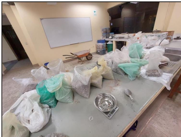
Figura 148: Pesaje de los agregados por tamiz de acuerdo al diseño
