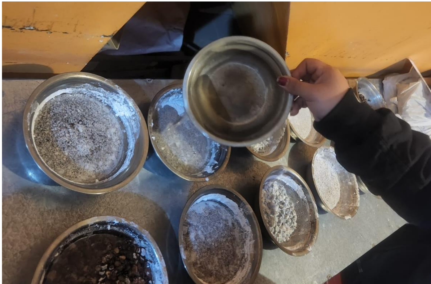
Figura 77: Sumersión de las muestras en el sulfato de magnesio
