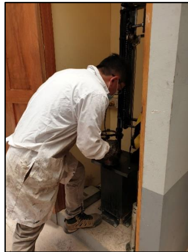
Figura 133: Colocado del molde en el martillo compactador
