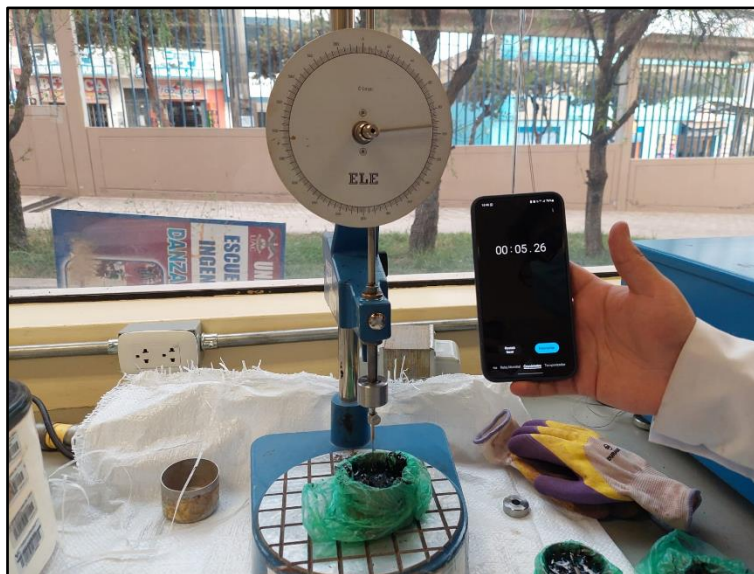
Figura 93: Ensayo de penetración del cemento asfáltico PEN 85/100
