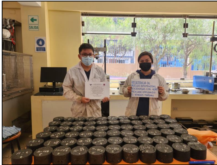
Figura 169: Especímenes Marshall adicionales con HDPE reciclado
