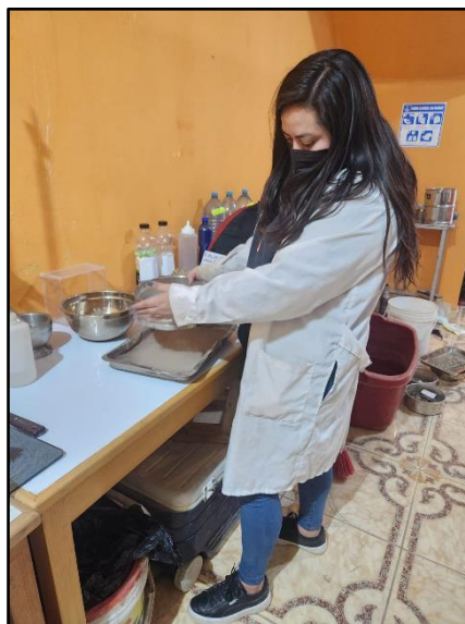
Figura 63: Tamizado del material por la malla N°40
