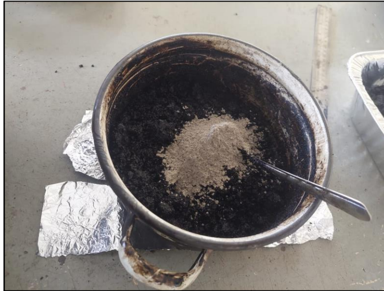
Figura 104: Adición del filler a la mezcla
