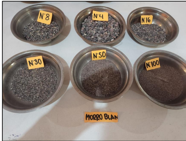
Figura 73: Arena triturada de Morro Blanco separada por tamices para realizar el ensayo
