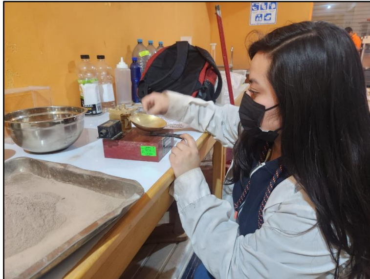
Figura 64: Calibración de la cuchara de Casagrande
