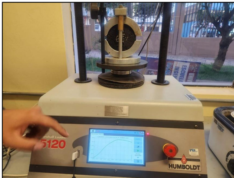
Figura 125: Datos de estabilidad y flujo.
