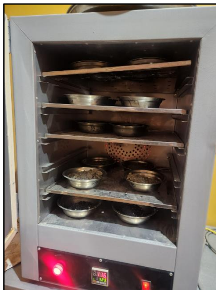
Figura 78: Muestras del ensayo de durabilidad en el horno
