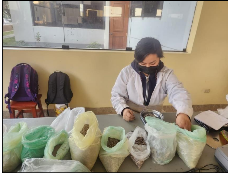
Figura 100: Pesaje de los agregados por tamiz de acuerdo al diseño
