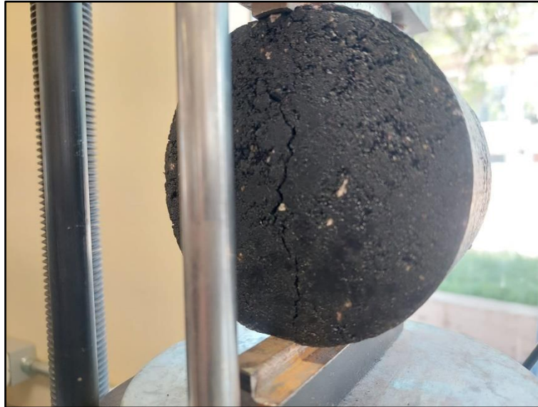
Figura 189: Muestra asfáltica adicionada con HDPE en el cabezal de rotura diametral.
