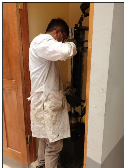
Figura 181: Colocado del molde con la muestra en el martillo compactador
