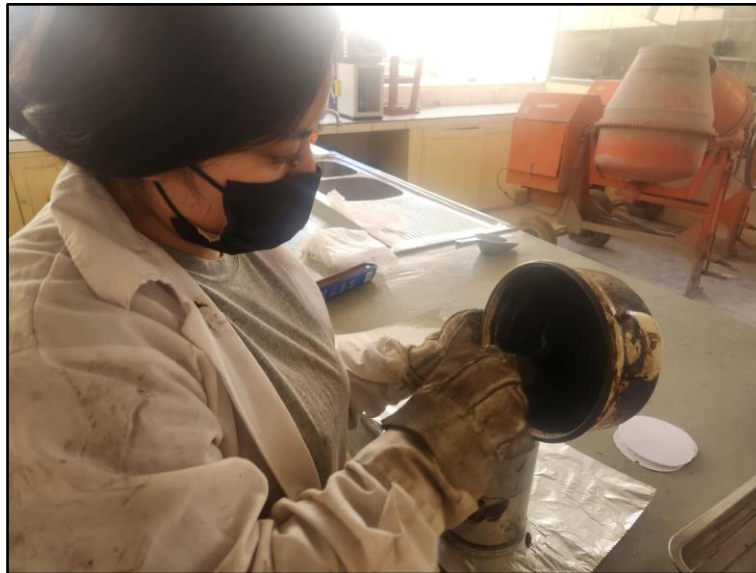
Figura 180: Vertido de mezcla asfáltica adicionada con HDPE en el molde Marshall
