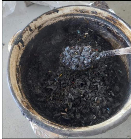
Figura 155: Adición del polietileno de alta densidad reciclado a la mezcla.
