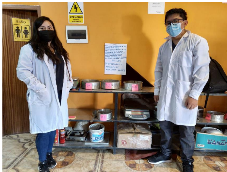
Figura 26: Ensayo de peso específico y absorción de agregado grueso
