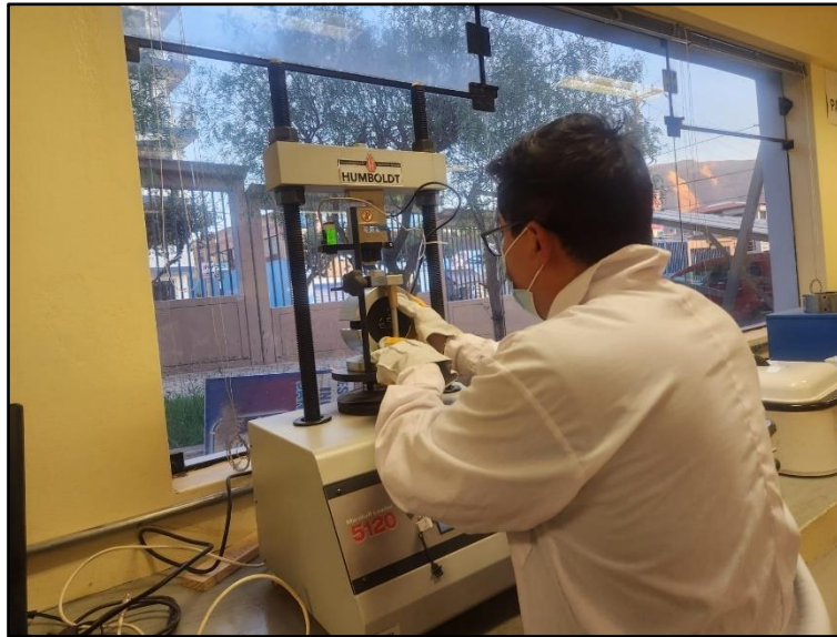
Figura 124: Alineamiento del cabezal de rotura, así como medidor de flujo
