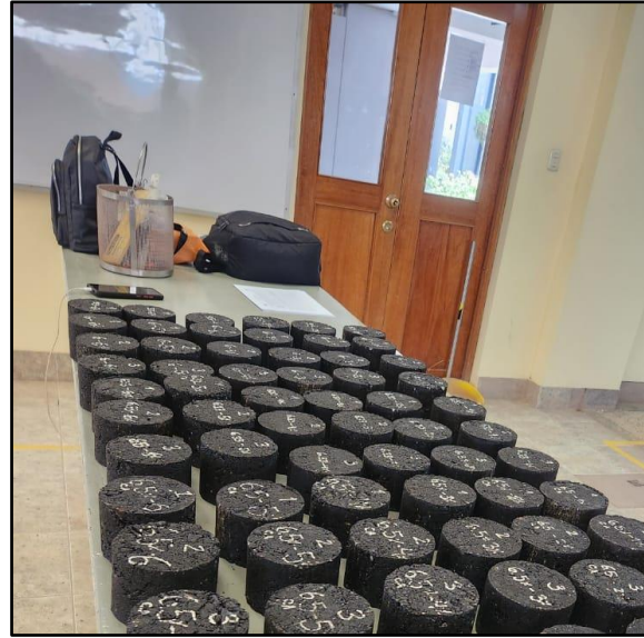
Figura 164: Muestras adicionales con HDPE - ensayo de peso específico
