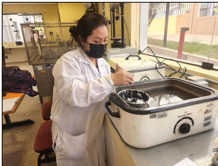
Figura 91: Cemento asfáltico PEN 85/100 en baño maría
