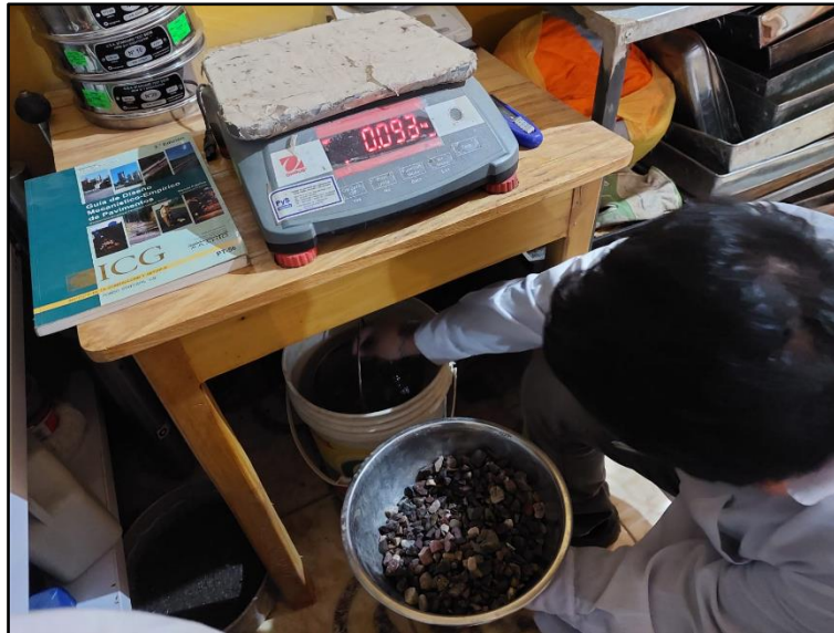
Figura 29: Colocación del material en la cesta metálica
