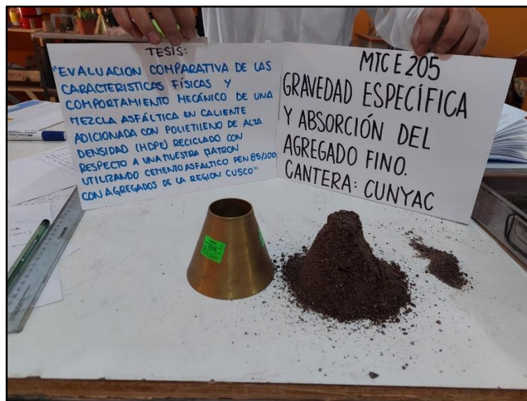
Figura 55: Muestra en condición Saturada Superficialmente Seco
