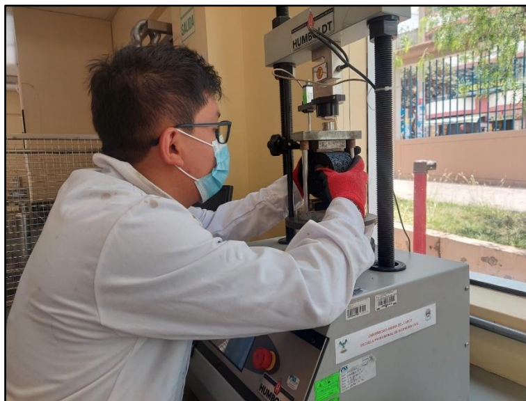
Figura 142: Muestra asfáltica con cabezal de rotura diametral
