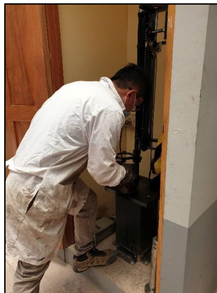
Figura 107: Colocando el Molde en el martillo automático
