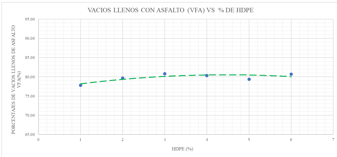
Figura 219: Valores del porcentaje de vacíos llenos de asfalto para la mezcla asfáltica con 6.5% de cemento asfáltico adicionado con HDPE
