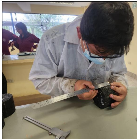
Figura 170: Toma de datos de altura y diámetro de las muestras adicionadas con HDPE
