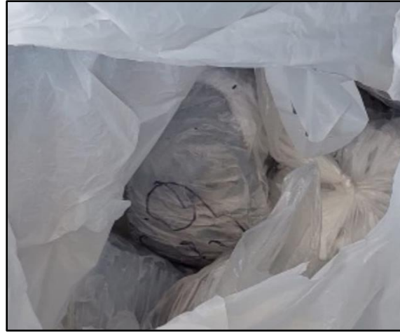
Figura 187: Muestras asfálticas adicionadas con HDPE en congeladora
