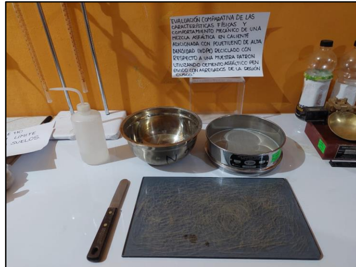
Figura 68: Materiales y equipos usados para la determinación del límite plástico e índice de plasticidad
