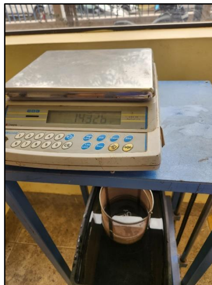
Figura 116: Peso del espécimen en la canastilla de flotación
