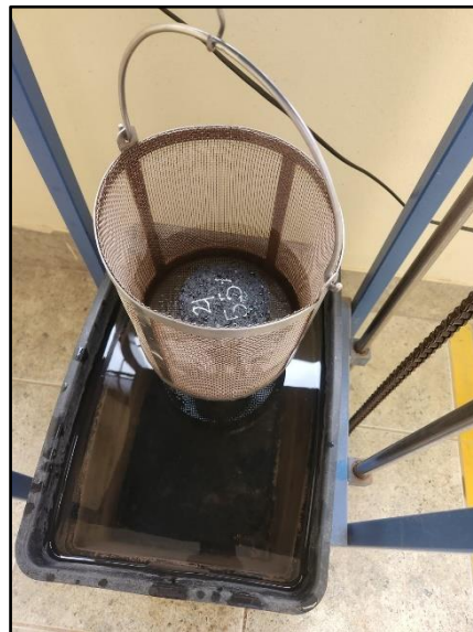
Figura 167: Muestra asfáltica adicionada con HDPE en canastilla de flotación
