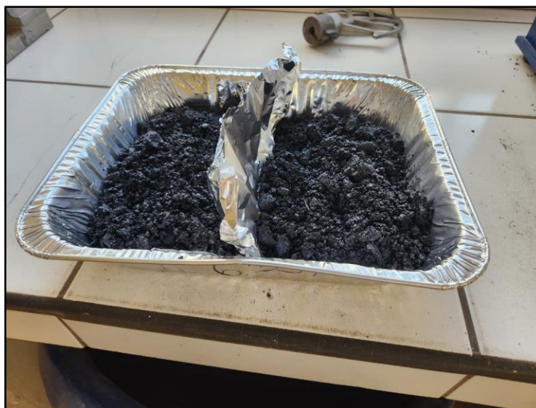
Figura 179: Recipientes de aluminio con mezclas asfálticas adicionada con HDPE
