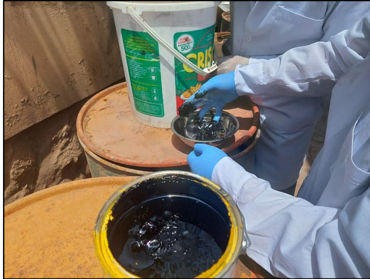
Figura 90: Separación de cemento asfáltico PEN 85/100 a ensayar
