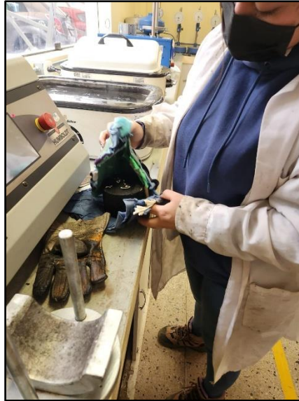
Figura 173: Espécimen Marshall adicionado con HDPE retirado de Baño María
