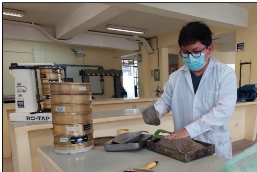
Figura 146: Tamizado de Agregados
