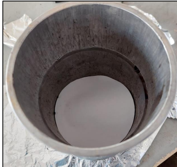
Figura 156: Molde Marshall con papel filtro
