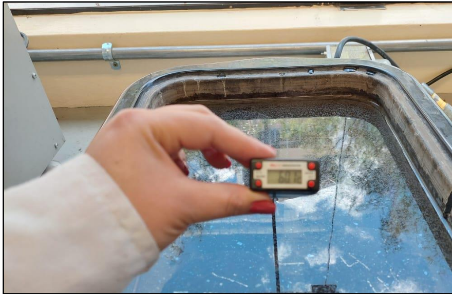
Figura 171: Temperatura de especímenes Marshall adicionadas con HDPE en Baño María
