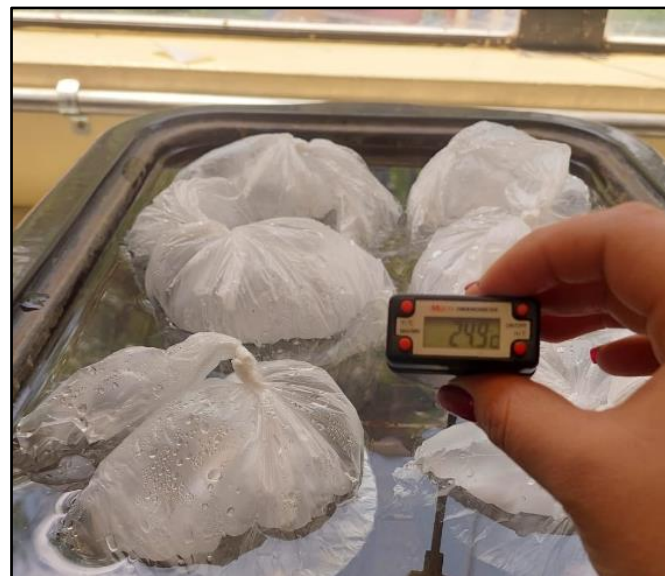
Figura 188: Muestras asfálticas adicionas con HDPE en Baño María a 25°C
