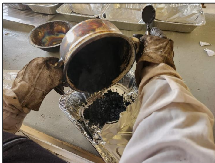
Figura 129: Llenado del recipiente de aluminio con la mezcla asfáltica
