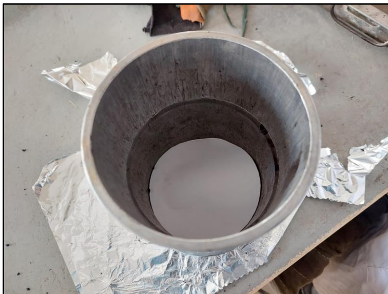
Figura 105: Molde Marshall con papel filtro
