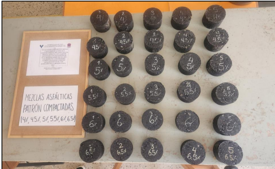
Figura 110: Muestras asfálticas con porcentajes 4% - 6.5%
