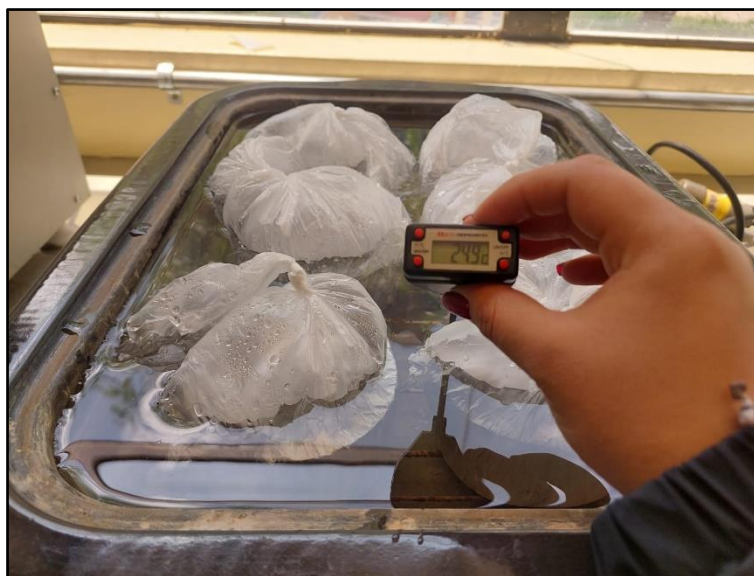
Figura 141: Muestras asfálticas en Baño María a 25°C
