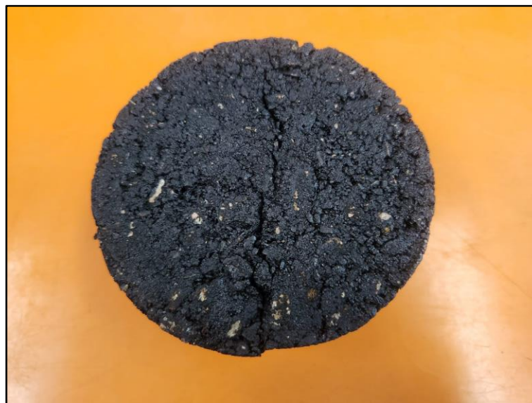
Figura 137: Fisura vertical de la muestra asfáltica
