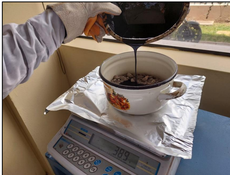
Figura 103: Pesaje del cemento asfáltico según el diseño.
