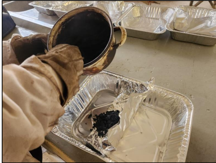
Figura 178: Llenado del recipiente de aluminio con la mezcla asfáltica adicionada con HDPE
