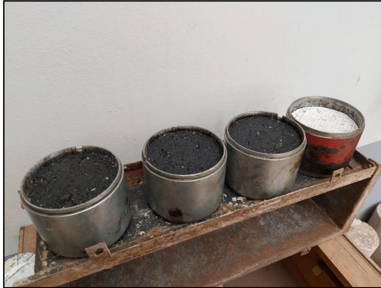
Figura 159: Molde con papel filtro y espécimen enfriando.
