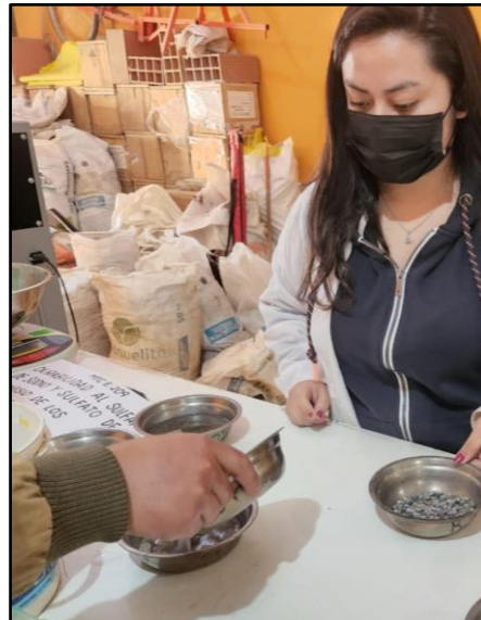
Figura 34: Colocación de Sulfato de Magnesio en el Agregado Grueso
