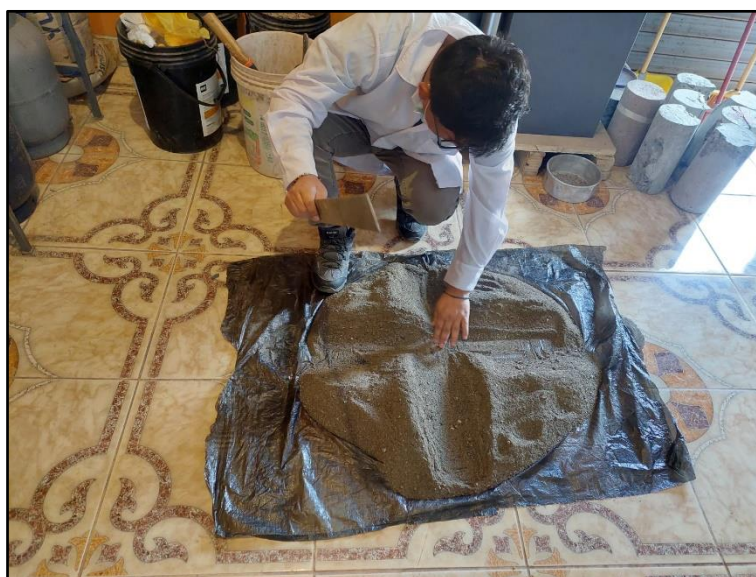
Figura 44: Cuarteo de la Arena natural de Cunyac
