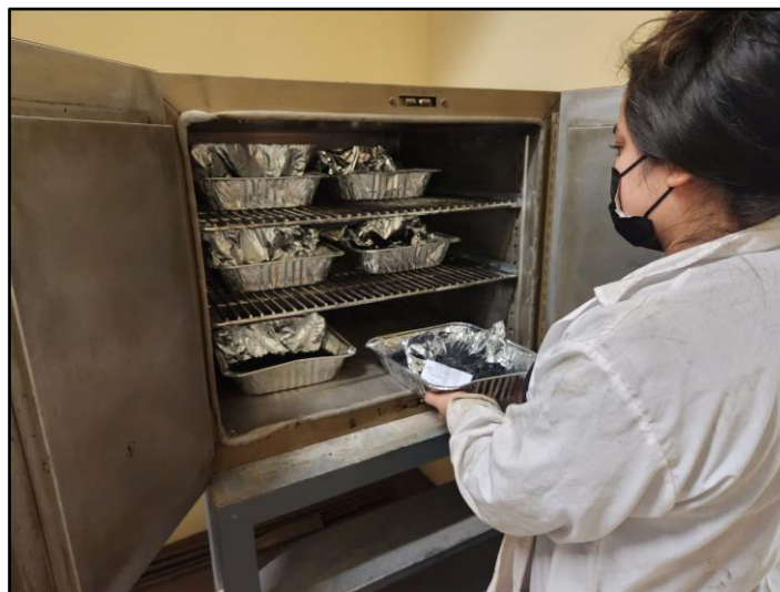
Figura 131: Recipientes con mezcla asfáltica en horno a 140^{\circ}\text{C}
