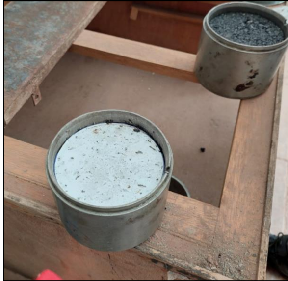
Figura 108: Molde con papel filtro y dejando enfriar.
