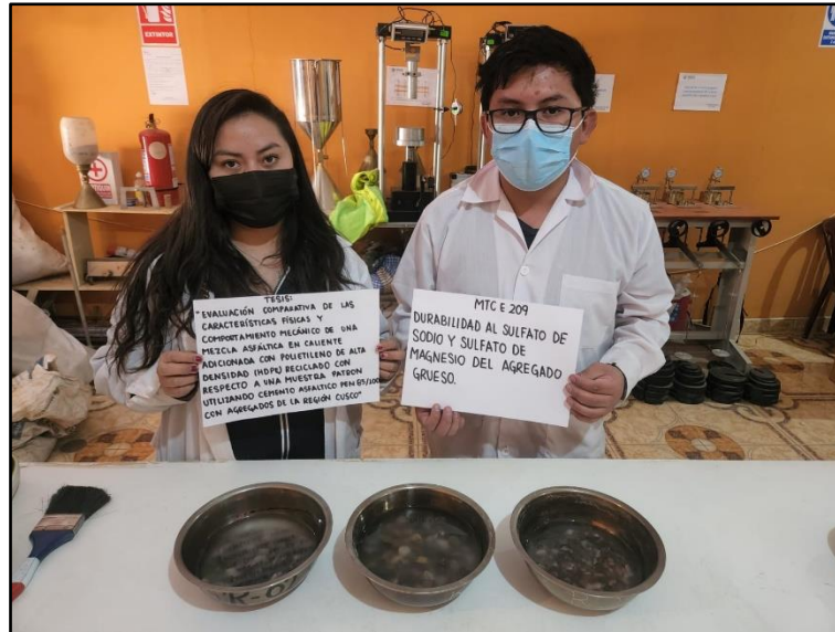
Figura 35: Agregado grueso sumergido en Sulfato de Magnesio
