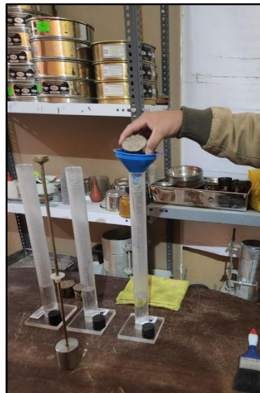
Figura 85: Colocación de material en los cilindros plásticos
