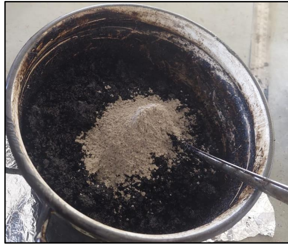
Figura 153: Adición del filler a la mezcla.
