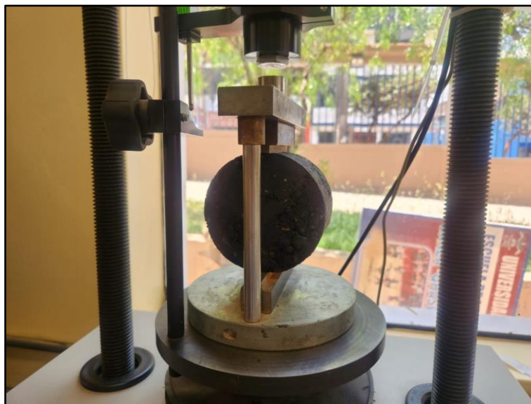
Figura 184: Muestra asfáltica adicionada con HDPE en el cabezal de rotura diametral
