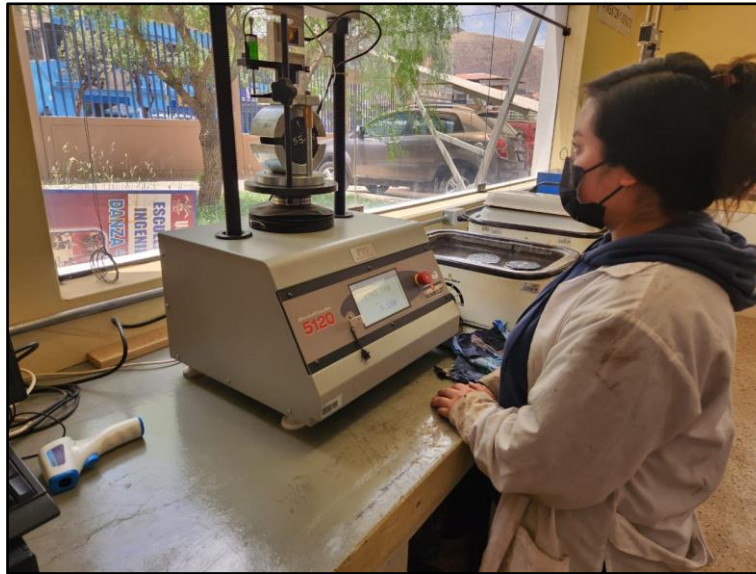
Figura 175: Toma de datos de estabilidad y flujo.
