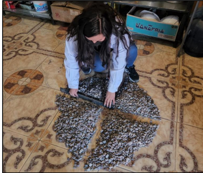
Figura 13: Cuarteo de agregado grueso de Morro Blanco.
