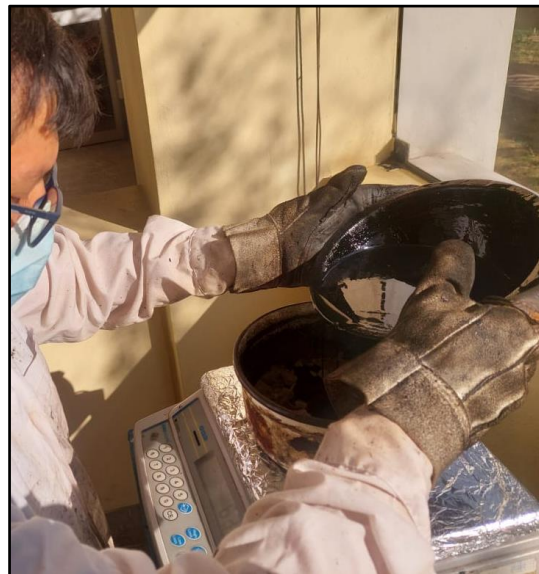
Figura 152: Pesaje del cemento asfáltico según el diseño.
