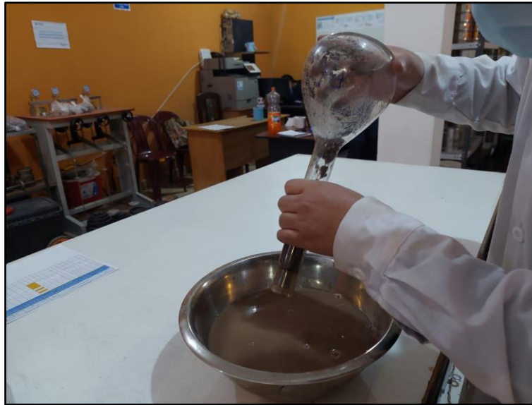
Figura 60: Vaciado de fiola.
