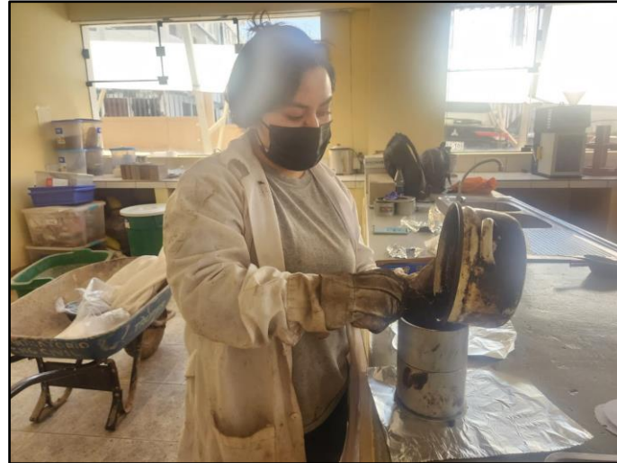
Figura 132: Vertido de mezcla asfáltica en el molde Marshall
