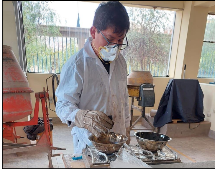
Figura 151: Asfalto en cocina en temperatura de 120°C – 140°C.
