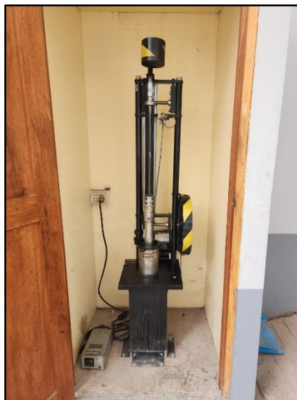
Figura 158: Molde colocado en el martillo automático
