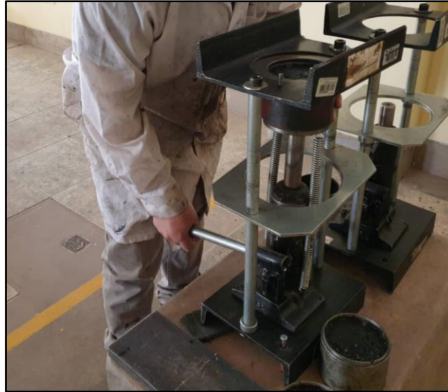
Figura 182: Eyección de muestras asfálticas adicionales con HDPE
