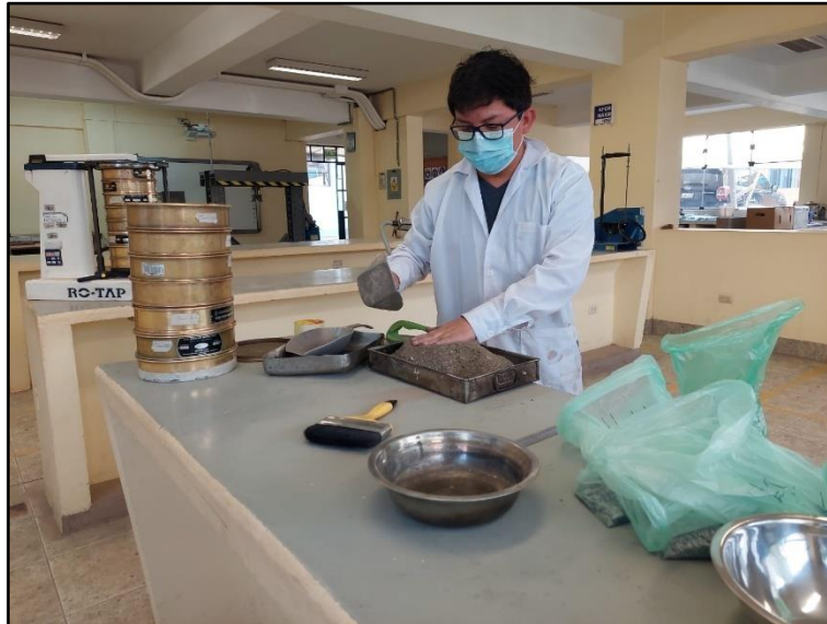
Figura 98: Tamizado de Agregados
