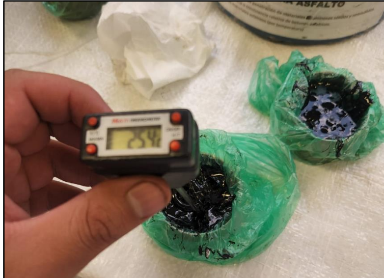
Figura 92: Toma de temperatura del cemento asfáltico PEN 85/100
