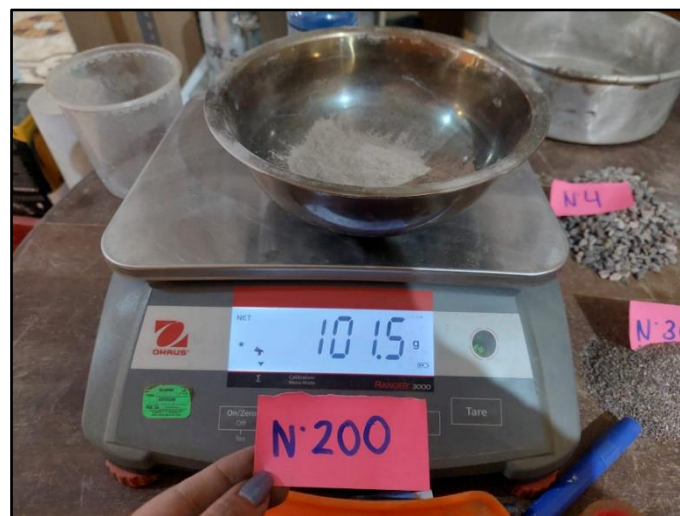
Figura 46: Material retenido en el tamiz N°200
