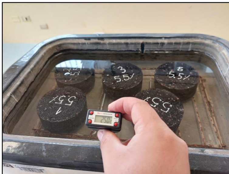
Figura 114: Muestras sumergidas en Baño María a 25°C
