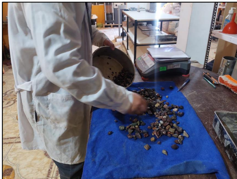
Figura 28: Secado del material saturado superficialmente seco.
