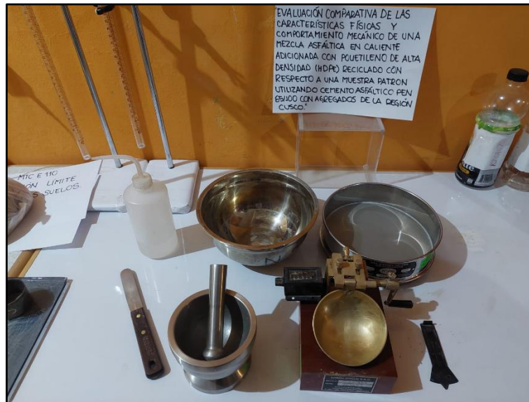
Figura 62: Materiales y equipos usados para la determinación del límite líquido de la arena
