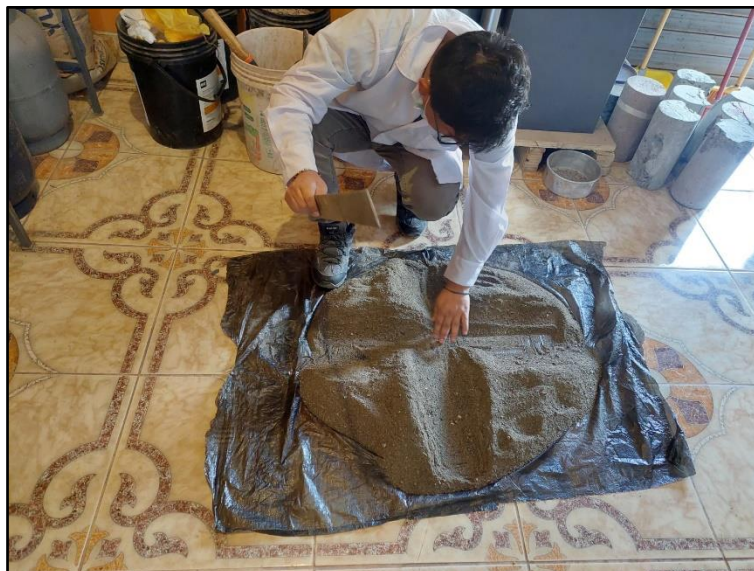
Figura 51: Cuarteo de la arena natural de Cunyac
