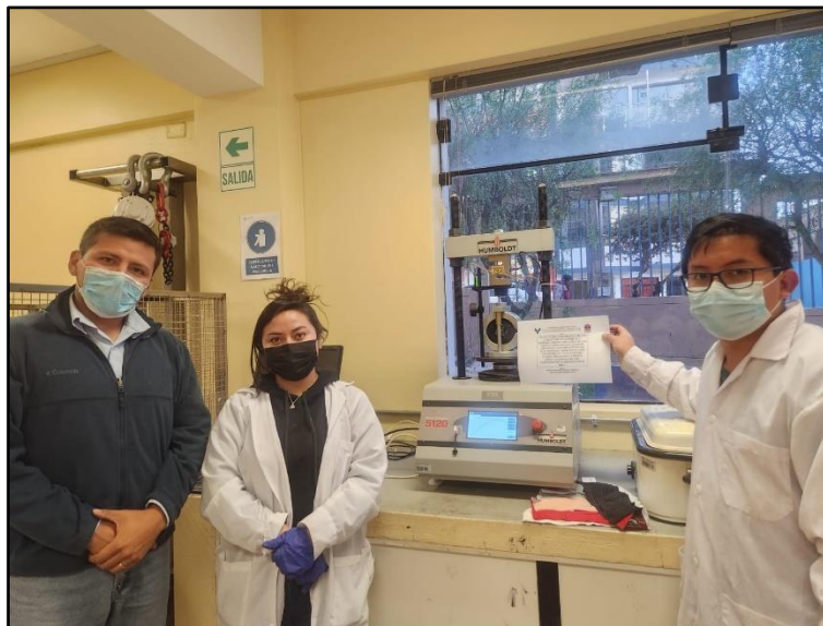
Figura 127: Ensayo de Estabilidad y Flujo.
