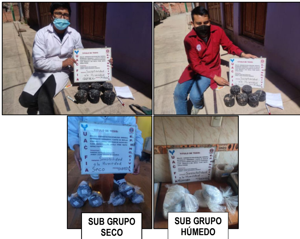
Agrupamiento de Especímenes - Ensayo de Daño Inducido por Humedad
