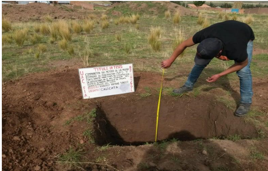
Excavación de calicata N°01
