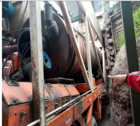
En esta tarea un cilindro giratorio que en su interior está provisto de paletas que secan y calientan los áridos a una temperatura de 150 °C, mediante un quemador de combustible.
