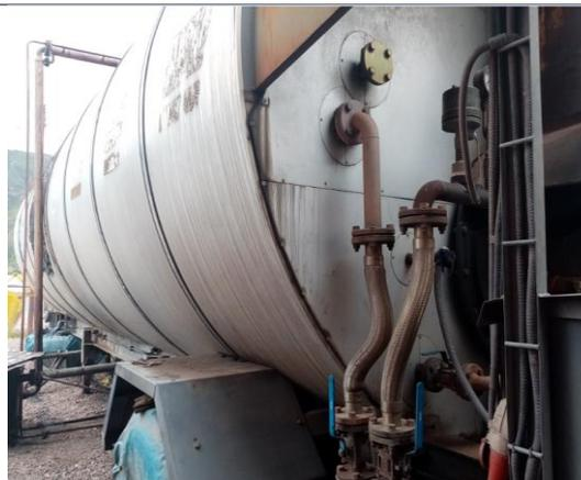
Esta tarea consiste en el calentado del asfalto por inducción a 170 °C.
