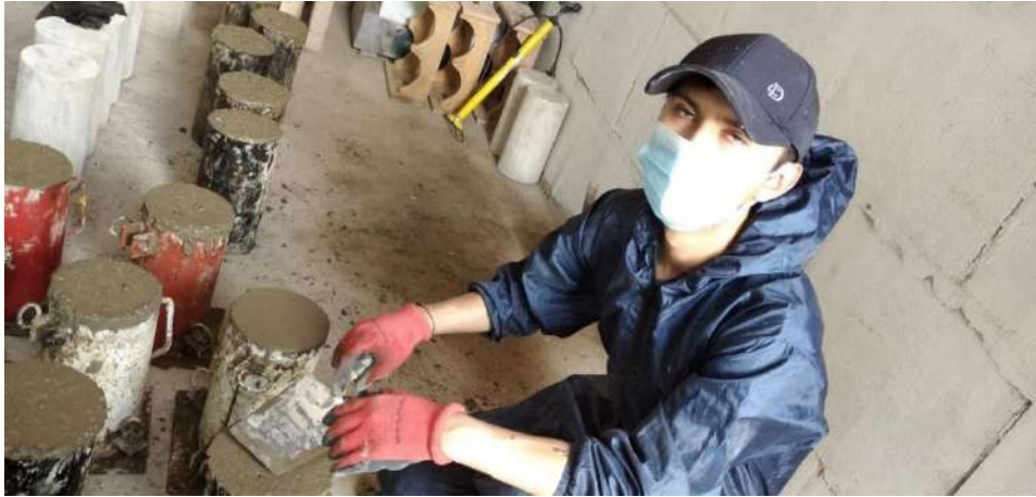
Figura 80. Enrazado de las 54 probetas de concreto F'_{C}=210 \text{ Kg/cm}^2 .
