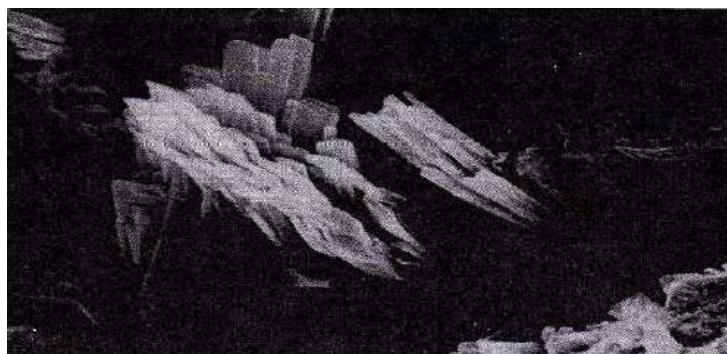
Figura 6. Cristales de cemento hidratado
