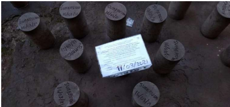
Figura 83. Selección de las 9 probetas que serán totalmente sumergidas.
