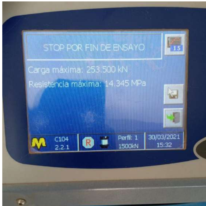
Figura 112. Rotura a los 28 días de las probetas curadas con Aditivo CHEMA (Muestra 2)
