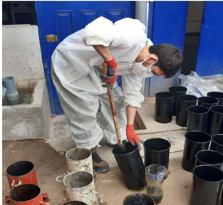
Figura 62. Humectado con Petróleo en briqueteras para facilitar el posterior desmolde.
