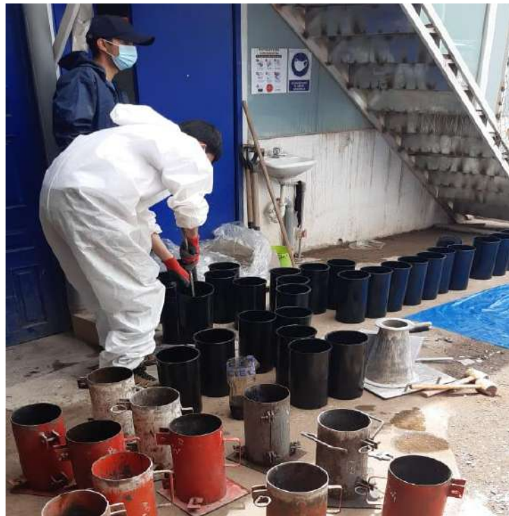
Figura 63. Humectado con Petróleo en briquetetas
