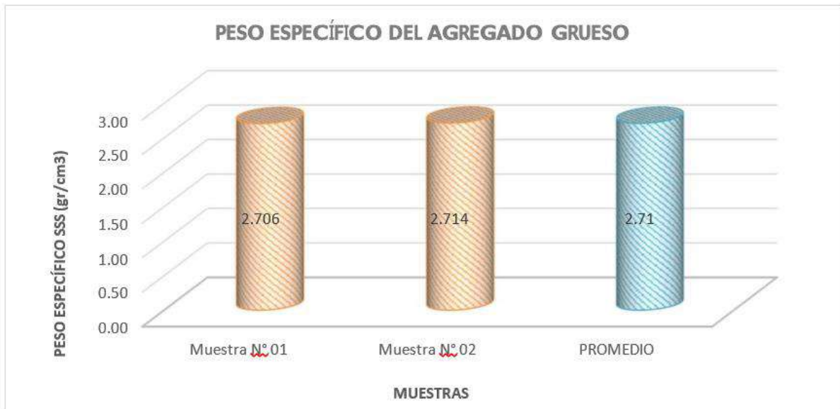
Figura 117. Grafica de datos procesados del ensayo Peso Específico del Agregado Grueso
