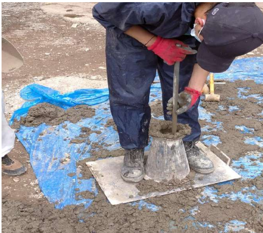
Figura 70. Realización de la prueba de asentamiento con el cono de Abrahams.
