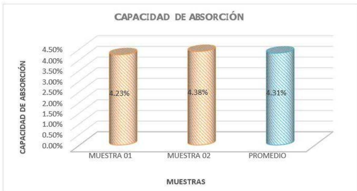
Figura 124. Grafica de datos de la Capacidad de Absorción del Agregado Fino
