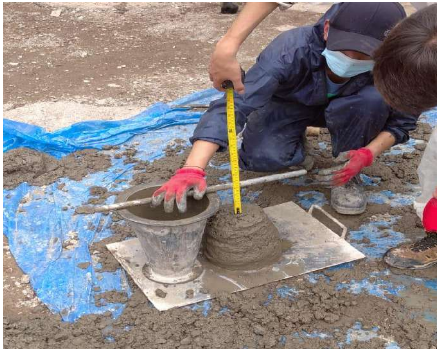
Figura 71. Determinación del Slump N° 1 (4").
