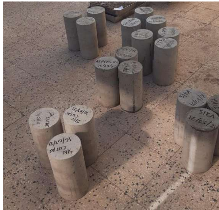
Figura 101. Probetas a ensayar a los 7 días.
