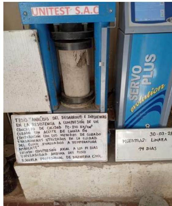
Figura 110. Rotura a los 14 días de las probetas curadas con aceite de linaza (Muestra 1)
