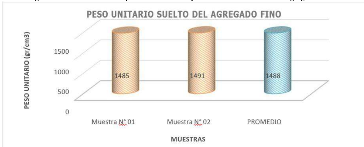
Figura 121. Grafica de datos procesados del ensayo Peso Unitario Suelto del Agregado Fino
