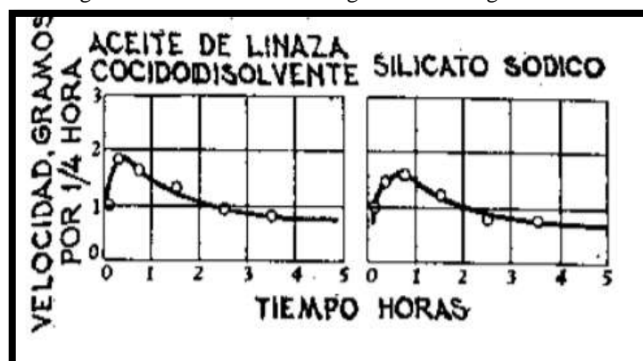
Figura 28. Resistencia al desgaste de hormigón tratado
