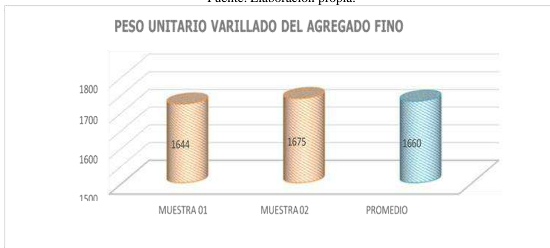
Figura 122. Grafica de datos procesados del ensayo Peso Unitario Compactado del Agregado Fino
