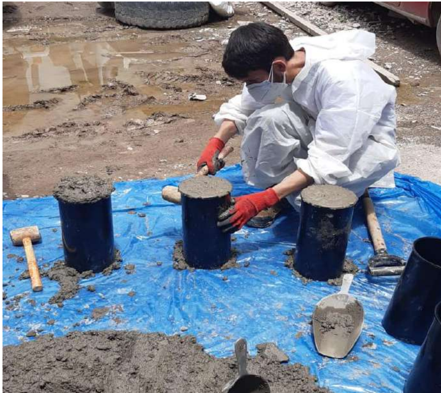
Figura 78. Golpeado con el combo de los exteriores de las briqueteras.
