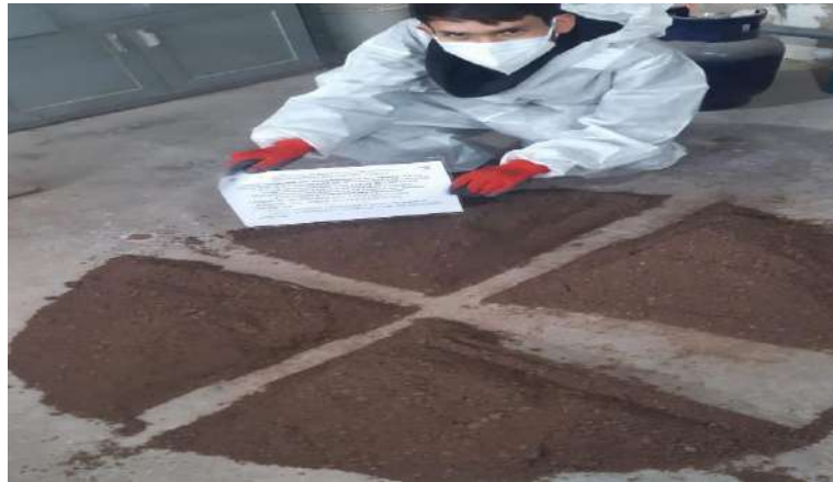
Figura 48. Selección del agregado por el método de cuarteo
