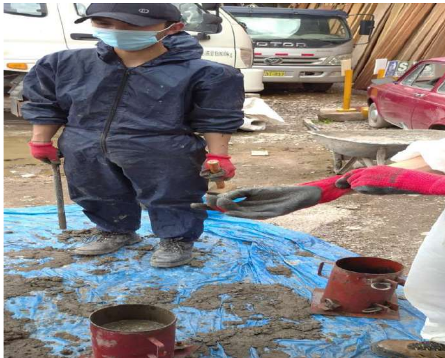
Figura 77. Elaboración de las Probetas.
