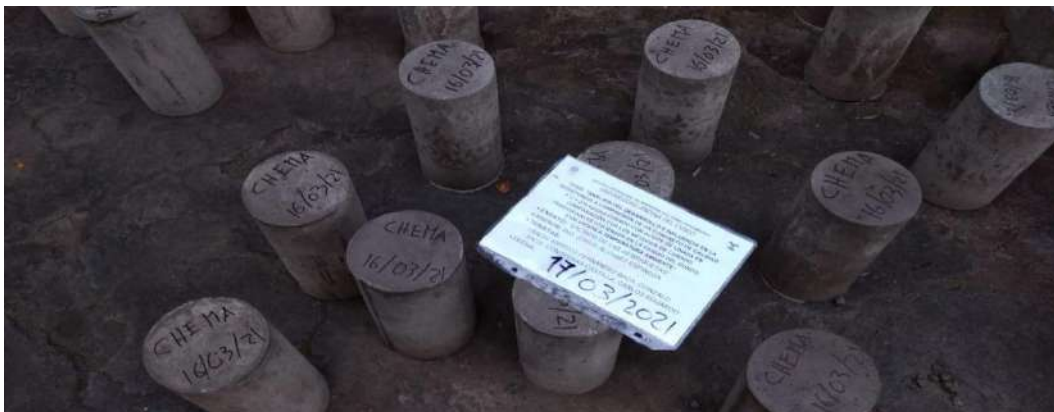
Figura 87. Selección de las 9 probetas que serán curadas con Aditivo CHEMA.
