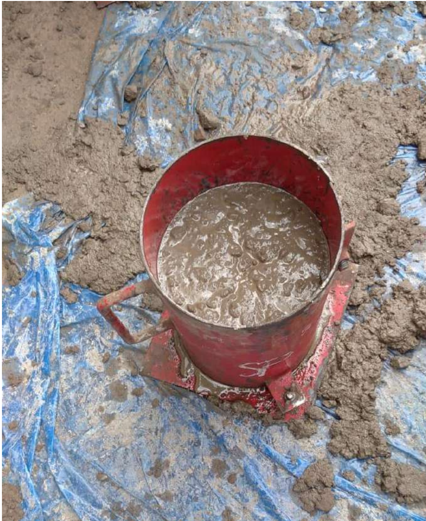
Figura 75. Vaciado de las briquetetas.
