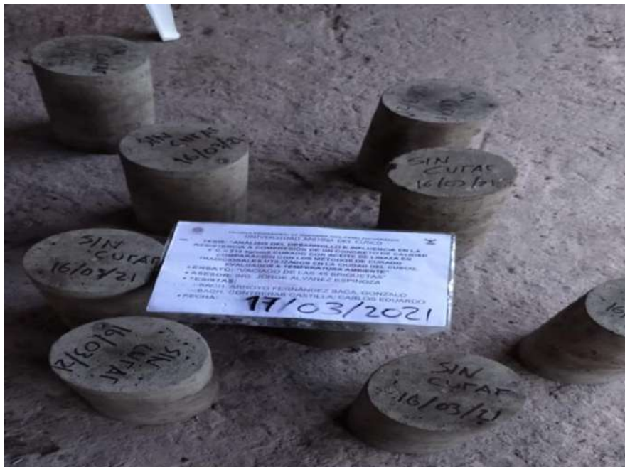
Figura 95. Selección de las 9 probetas que no se curarán mediante ningún método.
