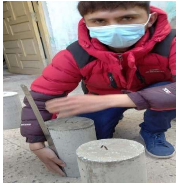
Figura 103. Medición de la altura de las probetas a ensayar a los 7 días.
