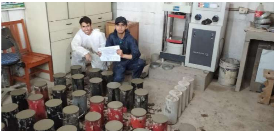
Figura 81. Foto final de las 54 probetas ya enrazadas.
