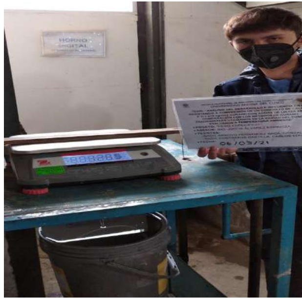
Figura 45. Determinación del peso de la muestra sumergida en la cestilla.
