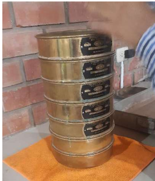
Figura 50. Selección de tamices para granulometría del agregado fino
