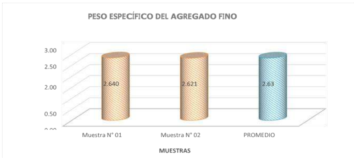
Figura 123. Grafica de datos procesados del ensayo Peso Específico del Agregado Fino
