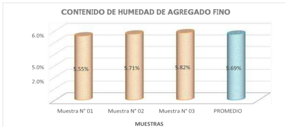
Figura 120. Gráfica de datos procesados del ensayo contenido de Humedad de Agregado Fino
