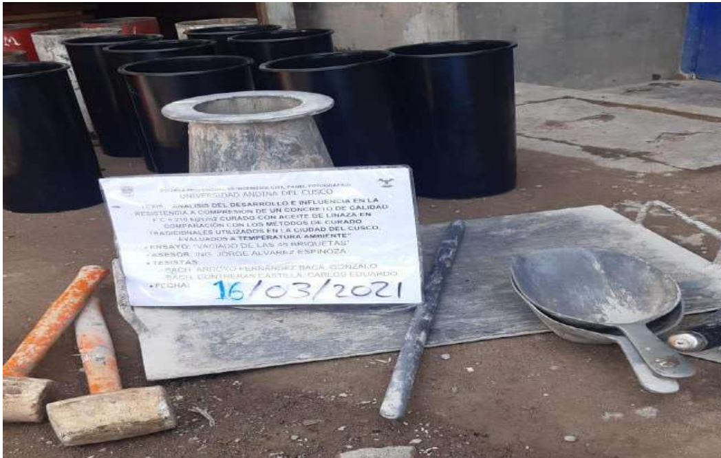
Figura 61. Cono de Abrahms y otros materiales a utilizar en el vaciado.
