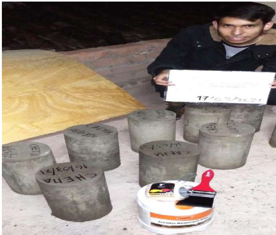
Figura 88. Probetas curadas con Aditivo CHEMA y Aditivo CHEMA.
