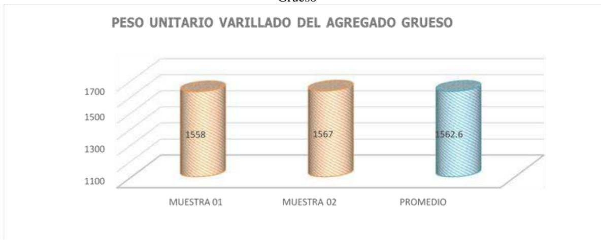
Figura 116. Grafica de datos procesados del ensayo Peso Unitario Compactado del Agregado Grueso
