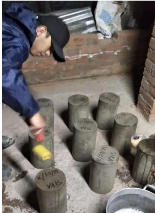
Figura 94. Curado de las Probetas con Aditivo SIKA.
