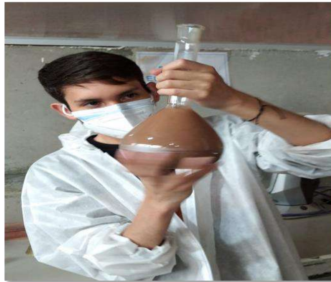
Figura 56. Eliminación de las burbujas de aire.
