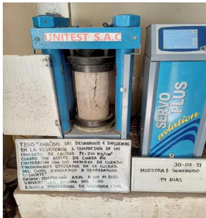
Figura 109. Rotura a los 14 días de las probetas totalmente sumergidas (Muestra 1)
