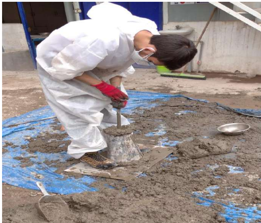
Figura 72. Varillado en el cono de Abrahams para la verificación del SLUMP
