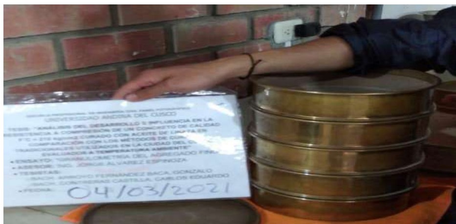
Figura 51. Tamizado del agregado Fino
