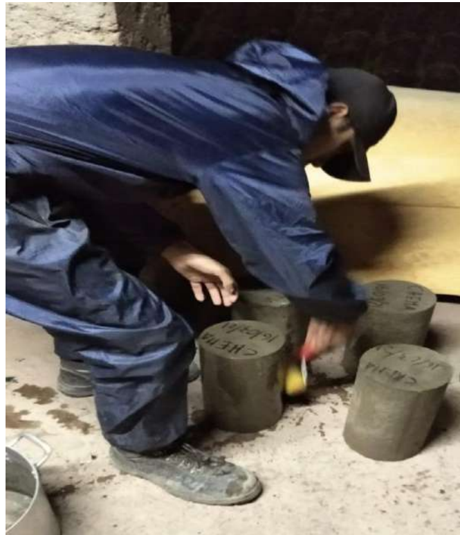
Figura 90. Curado de las Probetas con Aditivo CHEMA.
