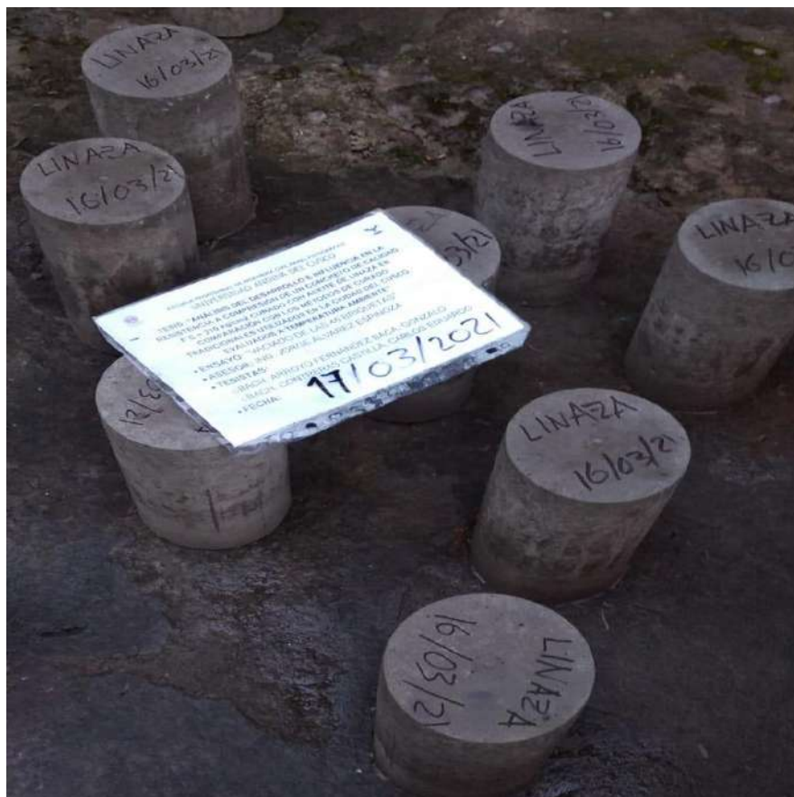
Figura 97. Selección de las 9 probetas que serán curadas con aceite de linaza.
