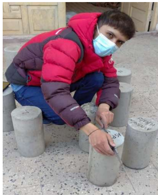
Figura 102. Medición del diámetro de las probetas a ensayar a los 7 días.
