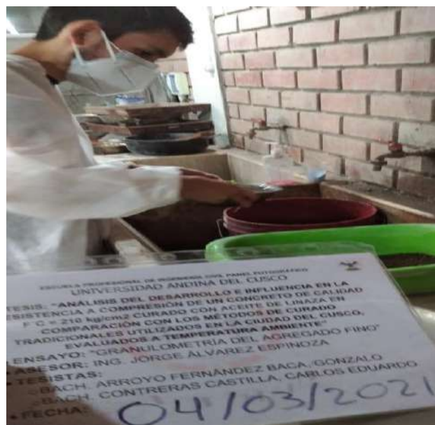
Figura 49. Lavado de la muestra de agregado fino y posterior tamizado por la malla Nro. 200.
