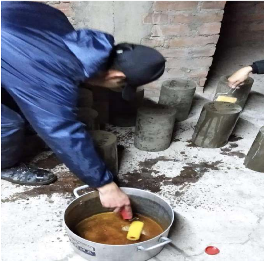
Figura 100. Curado de probetas con Aceite de Linaza.
