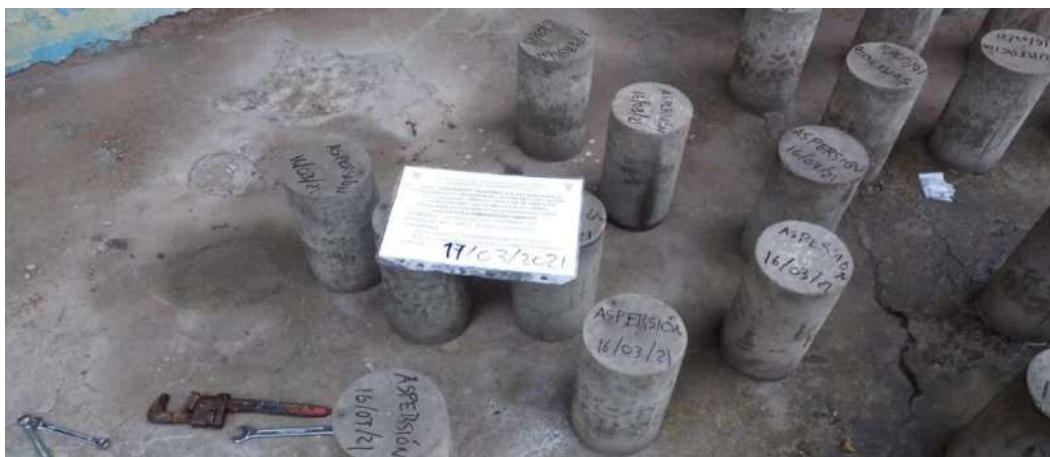
Figura 85. Selección de las 9 probetas que serán curadas por el método de Aspersión.
