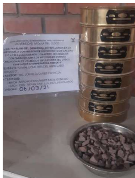
Figura 35. Selección de tamices del agregado grueso
