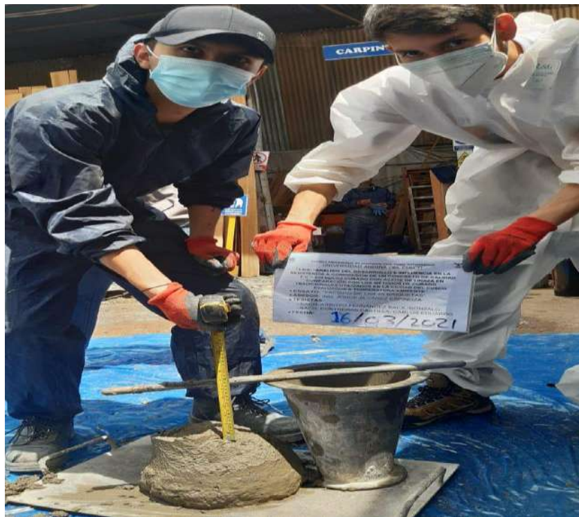
Figura 74. Determinación del Slump N° 2 (4”).
