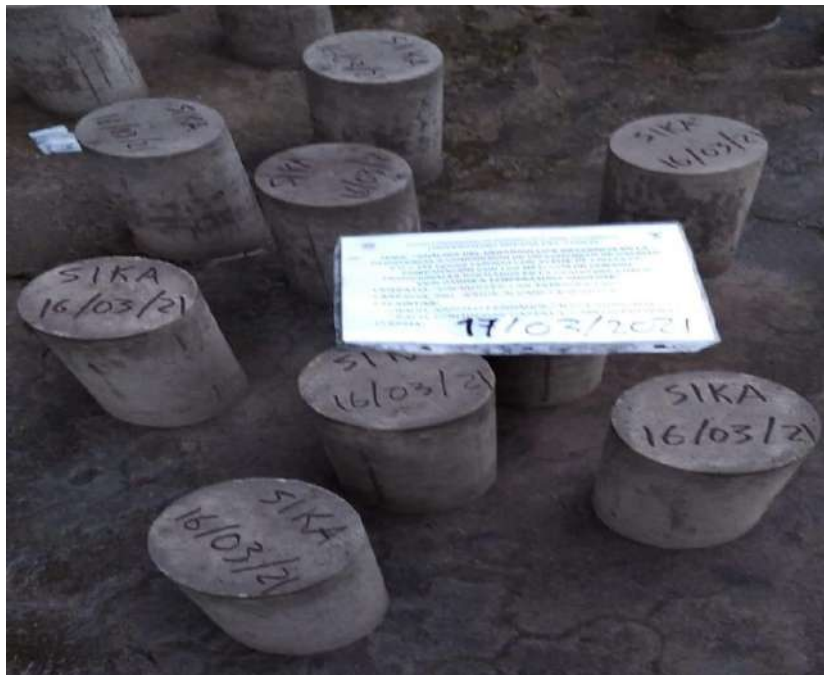
Figura 91. Selección de las 9 probetas que serán curadas con Aditivo SIKA.
