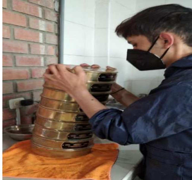
Figura 36. Zarandeo del Agregado grueso por los tamices correspondientes
