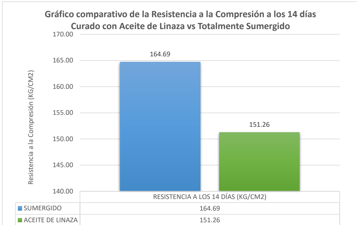
Figura 141. Gráfico comparativo de los valores promedio alcanzados de la resistencia a la compresión a los 14 días Totalmente sumergido vs curado con Aceite de Linaza.
