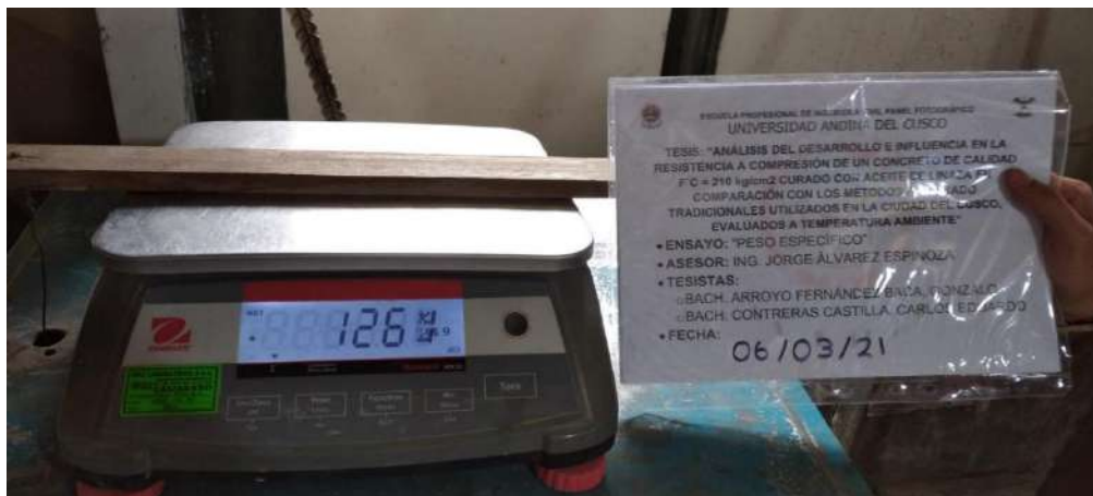
Figura 44. Determinación del peso de la muestra SSS de agregado sumergida
