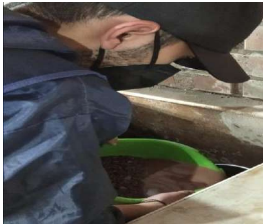
Figura 34. Lavado de la muestra de agregado grueso
