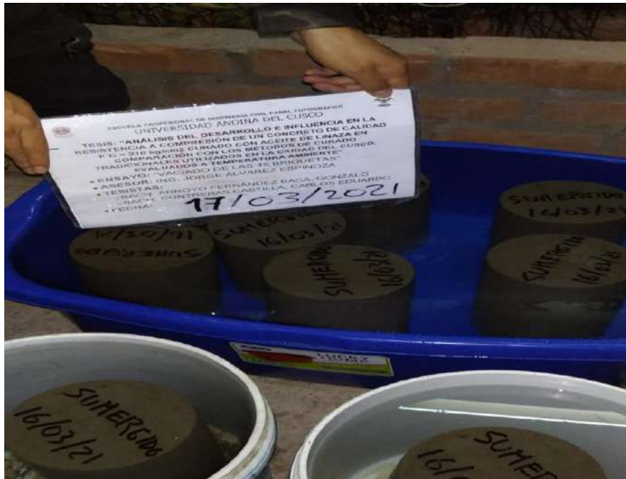
Figura 84. Probetas totalmente sumergidas.
