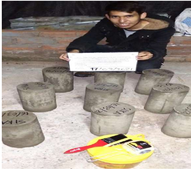
Figura 92. Probetas curadas con Aditivo SIKA.
