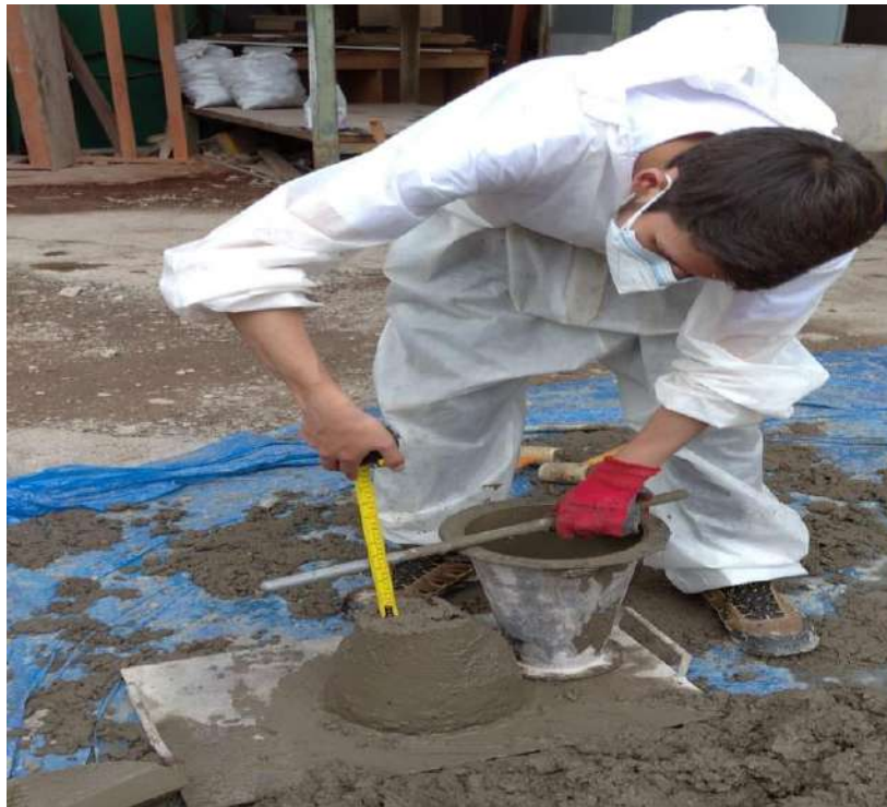
Figura 73. Determinación del Slump N° 2 (3.5”).
