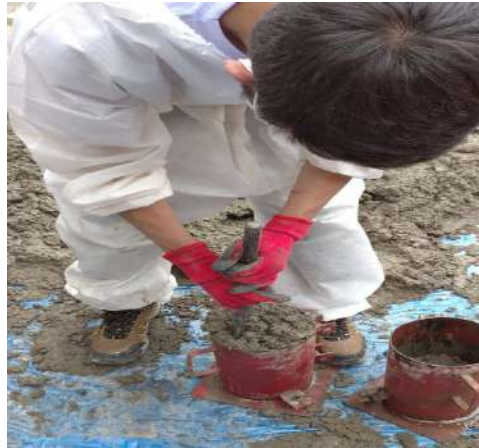
Figura 76. Varillado de las Briquetas cada 3 capas 25 golpes
