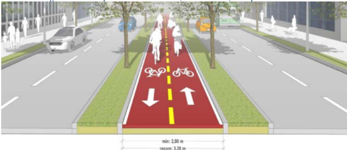
Figura N° 28. Esquemático de ciclovía (bidireccional) en separador central
