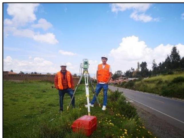
*Figura 60: Estación total para la georreferenciación de los puntos de foto control*
