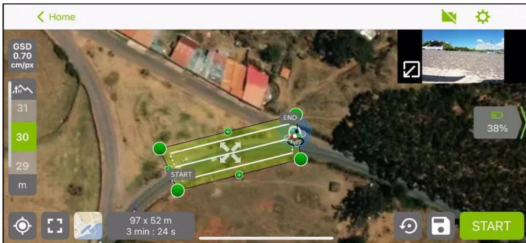
Figura 64: Configuración del plan de vuelo en el aplicativo Pix4Dcapture
