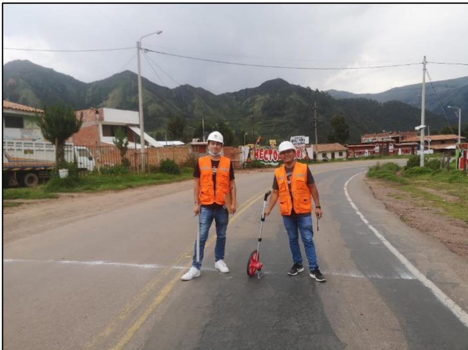
*Figura 239: Recolección de datos del UM-09 mediante la metodología tradicional del PCI*
