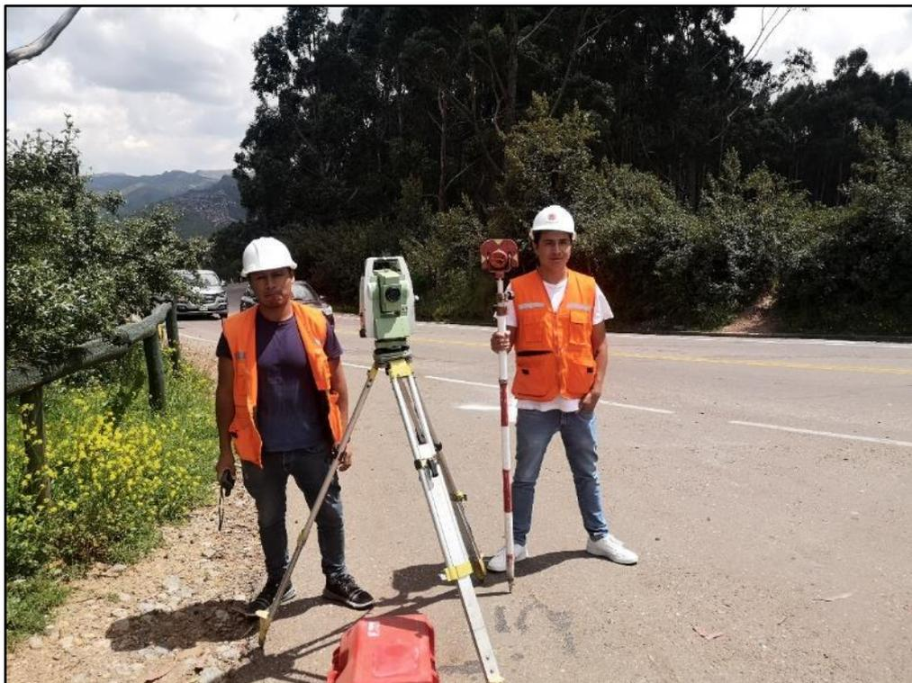
Figura 225: Georreferenciación de puntos de foto control en el UM-03
