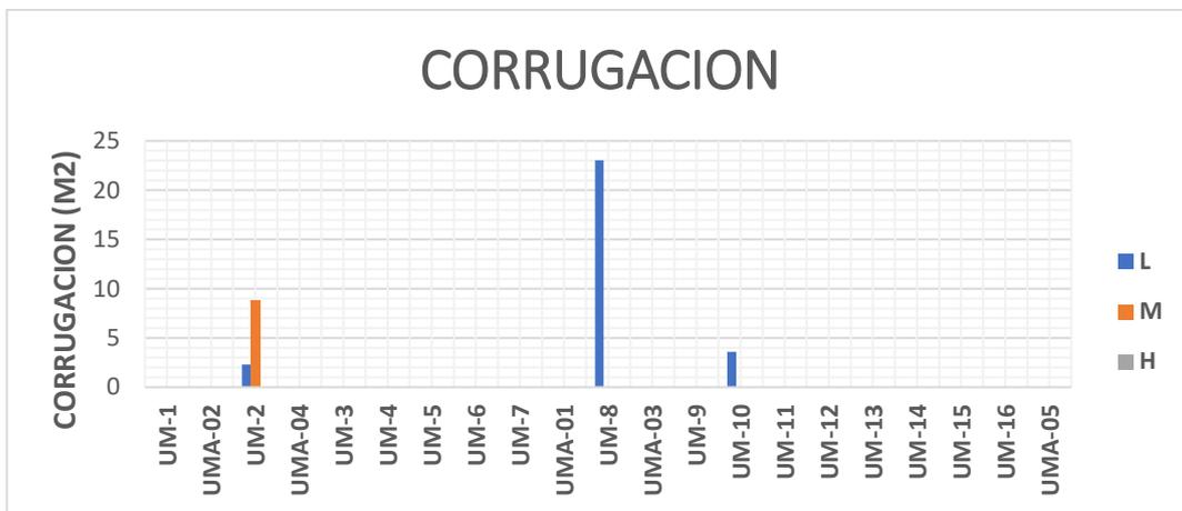
Figura 158: Distribución de deterioros de las UMs mediante la metodología del PCI – PIEL DE CORRUGACIÓN
