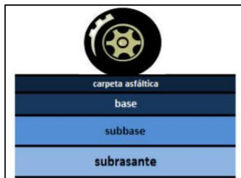
*Figura 3: Paquete Estructural del Pavimento con superficie de concreto asfáltico*
