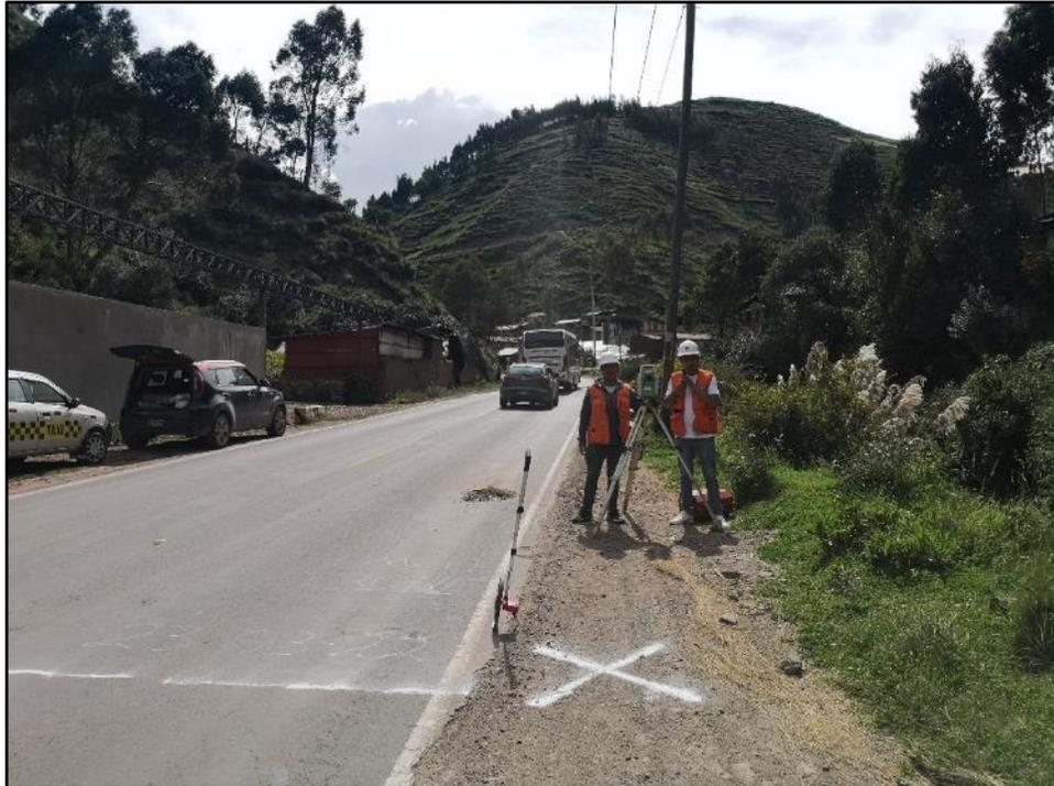
*Figura 242: Recolección de datos del UM-11 mediante la metodología VANT*
