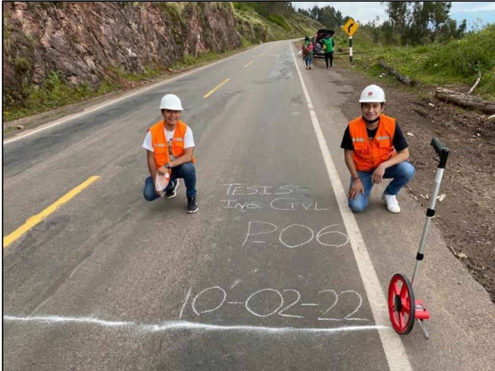
Figura 230: Recolección de datos del UM-06 mediante la metodología tradicional del PCI
