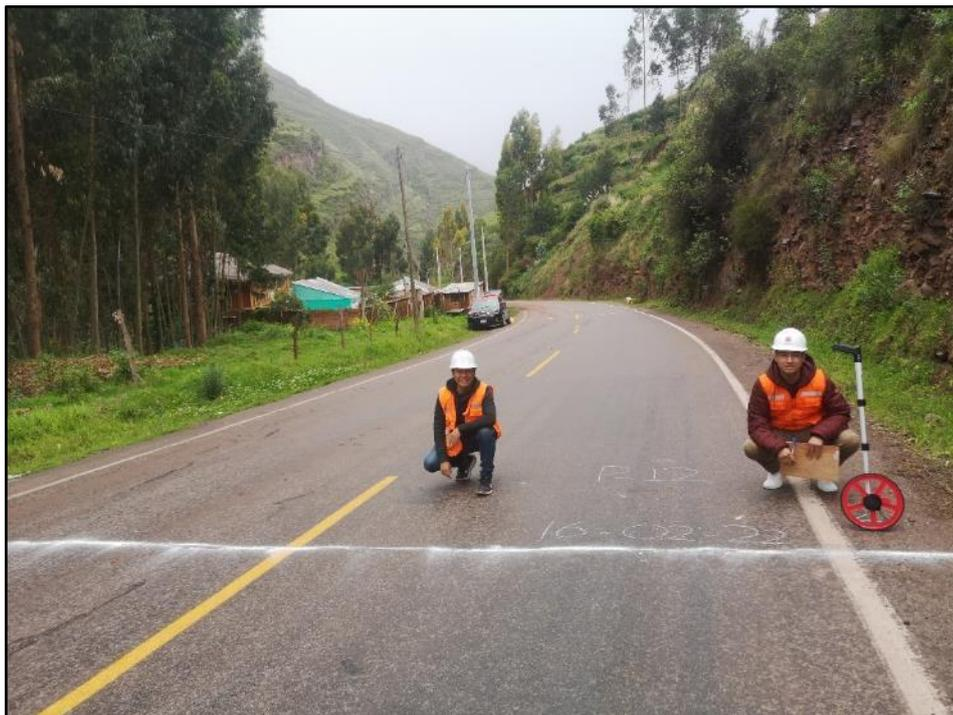
*Figura 245: Recolección de datos del UM-012 mediante la metodología tradicional del PCI*
