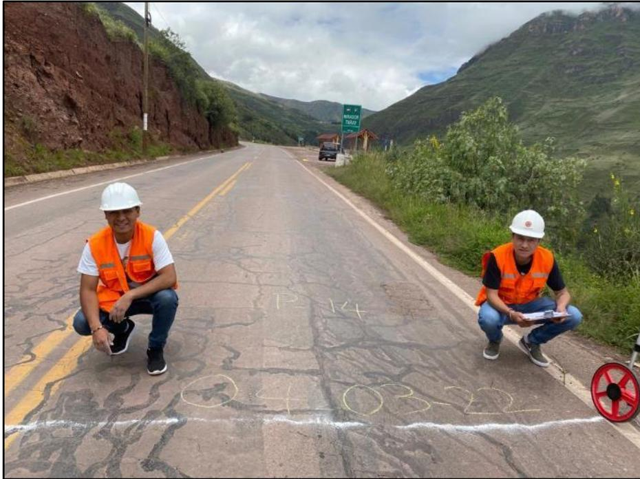
Figura 248: Recolección de datos del UM-014 mediante la metodología tradicional del PCI
