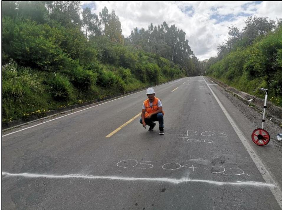
Figura 224: Recolección de datos del UM-03 mediante la metodología tradicional del PCI
