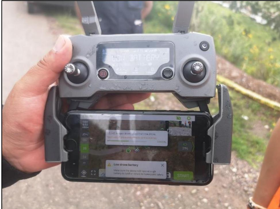
*Figura 250: Control remoto del drone Mavic 2 Pro*
