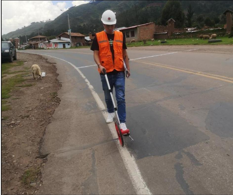
*Figura 238: Uso del odómetro para la delimitación del UM-09*
