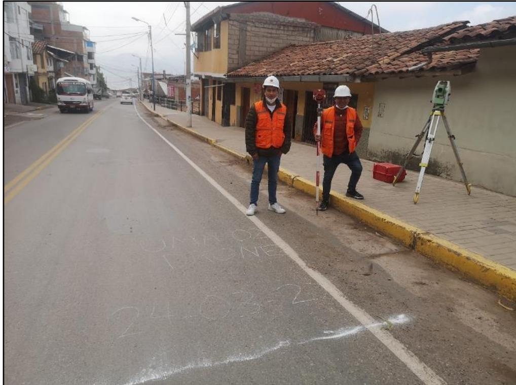
*Figura 256: Georreferenciación de puntos de foto control en el UMA-02*
