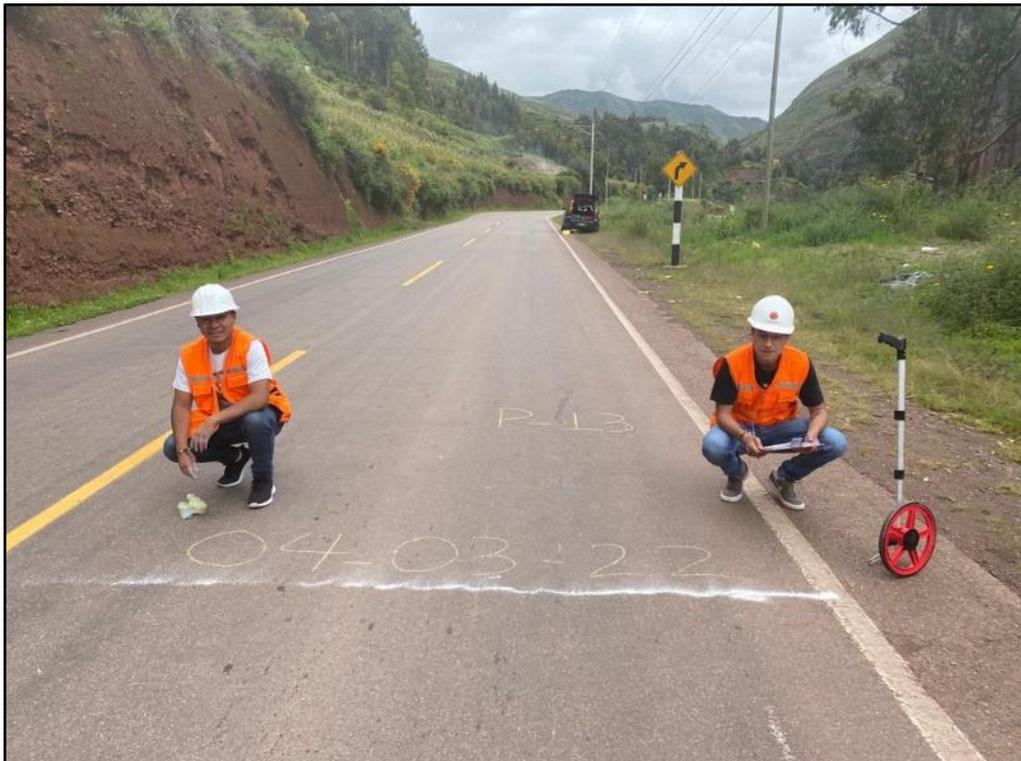
*Figura 247: Recolección de datos del UM-013 mediante la metodología tradicional del PCI*
