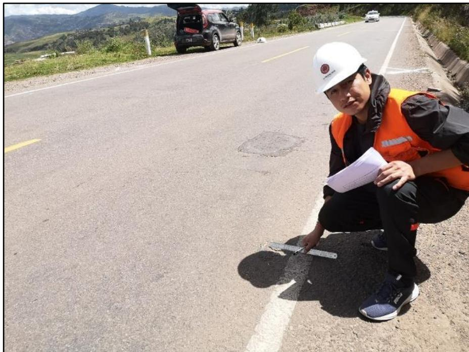
*Figura 255: Recolección de datos del UMA-01 mediante la metodología tradicional del PCI*
