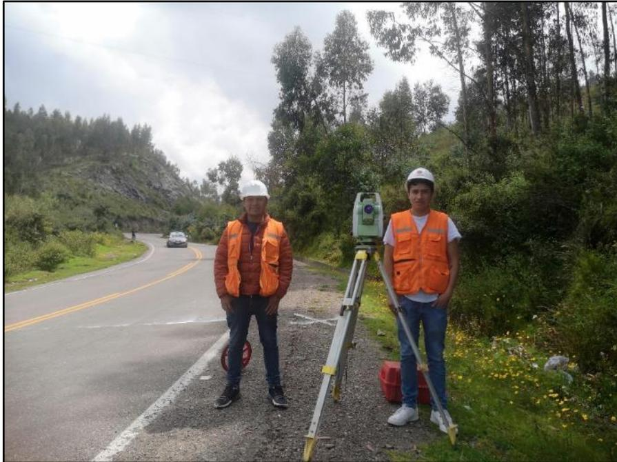
*Figura 226: Georreferenciación de puntos de foto control en el UM-04*
