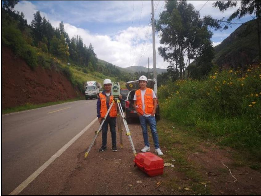
*Figura 246: Georreferenciación de puntos de foto control en el UM-013*
