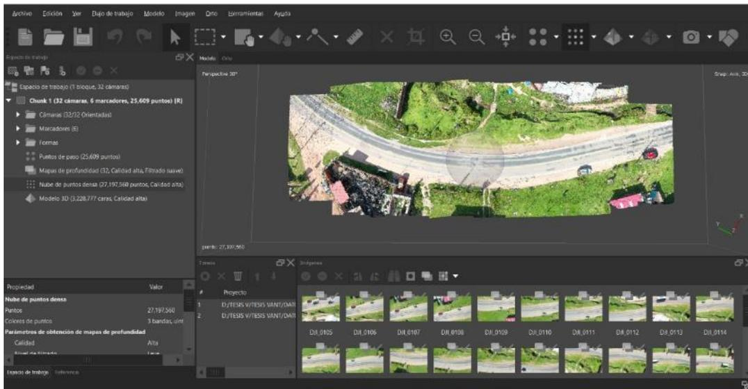
Figura 74: Creación de nube de puntos densa
