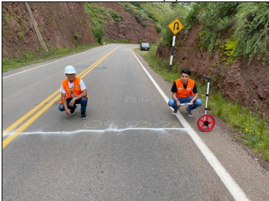
*Figura 253: Recolección de datos del UM-016 mediante la metodología tradicional del PCI*
