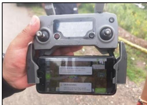
*Figura 48: Control remoto del drone Mavic 2 Pro*
