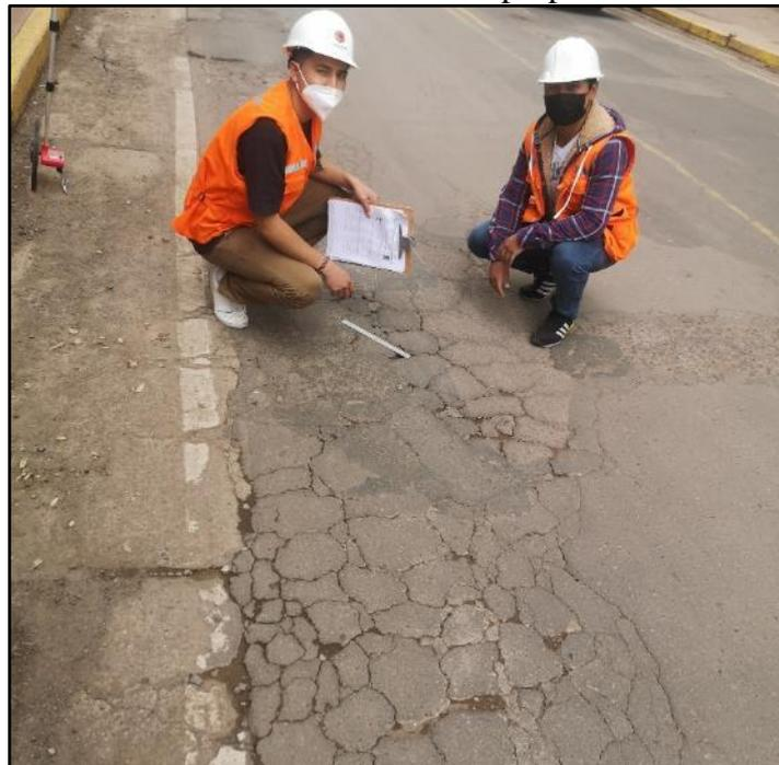
*Figura 221: Recolección de datos del UM-01 mediante la metodología tradicional del PCI*
