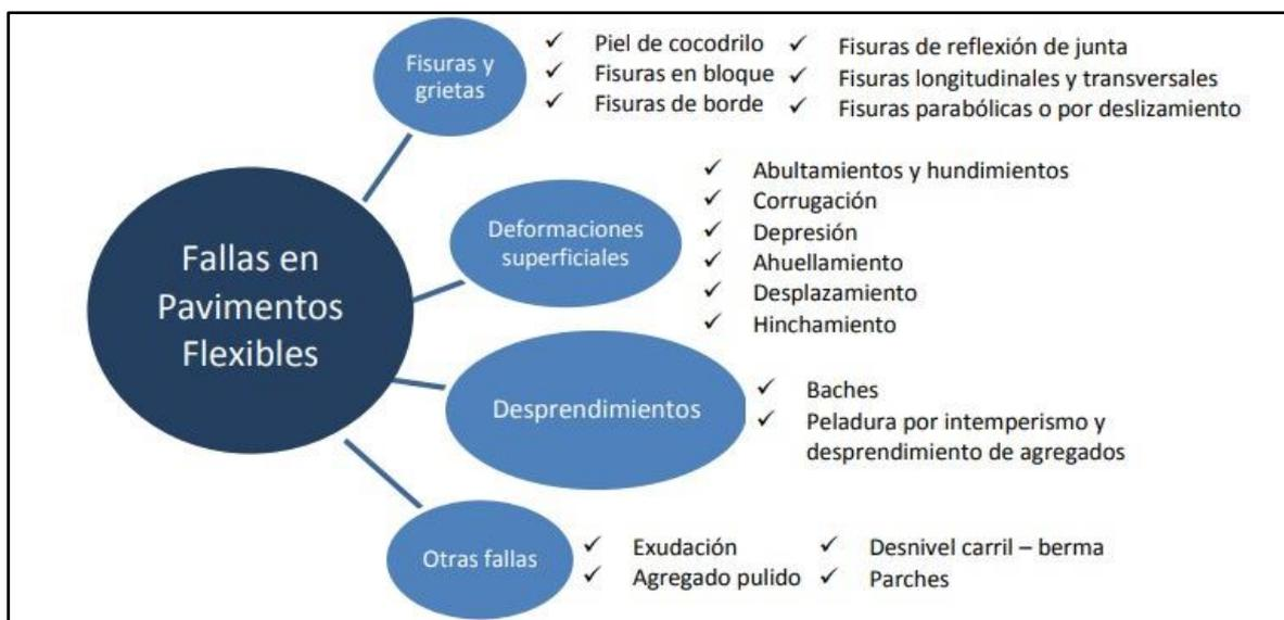
Figura 17: Clasificación de fallas en Pavimentos Flexibles
