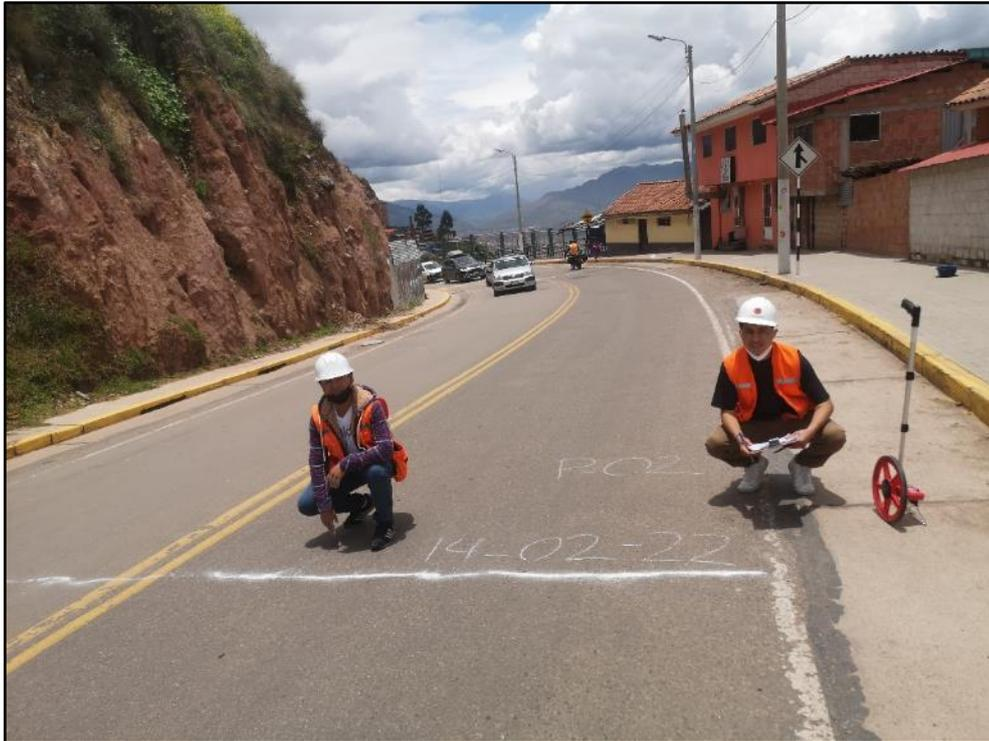
Figura 222: Recolección de datos del UM-02 mediante la metodología tradicional del PCI
