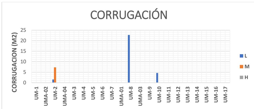
Figura 180: Distribución de deterioros de las UMs mediante la metodología del VANT – PIEL DE CORRUGACIÓN
