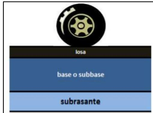
*Figura 2: Paquete Estructural del Pavimento de concreto de cemento Portland*
