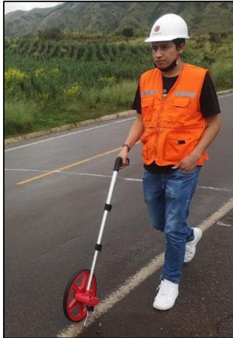
*Figura 49: Odómetro manual*
