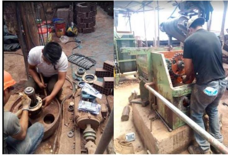
**e. DURANTE LA APLICACIÓN DE MANTENIMIENTO AUTÓNOMO:** Por otro grupo de trabajadores se evidencia en el área de producción se realiza limpieza de piezas de la maquinaria, lubricación de maquinarias ajustes e inspecciones sobre averías todo ello fue realizado en coordinación con el personal y responsables de área.
