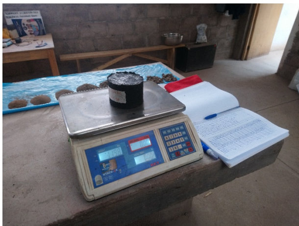
Figura 23: Toma de datos de peso seco, peso SSS y peso sumergido.
