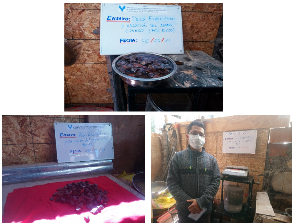
Figura 14: Lavado, secado, sumersión del agregado grueso.
