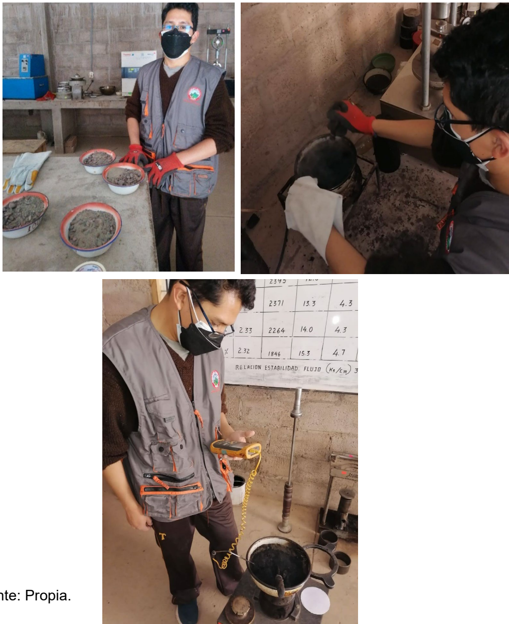
Figura 21: Elaboración de mezclas asfálticas en caliente.
