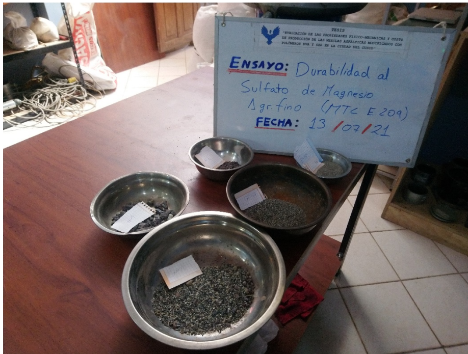
Figura 16: Separado de muestra por tamiz del agregado fino para ensayo.
