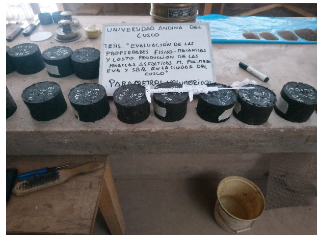
Figura 23: Toma de datos de peso seco, peso SSS y peso sumergido.
