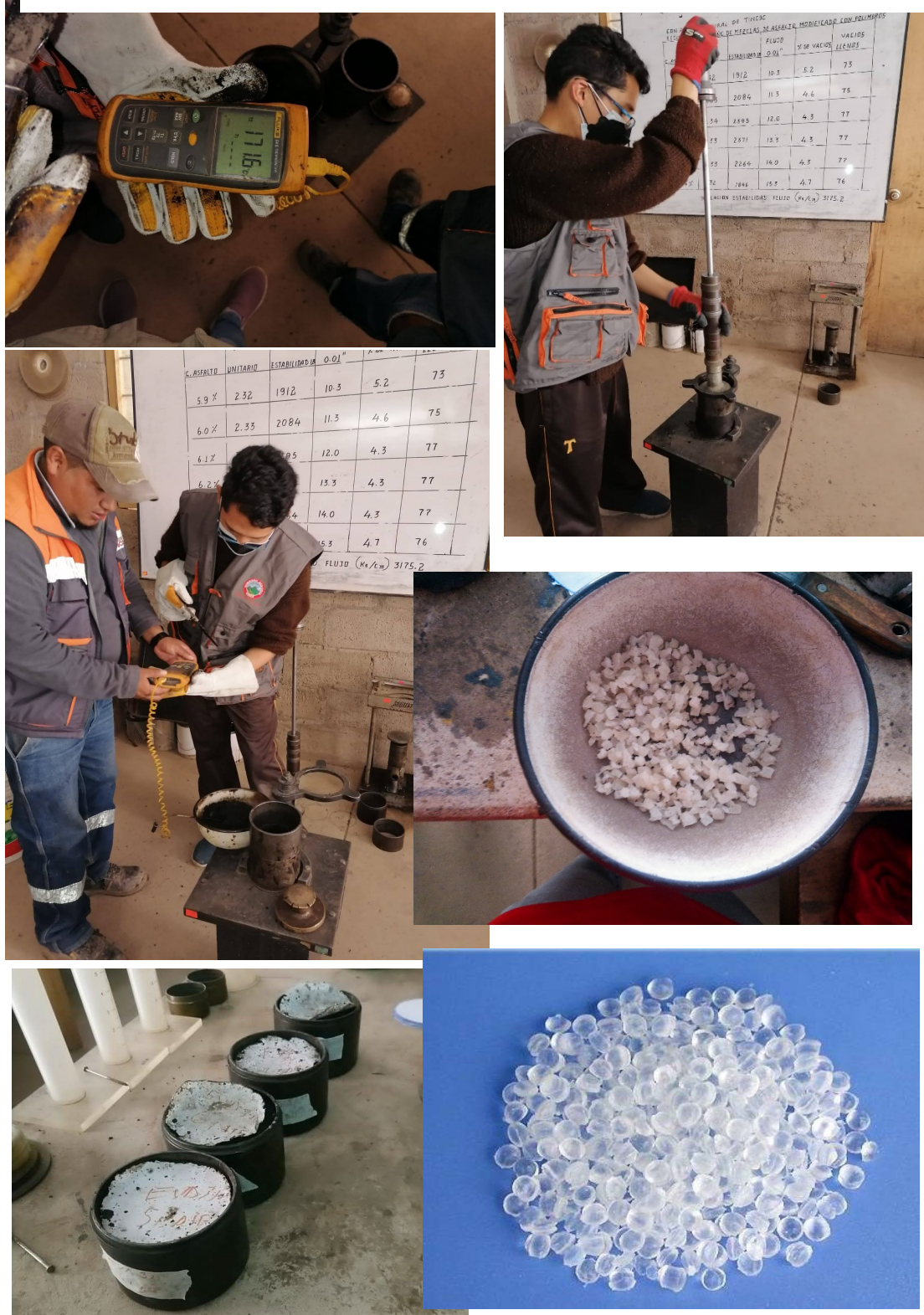
Figura 22: Compactación de especímenes Marshall, polímero EVA, SBR y espécimen final.
