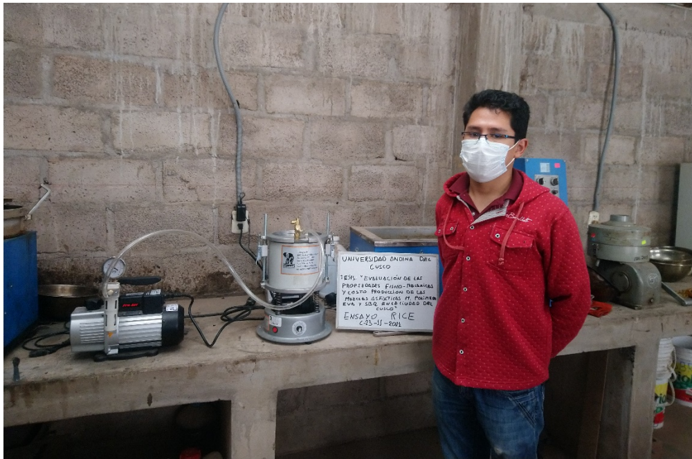
Figura 20: Vibrado y eliminación de aire con la bomba de vacíos.
