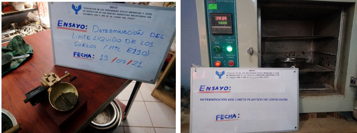
Figura 17: Colocado del material en la copa de Casagrande y la puesta en el horno
