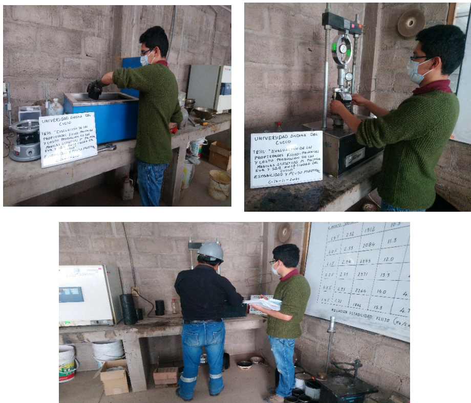
Figura 24: Preparación y evaluación de la estabilidad y flujo Marshall.
