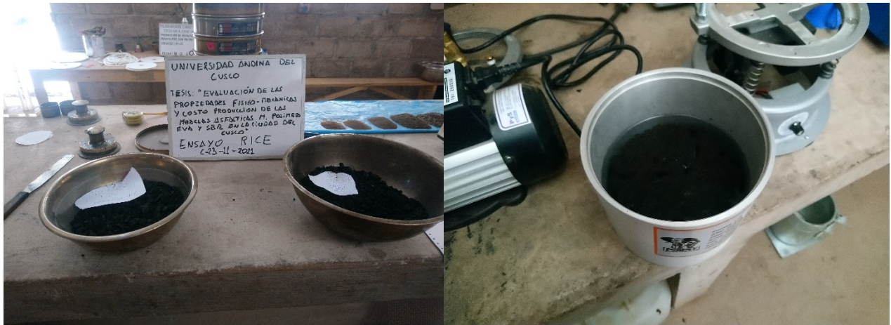
Figura 19: Procedimiento de separado de muestra, pesado, y el llenado de agua a 25 °C.
