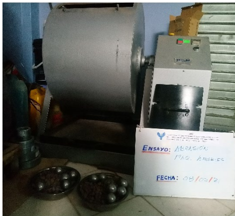
Figura 10: Peso de las muestras y colocación junto con las esferas.
