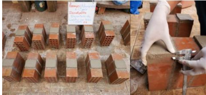
Figura 57: Colocado y rotura de probetas para el ensayo de adherencia a cizalle.
