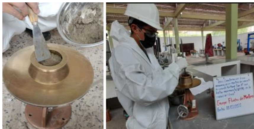
Figura 61: Colocado y apisonado de muestra en la mesa de flujo.
