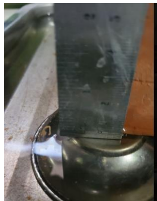
Figura 27: Medición a 3mm de altura del agua succionada sobre soportes metálicos.
