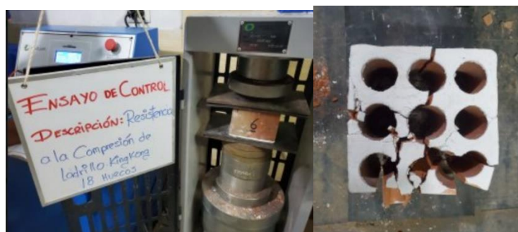
Figura 26: Colocado de muestra en la máquina a compresión.
