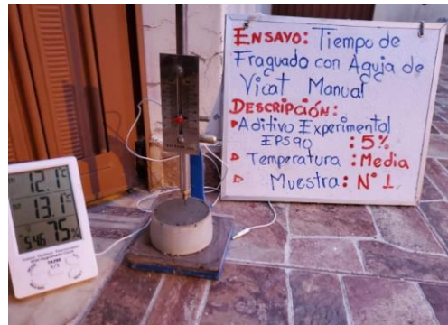
Figura 70: Registro de penetración en mm y temperatura baja del ensayo de tiempo de fraguado.
