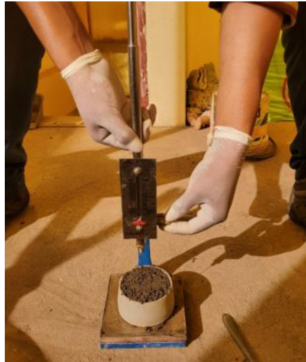
Figura 67: Primera penetración a los 30 min de haber empezado el ensayo de tiempo de fraguado.
