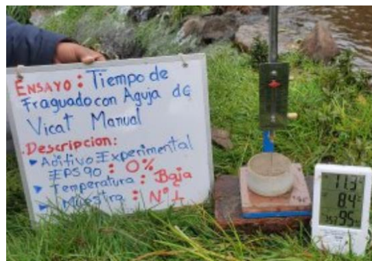
Figura 70: Registro de penetración en mm y temperatura baja del ensayo de tiempo de fraguado.
