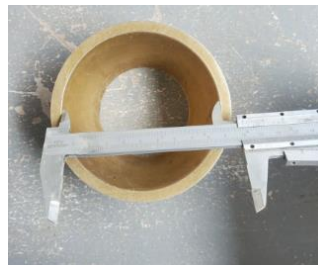
Figura 64: Ensayo de fluidez de mortero en el Laboratorio de Mecánica de Suelos y Materiales de la Universidad Nacional de San Antonio Abad del Cusco.
