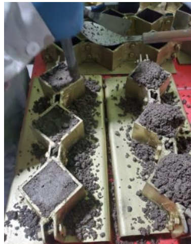
Figura 41: Apisonado de la 2da capa de la muestra para cubos de mortero.
