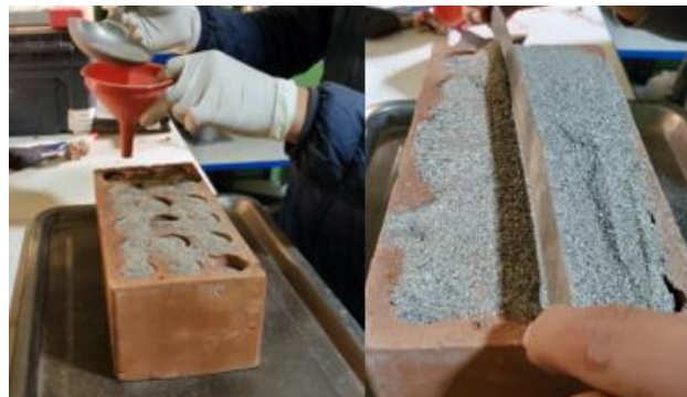
Figura 30: Llenado de vacíos de ladrillo King Kong 18 huecos.
