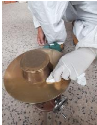
Figura 62: Secado de agua alrededor de molde cónico de la mesa de flujo.
