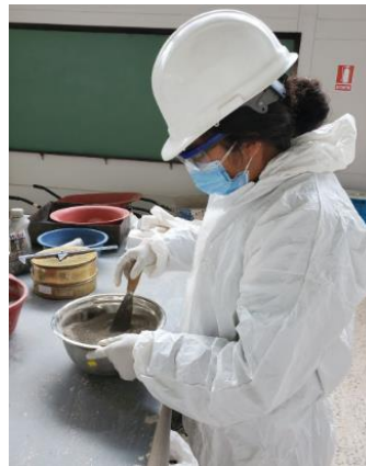
Figura 61: Colocado y apisonado de muestra en la mesa de flujo.
