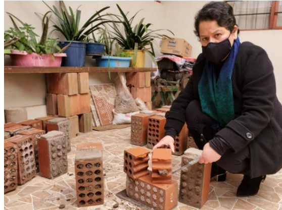
Figura 59: Rotura de ladrillo para percibir el mortero dentro de la muestra
