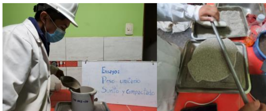
Figura 24: Colocado y enrazado del agregado en el molde volumétrico.
