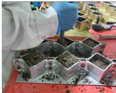
Figura 40: Apisonado de la 1ra capa de la muestra para cubos de mortero.
