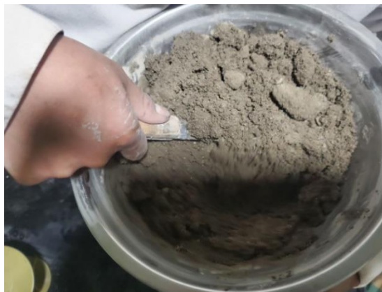
Figura 37: Preparación de mezcla con aditivo experimental EPS90.
