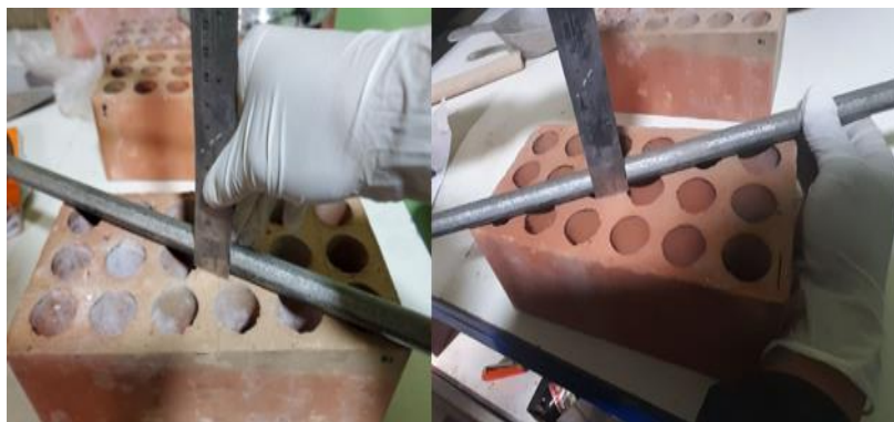
Figura 29: Medición de alabeo en los ladrillos.
