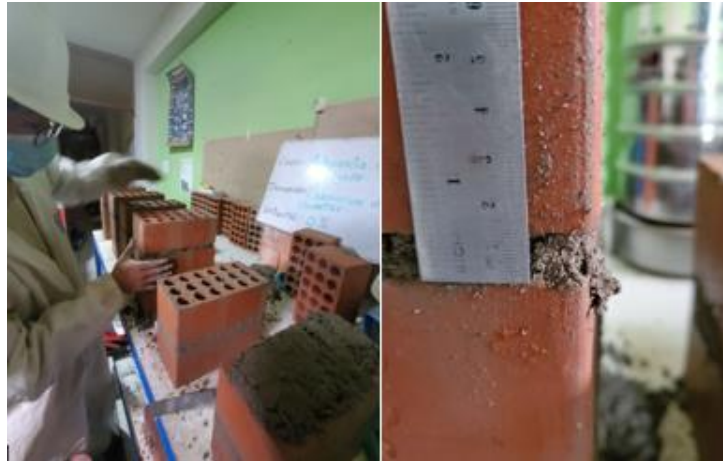
Figura 50: Medición de junta de mortero entre ladrillos.
