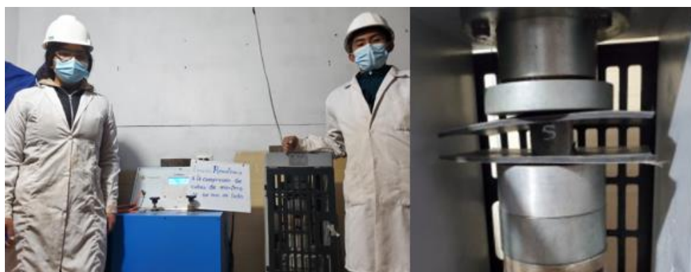
Figura 46: Colocado de cubos de mortero en la maquina a compresión.
