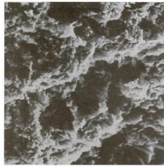
Figura 14: Vista microscopica de textura de ladrillo de arcilla.
