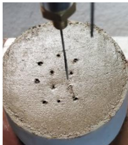
Figura 71: Penetraciones en el mortero
