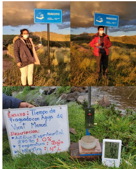
Figura 6: Ensayo de tiempo de fraguado en la comunidad de Huaccoto a temperaturas bajas.
