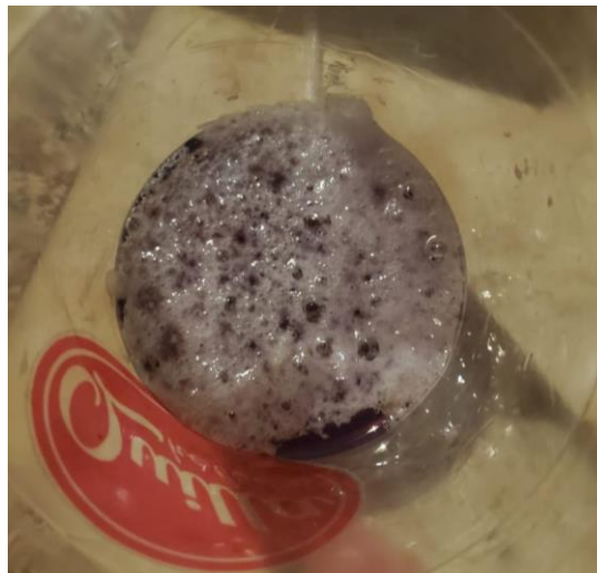
Figura 34: Poliestireno expandido disuelto en gasolina de 90.
