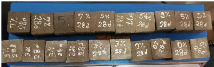
Figura 45: Medición de cubos de mortero.
