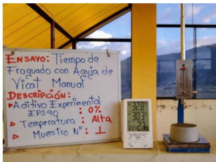
Figura 68: Registro de penetración en mm y temperatura alta del ensayo de tiempo de fraguado.
