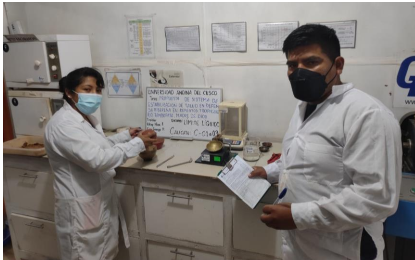
Figura 44: Colocado de la pasta en la cuchara de la Copa Casagrande
