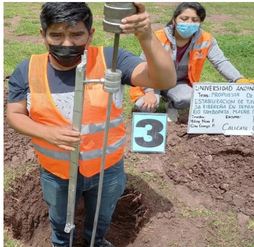
Figura 55: Auscultación de suelo con equipo penetrómico ligero
