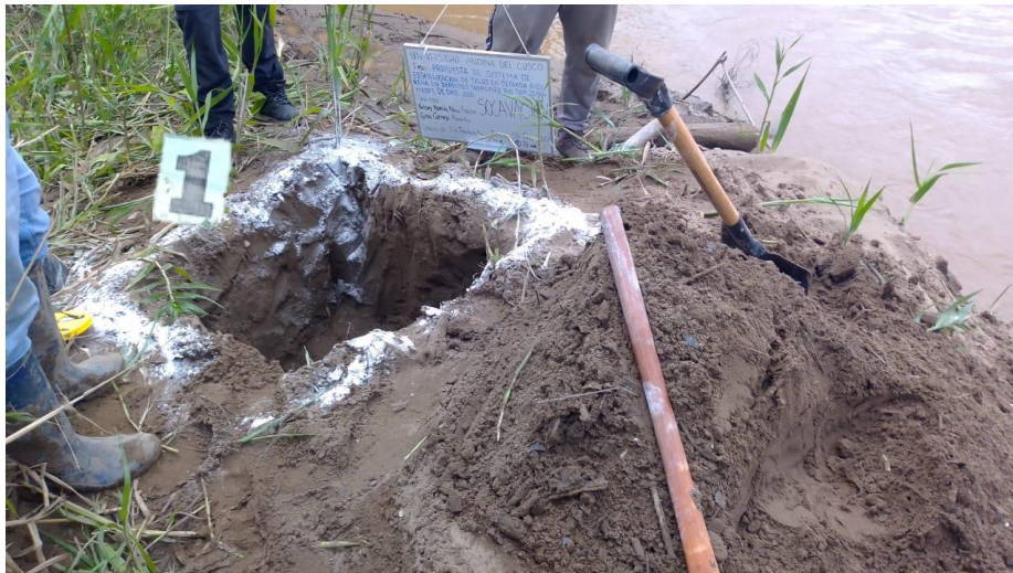
Figura 54: Calicata excavada a 1.00 m para ensayo DPL
