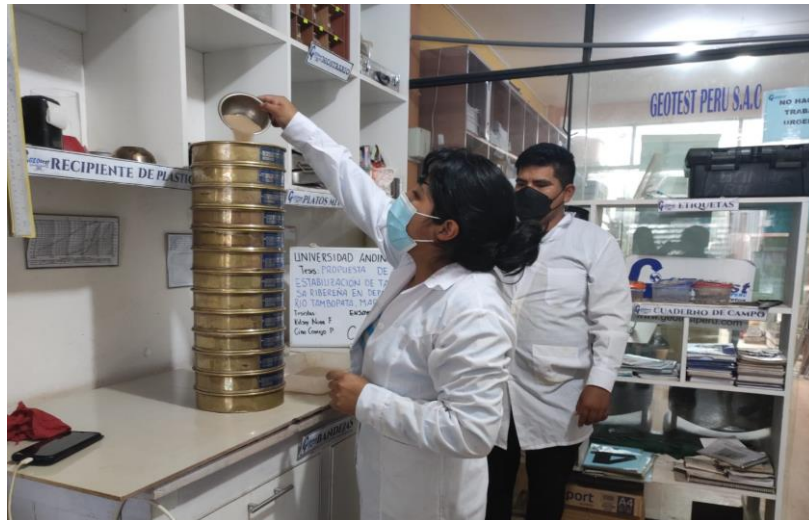
Figura 41: Puesta de muestra pesada en juego de tamices
