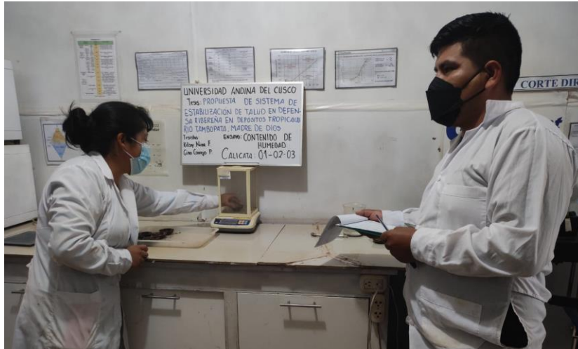
Figura 36: Pesado del recipiente con el material húmedo y su respectivo registro
