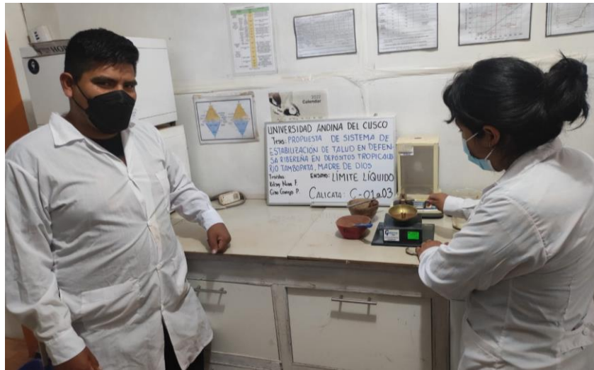
Figura 46: Revoluciones en la Copa Casagrande hasta juntar las partes separadas
