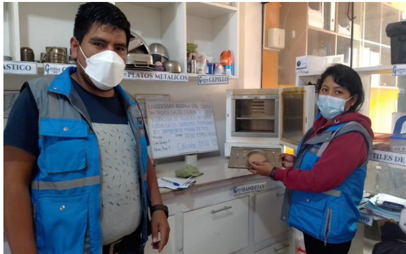
Figura 53: Material introducido en el horno por un lapso de 24 horas para luego ser pesado.
