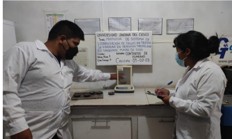
Figura 38: Pesado final de las muestras secas retiradas del horno Fuente: Elaboración propia
