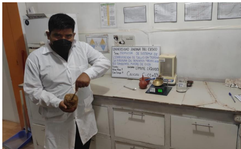
Figura 43: Preparación de la muestra convertida en pasta
