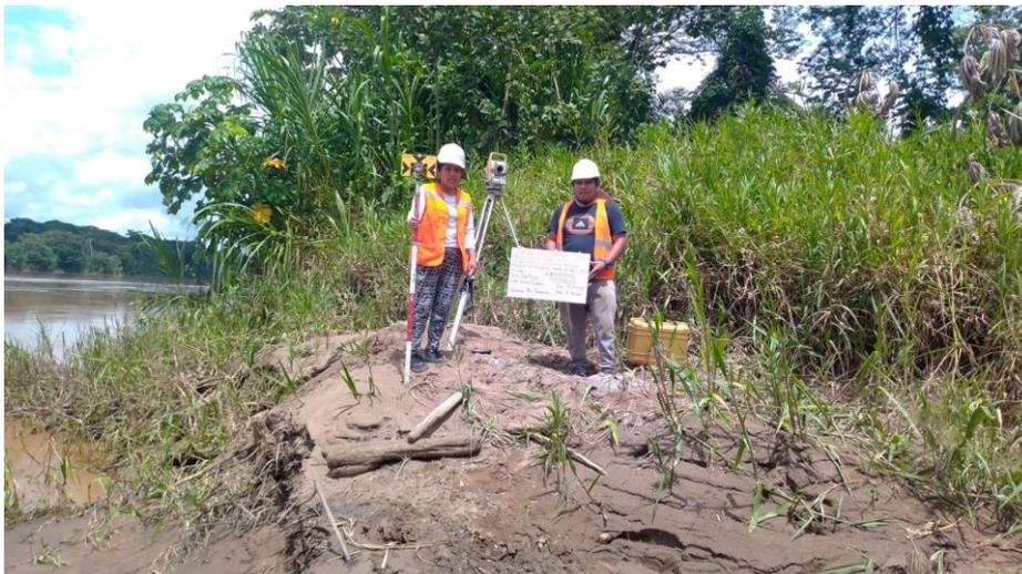
*Figura 31: Estacionamiento del equipo para levantamiento topográfico*
