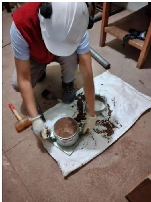
**Figura 32. Compactado del molde Proctor**
