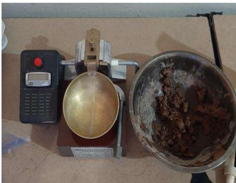
**Figura 26. Equipos para ensayo de Limite Liquido**
