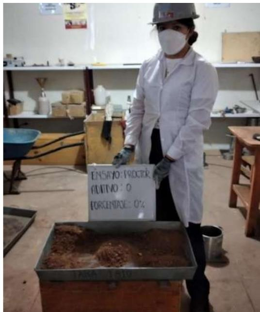
**Figura 31.** *Mezcla del material con el agua a diferentes porcentajes*
