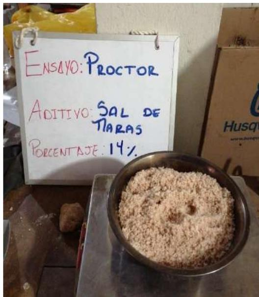
*Figura 34. Mezcla del material con los aditivos a diferentes porcentajes*
