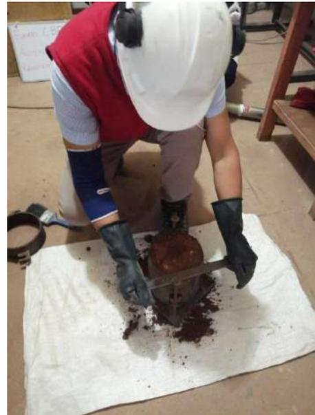
**Figura 36.** *Compactado y enraizado de la muestra*
