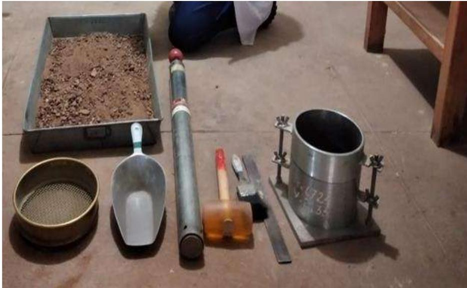
*Figura 29. Equipos para ensayo de Proctor Modificado*
