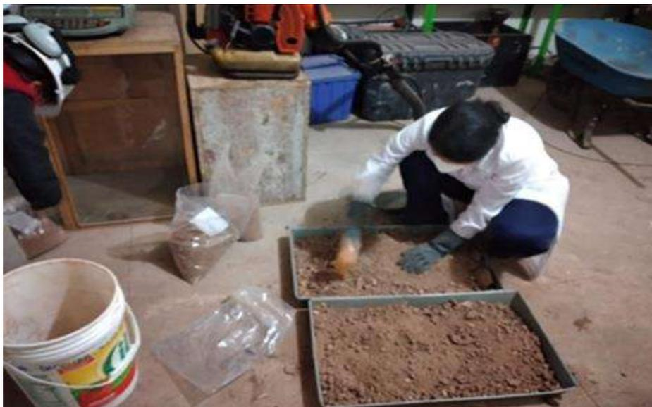
*Figura 30. Trituración del material*
