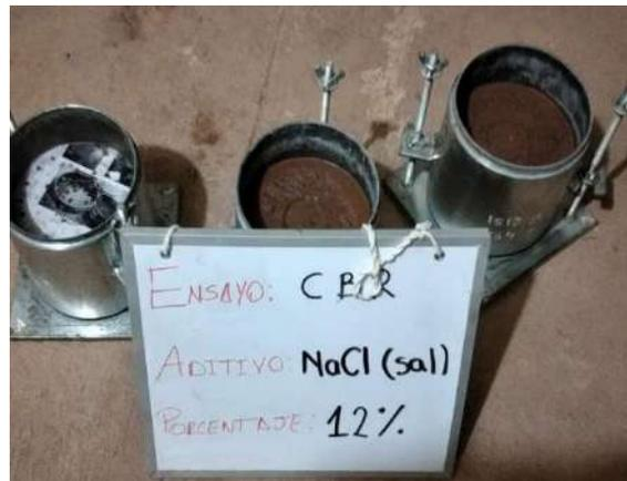
**Figura 40. Moldes húmedos después de 96 horas sumergidos en agua**
