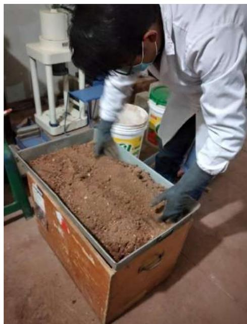
*Figura 35. Trituración y mezclado del material*
