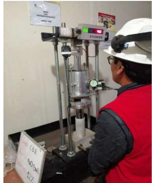
**Figura 41. Penetración de moldes CBR**
