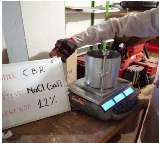
*Figura 37. Peso de la muestra compactada y el molde*
