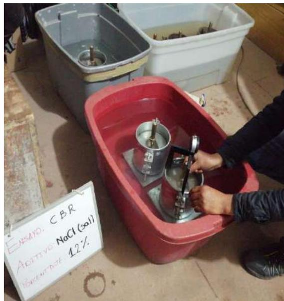
**Figura 39. Moldes sumergidos con diferentes porcentajes de aditivos**
