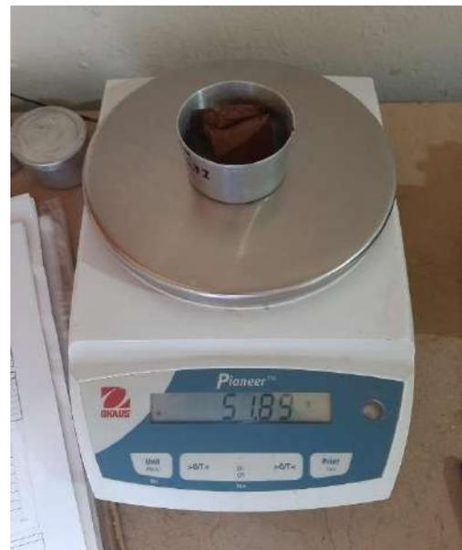
*Figura 27. Ensayo de Limite Liquido del suelos adicionado con los diferentes porcentajes de Oxido de Calcio y Cloruro de Sodio*
