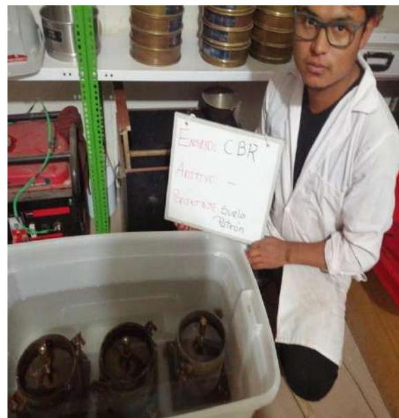
**Figura 38. Moldes compactados y sumergidos en agua**
