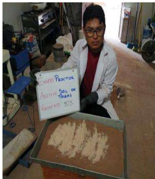
**Figura 33. Mezcla del material con los aditivos a diferentes porcentajes**
