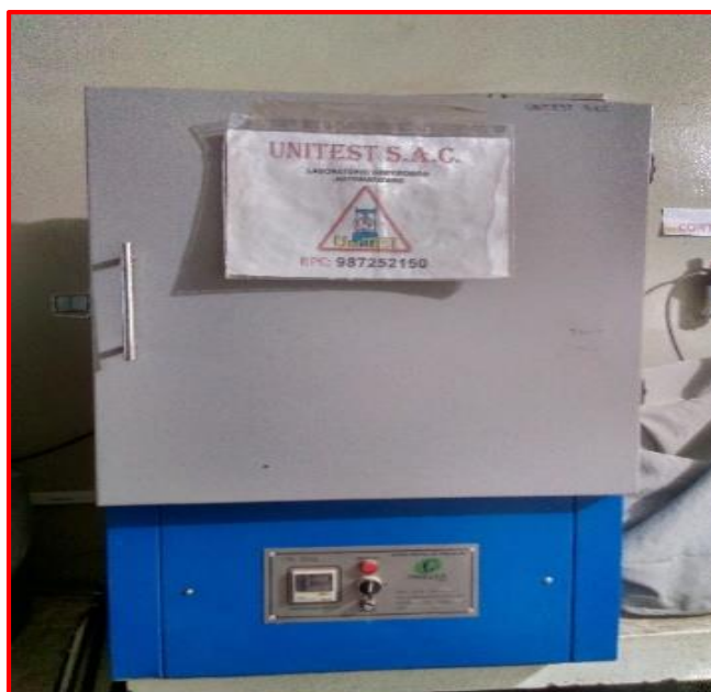
Figura 40: Horno de secado. ( T^{\circ} = 110^{\circ} \text{C} \pm 5^{\circ} \text{C} )
