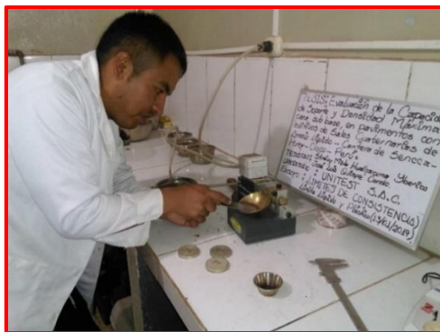
Figura 55: Colocación de muestra en la copa Casagrande.
