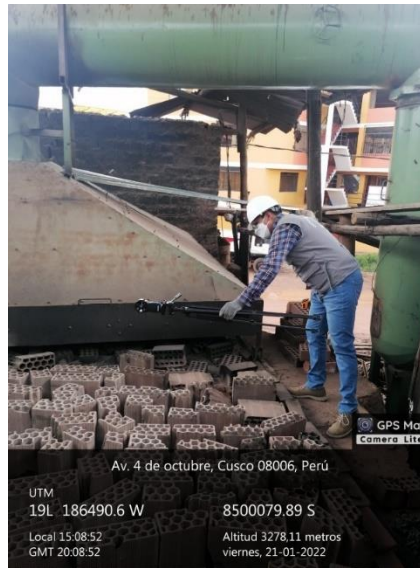
Imagen 13: Medición del flujo de salida de manera vertical
