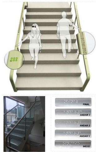
Figura 176. Barandas metálicas con sistema braille.
