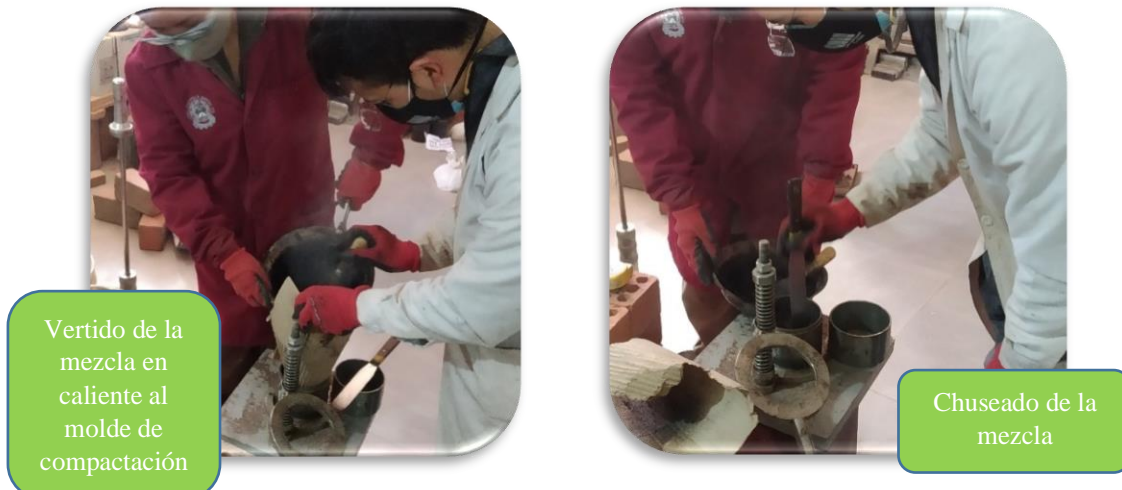
Figura 88: Vertido y chuseado de la mezcla asfáltica en caliente.
