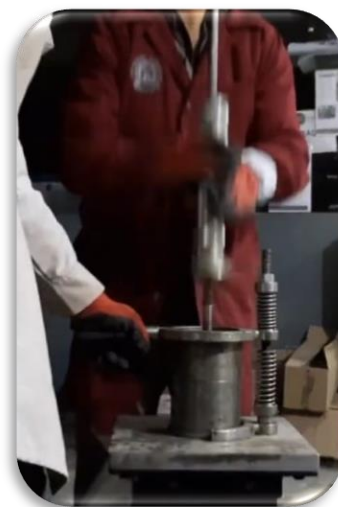
Figura 98: Compactación de la mezcla asfáltica modificada en caliente.
