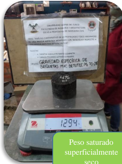
Figura 104: Peso de espécimen saturado superficialmente seco.
