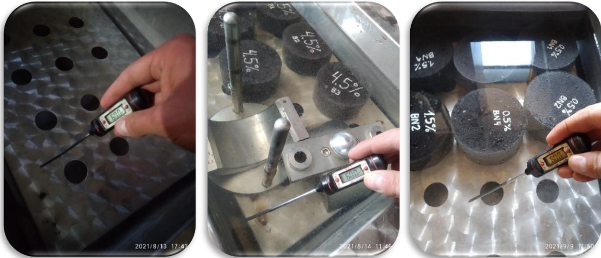
Figura 106: Colocado de especímenes en el baño María a 60°C durante 30 a 40 minutos.
