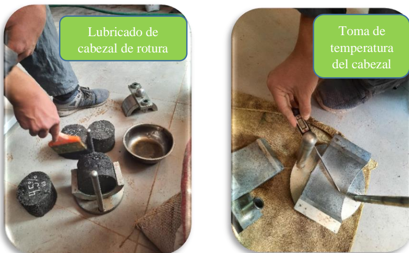
Figura 107: Lubricado y toma de temperatura del cabezal de rotura Marshall.
