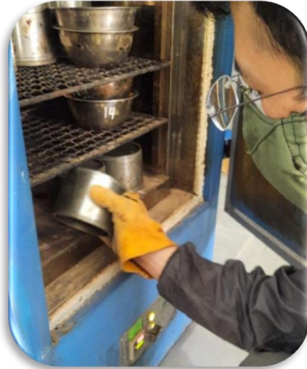
Figura 92: Colocación de agregados y moldes al horno.
