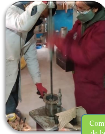
Figura 89: Compactación de la mezcla asfáltica en caliente.
