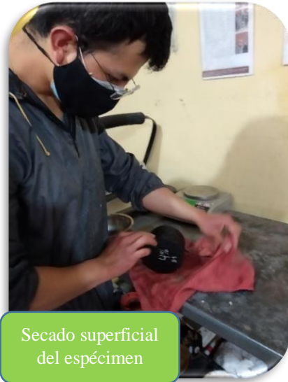
Figura 104: Peso de espécimen saturado superficialmente seco.
