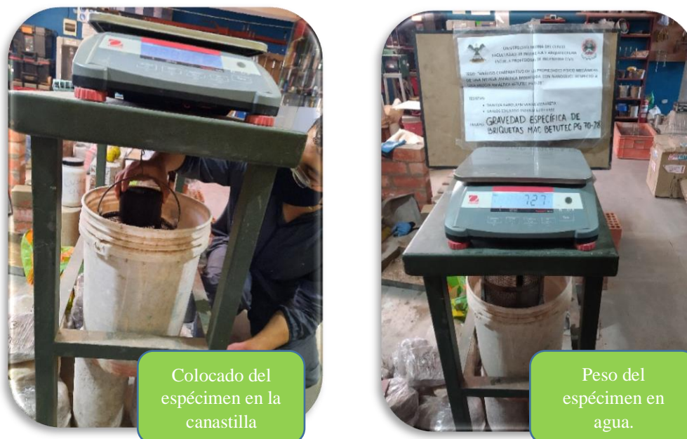
Figura 103: Peso del espécimen en agua.
