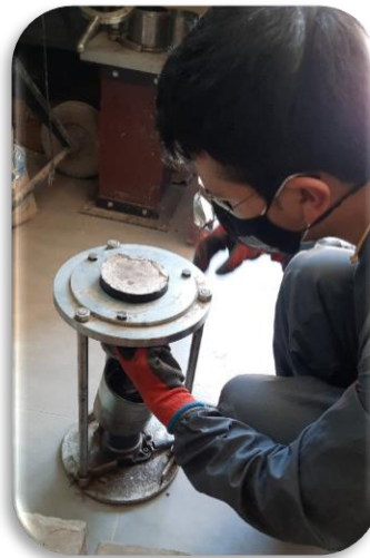
Figura 90: Extracción de espécimen asfáltico del molde con el eyector.
