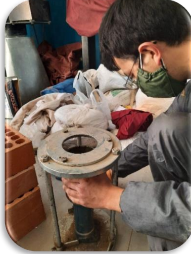
Figura 99: Extracción de espécimen asfáltico modificado del molde con el eyector.
