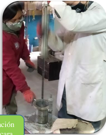
Figura 89: Compactación de la mezcla asfáltica en caliente.
