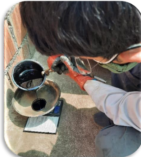
Figura 93: Pesaje del ligante asfáltico BETUTEC PG 70-28
