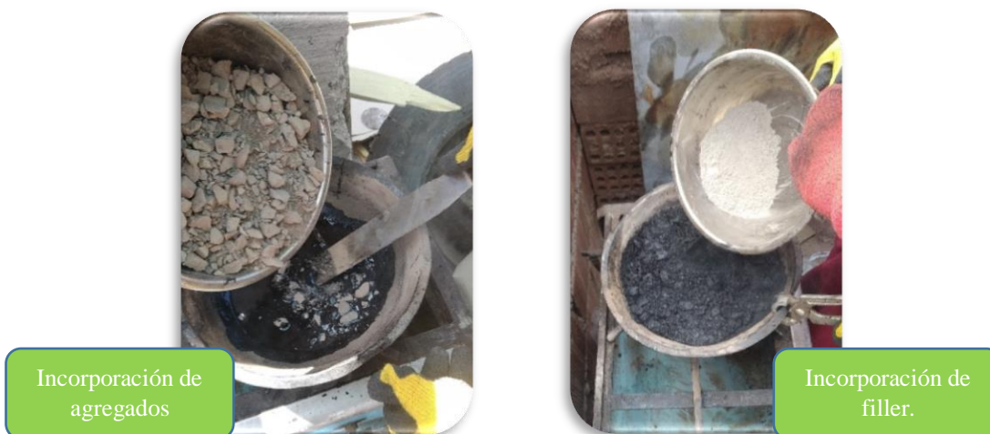
Figura 95: Incorporación de agregados.
