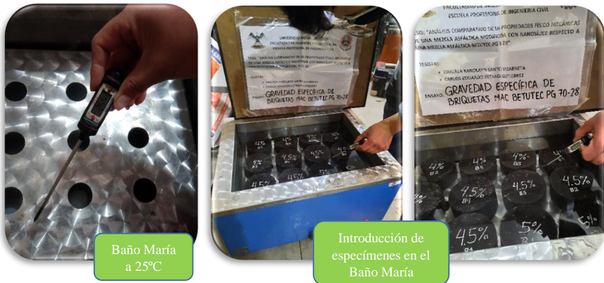
Figura 102: Introducción de especímenes al baño María a 25°C.
