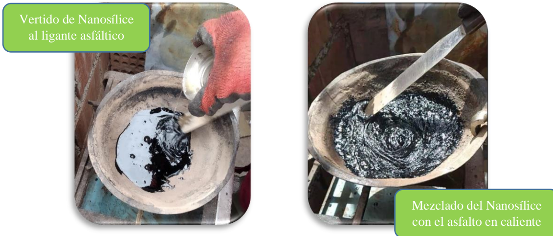
Figura 94: Incorporación de Nanosílice en el ligante asfáltico.
