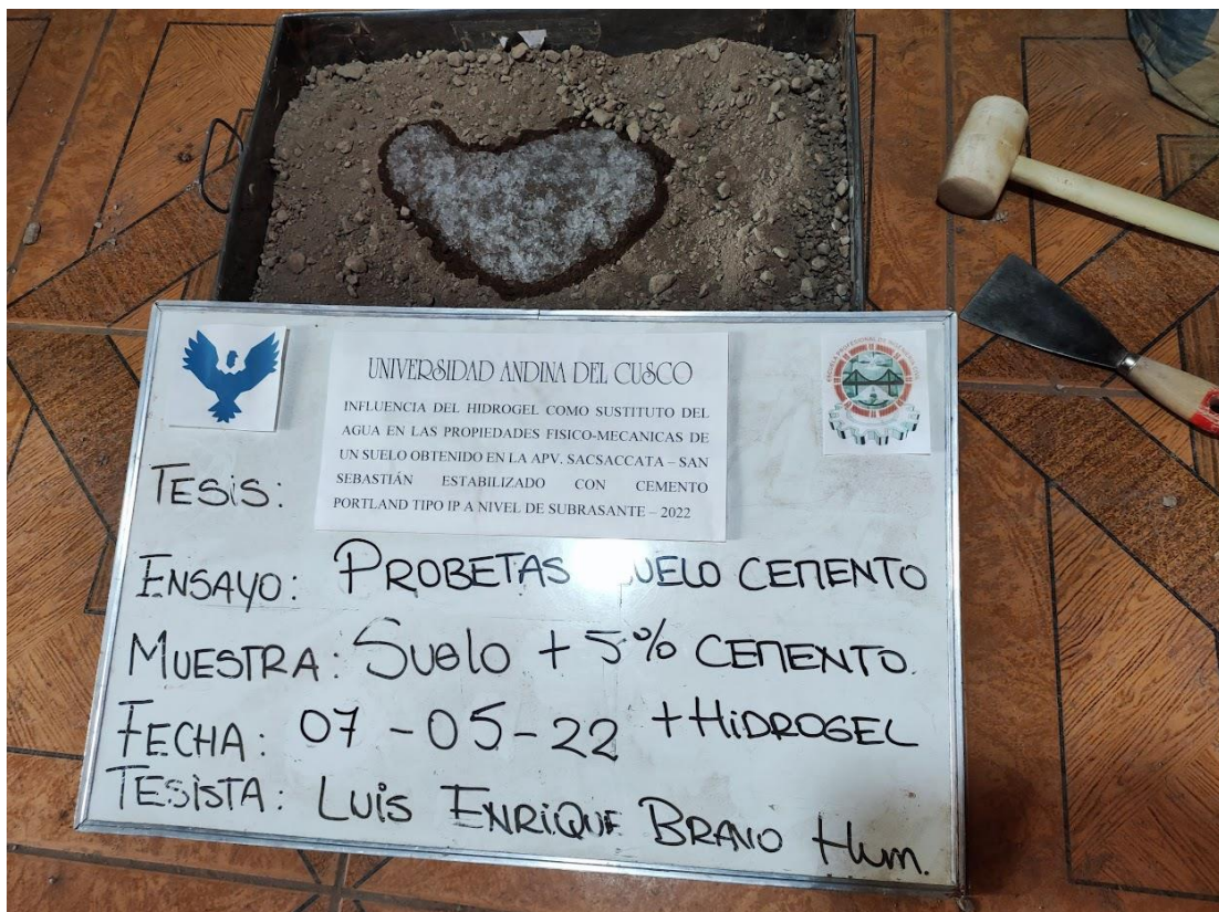
Figura 48. Mezclado de material para probetas de suelo cemento
