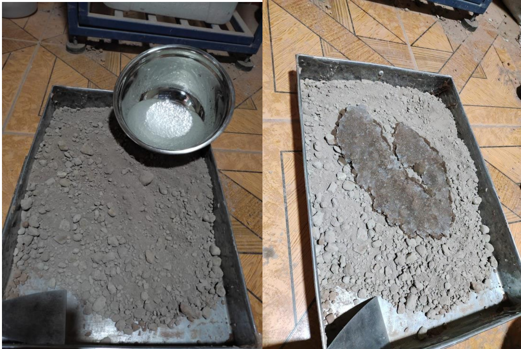
Figura 54. Preparación de la muestra con adición de hidrogel.
