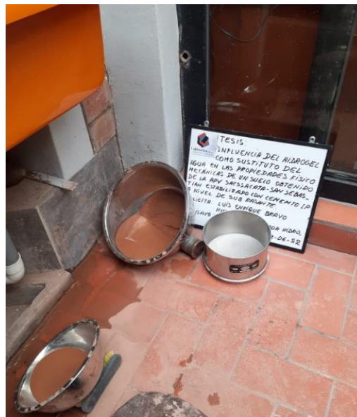
Figura 31. Lavado de Material Pasante de la Malla #200.
