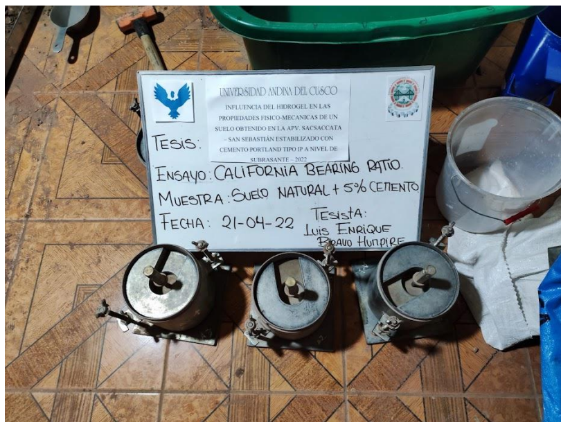
Figura 58. Colocación de pesas previo a sumersión.
