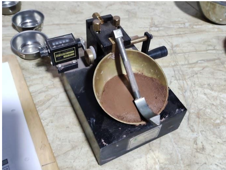
Figura 36. División de la masa con el acanalador.
