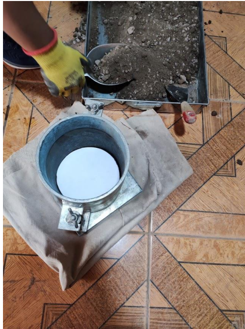
Figura 57. Colocación de Papel filtro.
