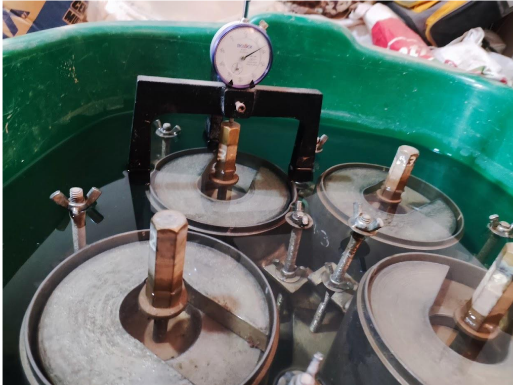
Figura 59. Lectura de dial para expansión.
