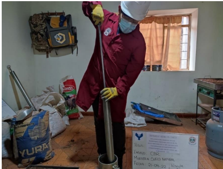
Figura 55. Compactación de la muestra de CBR.
