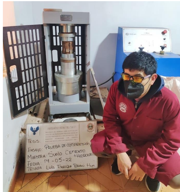
Figura 53. Ruptura de Probetas de Suelo Cemento.
