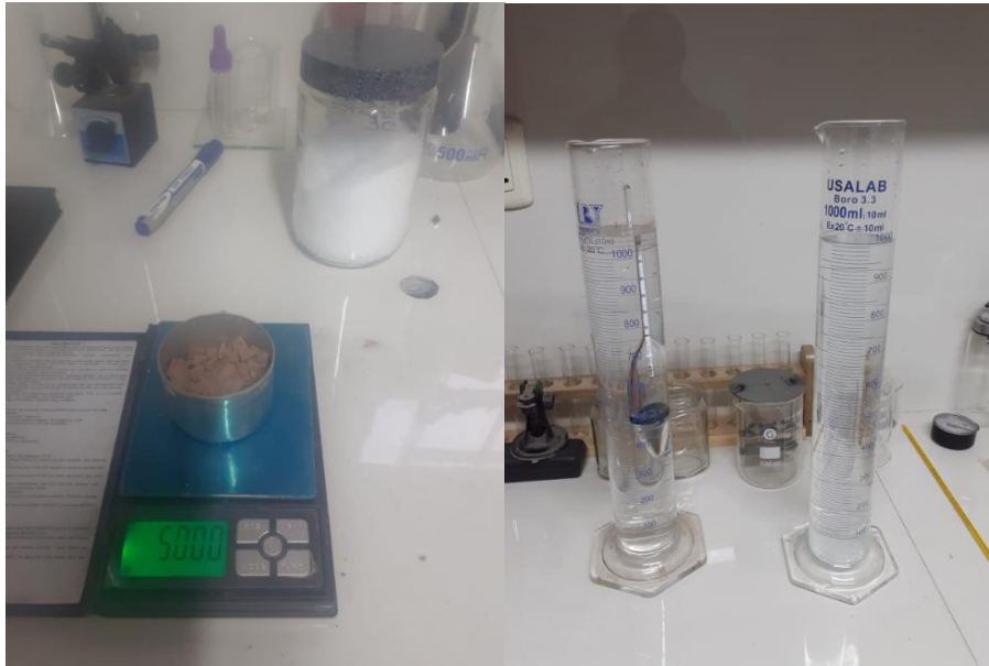
Figura 32. Preparación de Suelo y Solución con Hexametáfosfato de Sodio.
