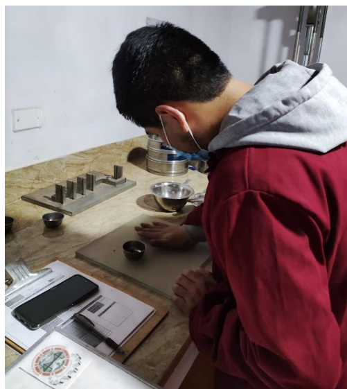
Figura 40. Proceso de obtención de cilindros para Límite Plástico.
