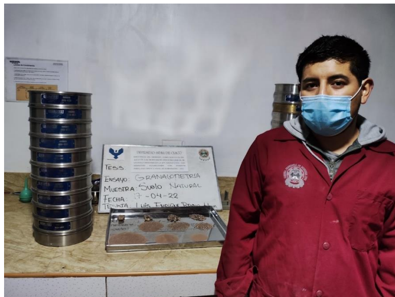
Figura 30. Muestras retenidas en tamices.
