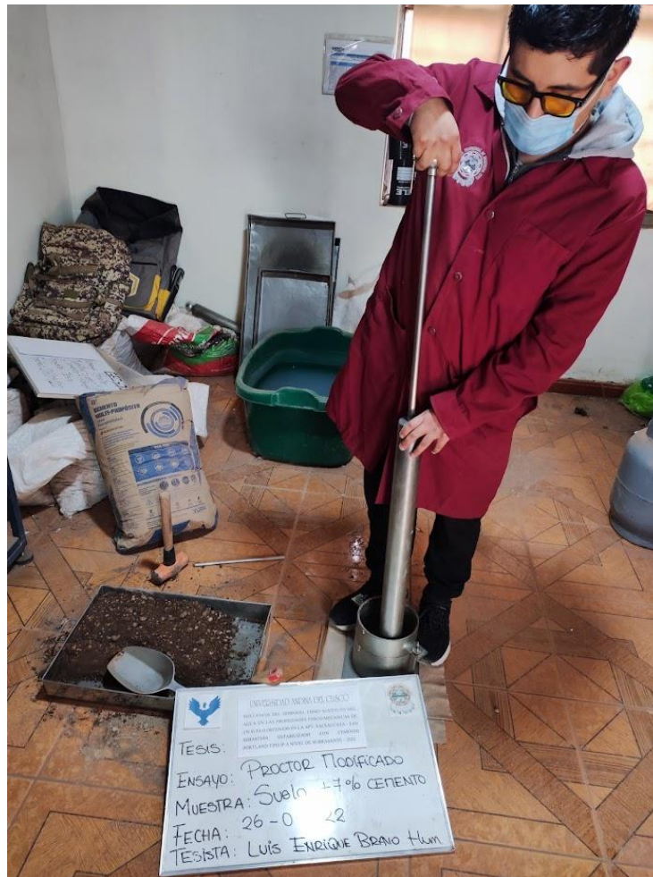
Figura 46. Proceso de Compactación a 5 capas cada una de 56 golpes.
