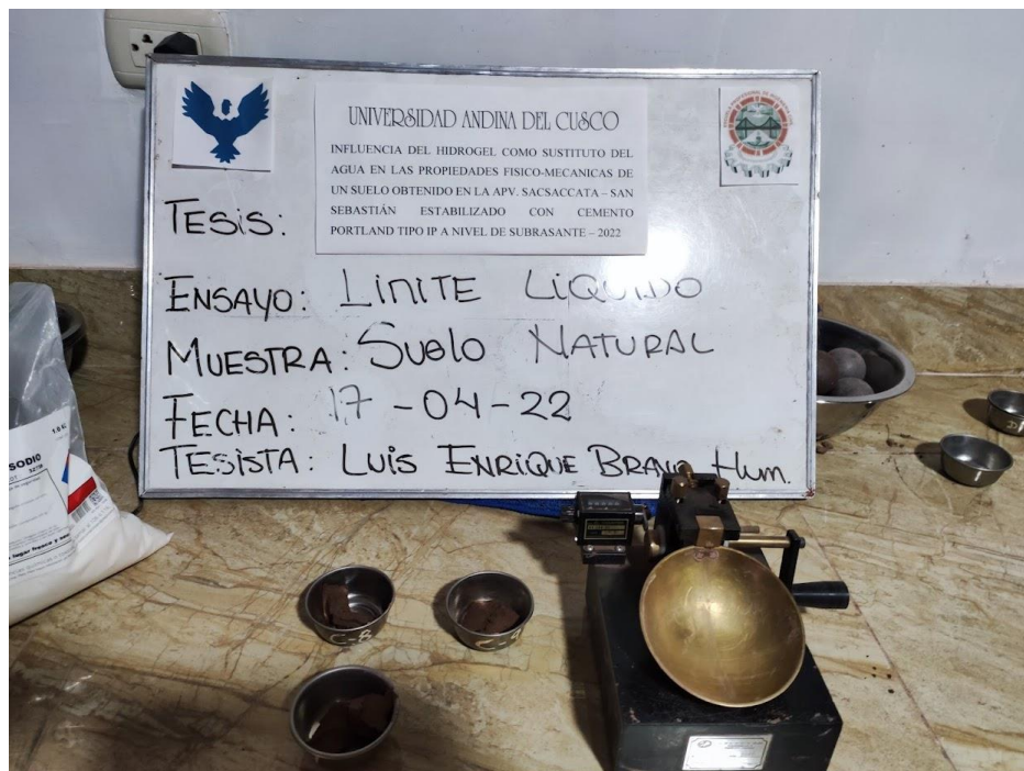
Figura 39. Muestras recogidas para determinar el contenido de humedad - Límite Líquido.
