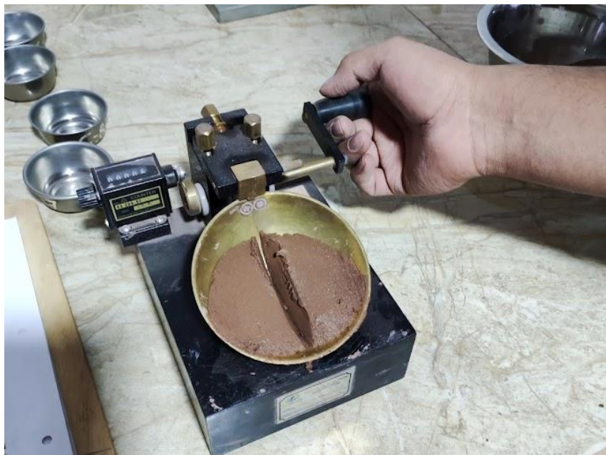
Figura 37. Manipuleo de cuchara de casa grande.
