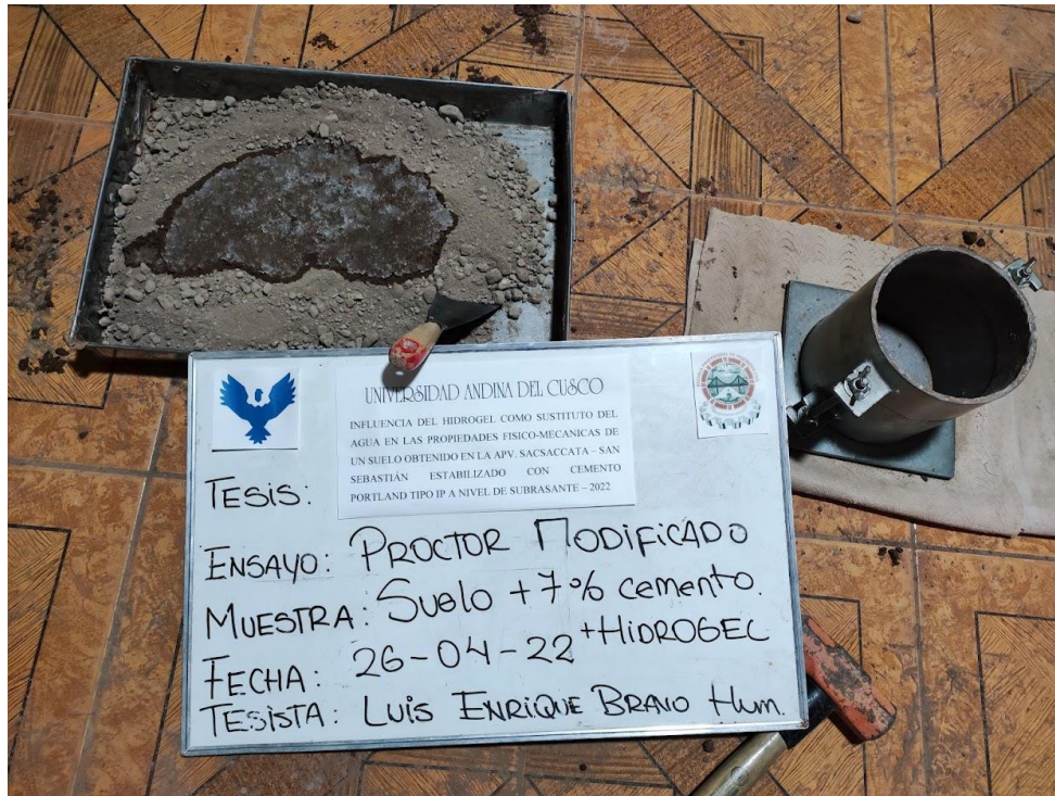
Figura 45. Preparación de la muestra con hidrogel.
