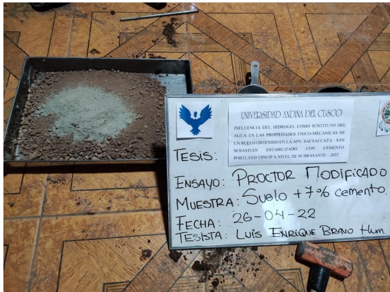
Figura 44. Preparación de la muestra con cemento.
