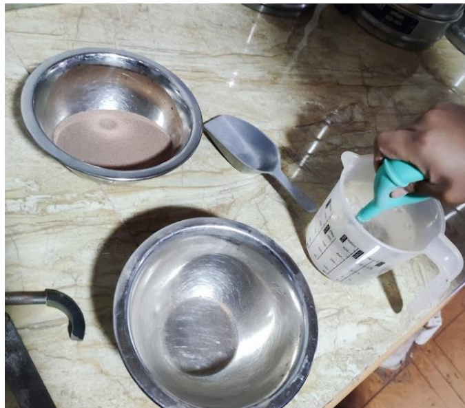
Figura 34. Muestra pasante por la malla #40.
