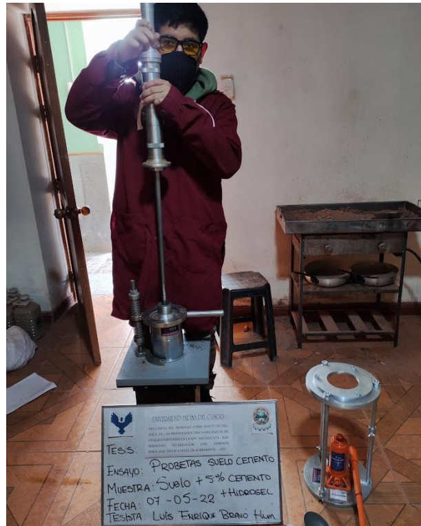
Figura 49. Compactación de muestra.
