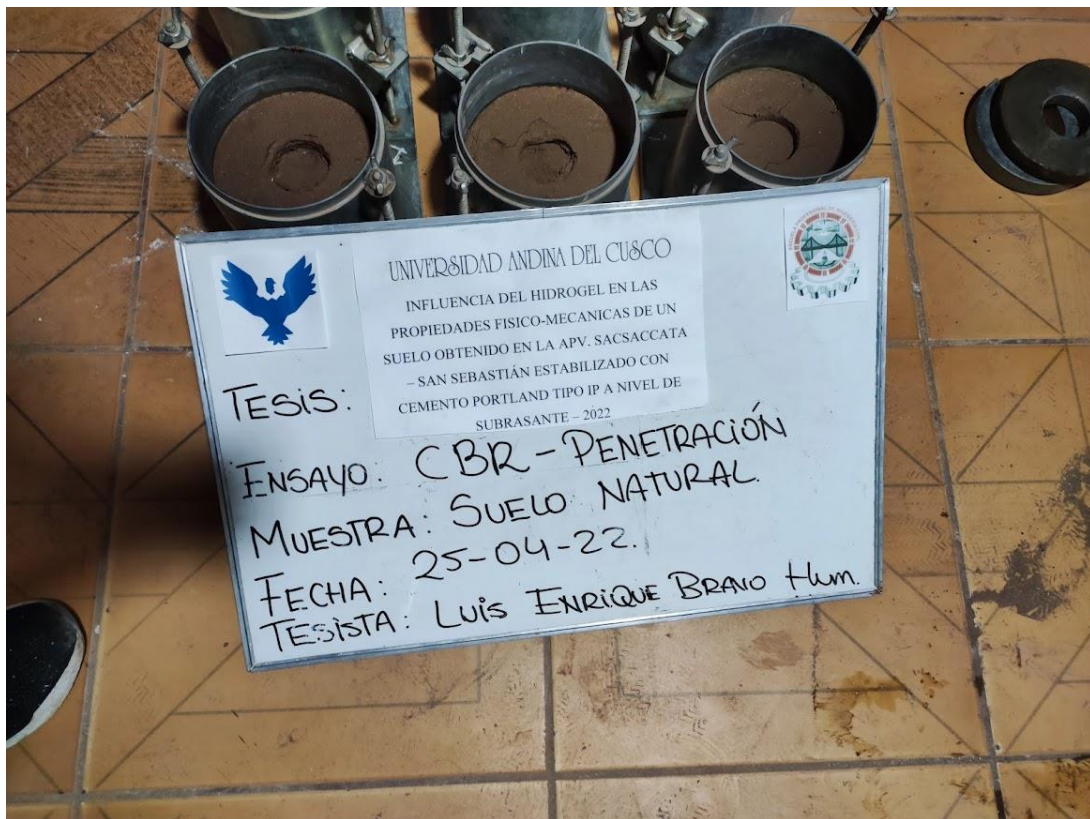
Figura 63. Moldes después de ser sometidos a esfuerzo.
