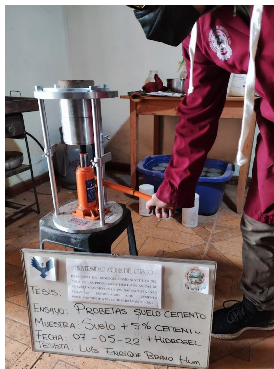
Figura 50. Extracción de Probetas de Suelo Cemento.
