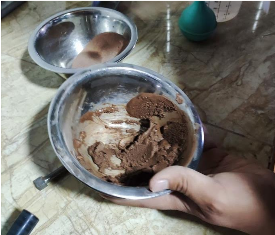
Figura 35. Amasado de la muestra previamente tamizada.
