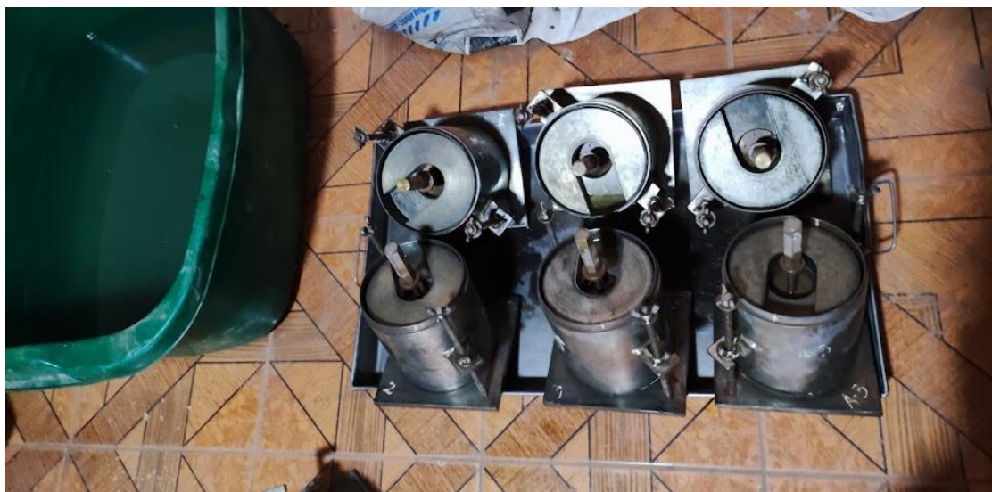
Figura 61. Escurrimiento de Moldes CBR.
