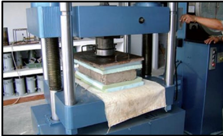
Figura 22: Ensayo de resistencia a la compresión
