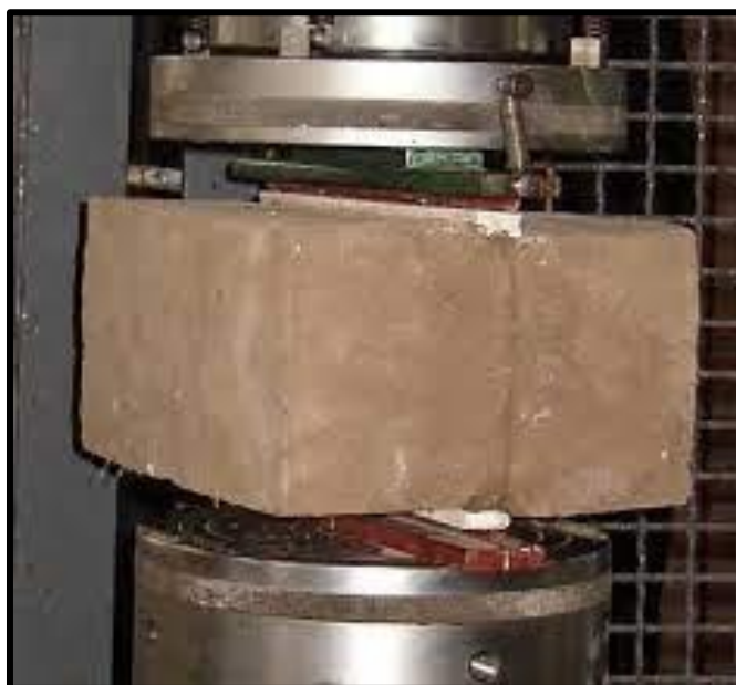
Figura 23: Ensayo de resistencia a la tracción por flexión
