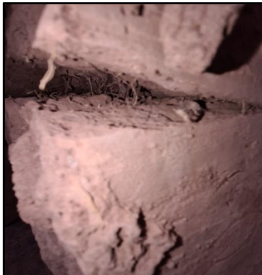
Fibra de cabuya después de ensayo
