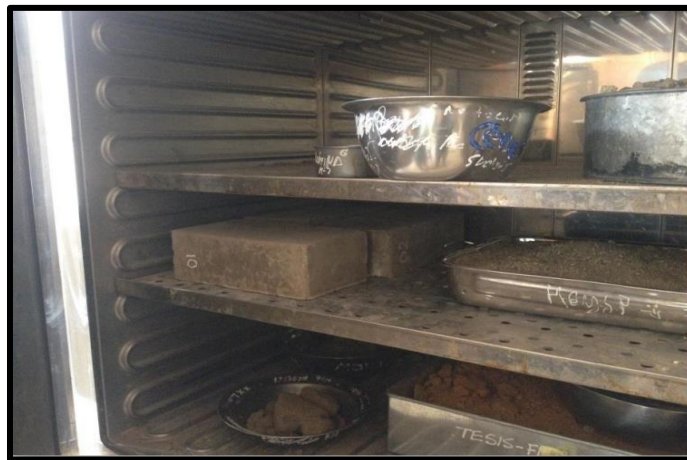
Figura 18: Secado de adobe al horno
