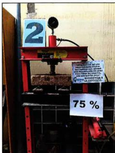
MUESTRA DE ADOBE N° 02 Vista de la muestra de adobe durante el Ensayo de Tracción.
