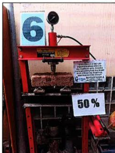
MUESTRA DE ADOBE N° 06 Vista de la muestra de adobe durante el Ensayo de Tracción.
