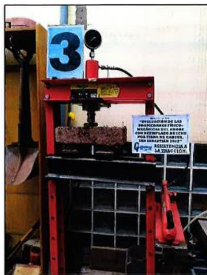
MUESTRA DE ADOBE N° 03 Vista de la muestra de adobe durante el Ensayo de Tracción.
