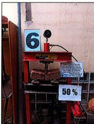
MUESTRA DE ADOBE N° 06 Vista de la muestra de adobe después el Ensayo de Tracción.
