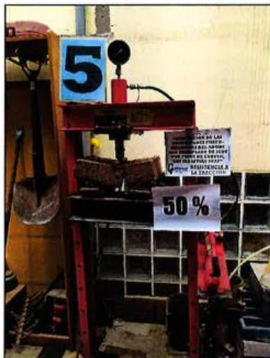
MUESTRA DE ADOBE Nº 05 Vista de la muestra de adobe después el Ensayo de Tracción.
