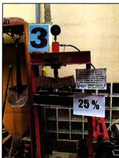
MUESTRA DE ADOBE N° 03 Vista de la muestra de adobe después el Ensayo de Tracción.
