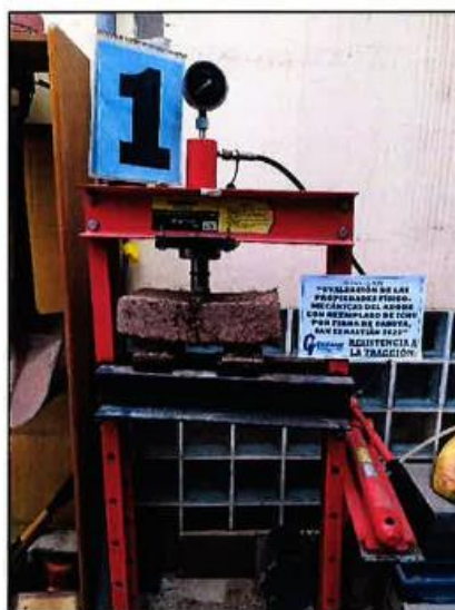
MUESTRA DE ADOBE N° 01 Vista de la muestra de adobe después el Ensayo de Tracción.
