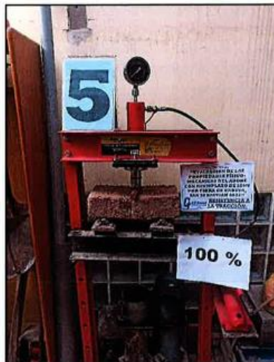
MUESTRA DE ADOBE N° 05 Vista de la muestra de adobe después el Ensayo de Tracción.
