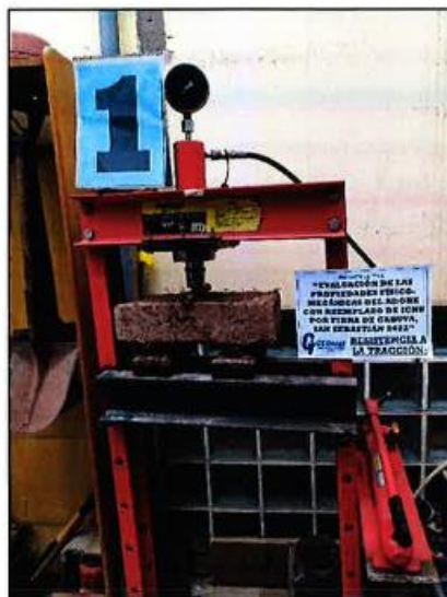
MUESTRA DE ADOBE N° 01 Vista de la muestra de adobe durante el Ensayo de Tracción.
