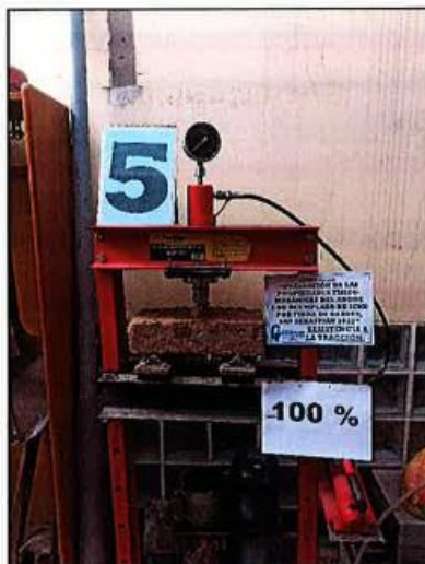
MUESTRA DE ADOBE N° 05 Vista de la muestra de adobe durante el Ensayo de Tracción.
