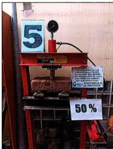
MUESTRA DE ADOBE Nº 05 Vista de la muestra de adobe durante el Ensayo de Tracción.
