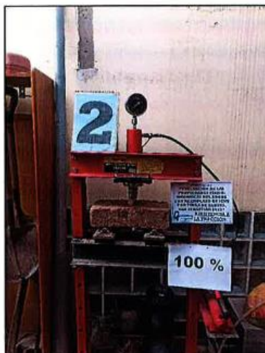
MUESTRA DE ADOBE Nº 02 Vista de la muestra de adobe durante el Ensayo de Tracción.
