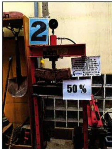
MUESTRA DE ADOBE N° 02 Vista de la muestra de adobe después el Ensayo de Tracción.
