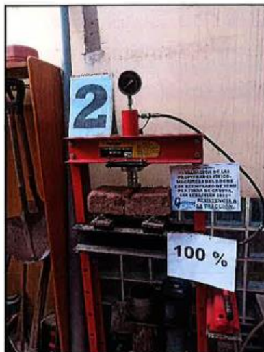
MUESTRA DE ADOBE Nº 02 Vista de la muestra de adobe después el Ensayo de Tracción.
