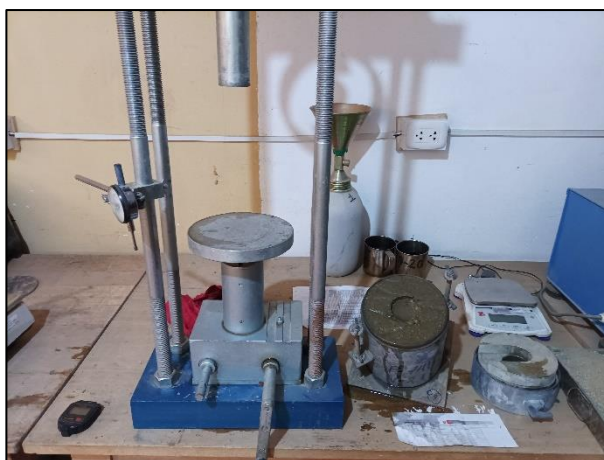
Penetración de Muestras de CBR
