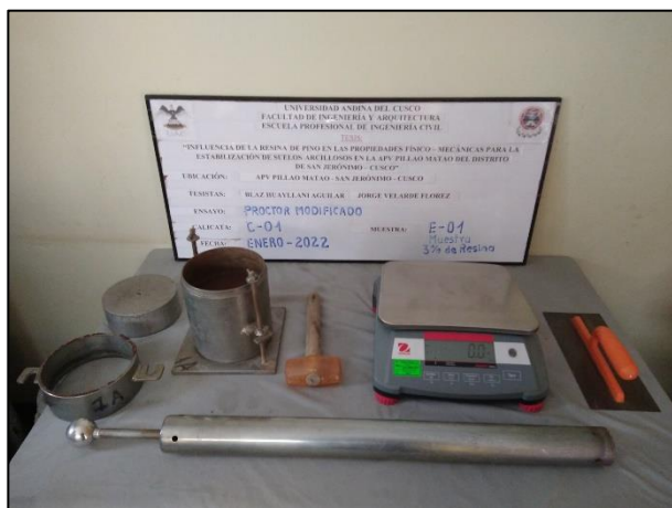
Ensayo de Proctor con 03% de Colofonia
