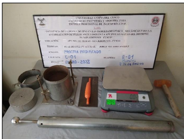
Ensayo de Proctor con 07% de Colofonia
