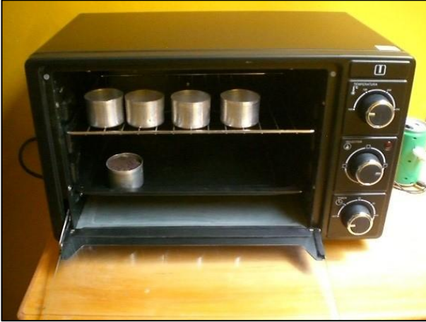
Control de Humedades
