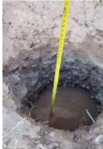
Figura 40: Tomando medidas del descenso del agua
