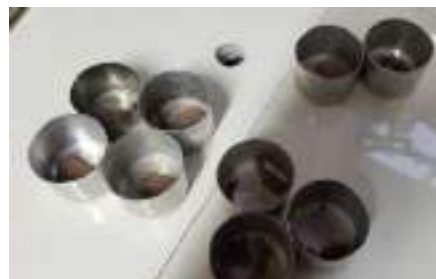
Figura 52: Muestras obtenidas durante el ensayo de límite plástico
