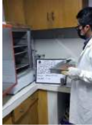
Figura 43: Coloca la muestra lavada en el horno
