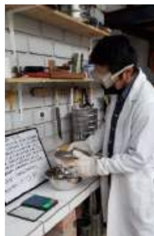
Figura 44: Realizando el tamizado manual de la muestra
