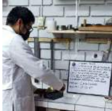
Figura 49: Girando la manivela de la cuchara de Casagrande y contando el número de golpes
