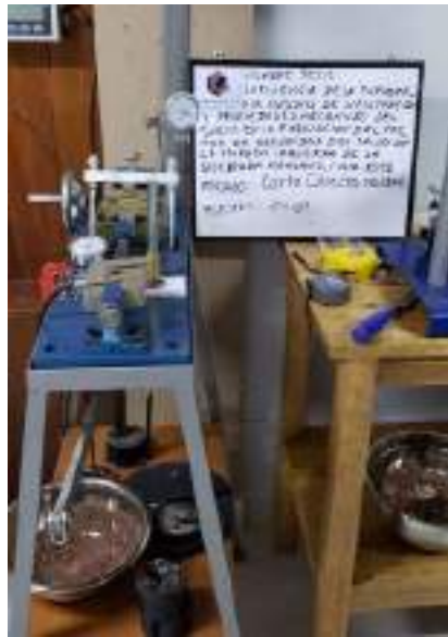
Figura 54: Preparando la máquina de corte directo para el ensayo
