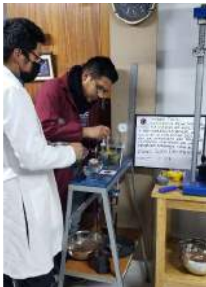
Figura 53: Colocando la muestra en la caja de corte
