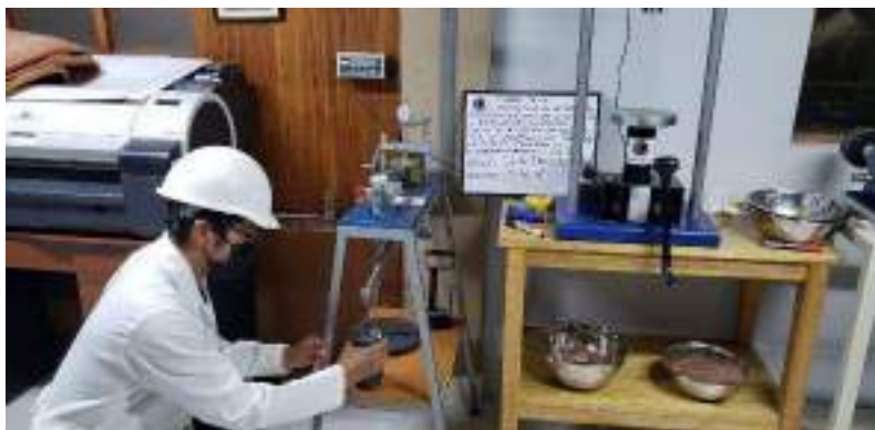
Figura 55: Colocando la carga normal en la máquina de corte directo
