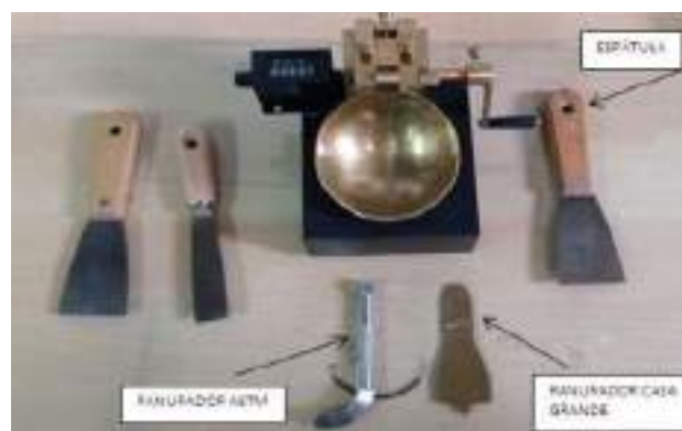
Figura 17: Equipo para la realización del ensayo de límite líquido
