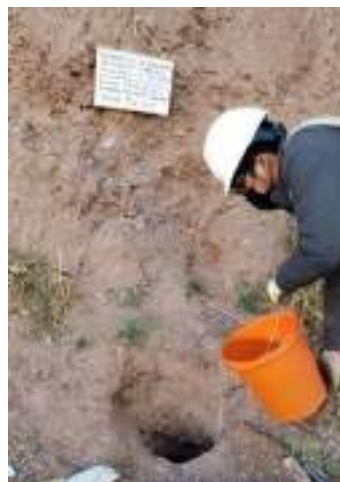
Figura 39: Llenando el pozo con agua
