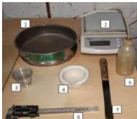
Figura 19: Equipo para la realización del ensayo de límite plástico
