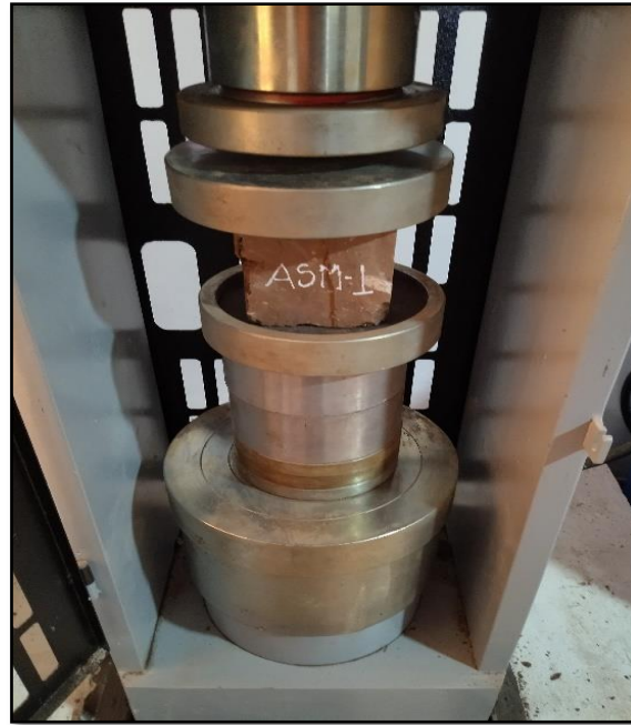
Figura 86: Equipo de Compresión Neopreno
