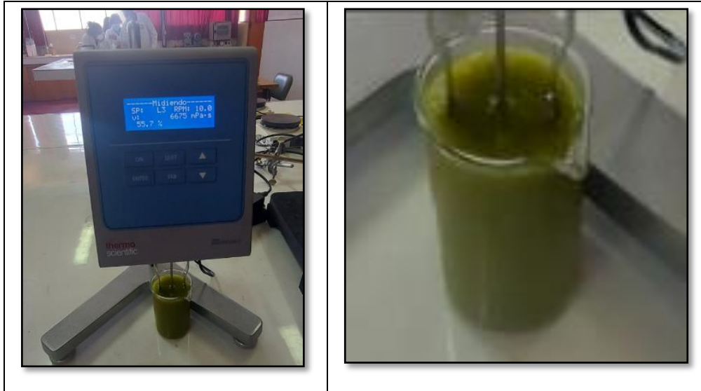
Figura 65: Ensayo de viscosidad del mucilago de patakiska
