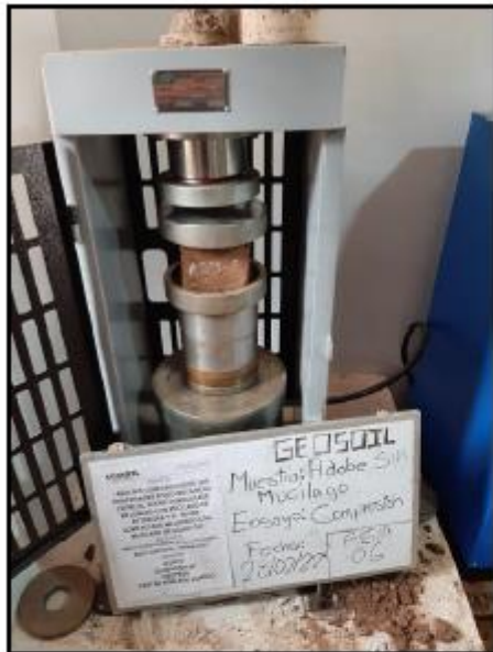
Ensayo de Compresión de adobe para muestra ASM-06.
