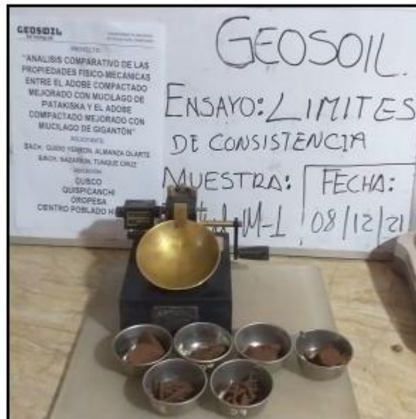
Ensayo de limite líquido y plástico para muestra M-1.
