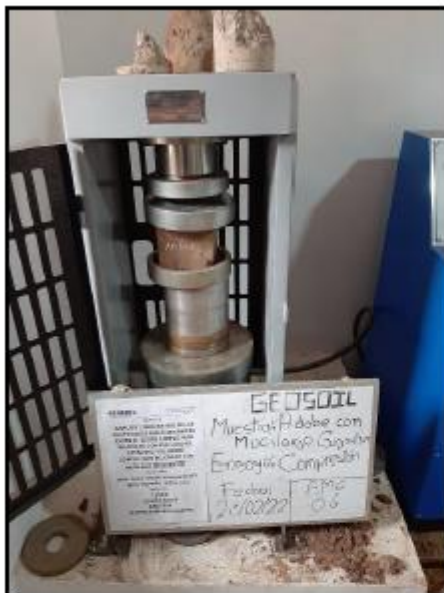
Ensayo de Compresión de adobe para muestra ASG-06.
