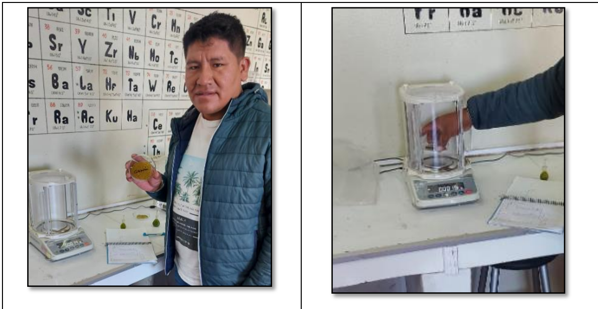
Figura 60: Ensayo de peso seco de mucilago de gigantón
