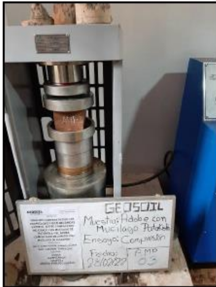
Ensayo de Compresión de adobe para muestra ASP-03.
