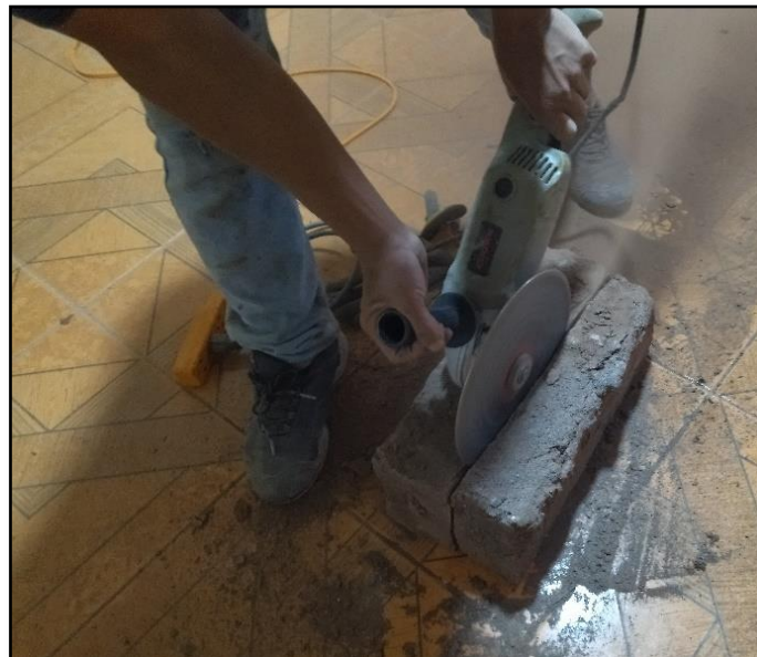
Figura 88: Corte al Adobe Compactado a 10x10x10cm con Amoladora
