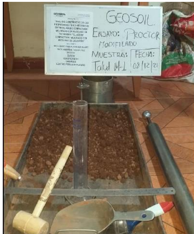
Figura 46: Muestra a Ensayar Proctor Modificado
