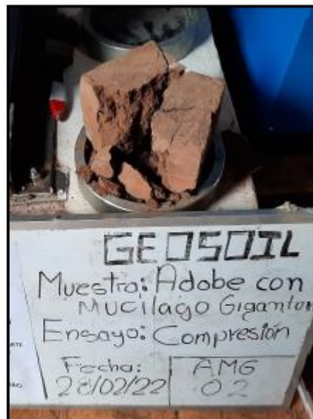
Ensayo de Compresión de adobe para muestra ASG-02.
