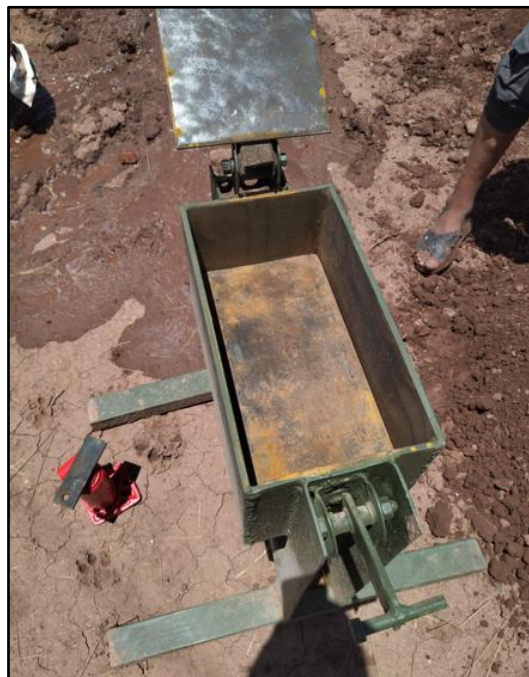
Figura 111: Limpieza de Maquina Compresión y Gatas Hidráulicas
