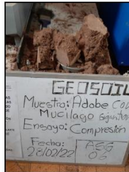
Ensayo de Compresión de adobe para muestra ASG-06.
