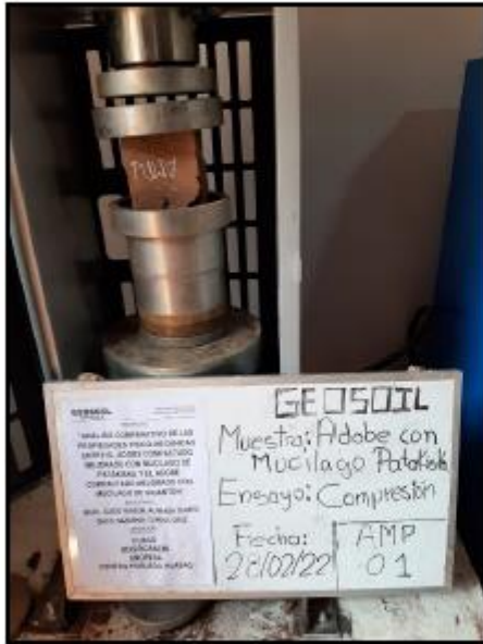
Ensayo de Compresión de adobe para muestra ASP-01.
