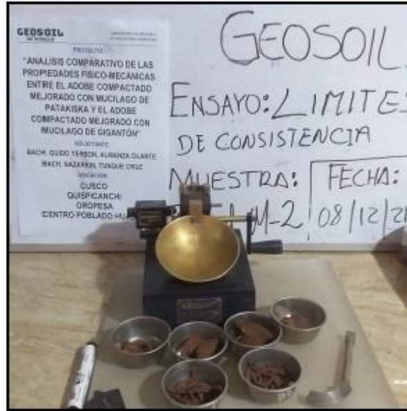
Ensayo de límite líquido y plástico para muestra M-2.
