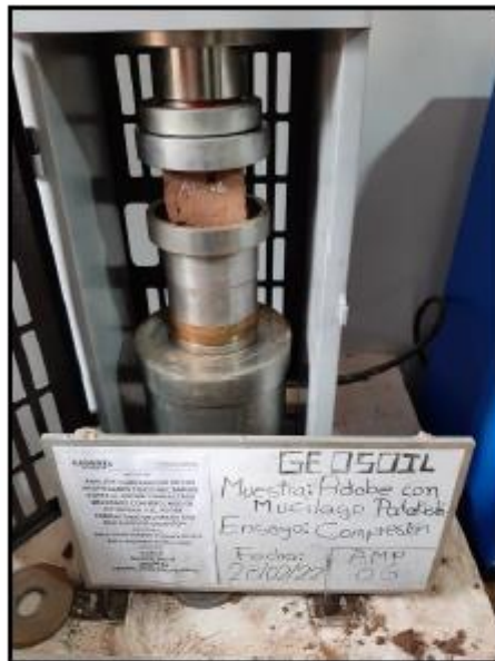
Ensayo de Compresión de adobe para muestra ASP-06.
