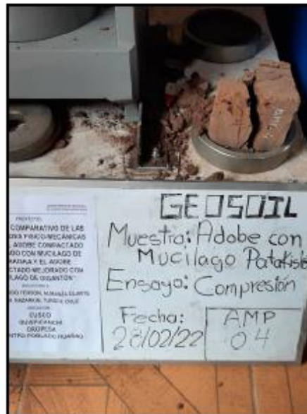
Ensayo de Compresión de adobe para muestra ASP-04.
