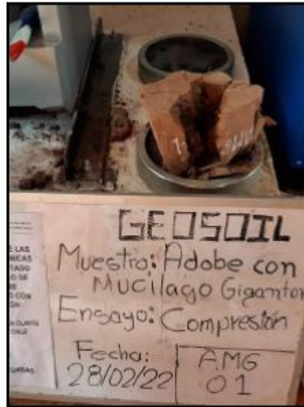
Ensayo de Compresión de adobe para muestra ASG-01.
