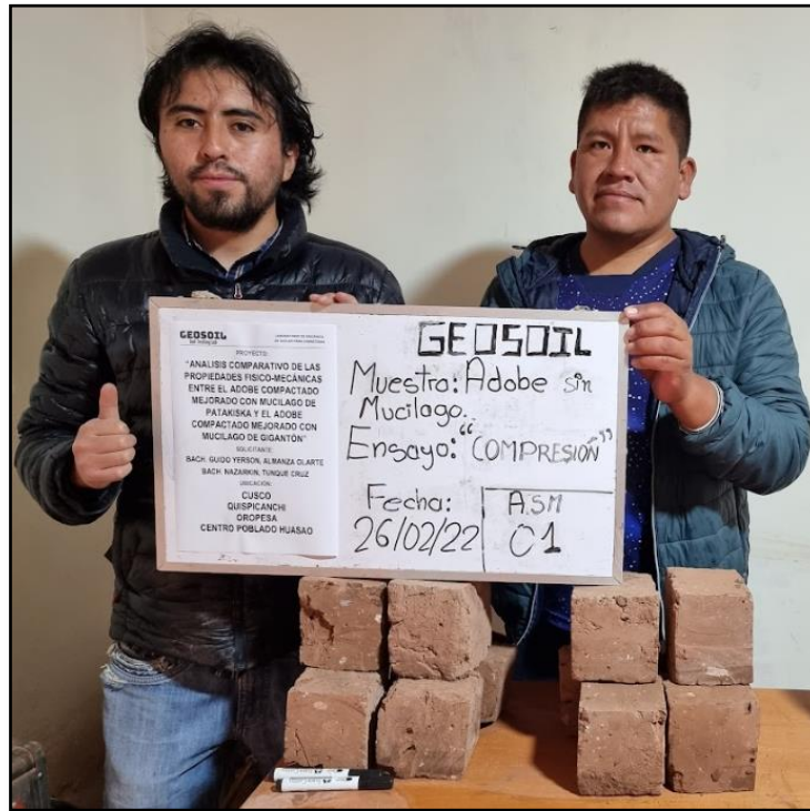
Figura 92: Cubos de Adobes Compactados adicionados con Mucilago de Gigantón de 10x10x10cm
