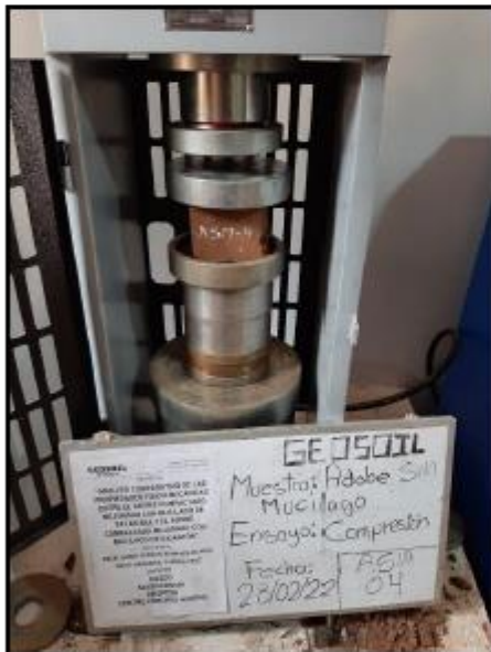
Ensayo de Compresión de adobe para muestra ASM-04.
