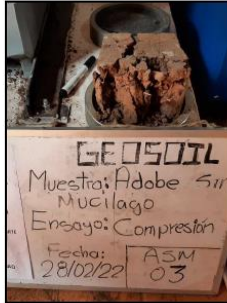
Ensayo de Compresión de adobe para muestra ASM-03.
