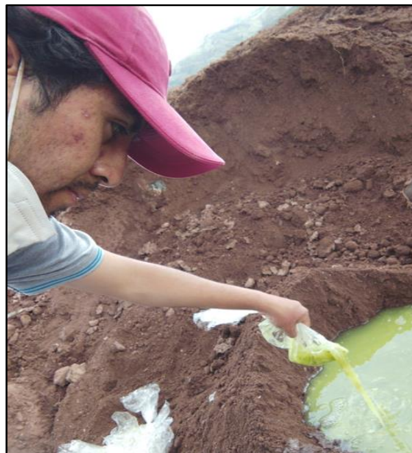
Figura 109: Colocación de Mucilago de Gigantón al suelo
