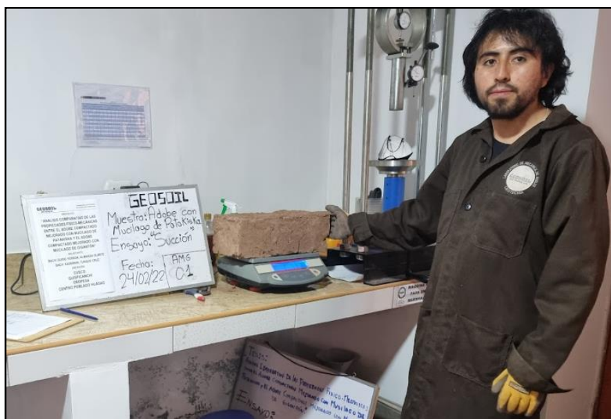
Figura 75: Ensayo de Succión Peso Seco del Adobe a Ensayar
