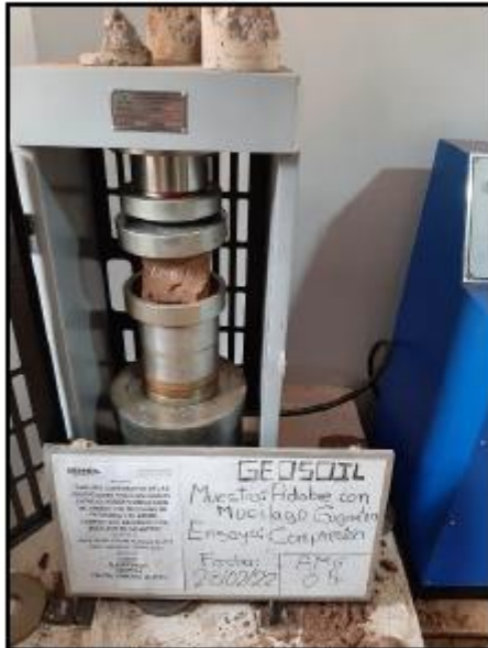
Ensayo de Compresión de adobe para muestra ASG-05.
