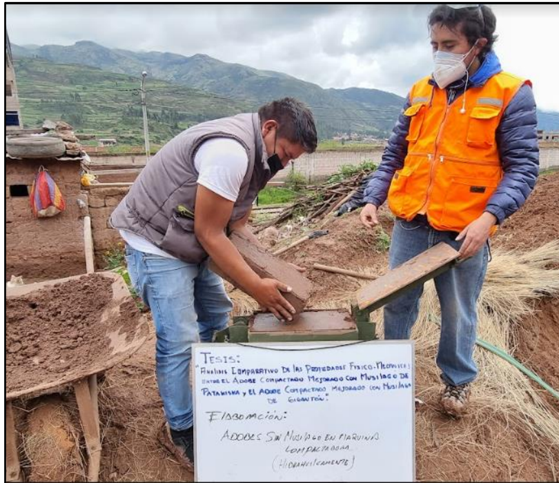
Figura 122: Extracción de Adobe Compactado
