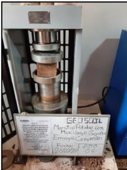
Ensayo de Compresión de adobe para muestra ASG-04.
