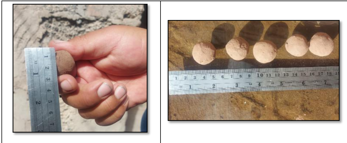
Figura 24: Prueba a la resistencia de la bola seca
