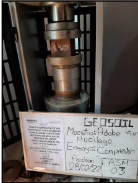
Ensayo de Compresión de adobe para muestra ASM-03.
