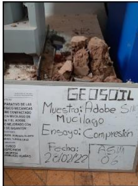
Ensayo de Compresión de adobe para muestra ASM-06.
