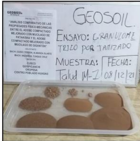
Ensayo de granulometría para muestra M-1.
