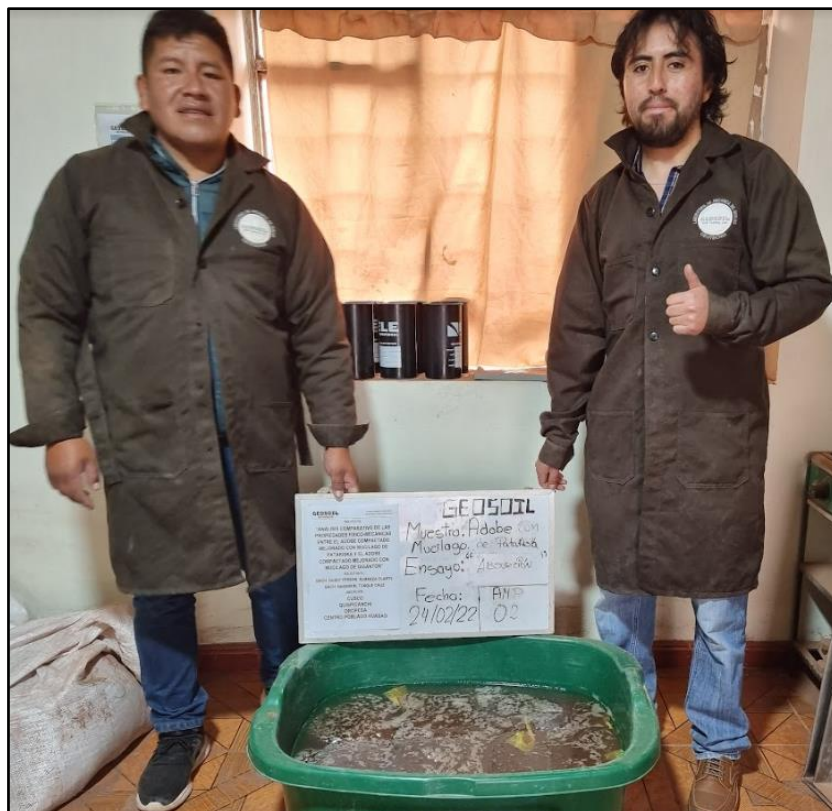
Figura 79: Ensayo de Absorción Adobes con Mucilago de Patakiska Saturados durante 24 horas
