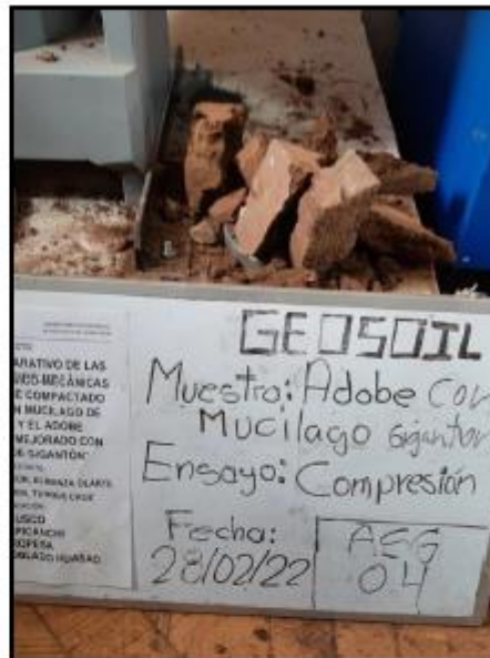
Ensayo de Compresión de adobe para muestra ASG-04.
