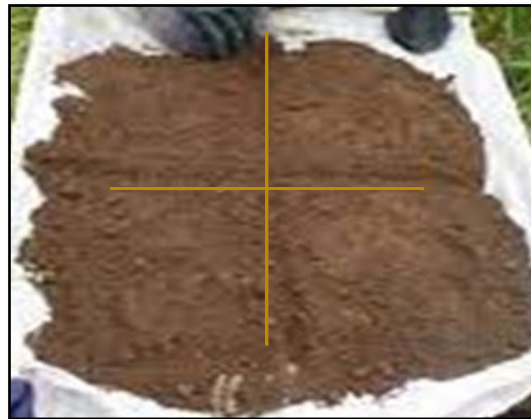
Figura 30: Método del Cuarteo del Suelo
