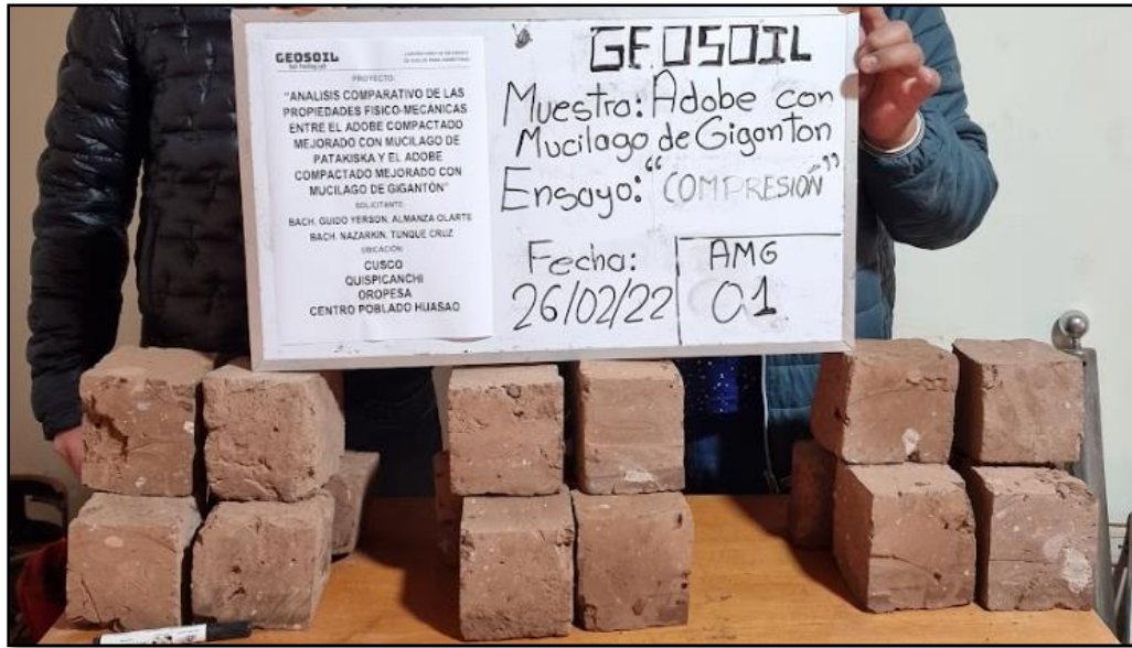
Figura 87: Cubos de Adobe Compactado de 10x10x10cm para conseguir la Resistencia a Compresión
