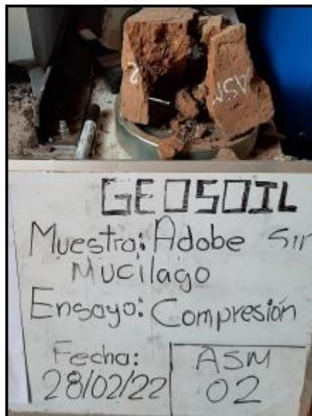
Ensayo de Compresión de adobe para muestra ASM-02.
