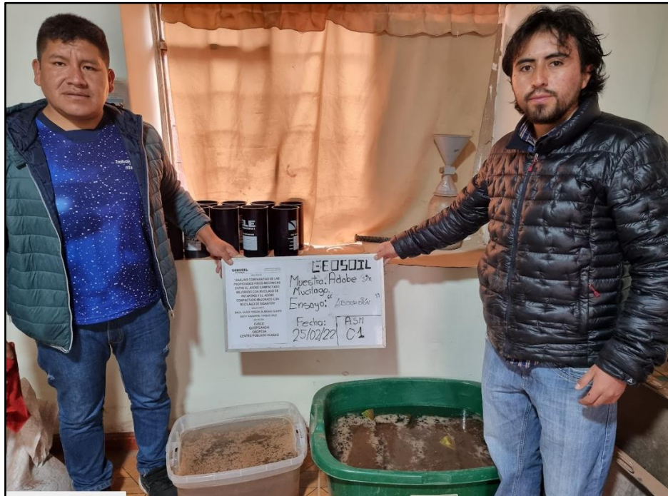
Figura 81: Ensayo de Absorción Adobes sin Mucilago Saturados Durante 24 horas
