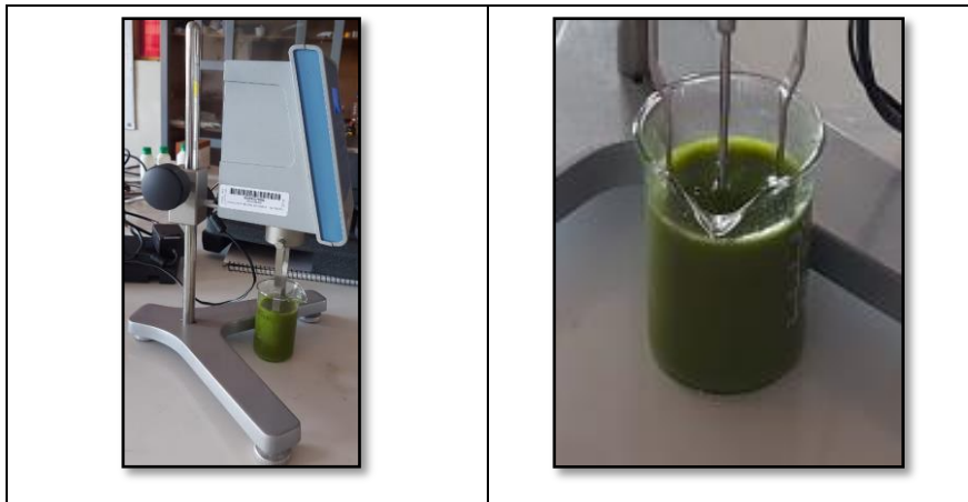
Figura 56: Evaluación de la viscosidad del mucilago de gigantón
