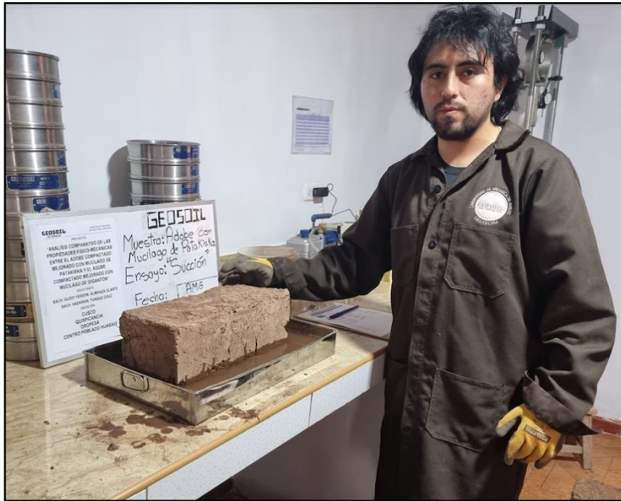
Figura 77: Ensayo de Succión Secado de Superficie del Adobe
