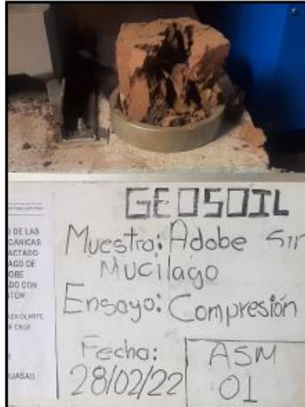
Ensayo de Compresión de adobe para muestra ASM-01.
