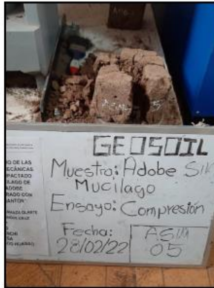
Ensayo de Compresión de adobe para muestra ASM-05.
