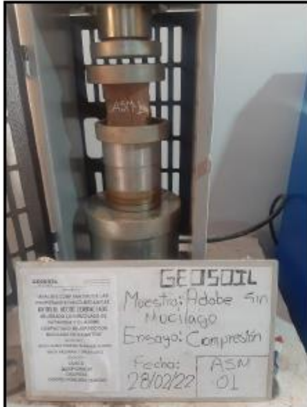
Ensayo de Compresión de adobe para muestra ASM-01.
