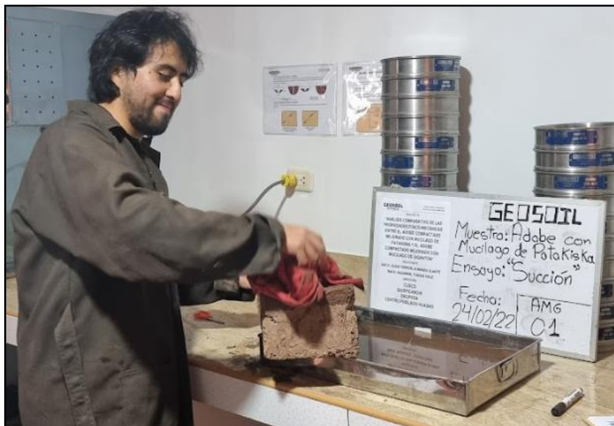
Figura 77: Ensayo de Succión Secado de Superficie del Adobe
