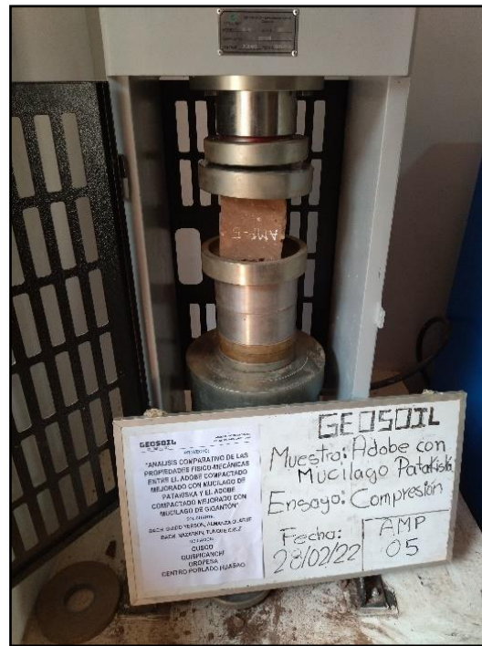
Figura 96: Ensayo de Resistencia a la Compresión Adobe Compactado con Mucilago de Patakiska
