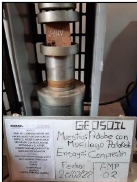
Ensayo de Compresión de adobe para muestra ASP-02.
