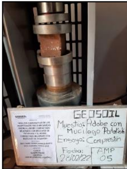
Ensayo de Compresión de adobe para muestra ASP-05.
