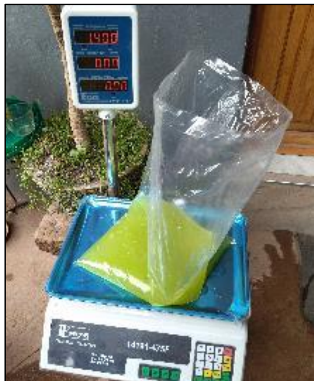
Figura 103: Pesado de Mucilagos de Patakiska y Gigantón para cada adobe
