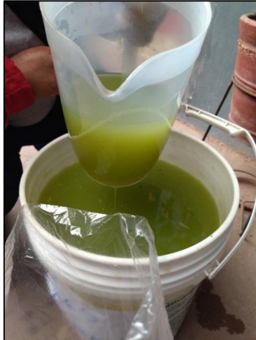
Figura 103: Pesado de Mucilagos de Patakiska y Gigantón para cada adobe
