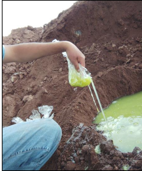
Figura 116: Colocación de Mucilago de Patakiska al Suelo
