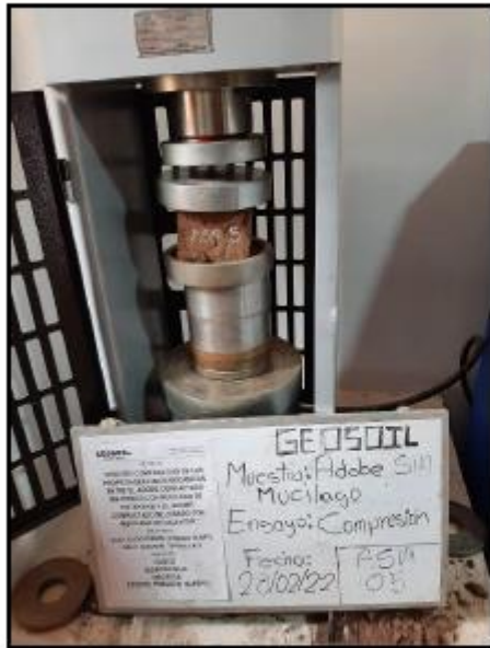
Ensayo de Compresión de adobe para muestra ASM-05.
