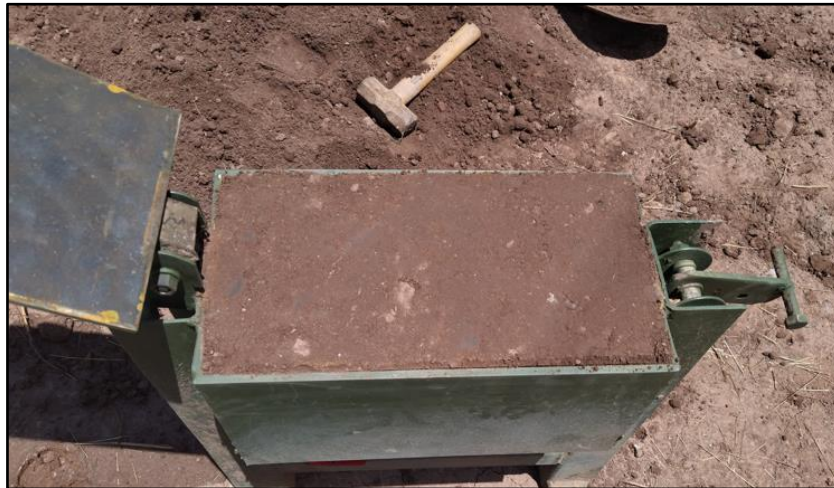
Figura 114: Extracción de Adobe Compactado
