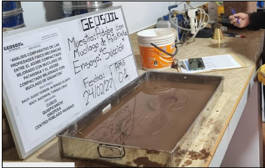
Figura 74: Bandeja Metálica con Agua para el Ensayo de Succión
