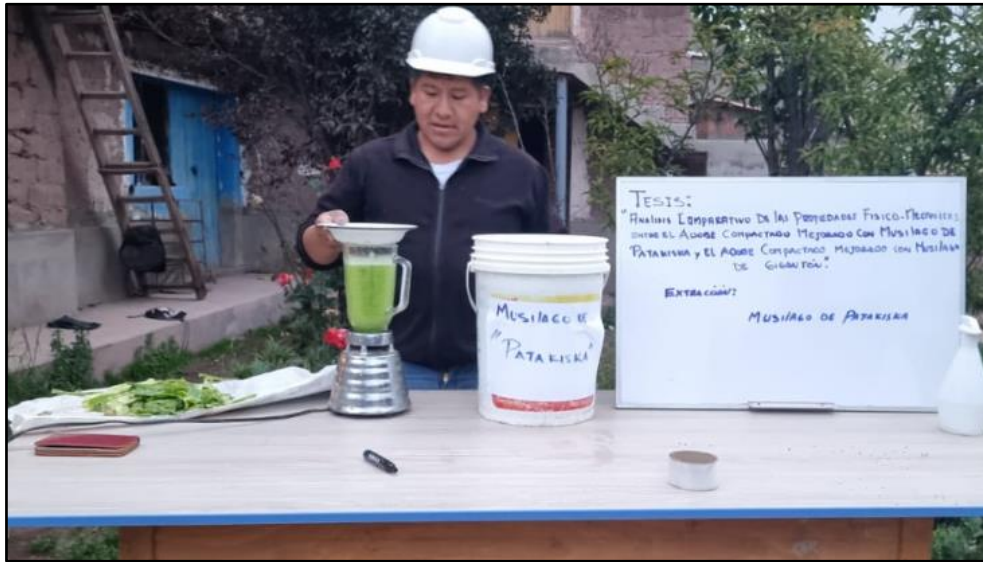
Figura 55: Licuado de la Planta Patakiska
