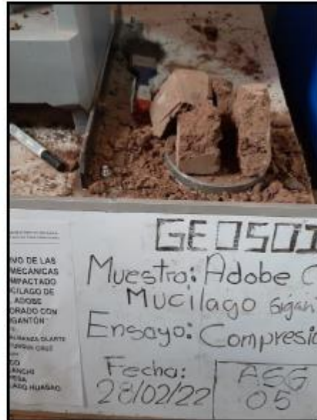
Ensayo de Compresión de adobe para muestra ASG-05.
