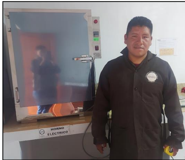
Figura 37: Horno Eléctrico para el Ensayo de Limite Liquido
