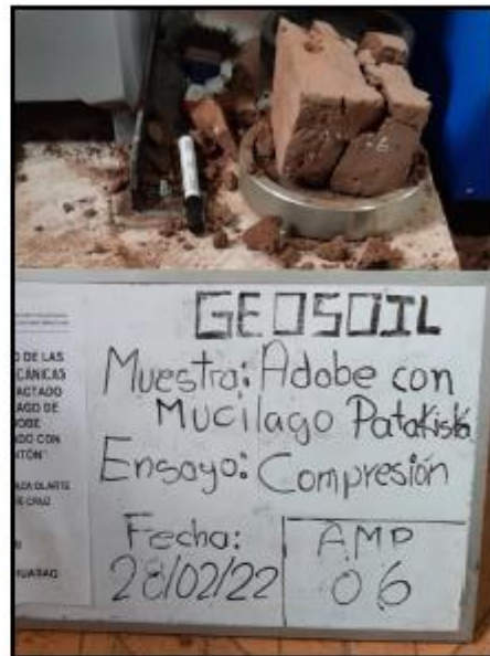
Ensayo de Compresión de adobe para muestra ASP-06.
