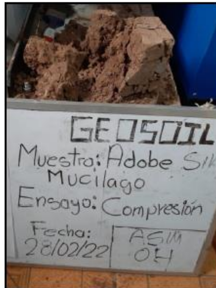
Ensayo de Compresión de adobe para muestra ASM-04.
