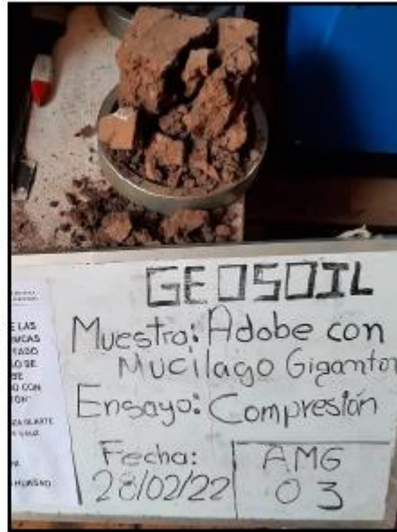
Ensayo de Compresión de adobe para muestra ASG-03.
