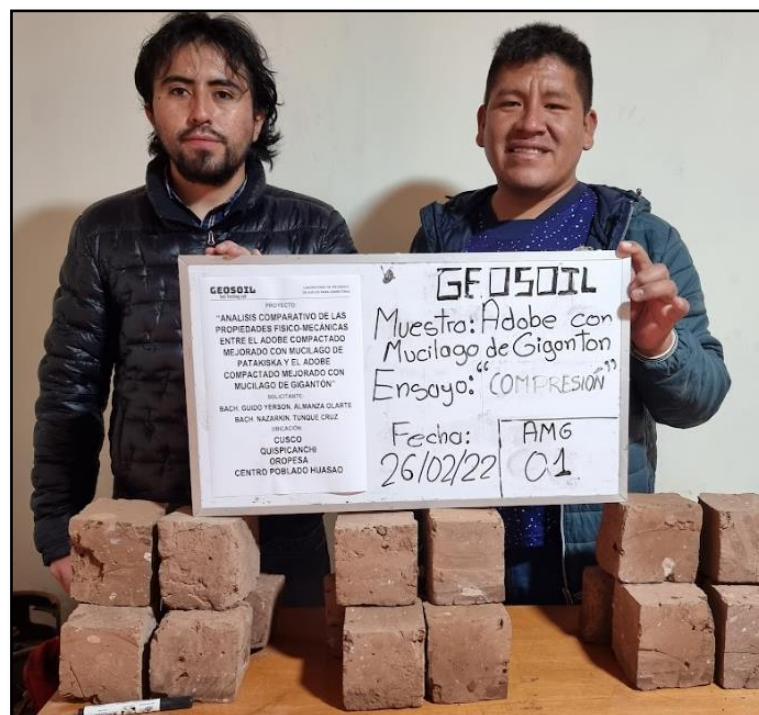
Figura 92: Cubos de Adobes Compactados adicionados con Mucilago de Gigantón de 10x10x10cm
