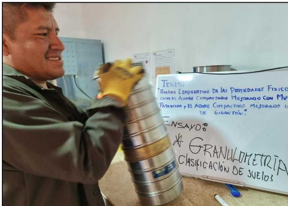
Figura 32: Proceso de Tamizado del Suelo
