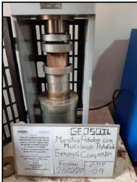
Ensayo de Compresión de adobe para muestra ASP-04.
