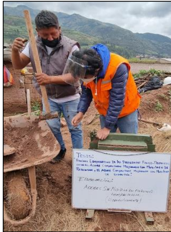
Figura 120: Cerramos la Máquina llena de Material, lista para Comprimir
