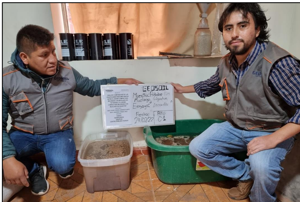
Figura 80: Ensayo de Absorción adobes con Mucilago de Gigantón Saturados Durante 24 horas
