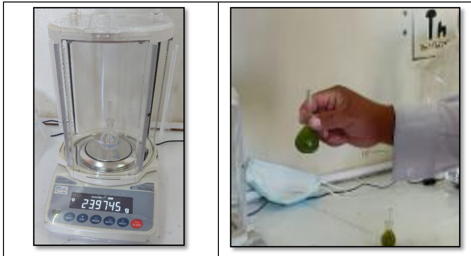
Figura 59: Registro de muestra de mucilago en balanza analítica
