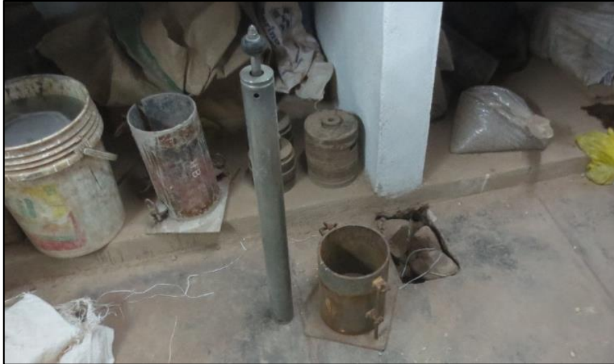
Figura 47: Molde y Pisón para el Ensayo
