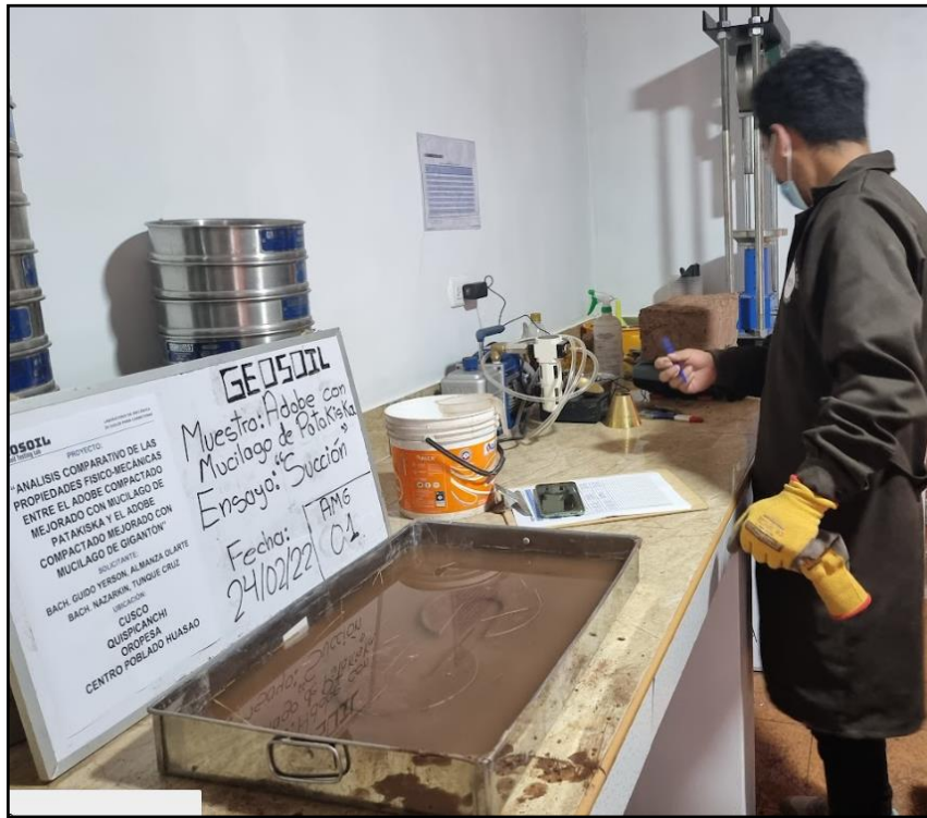
Figura 78: Ensayo de Succión Registro de Peso del Adobe una vez Realizado el Ensayo
