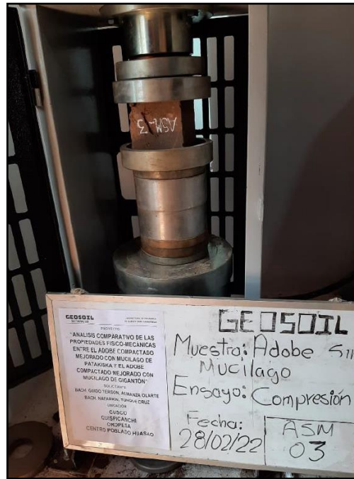
Figura 94: Proceso de Evaluación de Resistencia en Adobe Compactado sin Mucilago
