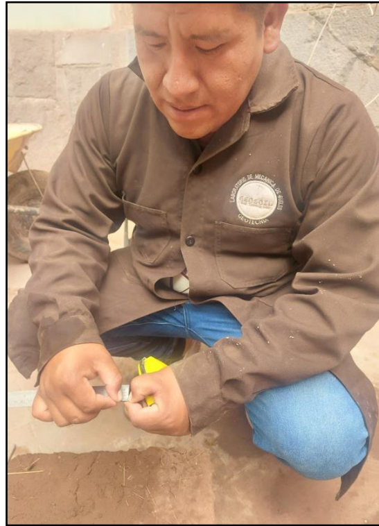
Figura 85: Recolección de Dato de la Profundidad de la Oquedad del (SAET)
