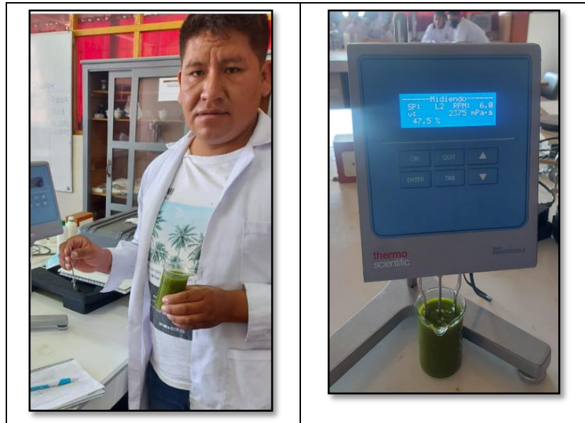
Figura 57: Viscosímetro rotatorio ensayo final
