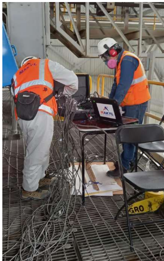
Figura 8: Instalación de cables OMA
