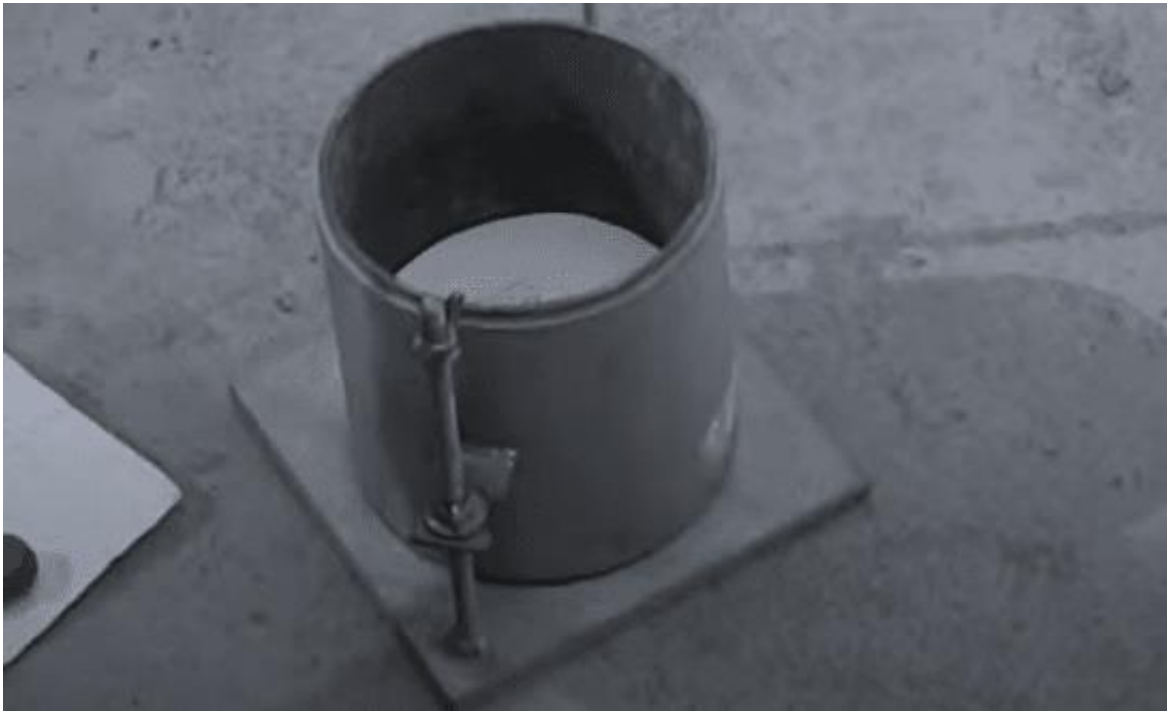
Figura 33: Colocada de Papel Filtro y la Placa con Vástago - CBR
