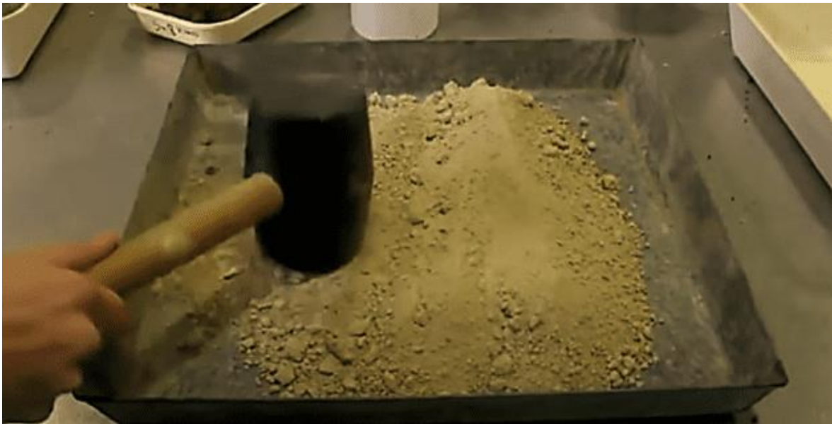
Figura 24: Preparado y Desmenuzando de la Muestra
