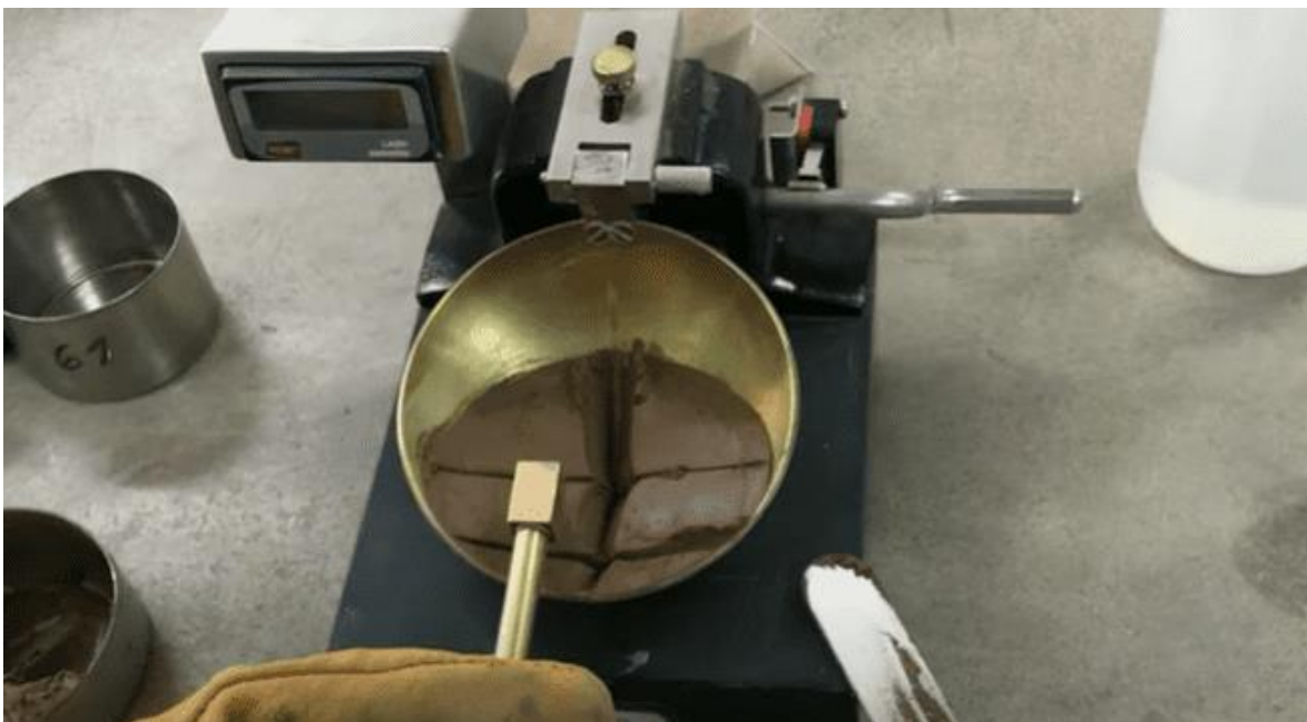
Figura 15: La Ranura se cierra en la copa de Casagrande al Proporcionar Golpes.
