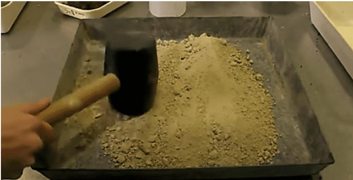
Figura 29: Preparado y Desmenuzando de la Muestra para CBR
