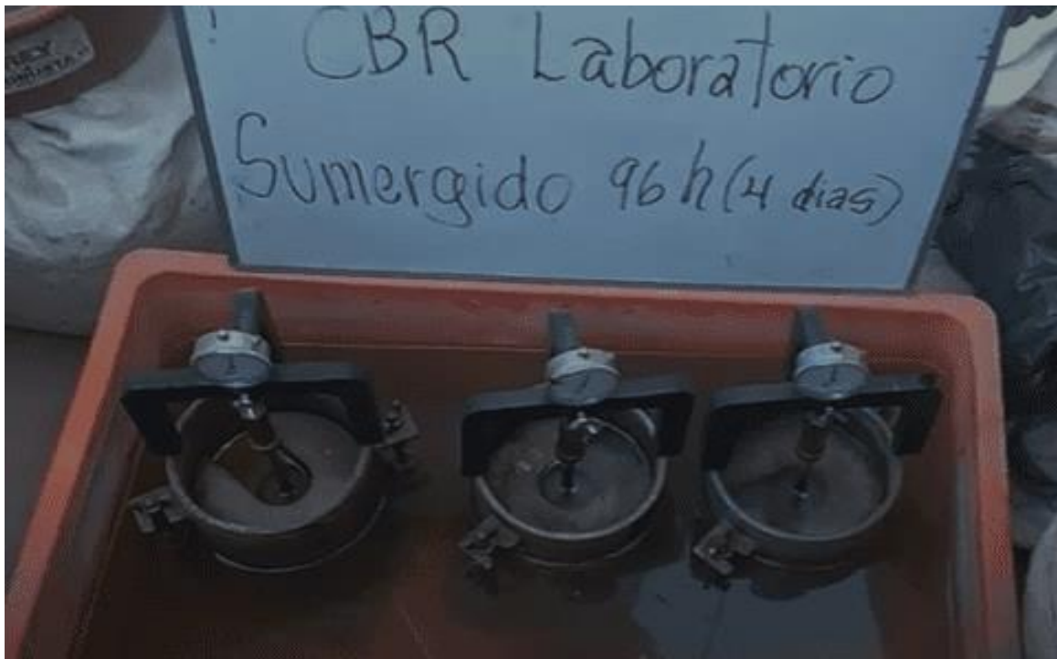
Figura 34: Sumersión de los moldes en un Recipiente con Agua - CBR
