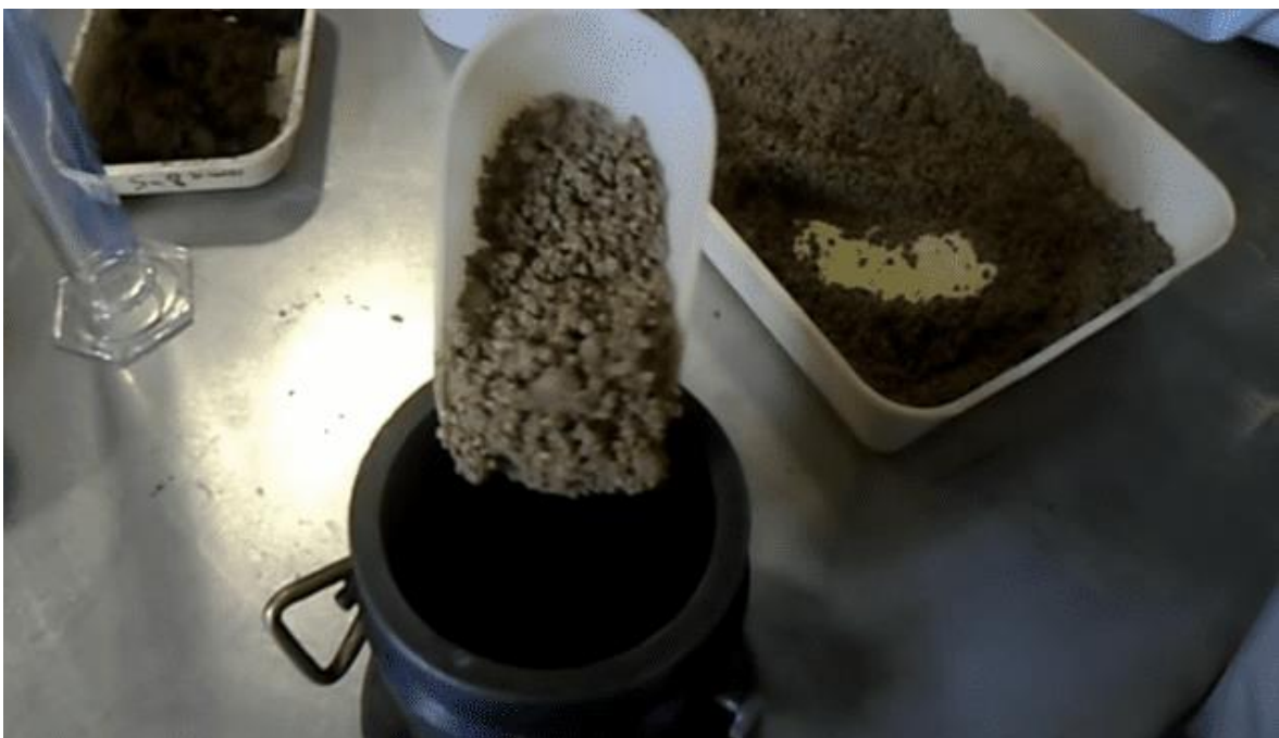
Figura 25: Mezclado de la Muestra con una Porción de Agua.
