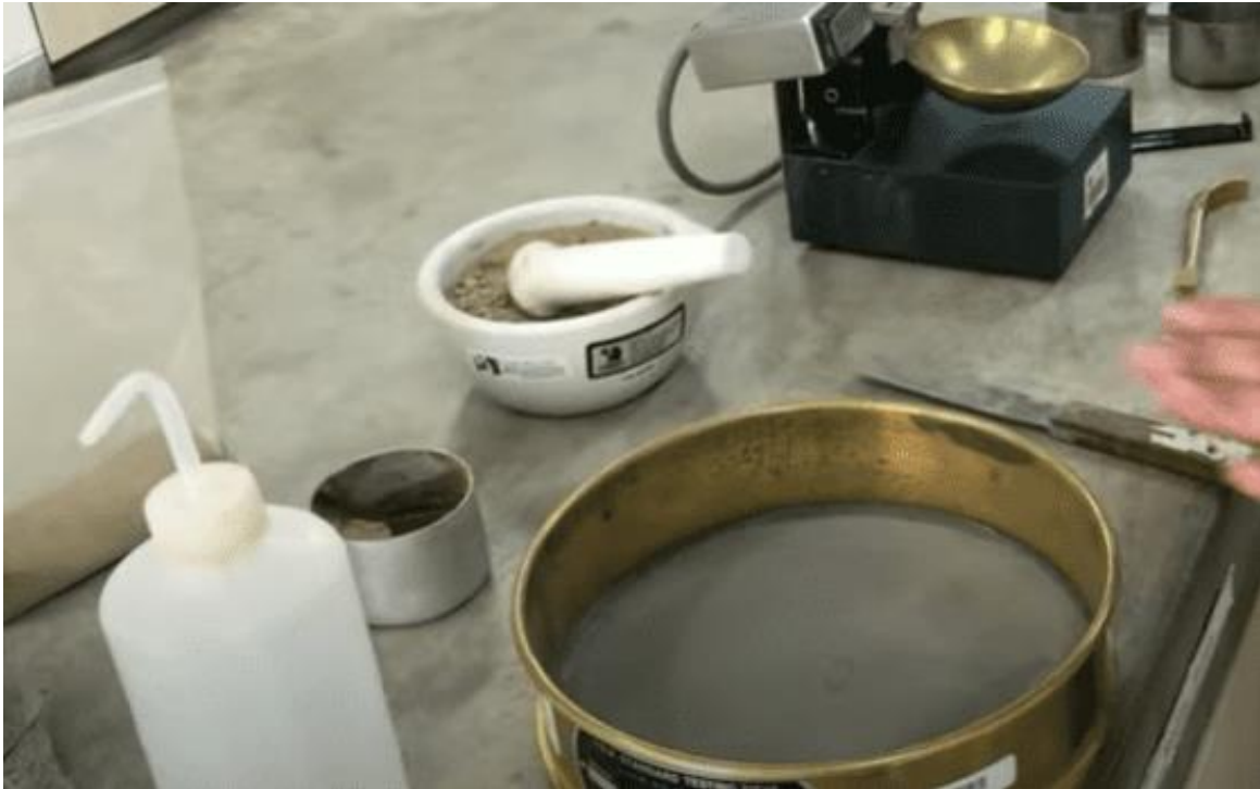
Figura 11: Preparado para Ensayo de Compresión Inconfinada
