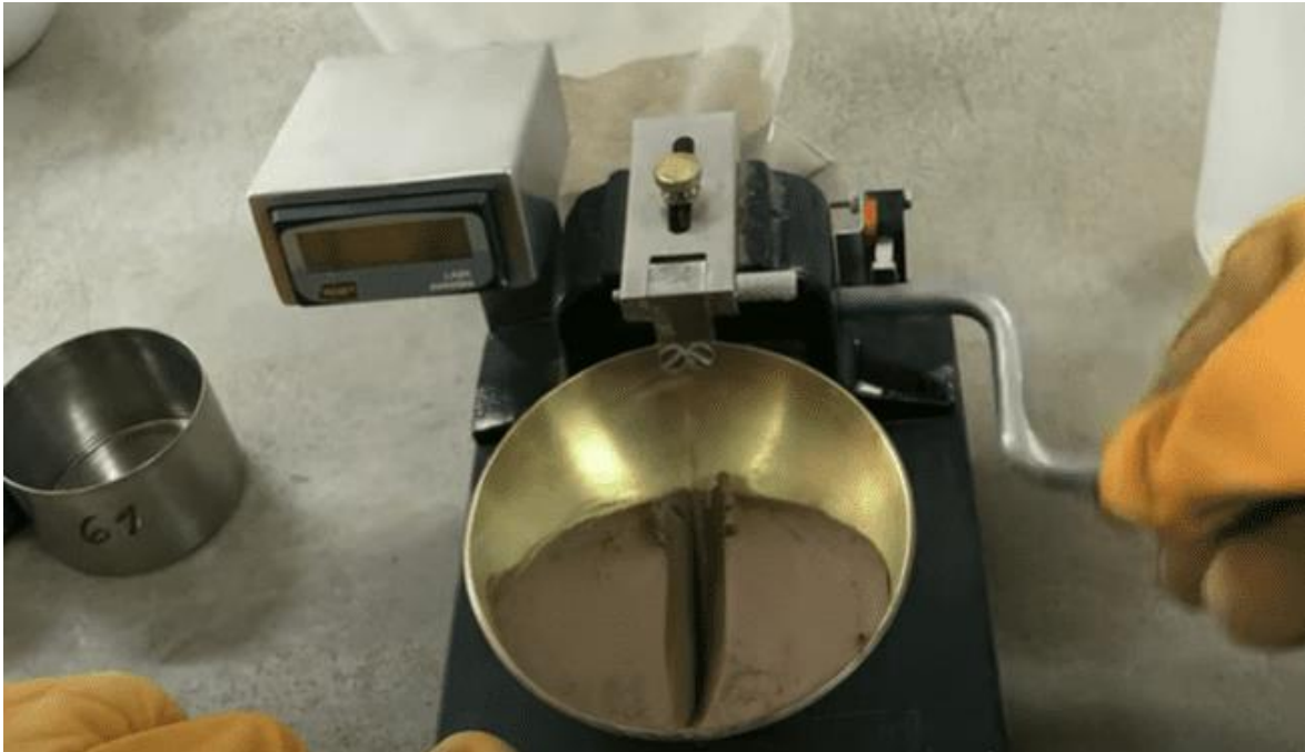
Figura 14: Corte de la Pasta en la copa de Casagrande con el acanalador.
