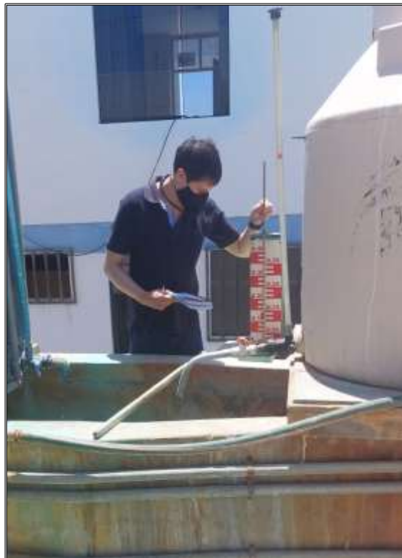
Figura N° 26. Verificación del medidor de caudal en PTAP Pampa Inalámbrica Fuente: Elaboración propia
