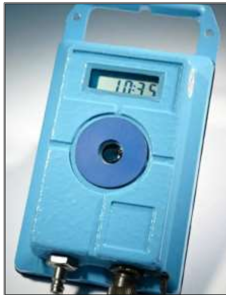
Figura N° 18. Data Logger Lolog Vista.
