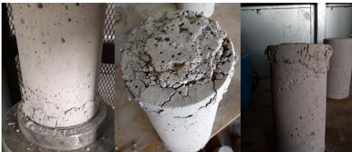
Figura 37: Falla de las briquetas sometidas a compresión - Diseño D-2-29
