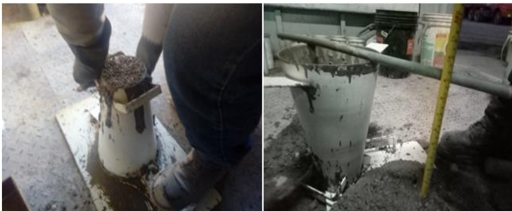
Figura 27: Ensayo de consistencia - Asentamiento con el cono de Abrams
