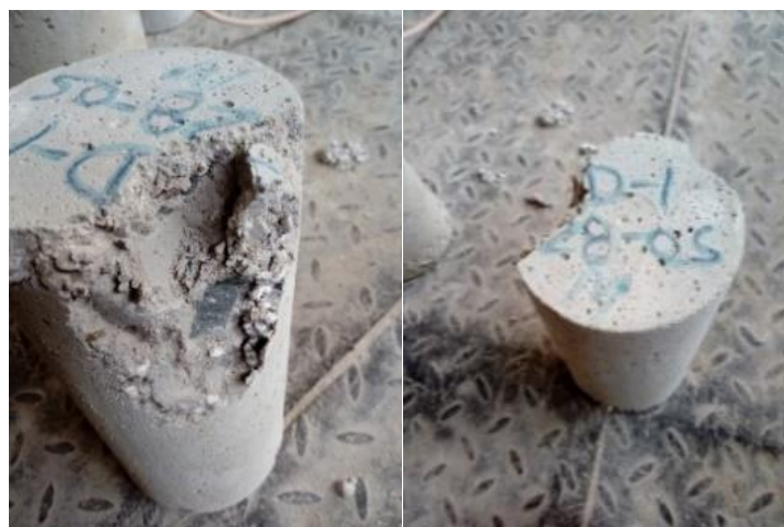
Figura 34: Falla de las briquetas sometidas a compresión - Diseño D-1-28
