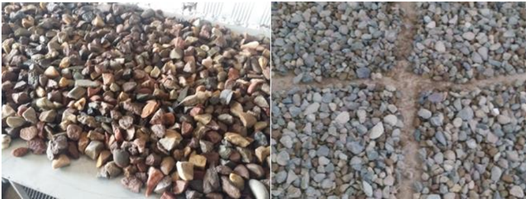
Figura 15: Proceso del muestreo del agregado grueso mediante el cuarteo
