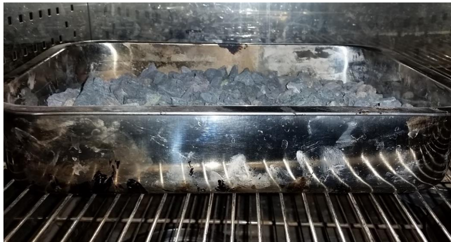
Figura 26: Muestra de Agregado Grueso ingresando al horno - Contenido de humedad
