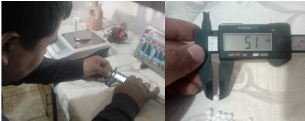
Figura 17: Medición de diámetros de las perlas de poliestireno expandido
