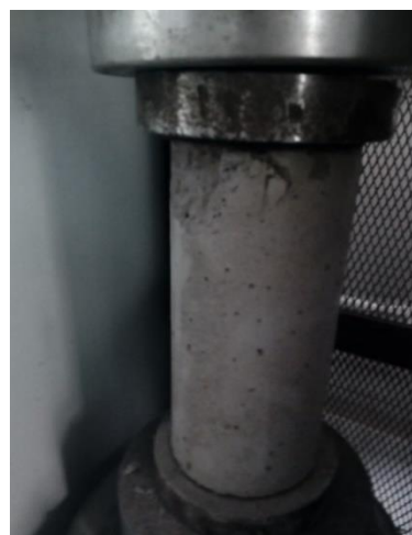
Figura 33: Falla de las briquetas sometidas a compresión - Diseño D-0-28
