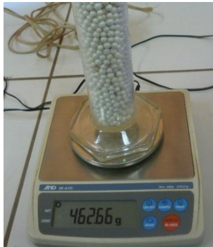
Figura 23: Desplazamiento de Volumen del EPS - Peso Especifico
