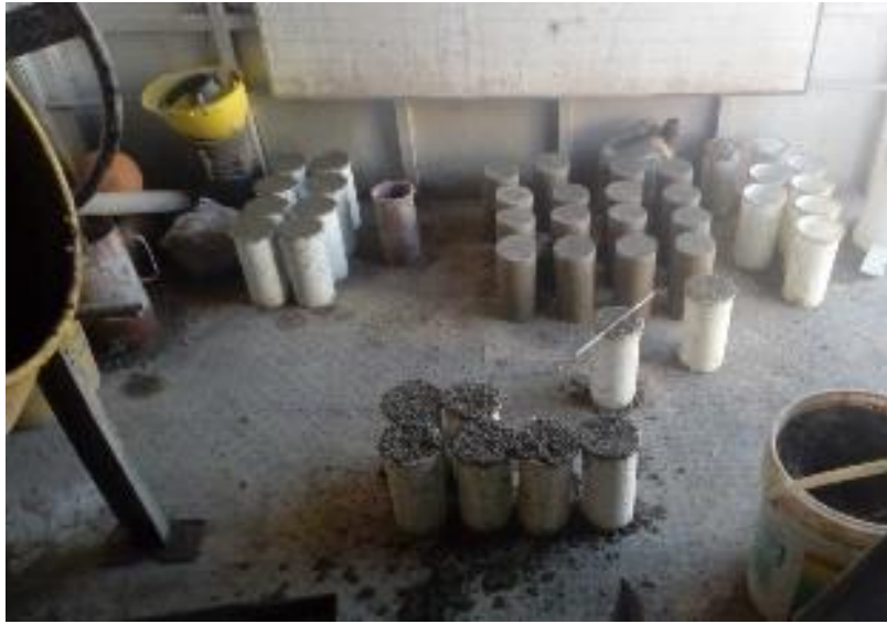
Figura 49: Elaboración de Testigos de concreto
