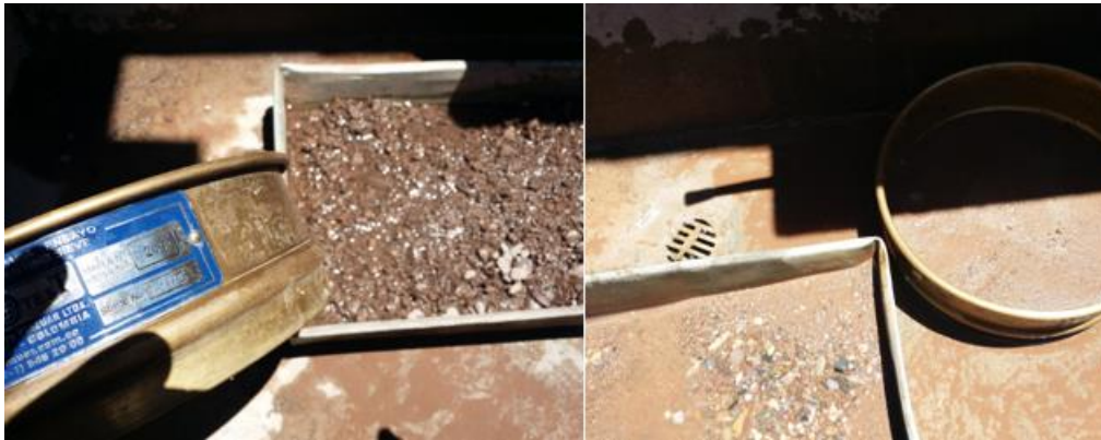
Figura 24: Lavado de Agregado por el tamiz N° 200
