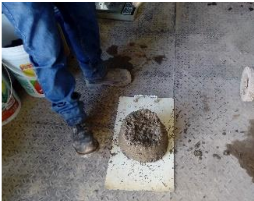
Figura 50: Ensayo de Consistencia - Prueba a las 2 Horas
