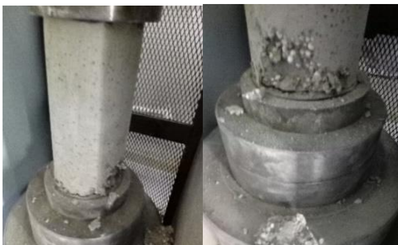
Figura 35: Falla de las briquetas sometidas a compresión - Diseño D-2-28
