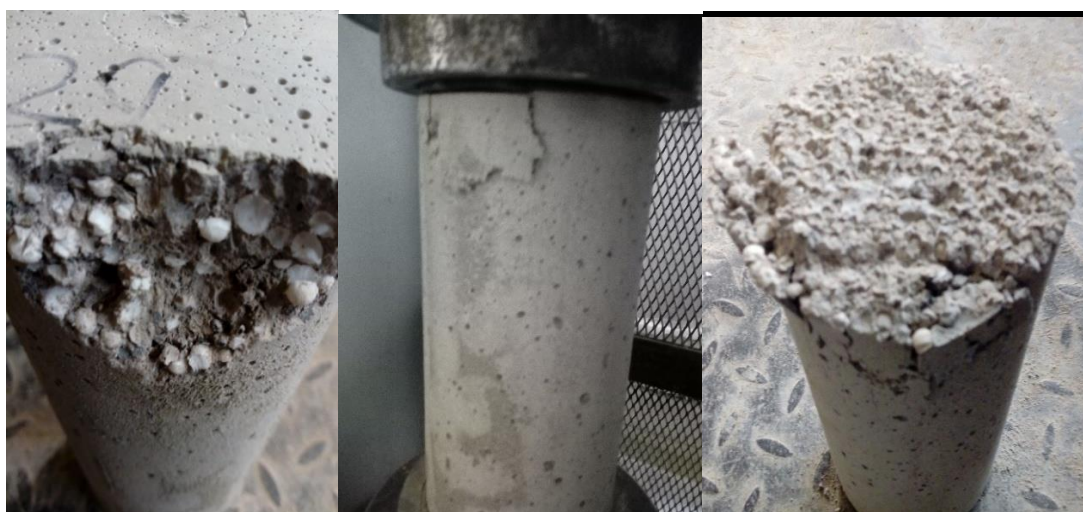
Figura 36: Falla de las briquetas sometidas a compresión - Diseño D-1-29
