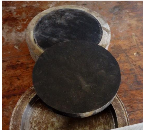
Figura 30: Colocación de Neopreno en los cabezales
