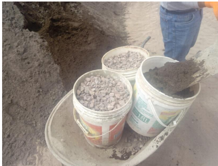
Figura 12: Selección de material para su posterior cuarteo
