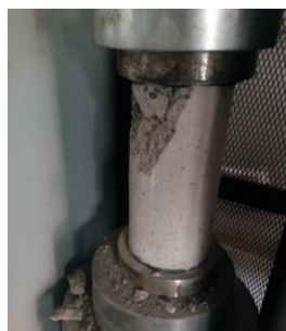
Figura 32: Falla de las briquetas sometidas a compresión - Diseño D-0-26
