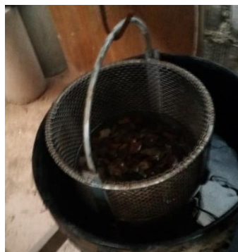
Figura 22: Muestra de Agregado Grueso en la canastilla sumergiéndose
