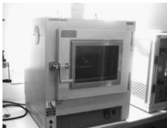
Figura 6. Ensayo en Estufa de Película Delgada
