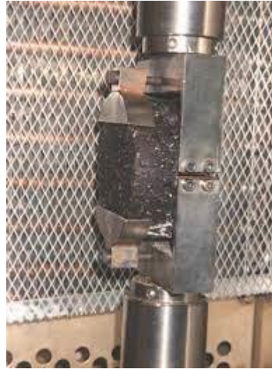
Figura 5. Ensayo de Tracción Directa
