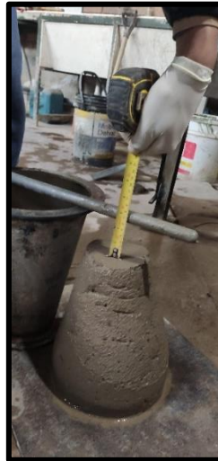
Figura 45: Medición de la fluidez con el método del SLUMP
