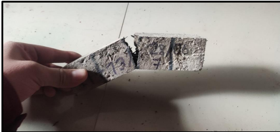
Figura 67: Falla de la muestra + 13% caucho a los días, sometida a flexión
