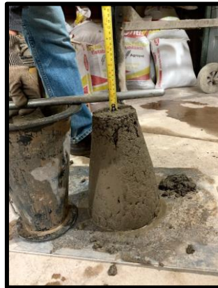
Figura 46: Medición de la fluidez con el método del SLUMP
