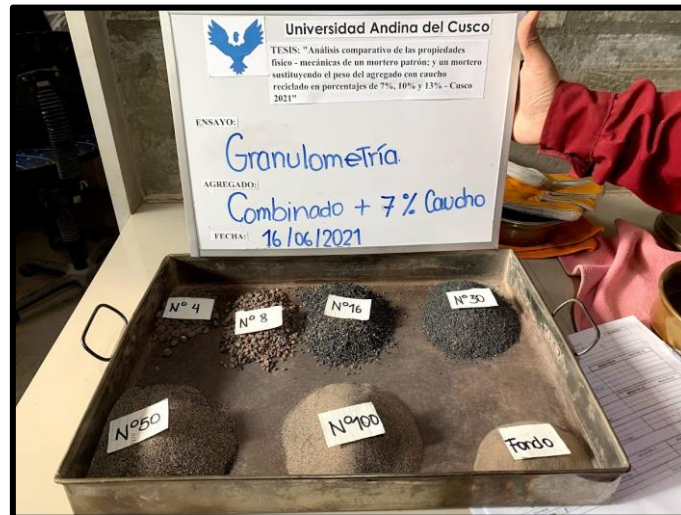
Figura 28: Pesos retenidos en cada tamiz de la granulometría de la combinación + 7% Caucho
