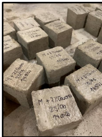
Figura 54: Desmoldado de los dados de mortero
