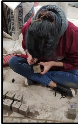
Figura 55: Distribución de muestras para el ensayo de compresión
