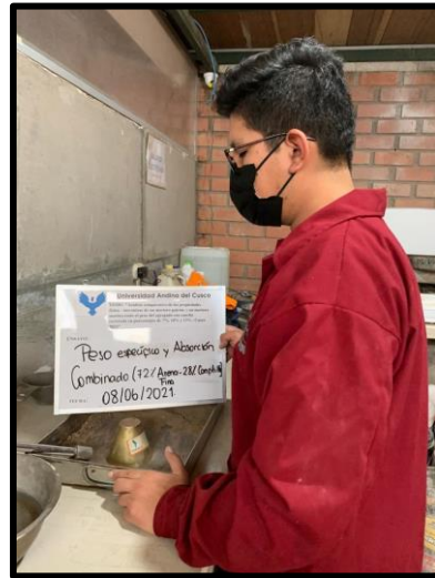
Figura 36: Prueba de humedad con el cono de absorción
