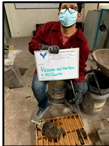
Figura 61: Vaciado del mortero en los moldes prismáticos
