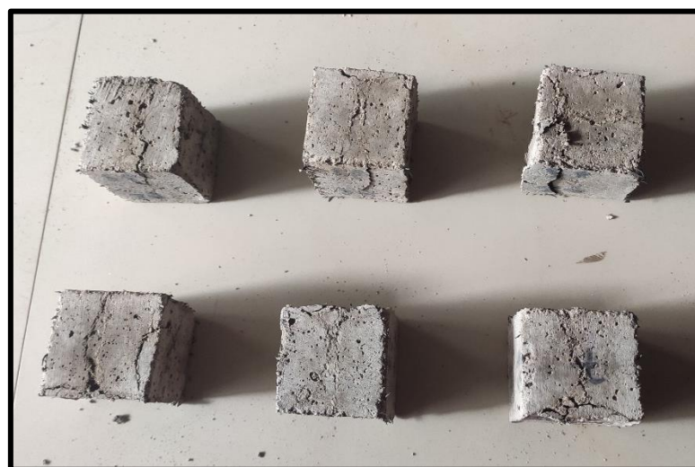
Figura 59: Falla de la muestra +13% caucho a los 28 días, sometida a compresión
