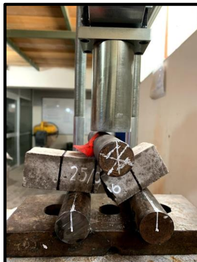
Figura 66: Rotura de la muestra de mortero patrón sometida a flexión
