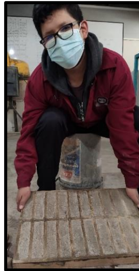
Figura 62: Desmoldado de prismas de mortero
