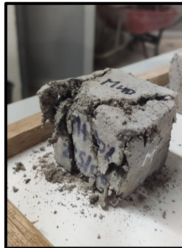
Figura 58: Falla de la muestra +10% caucho a los 28 días, sometida a compresión
