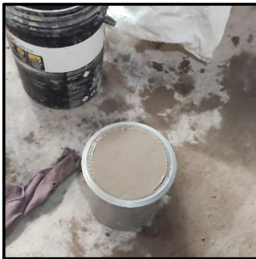
Figura 49: Llenado de la Olla Washington con la muestra de mortero
