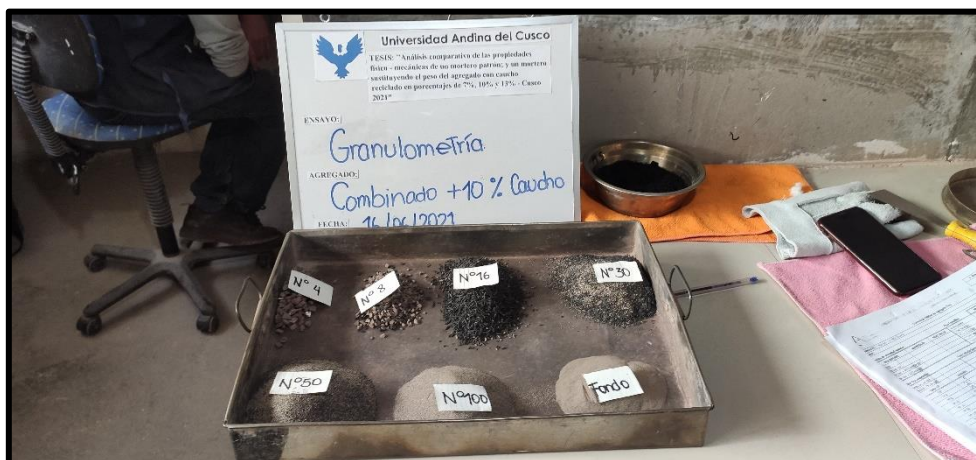
Figura 29: Pesos retenidos en cada tamiz de la granulometría de la combinación + 10% Caucho
