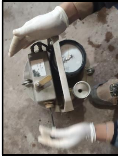
Figura 50: Ensayo de porcentaje de aire en el mortero
