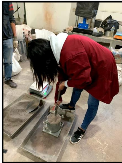
Figura 41: Compactación de la muestra dentro del molde
