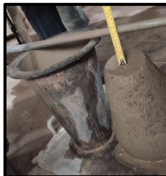
Figura 16: Cono de Abrahams y varilla de acero
