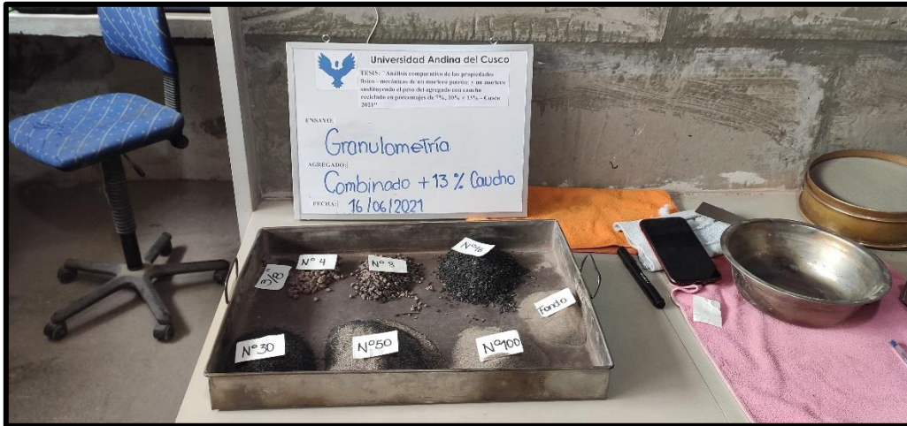
Figura 30: Pesos retenidos en cada tamiz de la granulometría de la combinación + 10% Caucho
