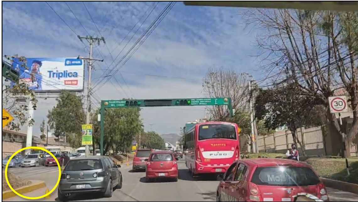
Figura N° 93. Falta de mantenimiento en señalización horizontal - Intersección 1
