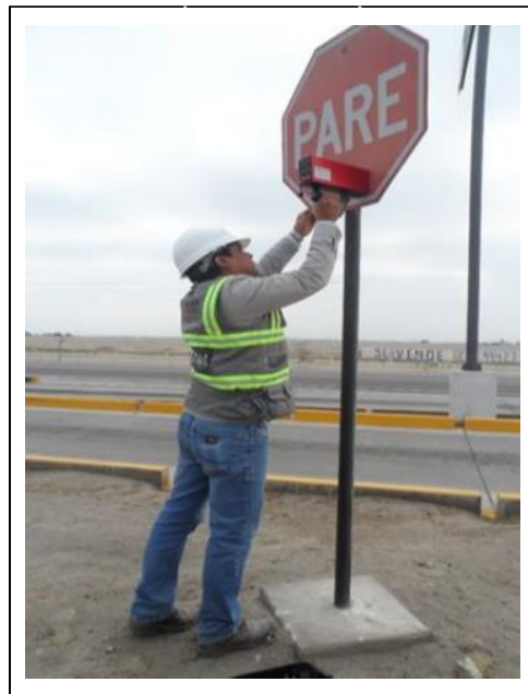
Figura 34: Medición de Reflectividad en señal vertical Visibilidad nocturna.
