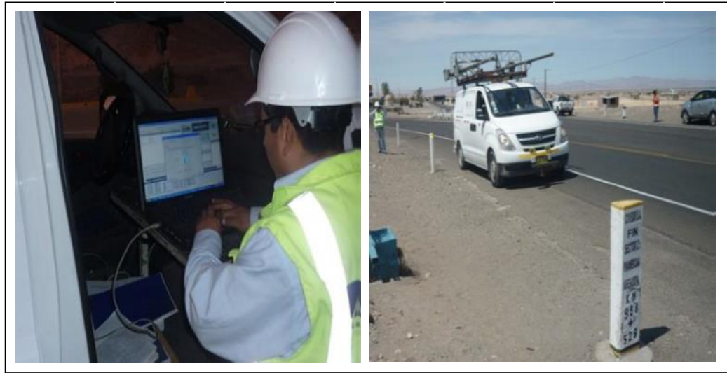
Figura 35: Medición de la rugosidad (IRI) de la calzada con perfilómetro láser.
