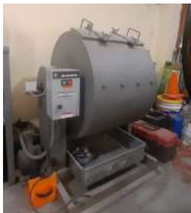
Figura 3-14 Instrumentos de ensayo de abrasion. Maquina de los angeles y balanza y agregado seleccionado.
