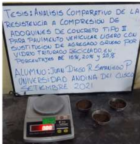
Figura 3-13 Instrumentos de ensayo Contenido de humedad de agregados. Balanza de precisión y taras para muestras.
