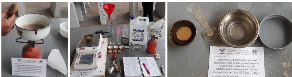
Figura 36. Muestras de suelo recubiertas con una capa impermeable de parafina
