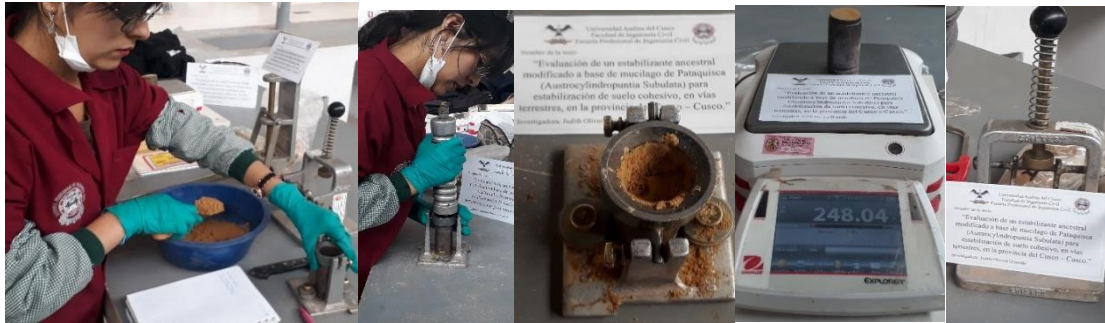
Figura 49. Compactación de suelo fino y registro de peso de suelo compactado mas molde sin base.
