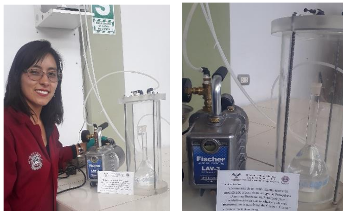
Figura 21. Uso de la bomba de vacíos para desairado del agua de ensayo
