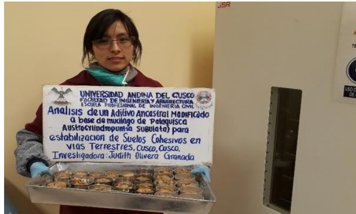
Figura 19. Muestras secas de suelo fino para la determinación del contenido de humedad
