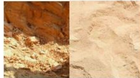
ILUSTRACIÓN 2. SUELO COHESIVO SC-ML.
