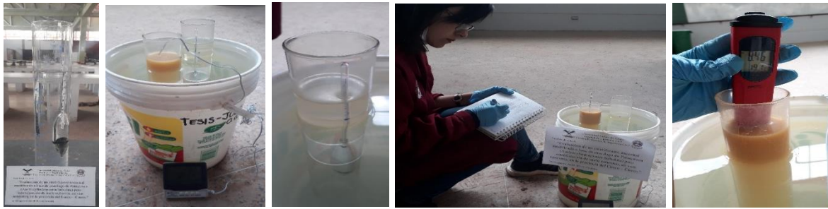
Figura 26. Procedimiento del registro de datos en el cilindro de sedimentación y el cilindro de control.
