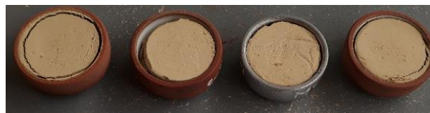
Figura 35. Muestras de suelo seco, ensayo límite de contracción
