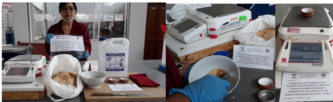
Figura 33. Equipos y materiales, ensayo límite de contracción
