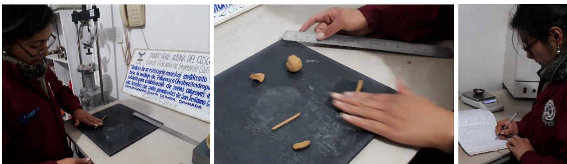
Figura 32. Preparación del cilindro de suelo de 1/8" de diámetro, ensayo de limite plástico
