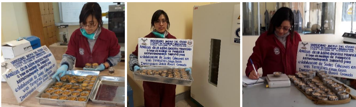
Figura 52. Registro del contenido de humedad del suelo fino, después del ensayo de compresión no confinada
