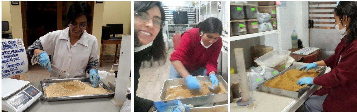
Figura 42. Preparación de la muestra de suelo a la humedad requerida
