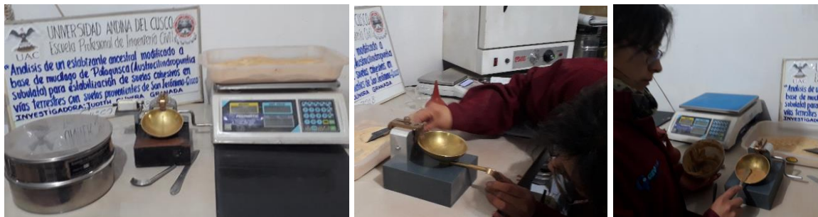
Figura 29. Ensayo limite líquido, graduación de equipo casa grande y colocación de suelo húmedo en la copa.
