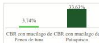
ILUSTRACIÓN 5. MEJORA DE CBR DEL SUELO CON MUCILAGO DE PENCA DE TUNA Y PATAQUISCA.
