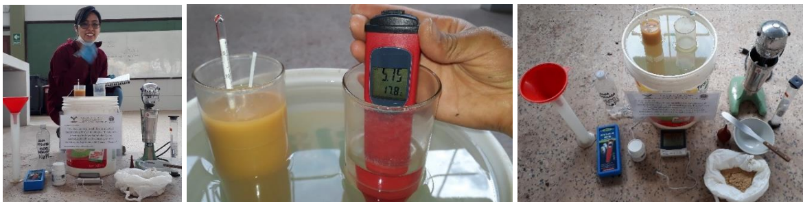
Figura 27. Imágenes del registro de datos de sedimentación de las partículas de suelo y control de temperatura
