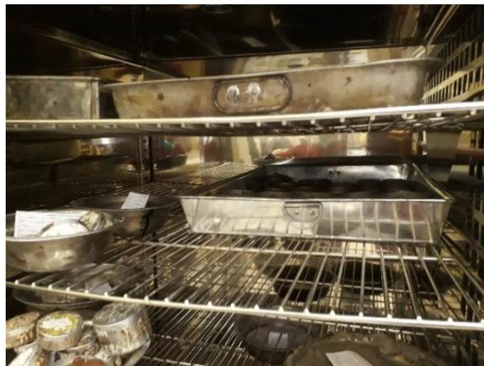
Figura 18. Muestras de suelo secadas al horno a temperatura constante
