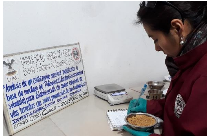
Figura 17. Registro del peso de la muestra de suelo húmedo
