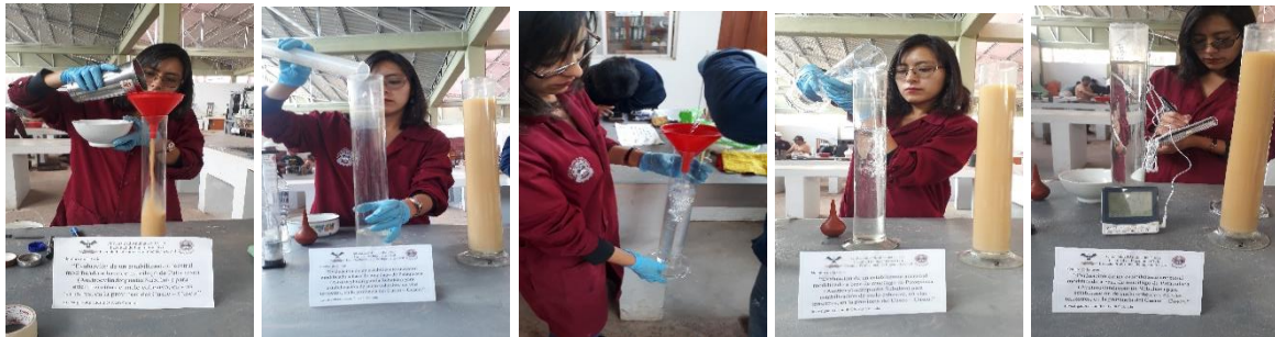
Figura 25. Procedimiento de preparación del cilindro de sedimentación y de control
