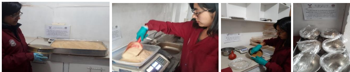
Figura 47. Preparación de muestras de suelo al contenido de humedad óptimo, ensayo compresión no confinada
