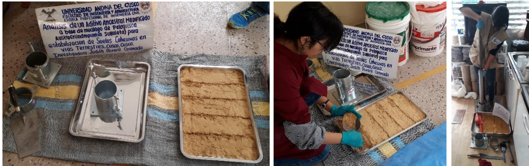
Figura 43. División del suelo en 5 partes iguales considerando las capas de compactación
