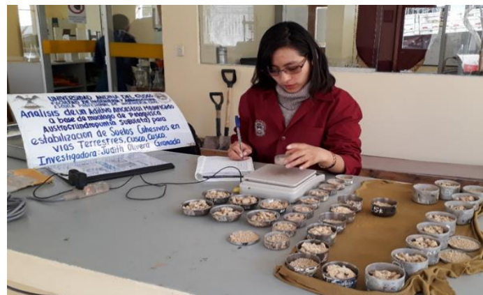
Figura 20. Registro del valor de peso de muestras de suelo seco
