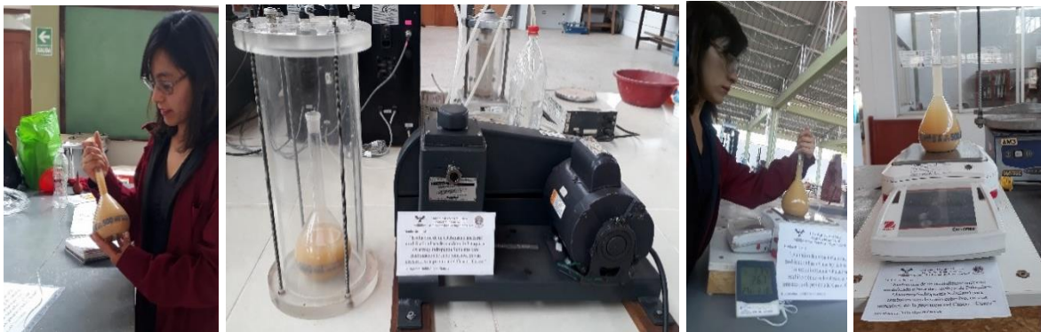
Figura 22. Ensayo de gravedad específica, desairado de la muestra y registro de peso
