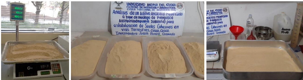
Figura 41. Preparación de 2.3 Kg de suelo para la adición de agua en los porcentajes establecidos
