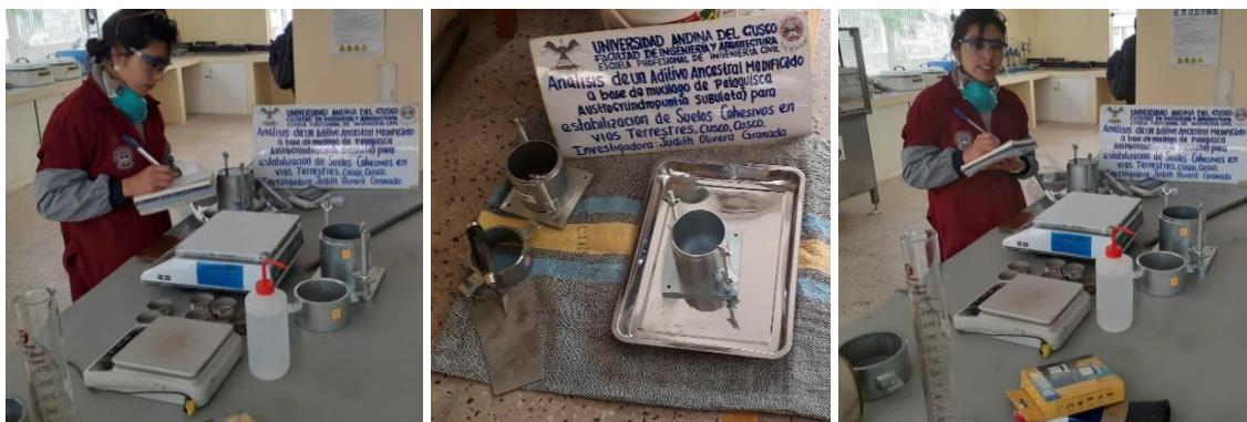
Figura 38. Calibración de instrumentos, ensayo Proctor Modificado
