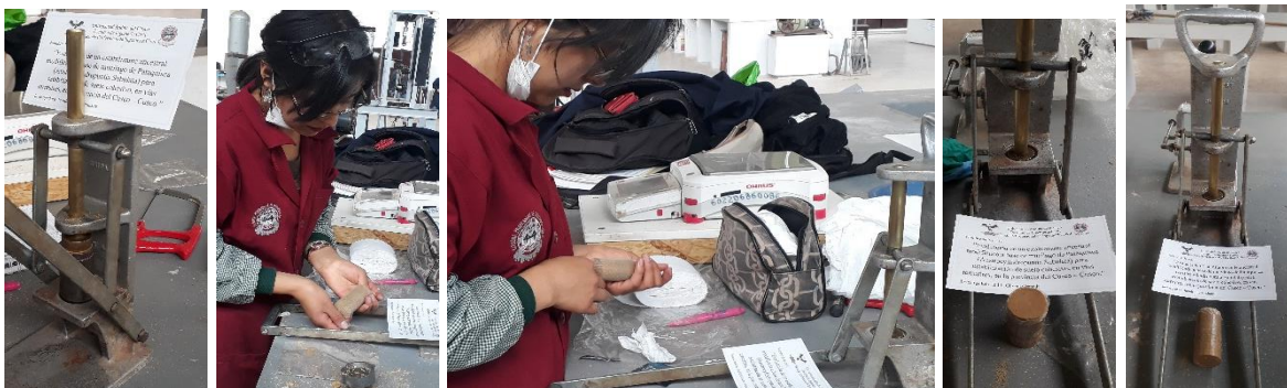
Figura 50. Extracción del suelo del molde de compactación y colocación de membrana
