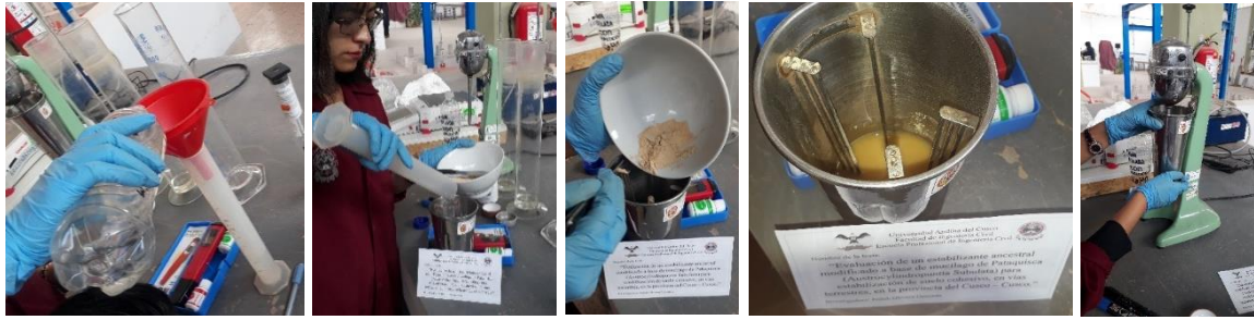
Figura 24 Transferencia de la mezcla en la maquina batidora
