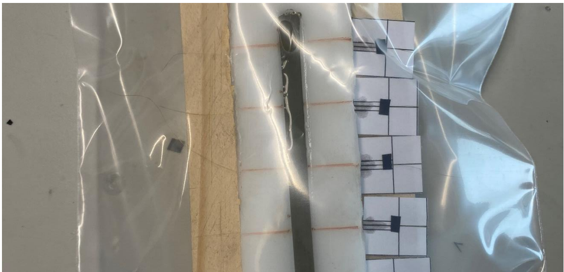
Figura 24: Molde con muestras acondicionado para el proceso de curado.
