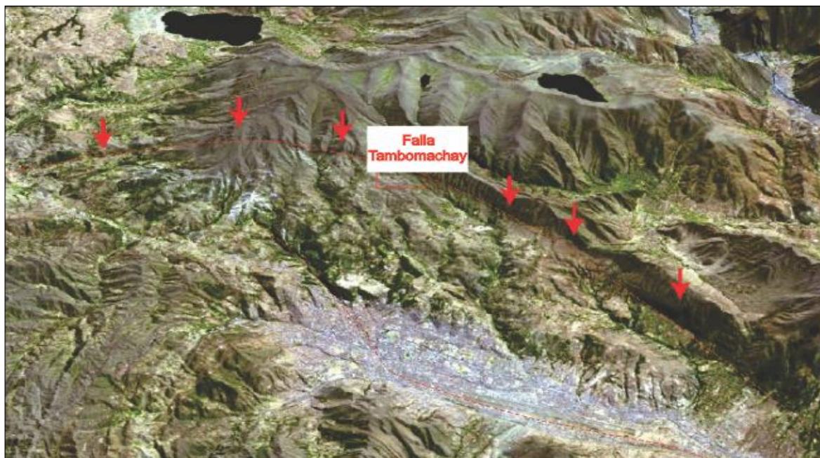
Figura N° 08. Desplazamiento de la falla evidenciado por las flechas rojas en el escarpe
