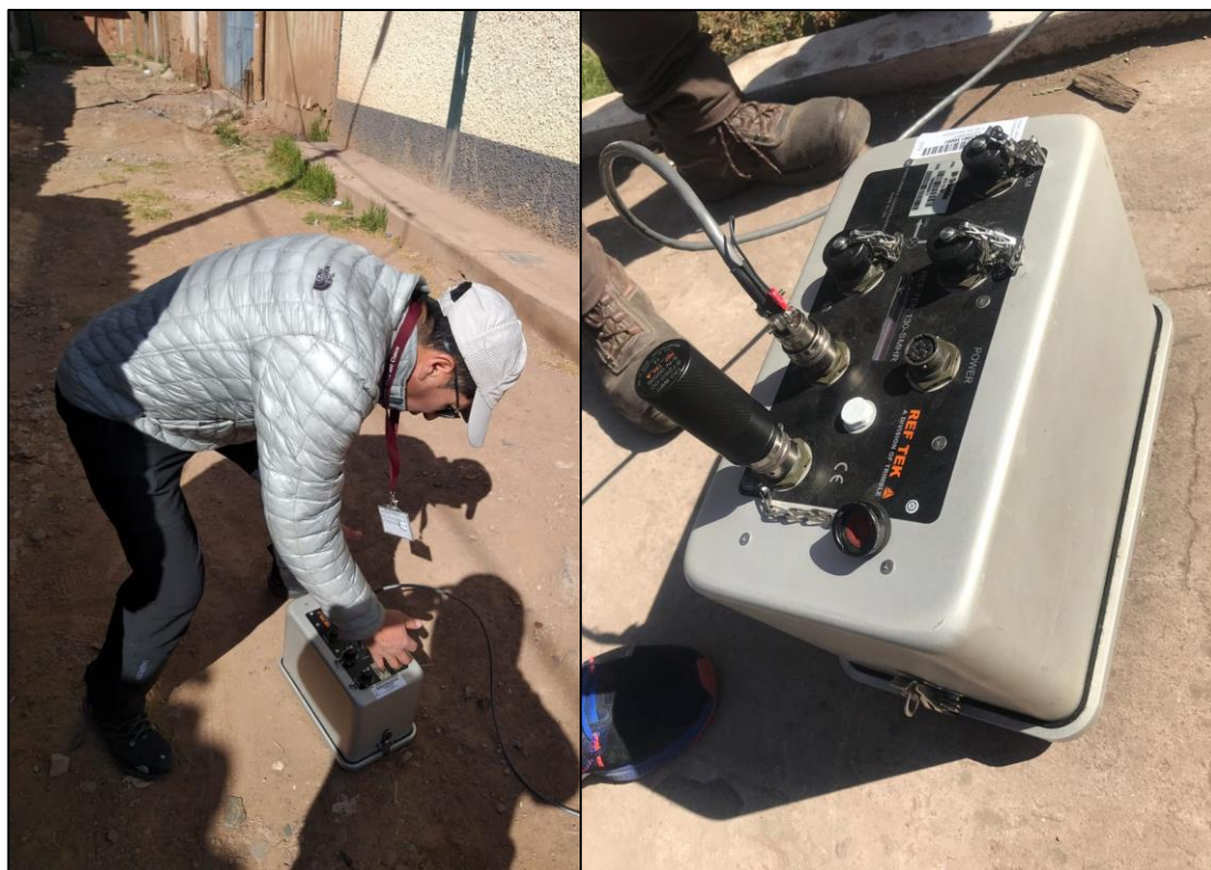
Fotografía N° 06. Instalación del Acelerómetro Ref Tek
