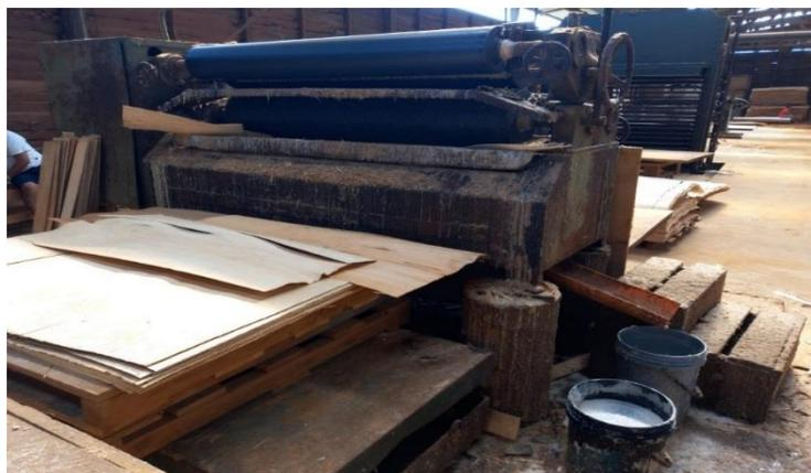
*Figura 8* Láminas Pasando por la Encoladora
