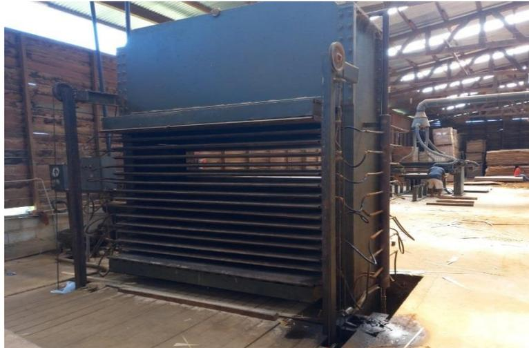
*Figura 10 Láminas Entrando a la Prensa Caliente*
