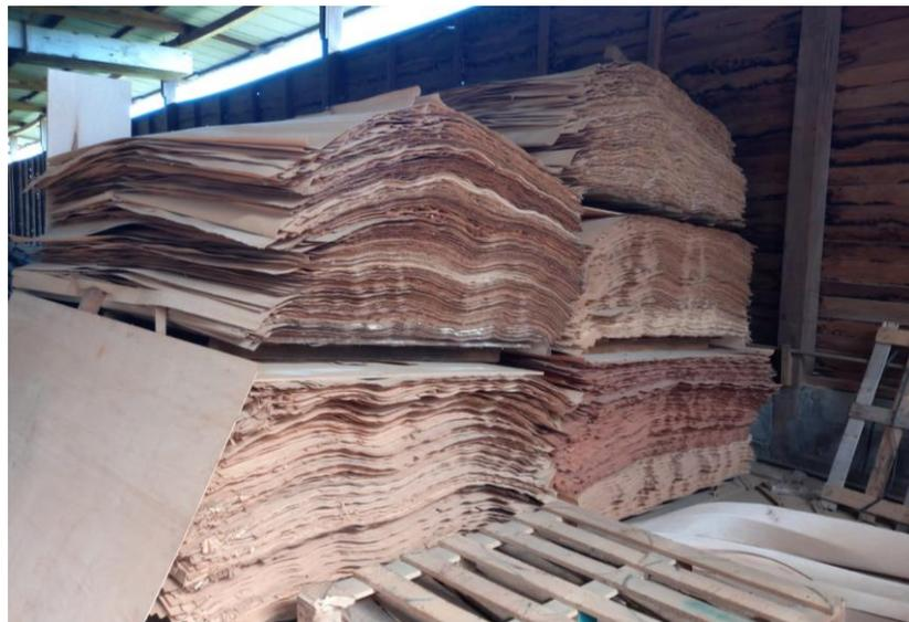
*Figura 6* Salida de las Láminas del Secadero
