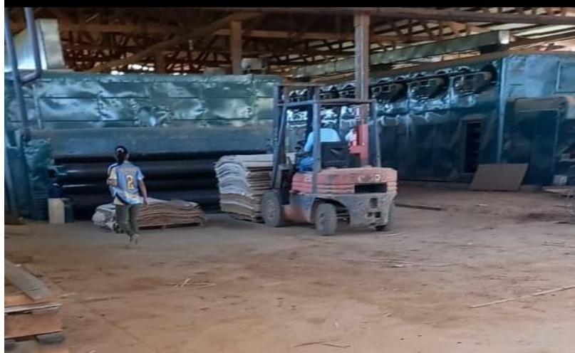
*Figura 5* Ingreso de Láminas Húmedas al Secadero
