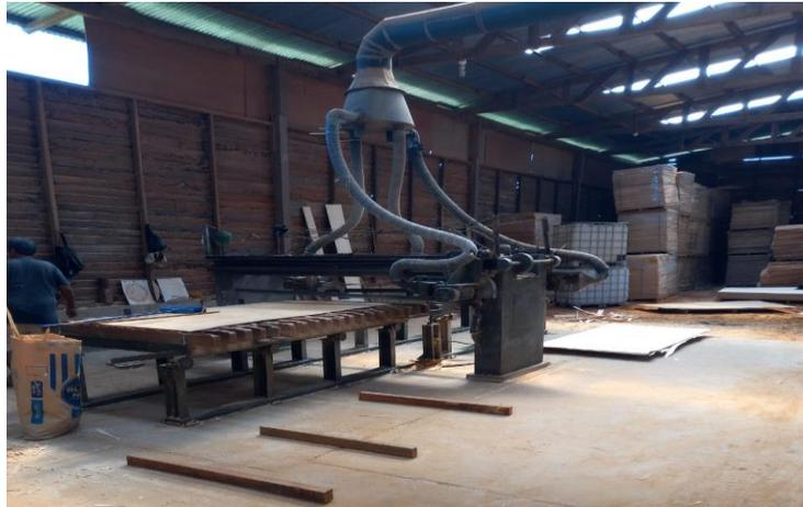
*Figura 11 Láminas Pasando por la Escuadradora manual y Maquina Lijadora*
