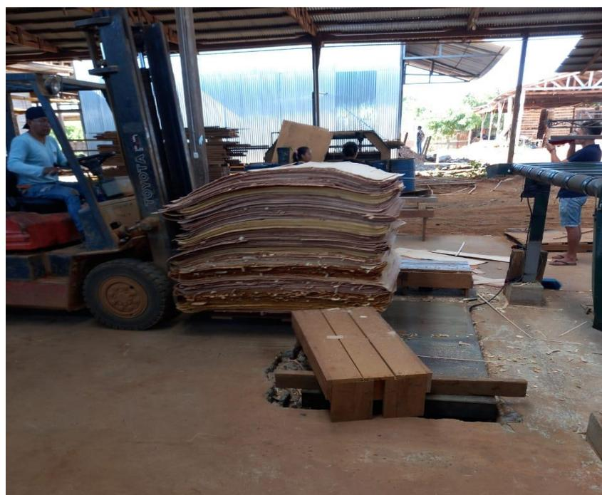
*Figura 4* Traslado de la Lámina al Secadero
