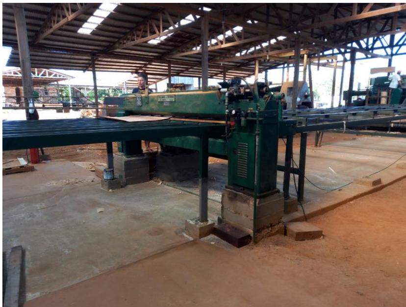
*Figura 3* Corte de la Lámina Mediante la Cizalla
