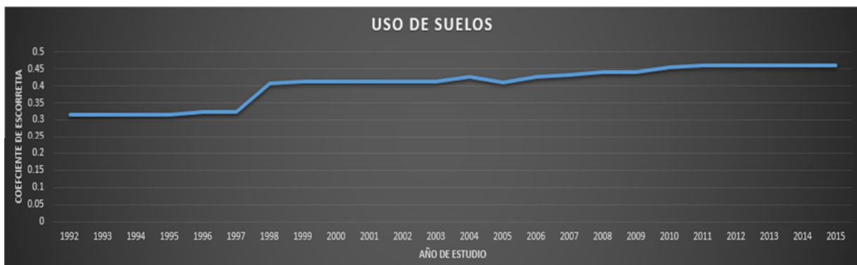
Figura 106: Coeficiente de escorrentía de acuerdo al uso del suelo de la cuenca Chuyapi del año 1992 al año 2015
