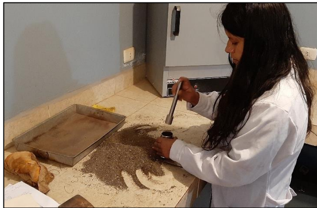
Ensayo con Molde Cónico para Agregado Fino
