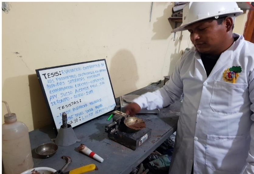
Figura N° 31. Colocado de la muestra a la copa de casa grande.
