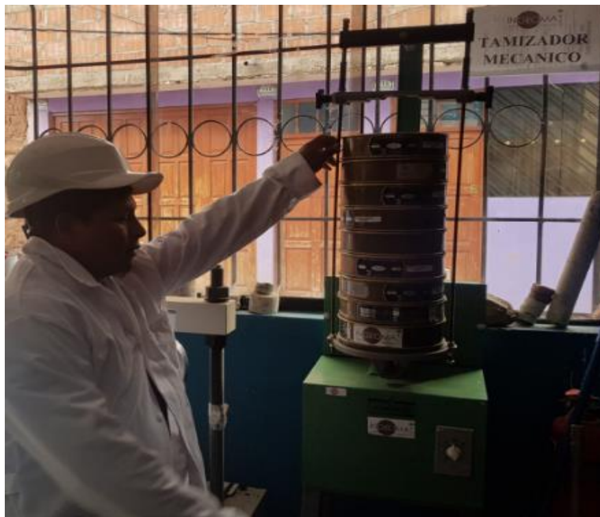
Figura N° 28. Tamizador con juego de tamices y muestra seca.
