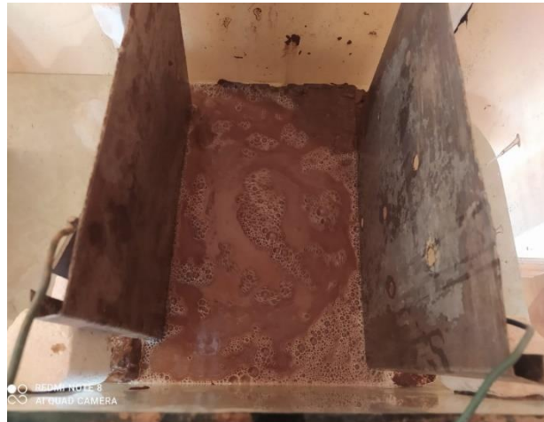
Figura N° 19. Inicio de la prueba de electroósmosis con muestra saturada.
