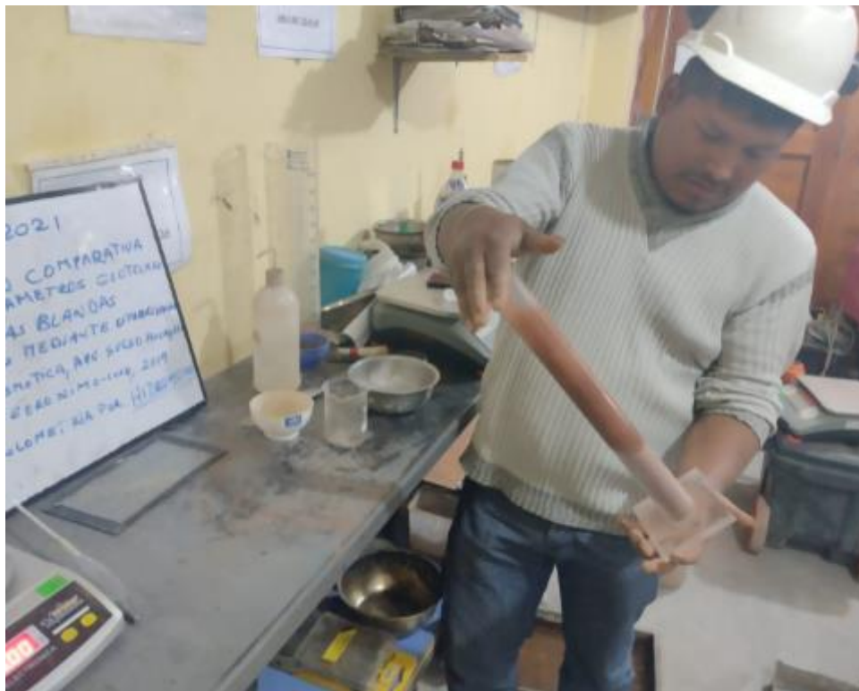
Figura N° 24. Mezclado de la muestra + agua con la solución.
