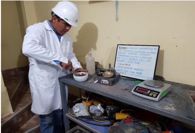
Figura N° 30. Mezclado de muestra con agua hasta formar una mezcla homogénea.
