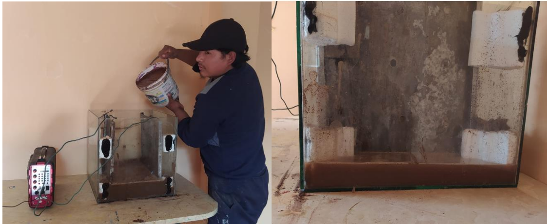
Figura N° 17. Colocación de muestra saturada en la cubeta de vidrio y drenado del agua en 1 día.
