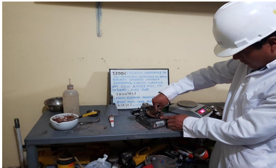
Figura N° 32. Se realiza un canal con el acanalador.
