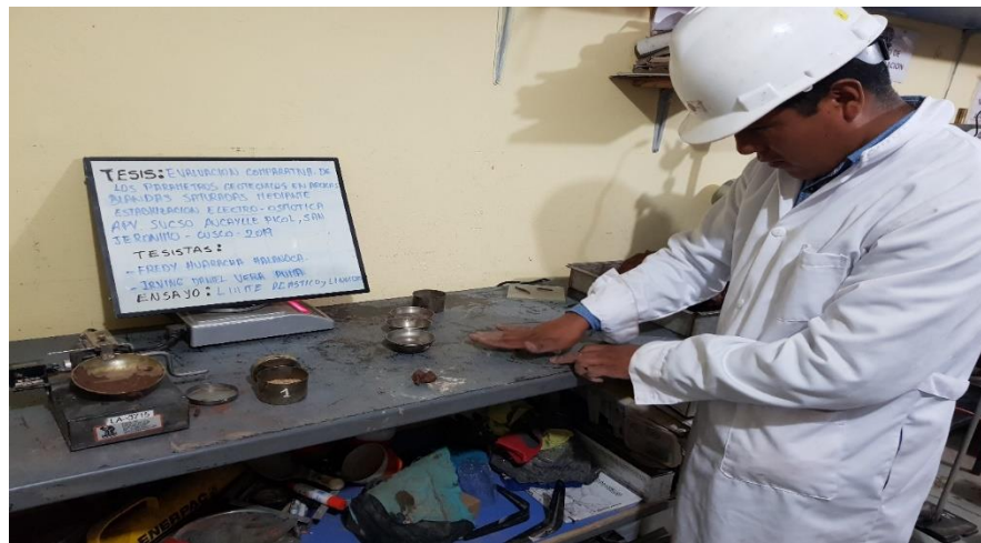
Figura N° 35. Moldeado de la muestra con la mano
