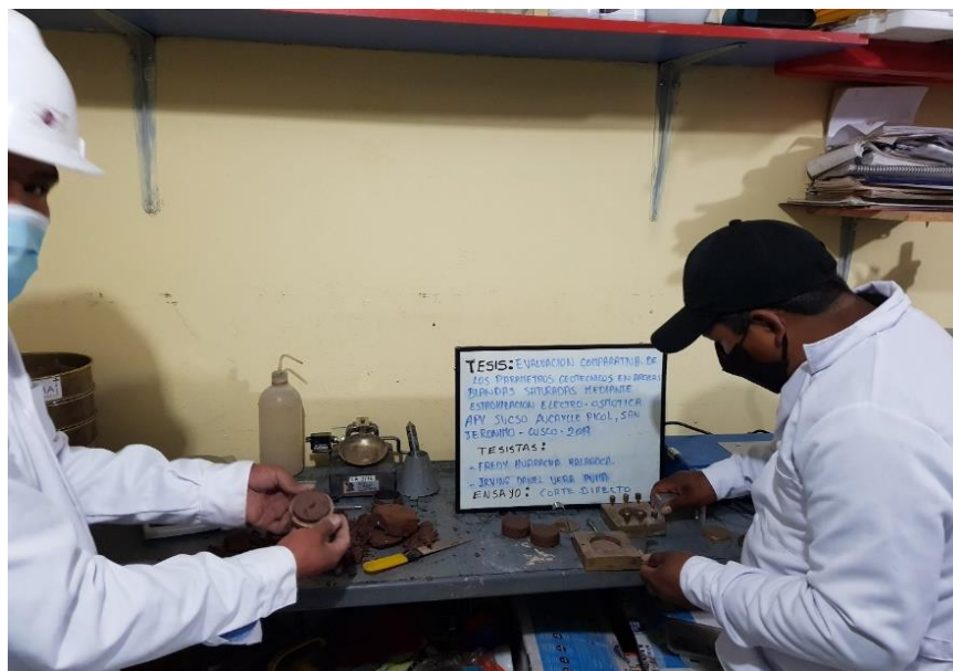
Figura N° 43. Ensamble de caja de corte con los marcos alineados y colocación de muestra.
