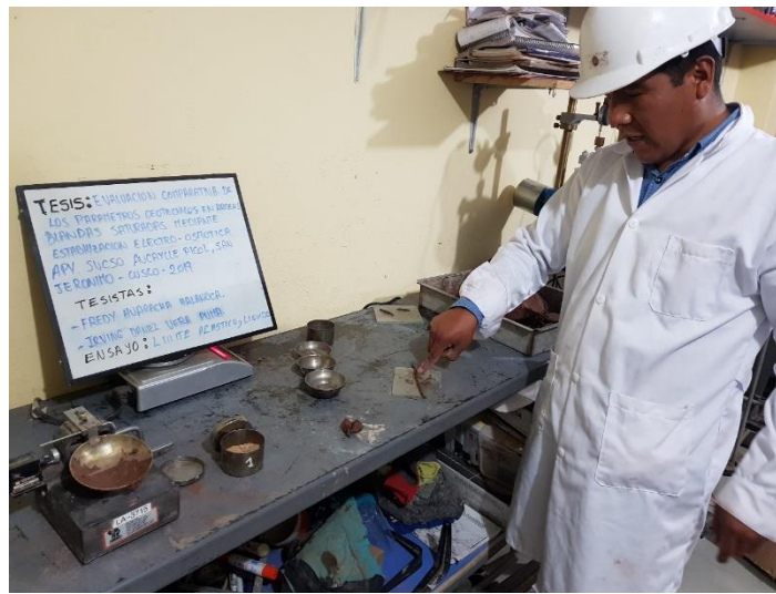
Figura N° 36. Rollo de suelo agrietado a los 3mm.
