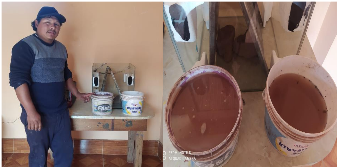
Figura N° 16. Saturación de la muestra con agua, reposada por 2 días.
