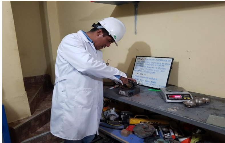
Figura N° 34. Recojo de muestra después del ensayo, pesado y colocación al horno.
