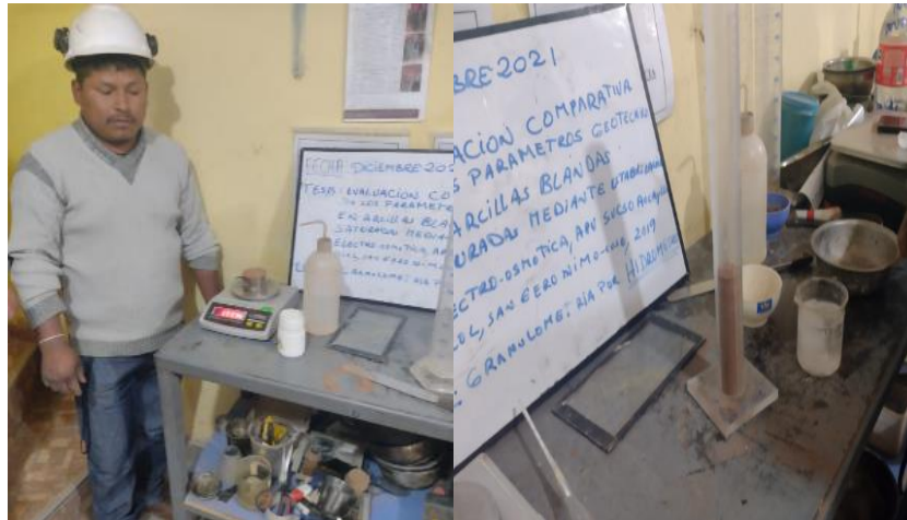
Figura N° 23. Pesado de la muestra y colocado al Cilindro de vidrio para sedimentación.
