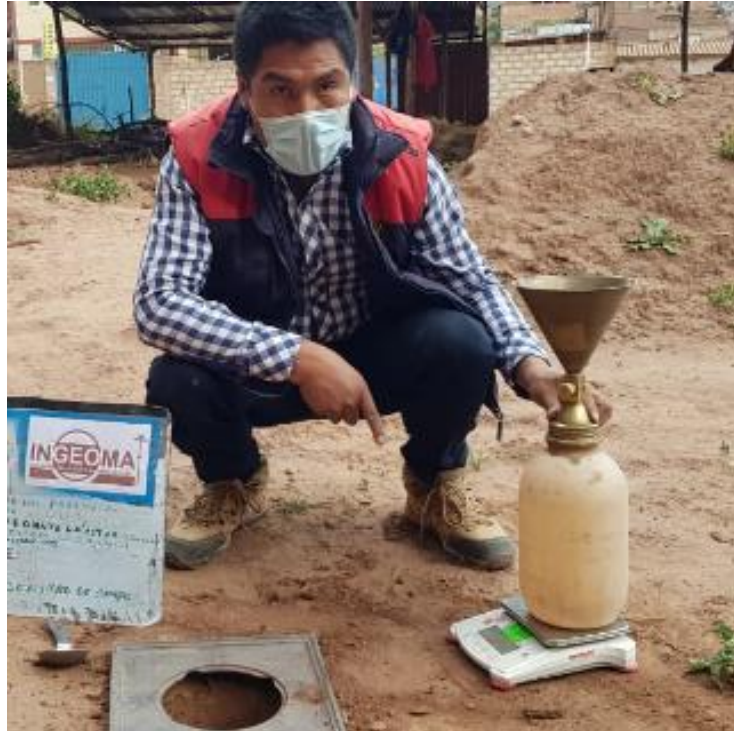
Figura N° 11. Pesado del cono con la arena.
