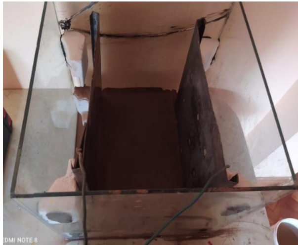
Figura N° 20. Final de la prueba de electroósmosis con la muestra semi seca.
