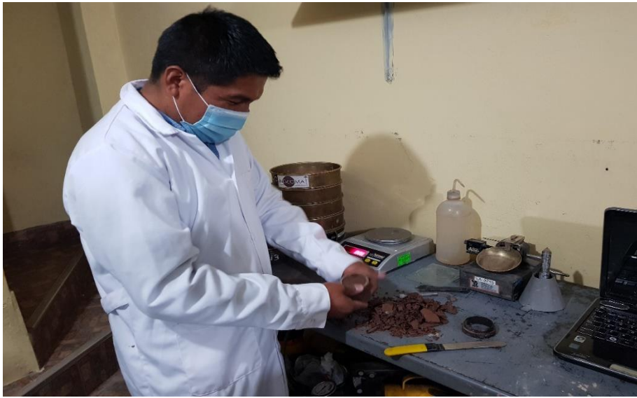
Figura N° 41. Tallado de las muestras para ensayo de corte directo.
