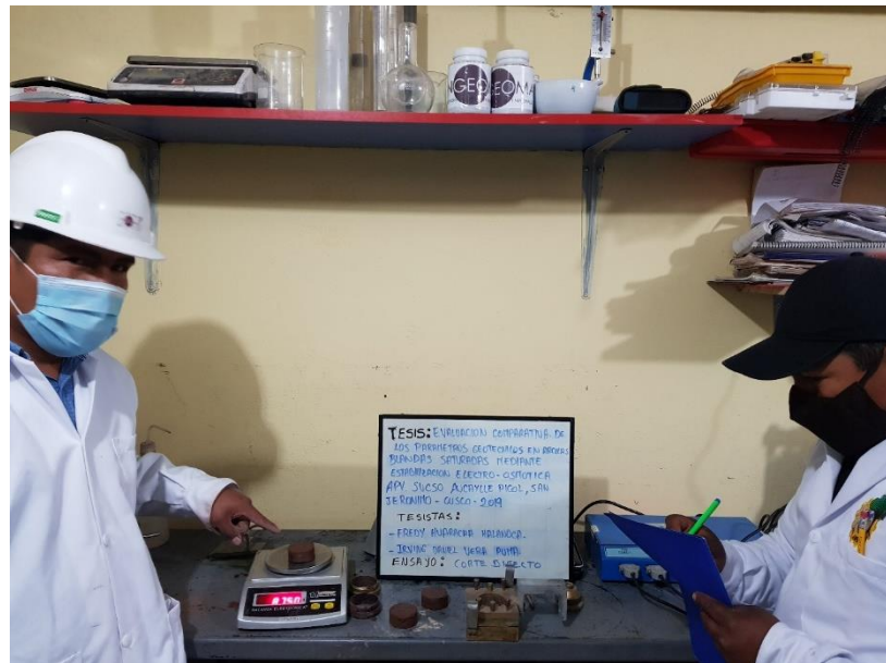
Figura N° 42. Determinación del peso inicial de las muestras para ensayo de corte directo.
