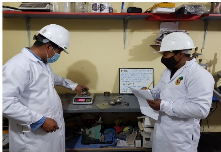
Figura N° 37. Recojo de muestras después del ensayo de limite plástico y pesado
