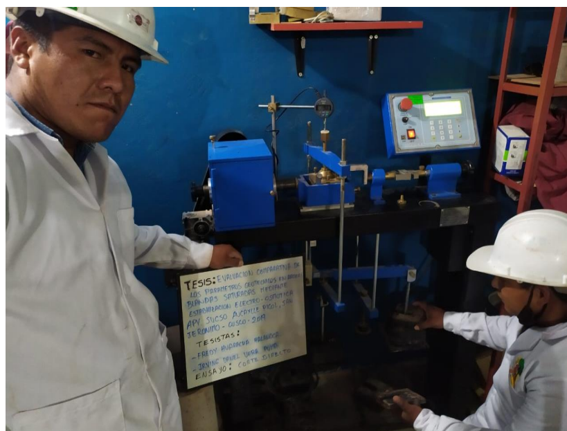
Figura N° 44. Incremento de peso de 4 Kg a 8 Kg para ensayo de corte directo.
