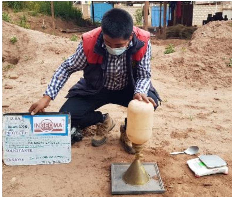
Figura N° 13. Colocado de la arena calibrada que llevamos en el contenedor sobre el agujero realizado.
