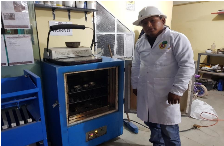
Figura N° 27. Secado en el horno de la muestra por 24 horas.
