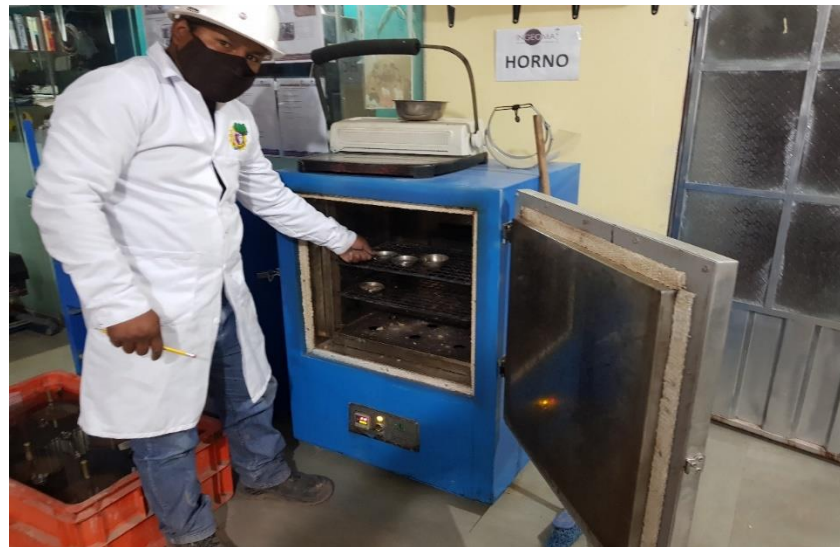
Figura N° 39. Colocado de muestra al horno por 24 hora.
