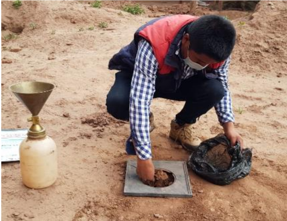
Figura N° 12. Excavación dentro del círculo de la placa base a unos 15 cm aproximado y recojo del material en bolsa.
