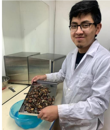
Figura 59: Agregado grueso escurriéndose de la solución de sulfato de magnesio Fuente: Propia
