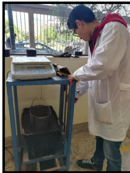
Figura 98: Determinación del peso sumergido de los especímenes patrones Fuente: Propia
