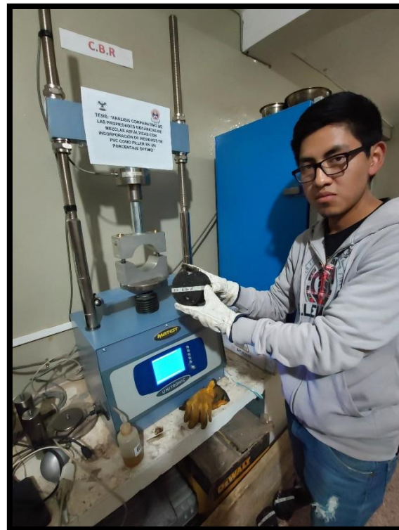
Figura 85: Colocado de los especímenes compactados en el cabezal de rotura Fuente: Propia
