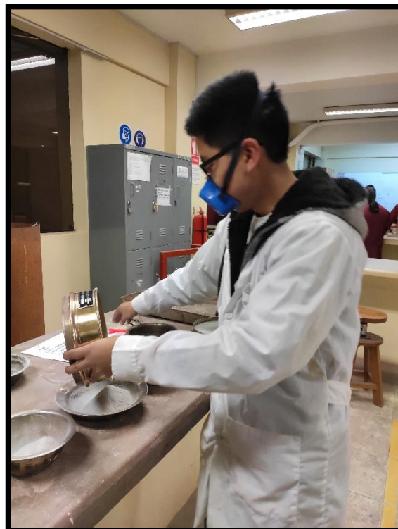
Figura 125: Extracción del PVC retenido en los tamices: Fuente: Propia
