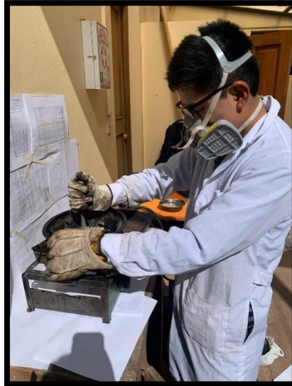
Figura 131: Elaboración de la mezcla asfáltica Fuente: Propia
