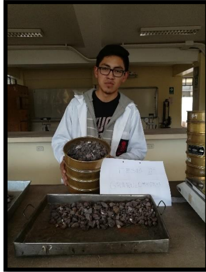
Figura 21: Serie de tamices para el agregado grueso ensamblada con agregado dentro Fuente: Propia
