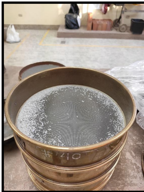
Figura 121: PVC triturado retenido en el tamiz #40 Fuente: Propia
