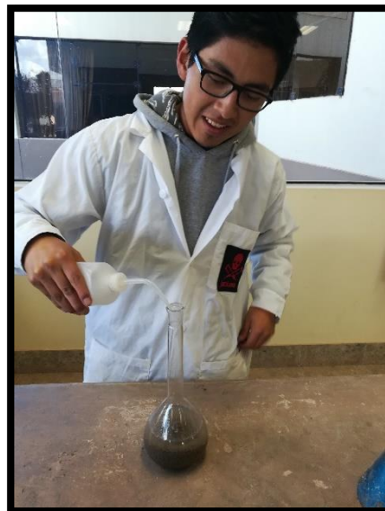
Figura 44: Llenado del matraz con agua Fuente: Propia
