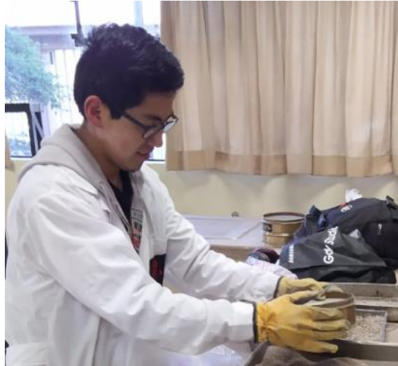
Figura 30: Tamizaje en el tamiz N° 10 del material Fuente: Propia
