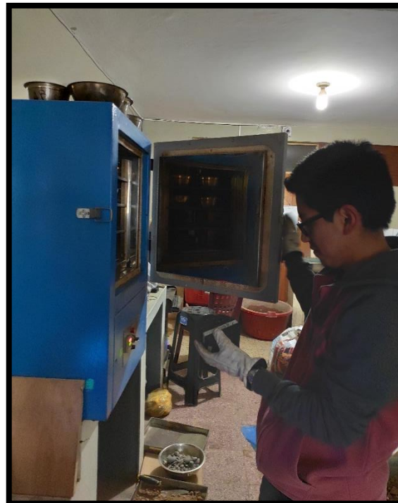
Figura 105: Extracción de los especímenes del horno para ensayarlos Fuente: Propia
