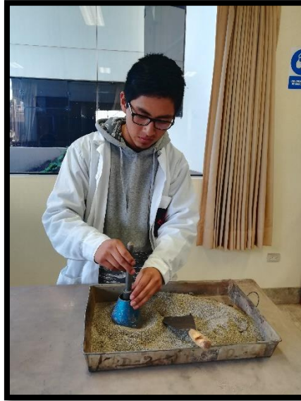
Figura 41: Compactación del agregado con el molde cónico Fuente: Propia
