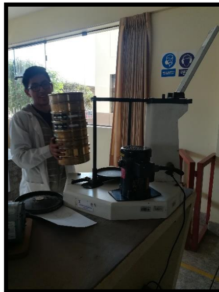
Figura 26: Tamizado del agregado fino Fuente: Propia
