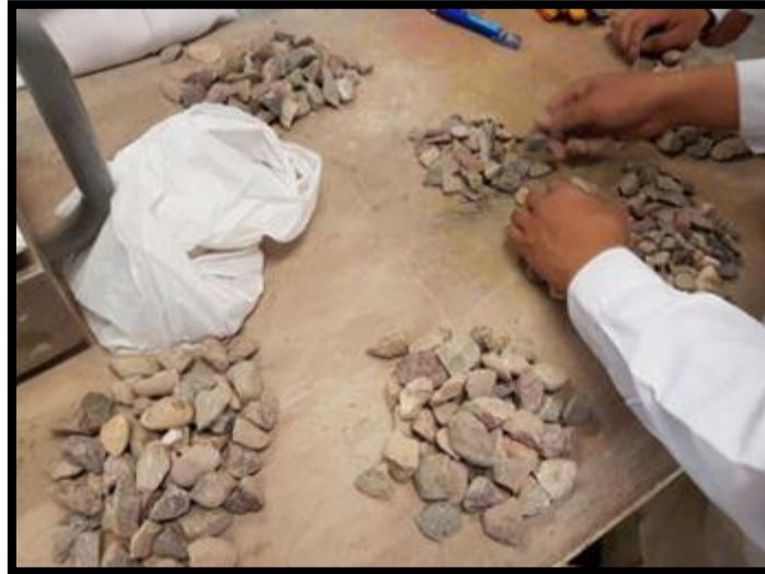
Figura 33: Agrupación de las porciones de agregado retenido por tamices Fuente: Propia
