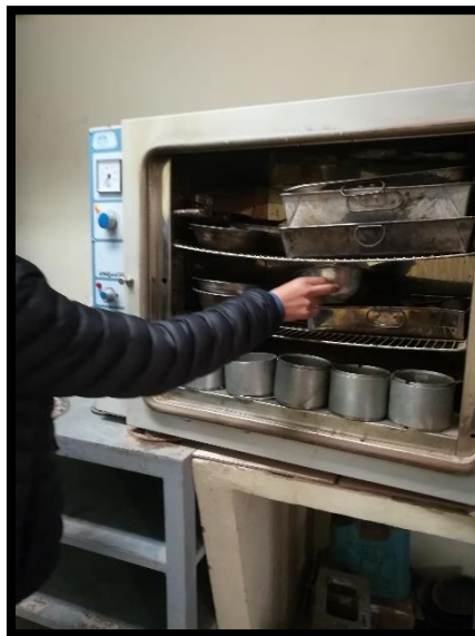
Figura 70: Calentado de materiales necesarios para la mezcla asfáltica a temperatura de mezclado Fuente: Propia
