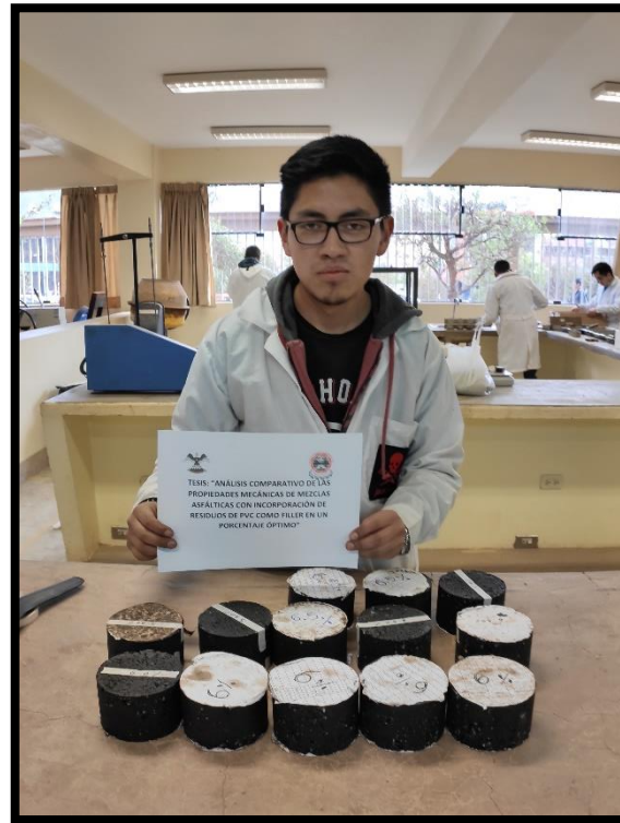
Figura 137: Especímenes de mezclas asfálticas modificadas eyectadas Fuente: Propia
