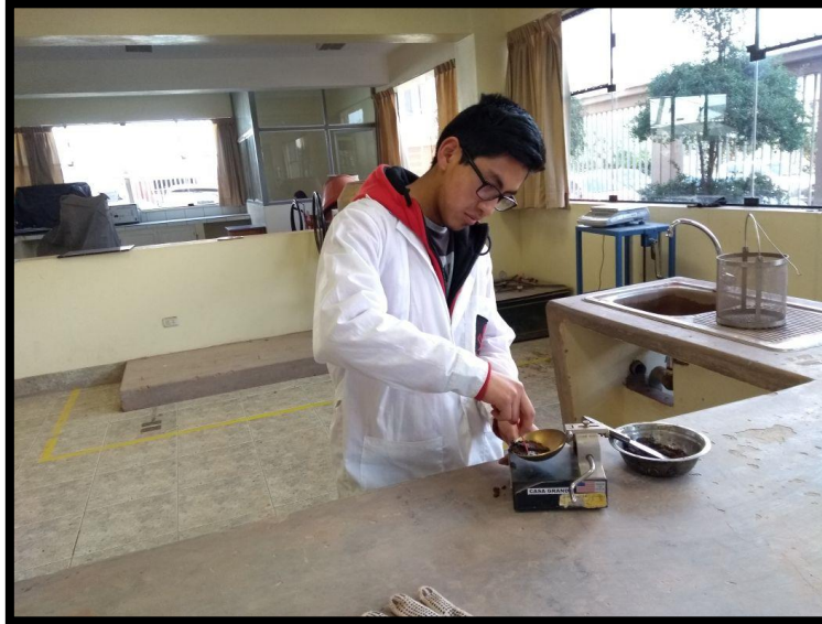
Figura 50: División de la muestra con el ranurador Fuente: Propia
