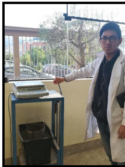
Figura 36: Peso del agregado sumergido Fuente: Propia
