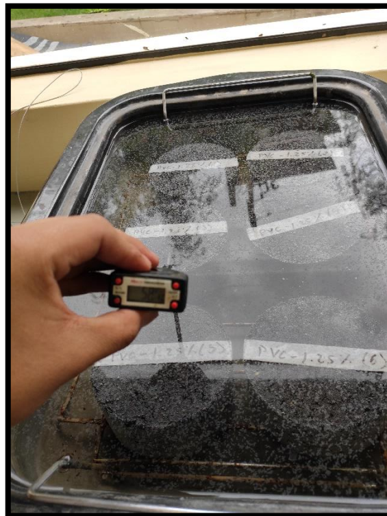
Figura 103: Especímenes patrón calentados en baño maría a 60 °C por 30 minutos Fuente: Propia
