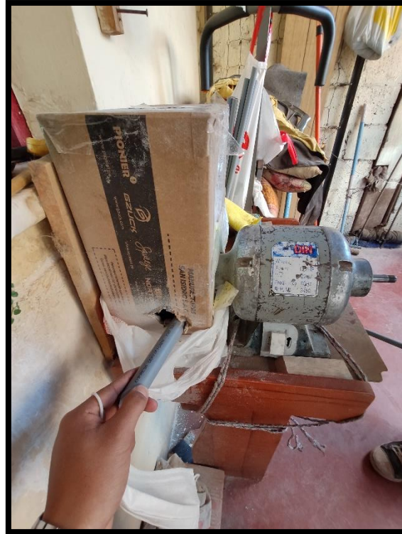
Figura 114: Introducción del tubo de PVC dentro de la caja para rasparlo con la piedra porosa Fuente: Propia
