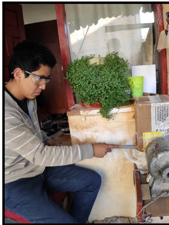
Figura 113: Raspado de tubo de PVC Fuente: Propia
