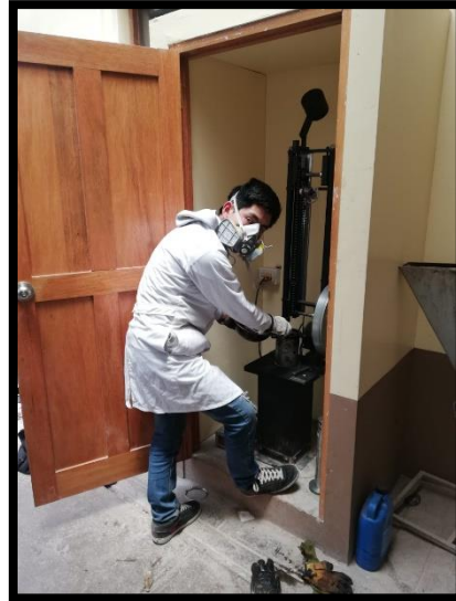
Figura 135: Vertido de la mezcla asfáltica modificada Fuente: Propia
