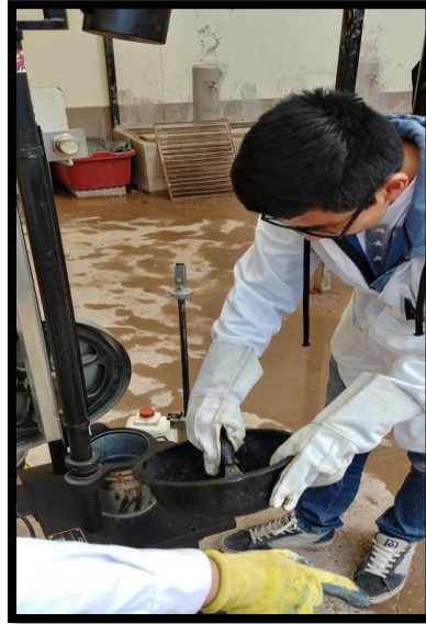
Figura 93: Vertido de la mezcla asfáltica patrón en el molde de compactación ensamblado Fuente: Propia
