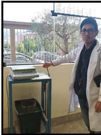
Figura 78: Determinación del peso sumergido de los especímenes Fuente: Propia
