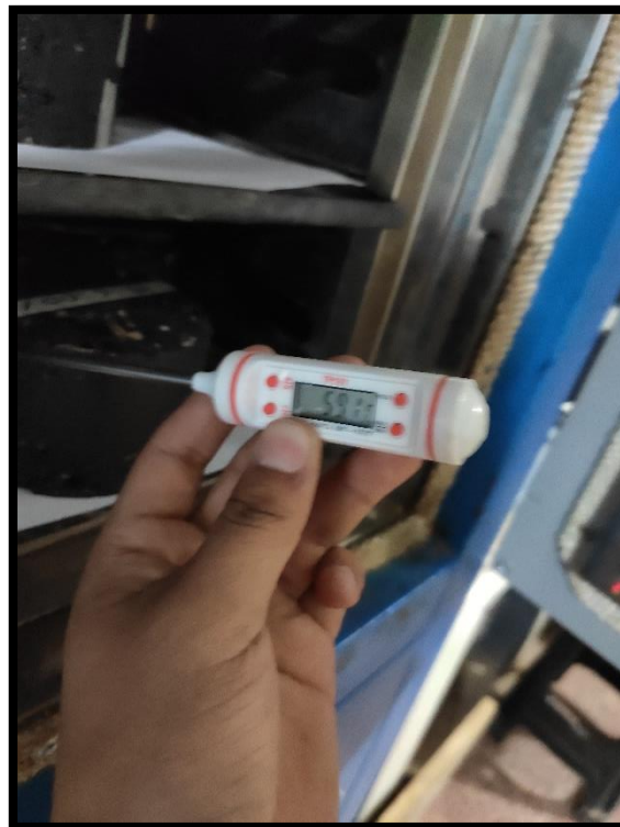
Figura 84: Verificación de la temperatura de los especímenes compactados Fuente: Propia
