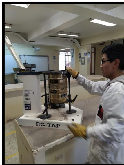
Figura 64: Tamizado del agregado Fuente: Propia
