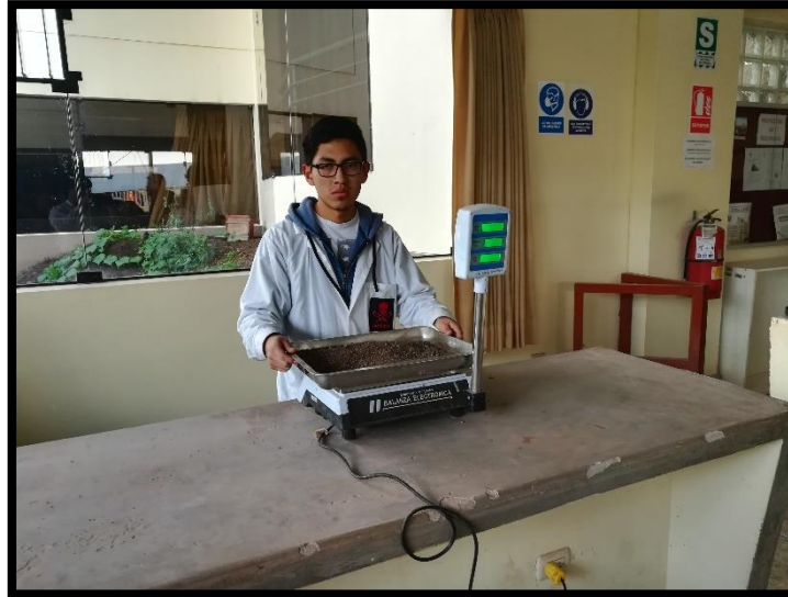
Figura 39: Peso del agregado grueso seco Fuente: Propia
