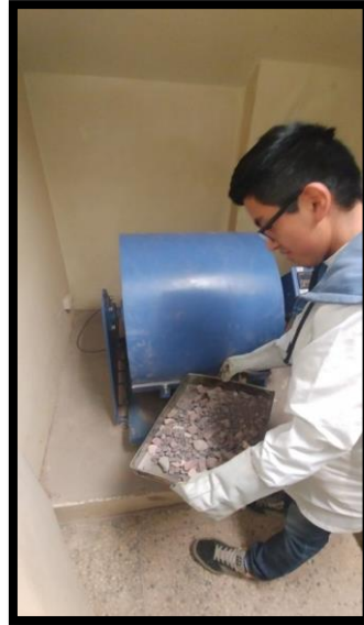
Figura 28: Colocación del agregado dentro de la máquina de abrasión los angeles Fuente: Propia
