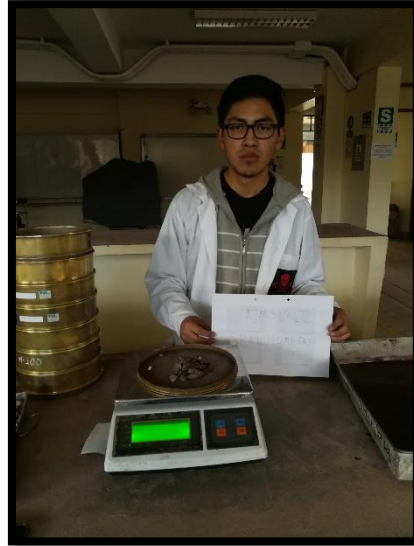
Figura 23: Peso del agregado retenido en el tamiz Fuente: Propia
