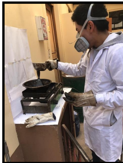
Figura 92: Mezclado del agregado y asfalto de la mezcla asfáltica patrón Fuente: Propia
