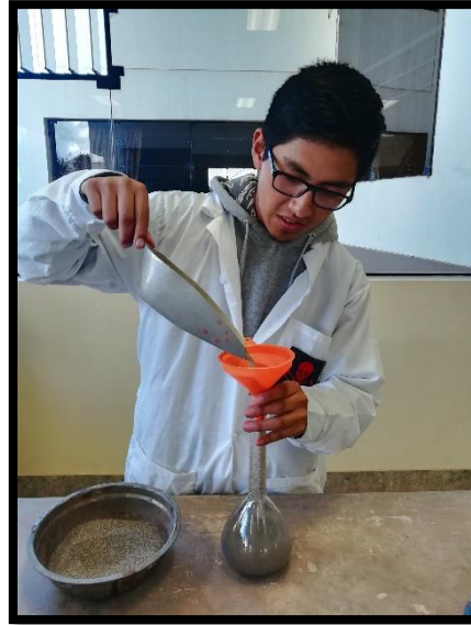
Figura 43: Colocando el agregado dentro del matraz aforado Fuente: Propia
