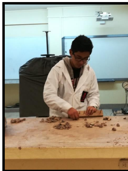
Figura 34: Utilización del calibrador para partículas alargadas Fuente: Propia
