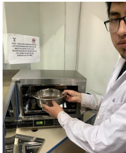
Figura 62: Colocación de muestras para secarse en el horno a 110 °C Fuente: Propia
