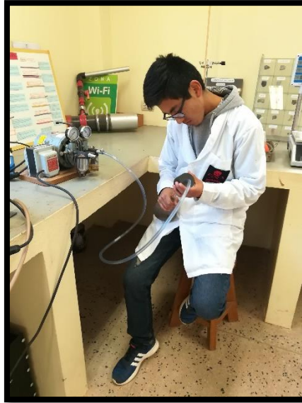
Figura 45: Extracción de las burbujas de aire con la bomba de vacíos Fuente: Propia
