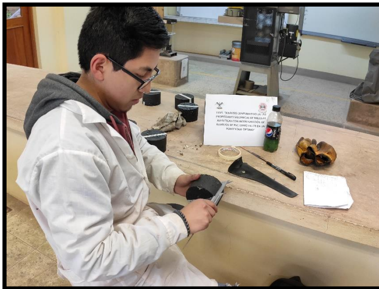
Figura 142: Determinación del espesor del espécimen de la mezcla asfáltica modificada Fuente: Propia
