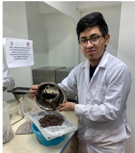
Figura 60: Arena triturada escurriéndose de la solución de sulfato de magnesio Fuente: Propia
