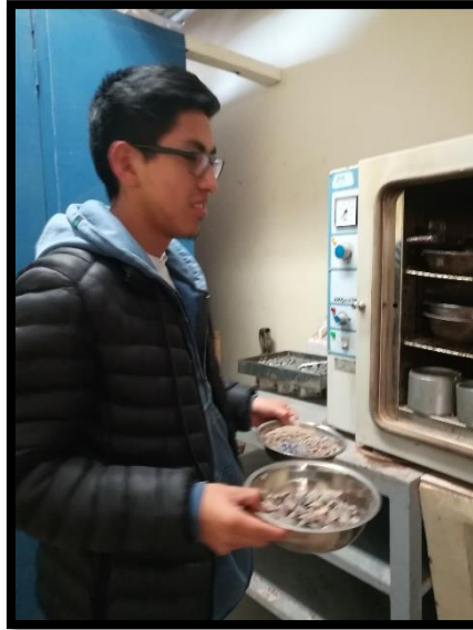
Figura 69: Calentado de agregados y molde de compactación a temperatura de la mezcla Fuente: Propia
