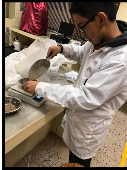
Figura 67: Dosificación del agregado fino Fuente: Propia
