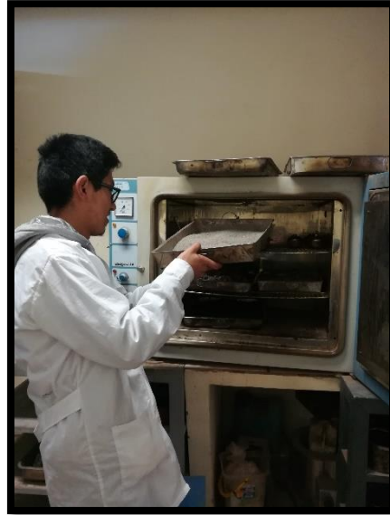
Figura 47: Secado del agregado fino en el horno Fuente: Propia
