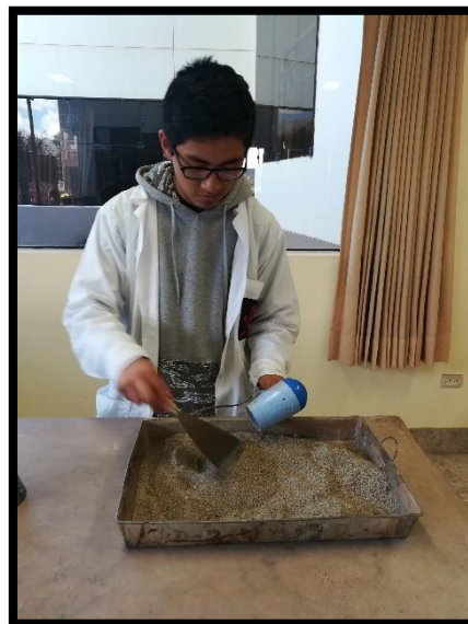
Figura 40: Secado del agregado con aire caliente Fuente: Propia
