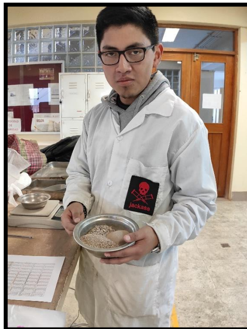
Figura 130: Agregado y filler dosificados listos para ser calentados en el horno a temperatura de la mezcla Fuente: Propia
