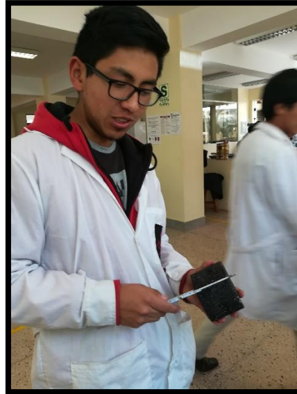
Figura 82: Medición de la altura del espécimen compactado Fuente: Propia
