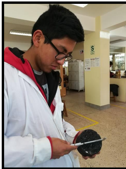
Figura 81: Medición del diámetro del espécimen compactado Fuente: Propia
