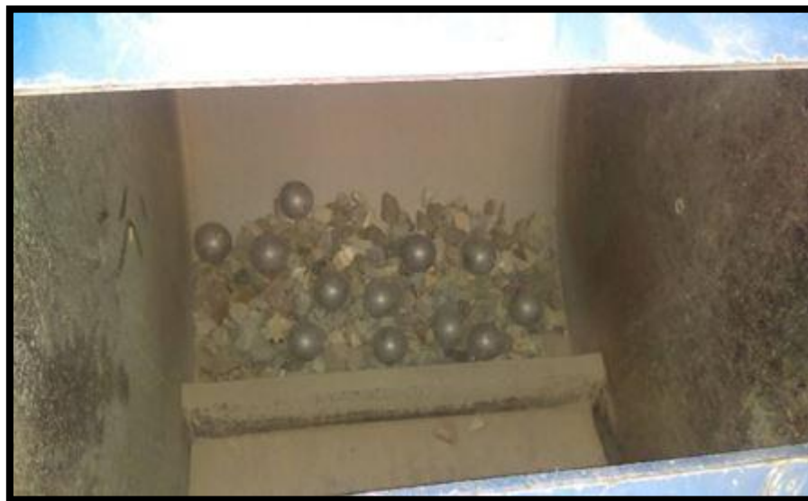
Figura 29: Agregado grueso dentro de la máquina de abrasión con la carga abrasiva Fuente: Propia
