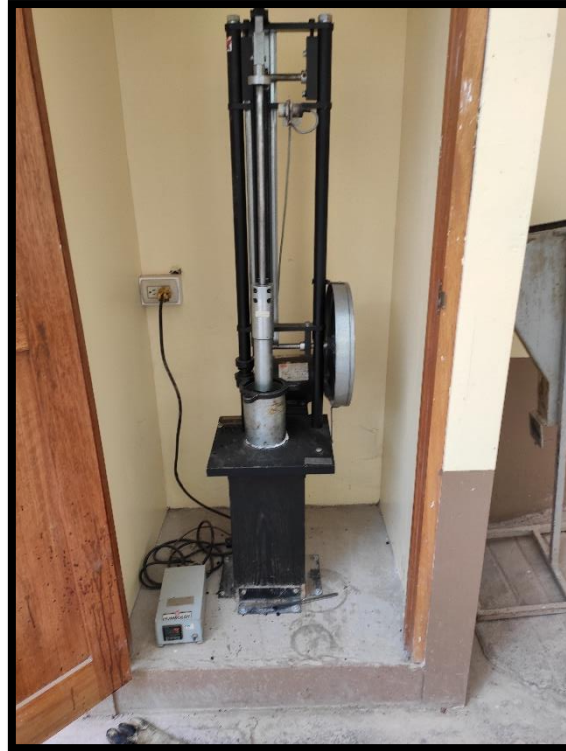
Figura 94: Compactado de la mezcla asfáltica patrón Fuente: Propia
