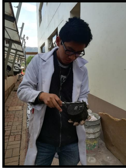
Figura 101: Medición del diámetro de los especímenes patrón Fuente: Propia
