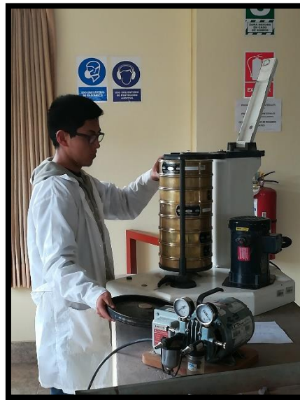
Figura 88: Tamizado de los agregados para preparación de la mezcla asfáltica patrón Fuente: Propia
