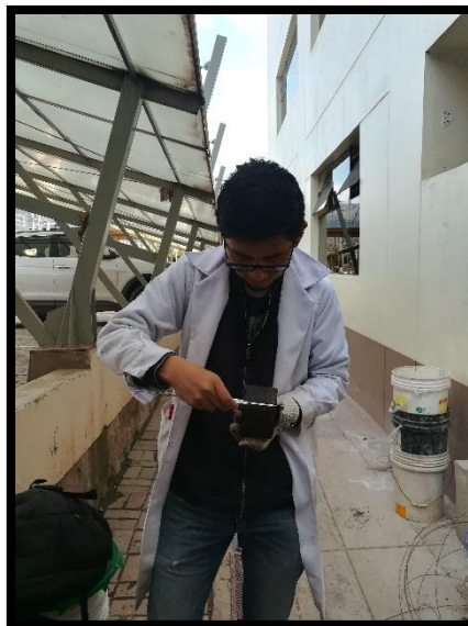
Figura 100: Medición del espesor de los especímenes patrón Fuente: Propia
