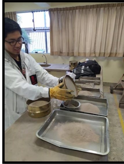
Figura 65: Separación por fracciones de retenido del agregado fino Fuente: Propia
