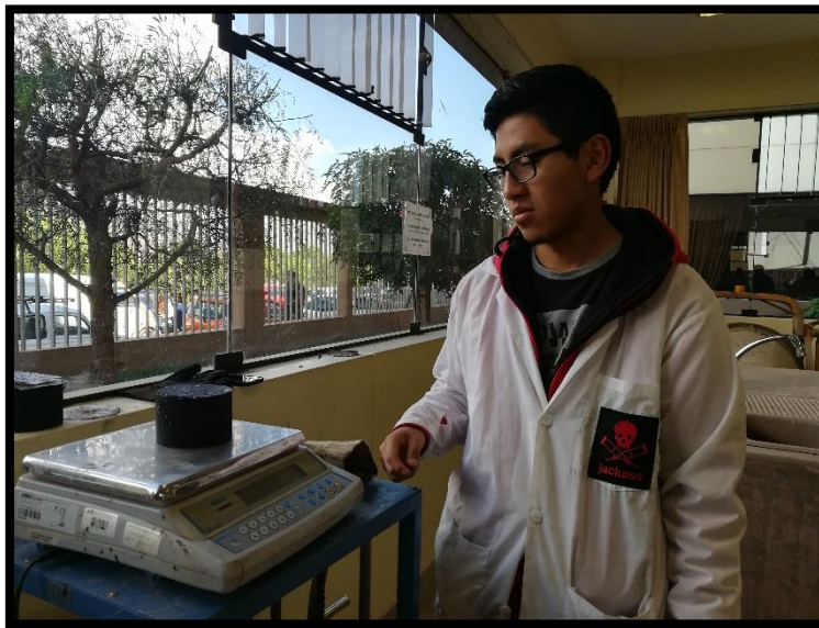
Figura 96: Peso del espécimen patrón seco Fuente: Propia
