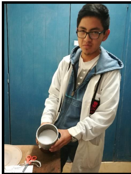
Figura 134: Preparación de los moldes de compactación para el vertido de la mezcla asfáltica modificada Fuente: Propia
