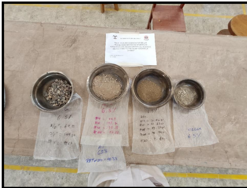
Figura 68: Dosificación de los agregados Fuente: Propia
