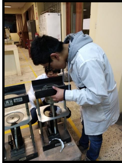
Figura 75: Eyeción de las mezclas asfálticas compactadas Fuente: Propia
