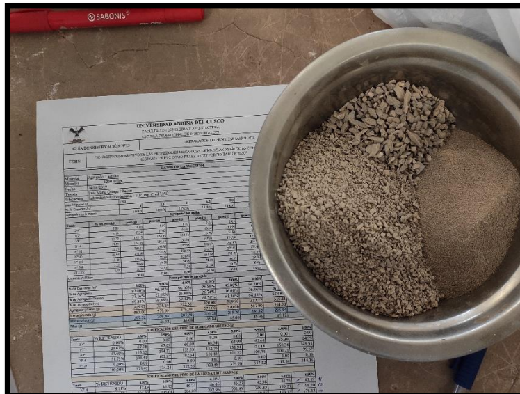
Figura 90: Agregado combinado necesario para elaborar la mezcla asfáltica patrón Fuente: Propia
