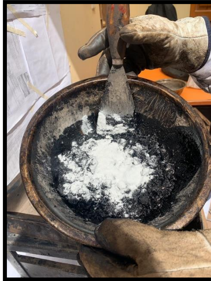
Figura 133: Mezcla asfáltica con los residuos de PVC Fuente: Propia
