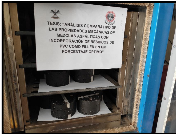
Figura 83: Especímenes colocados en el horno a 60 °C Fuente: Propia
