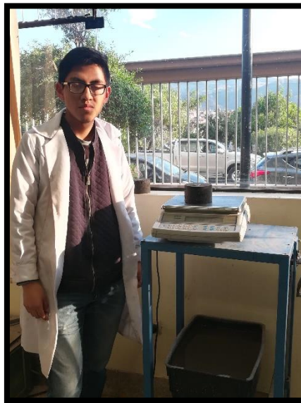
Figura 76: Determinación del peso seco de los especímenes Fuente: Propia
