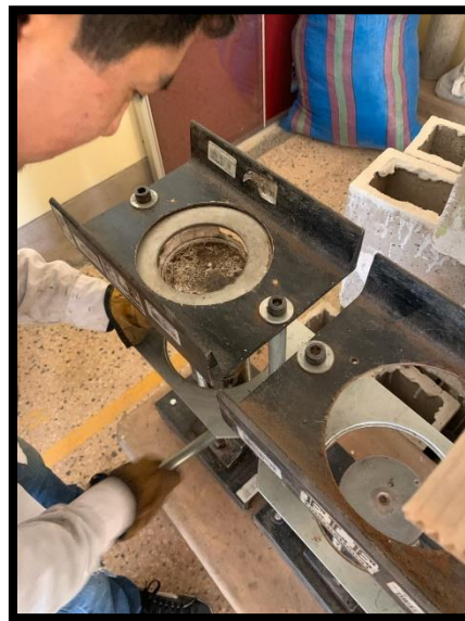
Figura 95: Eyección de la mezcla asfáltica patrón compactada Fuente: Propia
