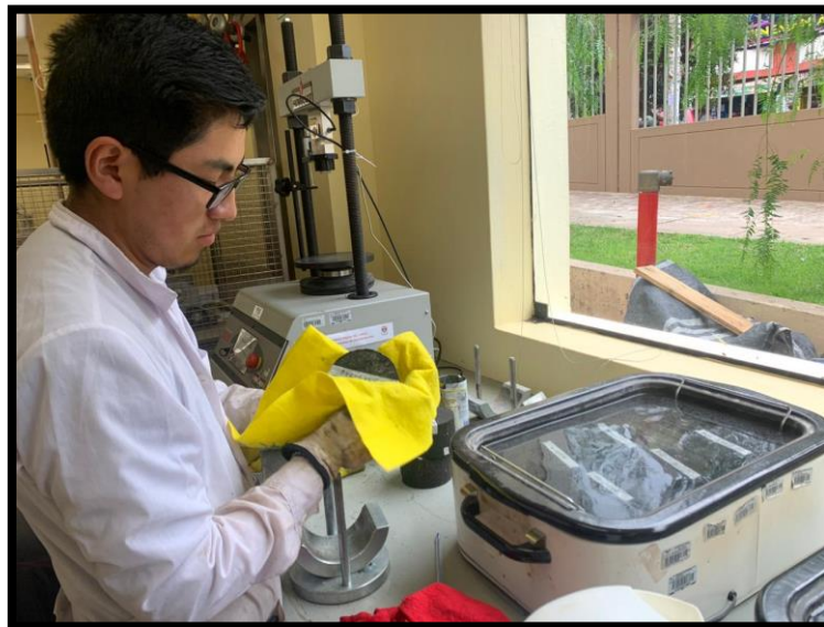
Figura 146: Secado de los especímenes de mezclas asfálticas modificadas con franela para ensayar su resistencia
