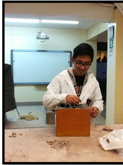
Figura 35: Utilización del calibrador para partículas achatadas Fuente: Propia
