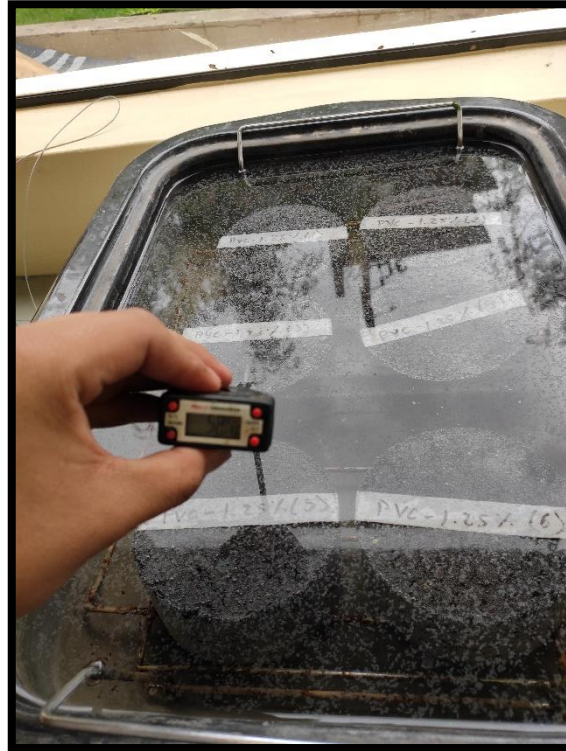
Figura 139: Especímenes de mezclas asfálticas modificadas sumergidas en baño maría a 25 °C Fuente: Propia
