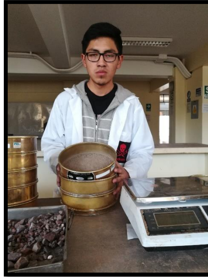
Figura 25: Serie de tamices para el agregado fino ensamblada con agregado dentro Fuente: Propia
