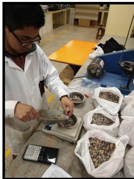
Figura 66: Dosificación del agregado grueso Fuente: Propia
