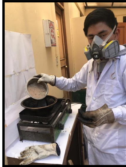
Figura 91: Incorporación del agregado combinado a la mezcla Fuente: Propia
