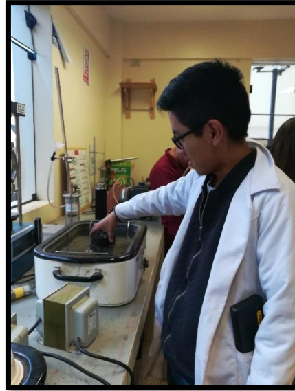
Figura 106: Extracción del espécimen patrón del baño maría para ensayar su resistencia Fuente: Propia
