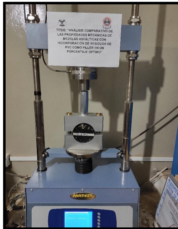
Figura 86: Muestra dentro del cabezal de rotura lista para ser ensayada Fuente: Propia
