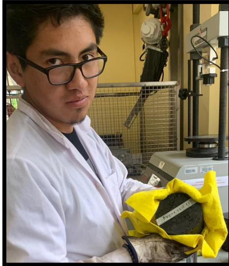
Figura 141: Secado del espécimen de mezcla asfáltica modificada para determinar su peso saturado superficialmente seco Fuente: Propia
