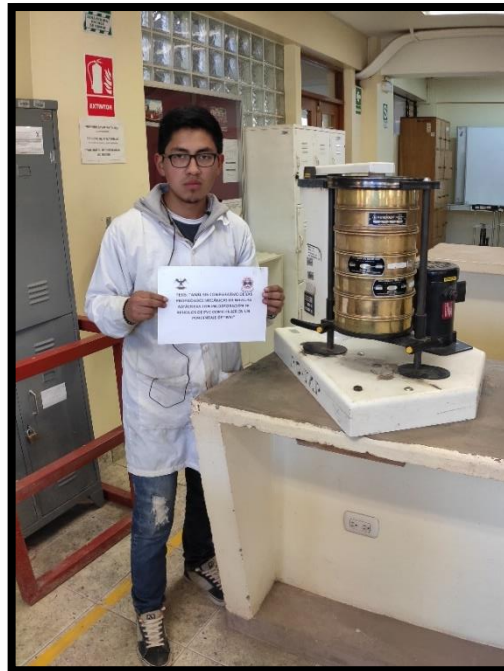
Figura 118: Serie de tamices con los residuos de PVC colocadas dentro de la tamizadora Fuente: Propia
