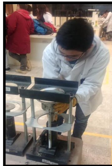
Figura 136: Eyección de la mezcla asfáltica modificada compactada Fuente: Propia
