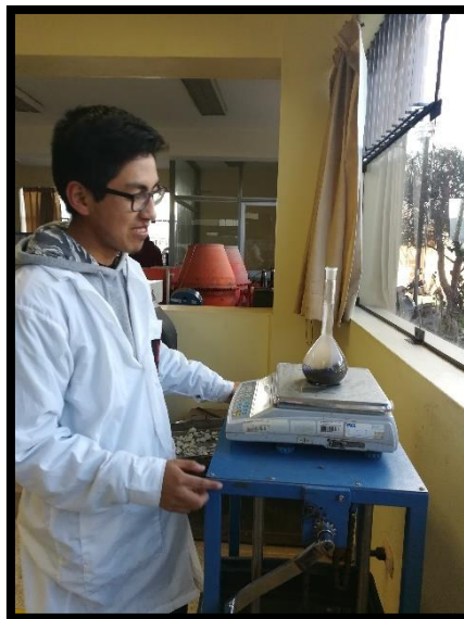
Figura 46: Peso del matraz con agregado y agua Fuente: Propia
