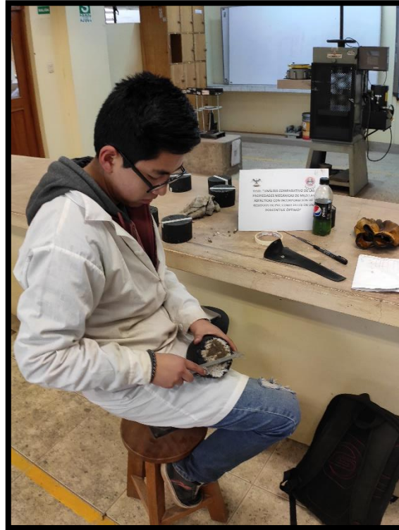
Figura 143: Determinación del diámetro del espécimen de la mezcla asfáltica modificada Fuente: Propia
