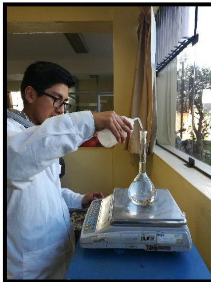
Figura 42: Peso del matraz con agua Fuente: Propia
