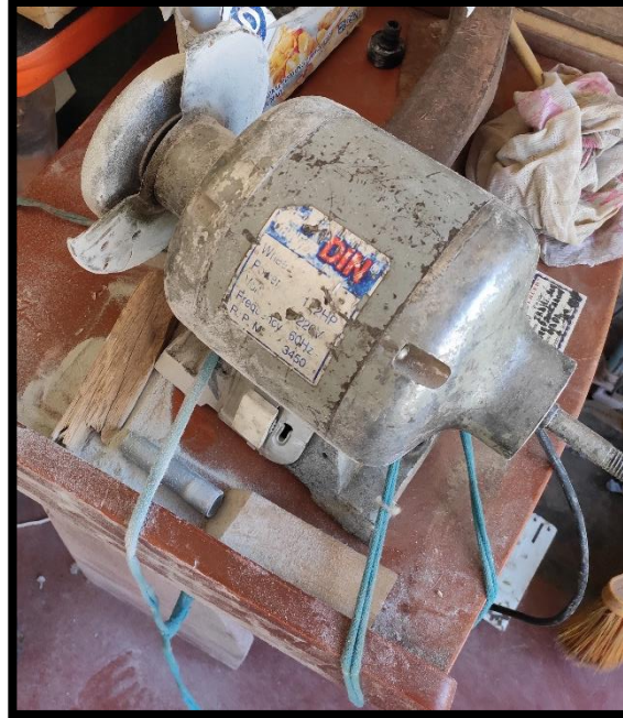
Figura 111: Motor necesario para triturar el PVC Fuente: Propia
