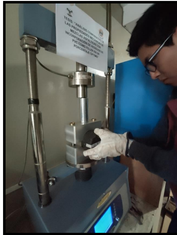
Figura 108: colocación del espécimen patrón en el cabezal de rotura Fuente: Propia
