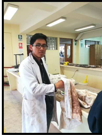
Figura 37: Secado con franela del agregado grueso Fuente: Propia
