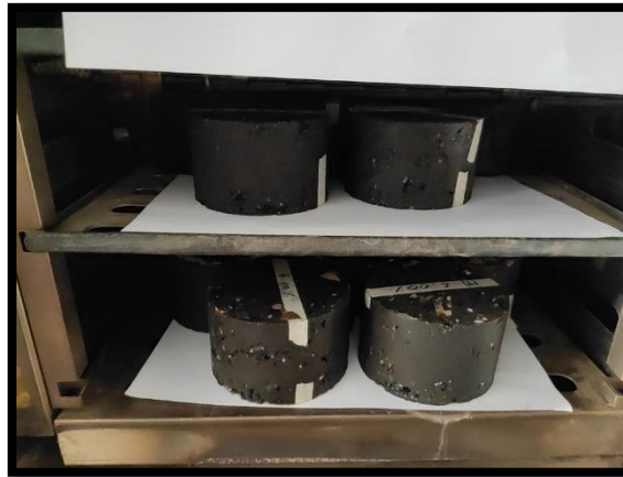
Figura 102: Especímenes patrón calentando en horno a 60 °C por 120 minutos Fuente: Propia
