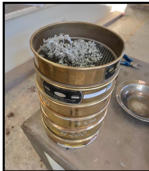
Figura 117: PVC triturado dentro de la serie de tamices listo para el tamizado Fuente: Propia
