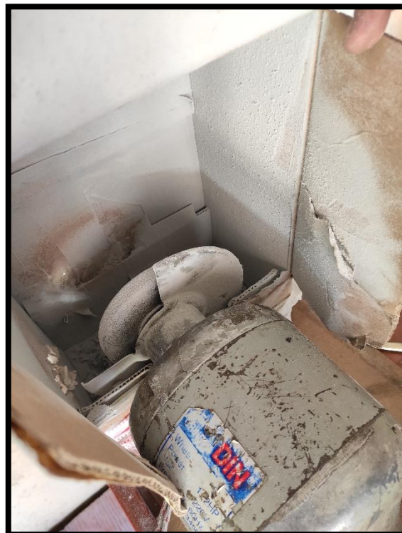
Figura 115: Partículas de PVC atrapadas en la caja luego del raspado con la piedra porosa Fuente: Propia
