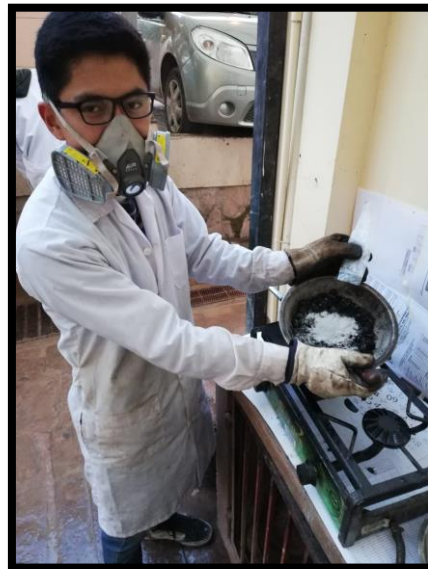
Figura 132: Incorporación de los residuos de PVC a la mezcla asfáltica Fuente: Propia
