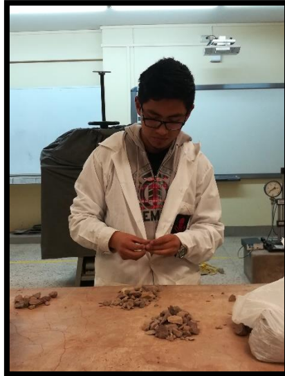
Figura 32: Verificación de las caras fracturadas de los agregados Fuente: Propia
