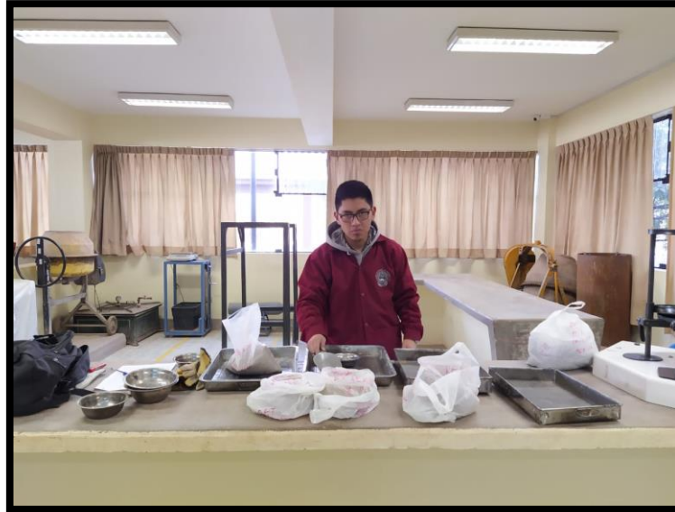
Figura 89: Pesado de agregado dosificado en bolsas para preparación de mezcla asfáltica patrón Fuente: Propia
