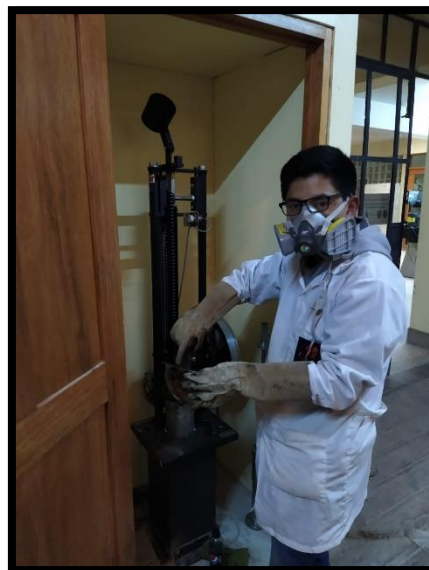
Figura 74: Vertido de la mezcla asfáltica dentro del molde de compactación Fuente: Propia
