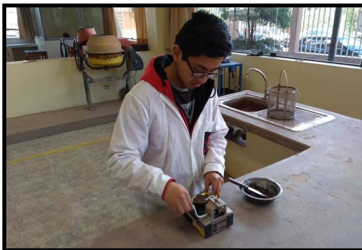
Figura 51: Registro del número de golpes de la cuchara de Casagrande Fuente: Propia
