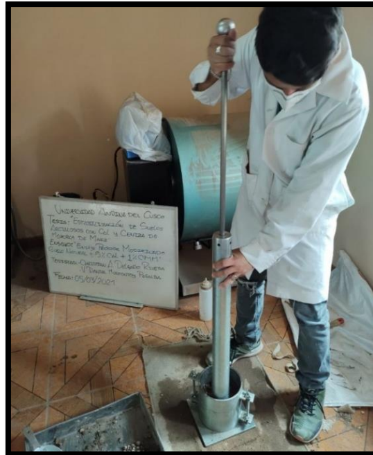
Figura 59. Compactación de Suelo usando pisón del Suelo Natural + 5% CAL + 1% de CMM para Proctor Modificado.
