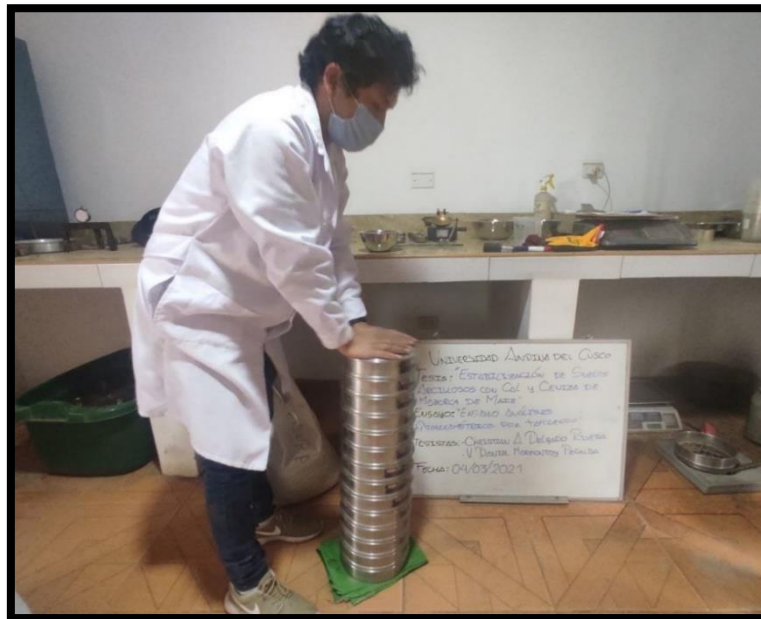
Figura 45. Preparación de tamices para el ensayo granulométrico.
