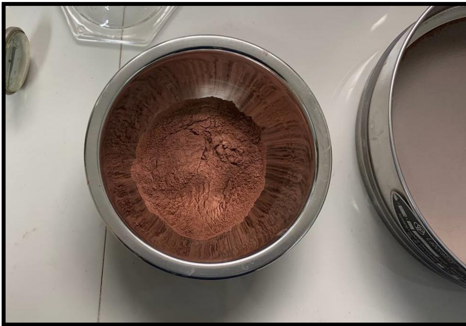
Figura 47. Preparación de la muestra seca para ensayo del hidrómetro.
