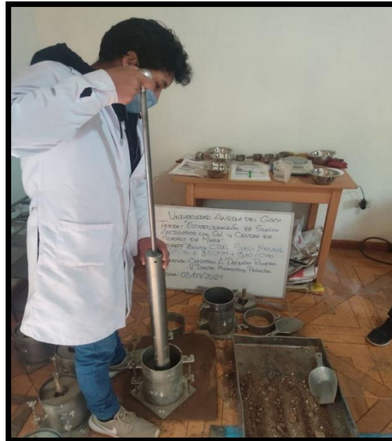
Figura 63. Compactación se suelos para ensayo de CBR con suelo natural + 5% de CAL + 3% de CMM + 15.10% de agua.
