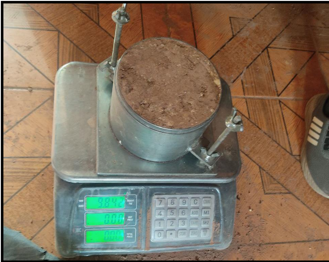
Figura 61. Pesado de muestras de Proctor Modificado compactadas + Molde.
