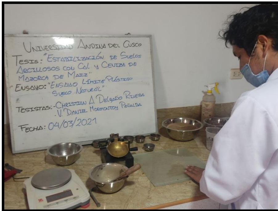
Figura 53. Realización del ensayo de límite plástico.
