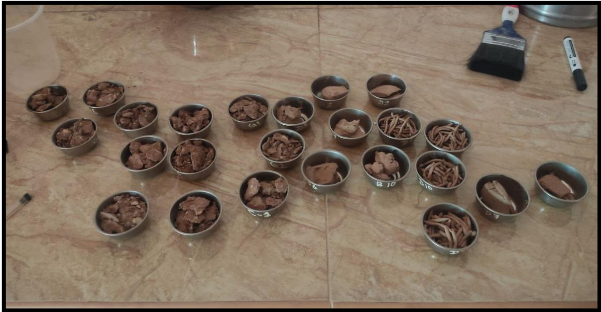
Figura 55. Muestras resultado de los ensayos de límites de consistencia.
