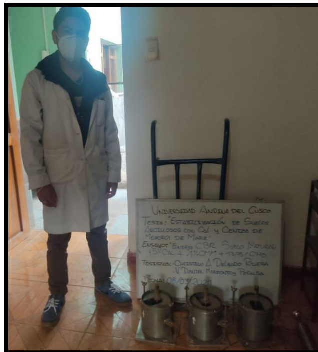
Figura 64. Muestras de CBR compactadas y listas para inmersión (con pesas)
