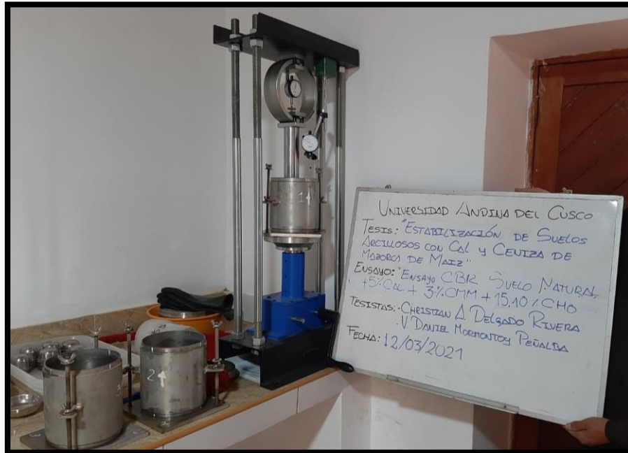
Figura 73. Muestras de CBR después del ensayo de penetración en suelo natural + 5% de CAL + 3% de CMM.
