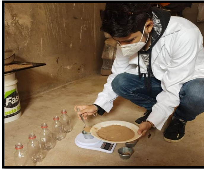
Figura 39. Preparación y pesado de muestras de suelo tamizado y cal en las taras.
