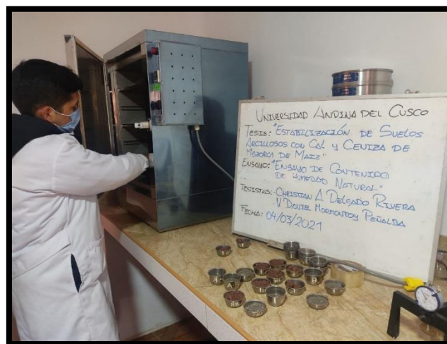
Figura 43. Ensayo de determinación del contenido de humedad natural
