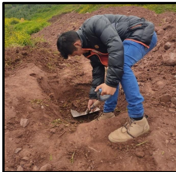
Figura 27. Excavación de Calicata 1 (C-1).
