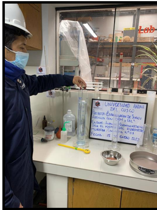
Figura 49. Preparación de la solución para el ensayo del hidrómetro.
