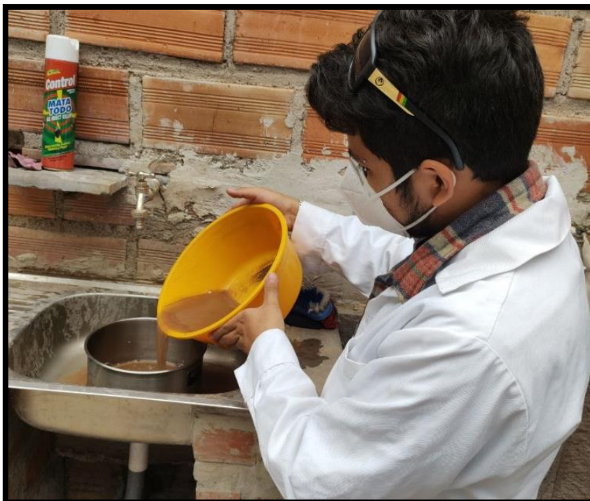
Figura 44. Lavado de material en la malla #200
