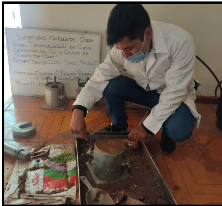
Figura 65. Enrasado de muestras de CBR en ensayo de suelo natural.
