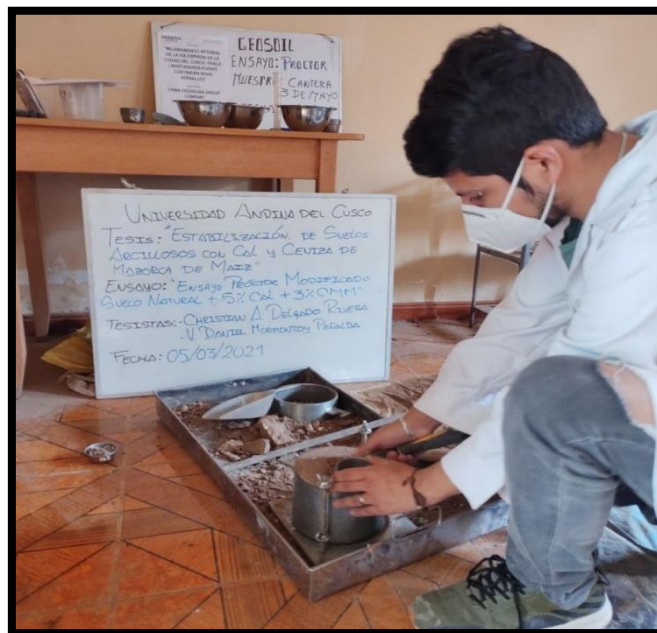
Figura 60. Extracción de muestras representativas para la determinación del contenido de humedad en el ensayo de Proctor Modificado.
