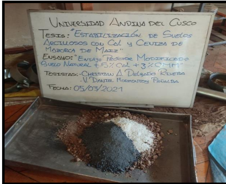
Figura 57. Mezclado de muestras y aditivos estabilizadores para ensayo de Proctor Modificado.
