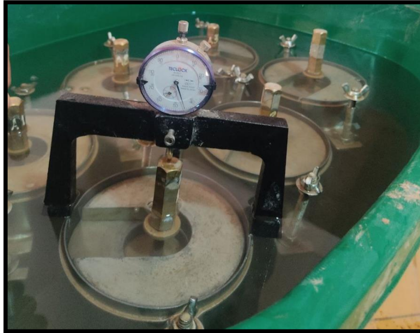
Figura 67. Toma de datos con el trípode y dial, en el ensayo de CBR para la verificación del hinchamiento.
