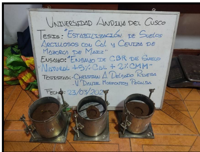
Figura 72. Muestras de CBR después del ensayo de penetración en suelo natural + 5% de CAL + 2% de CMM.
