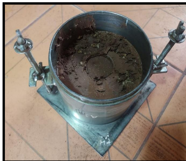
Figura 74. Muestra de CBR después del ensayo de penetración, para determinar el Contenido de humedad final.
