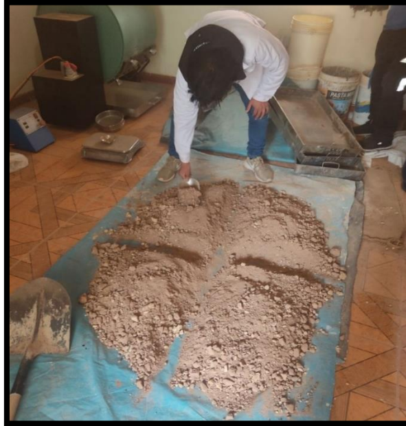
Figura 42. Cuarteo de suelos para la homogenización de muestras
