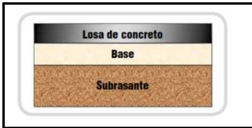
Figura 7. Estructura de un Pavimento Rígido
