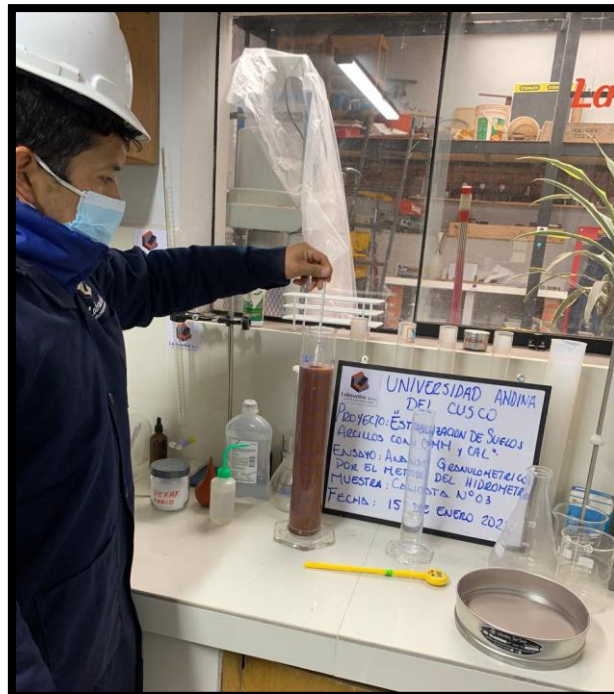
Figura 50. Realización del ensayo del hidrómetro.
