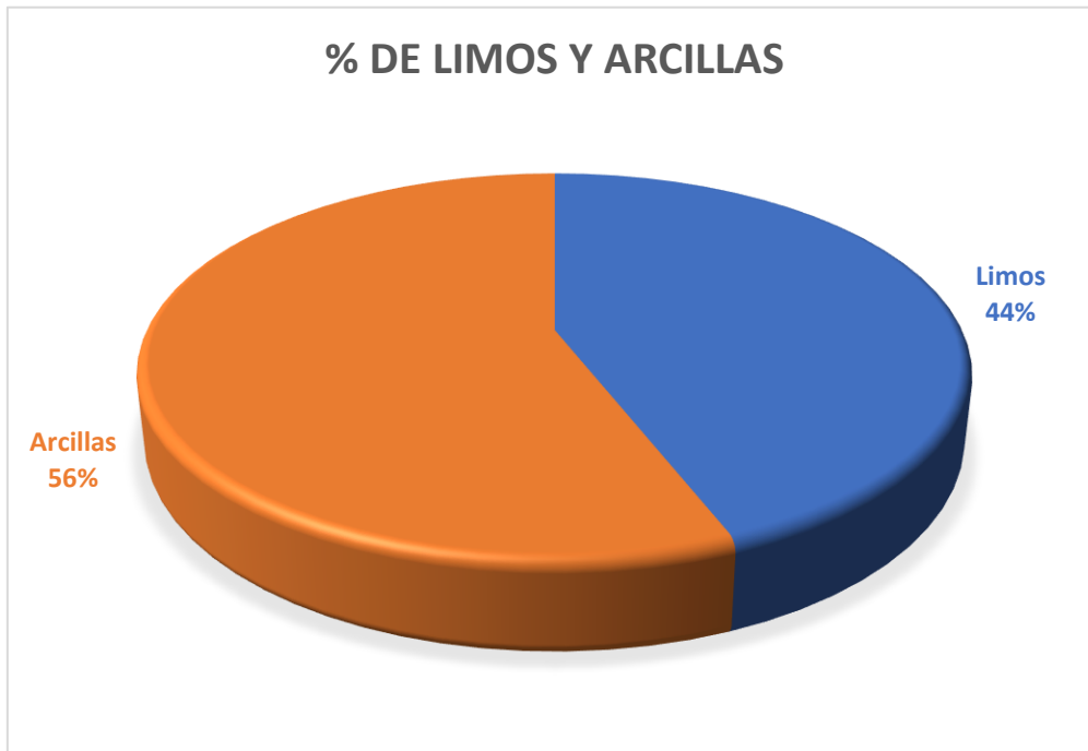
Figura 106. Resultados del ensayo de granulometría por hidrómetro.
