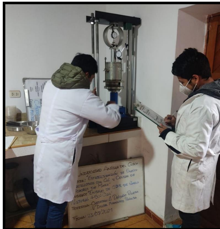
Figura 68. Ensayo de penetración en equipo de CBR de suelo natural + 5% de CAL.
