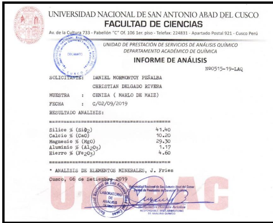
Figura 115. Ensayo de composición química de la CMM de Pillpinto.
