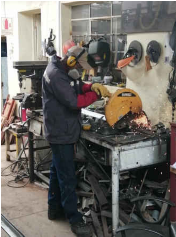
Figura 1: Colaborador realizando Trabajos en Caliente
