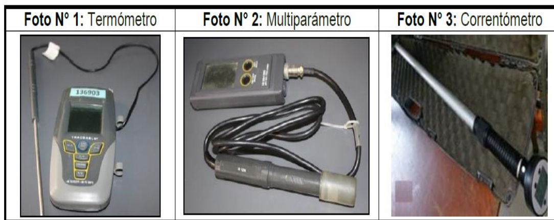
Figura 3.4. Equipos de medición
