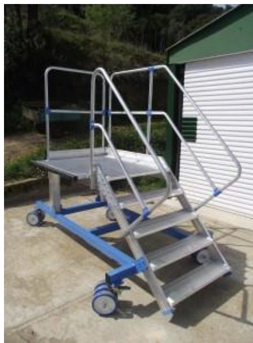
Figura 43 Escalera de acceso. Adaptado de (S.A, 2014)
