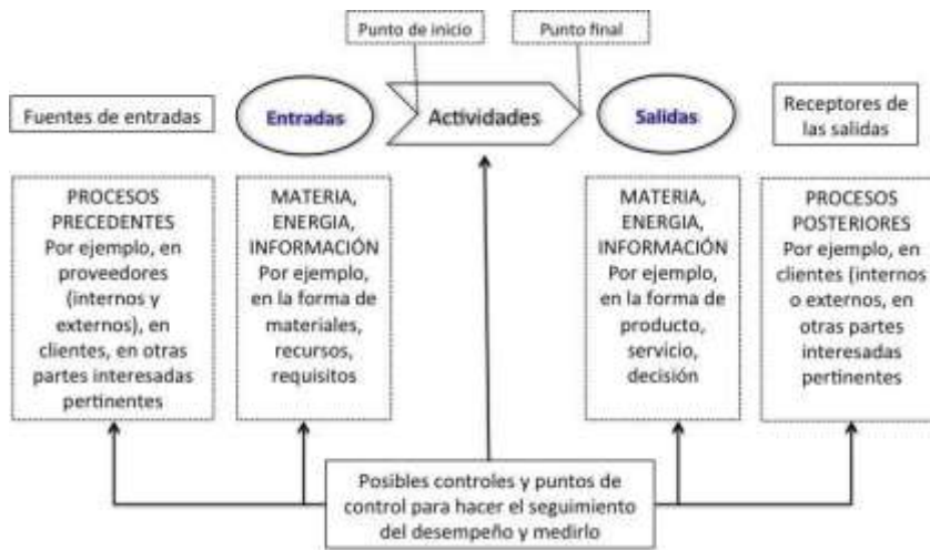
Figura 1. Procesos entradas y salidas. Representación esquemática de cualquier proceso y muestra la interacción de sus elementos.
