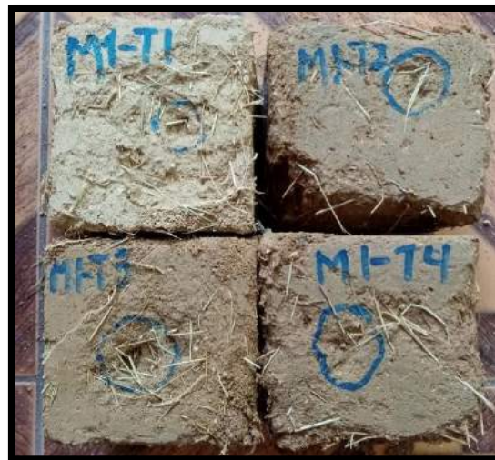
Figura 75: Muestra de M1 luego del ensayo de erosión acelerada de Swinburne Fuente: Propia
