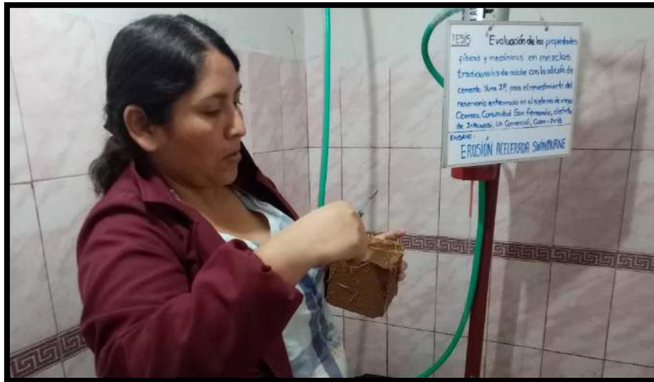
Figura 74: Medida de la profundidad de oquedad Fuente: Propia
