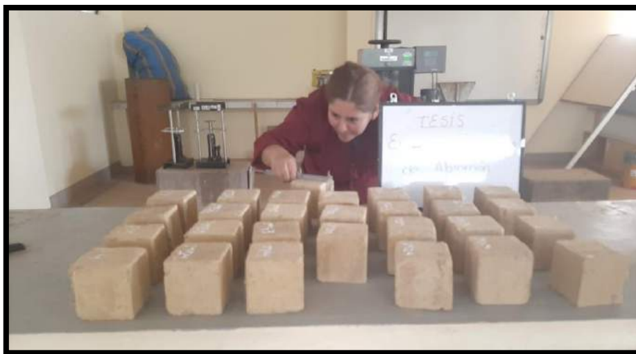
Figura 56: Toma de medidas de bloques de 10x10x10 cm antes de sumergirlos Fuente: Propia
