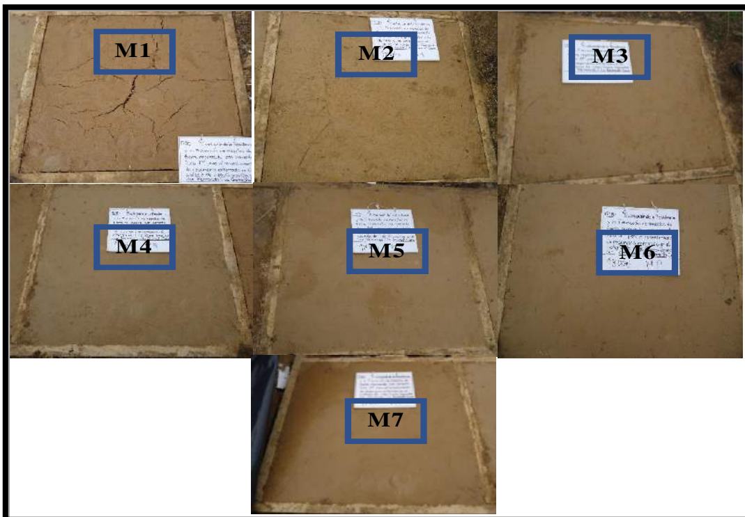
Figura 55: Paneles para evaluación de fisuras a los 56 días de secado Fuente: Propia
