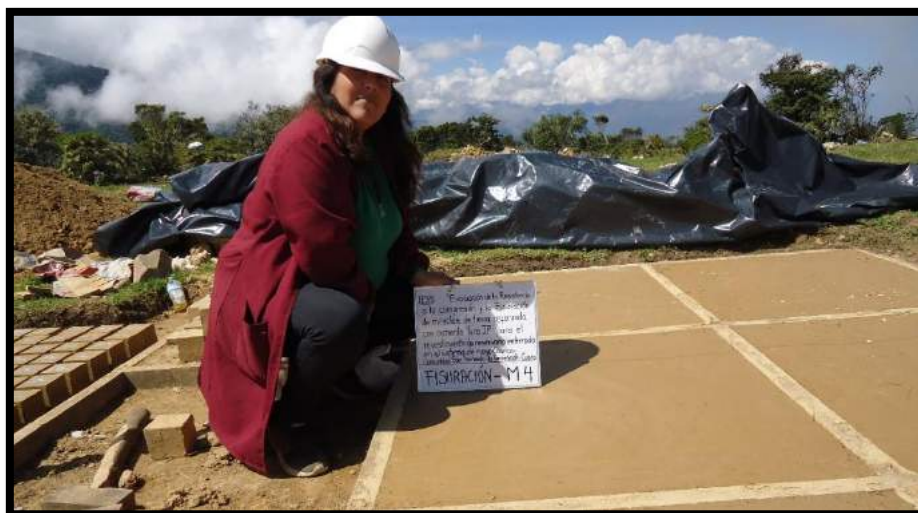
Figura 53: Evaluación de la fisuración a los 28 días de secado Fuente: Propia
