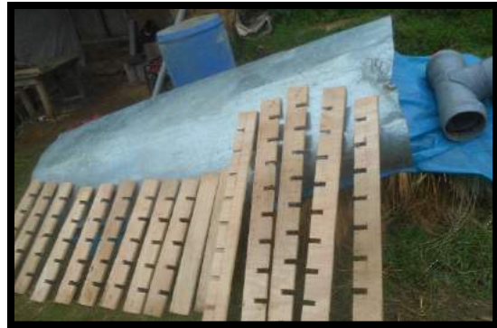
Figura 41: Corte y armado de moldes para los ensayos de resistencia a la compresión, absorción y erosión acelerada
