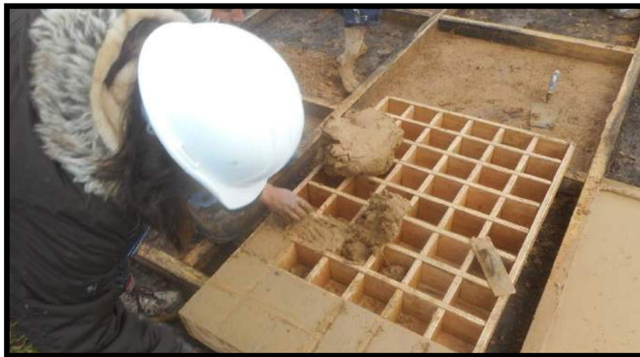
Figura 44: Proceso de lanzamiento de mezcla en moldes cúbicos Fuente: Propia
