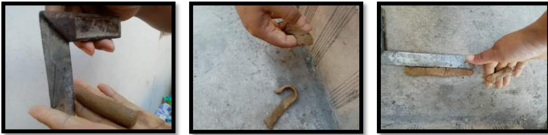
Figura 22: Prueba de cinta de barro Fuente: Propia
