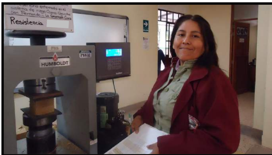
Figura 65: Desarrollo del ensayo de resistencia a la compresión a los 14 días de secado Fuente: Propia
