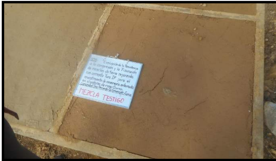
Figura 51: Formación de fisuras a partir del segundo día de secado en la mezcla testigo (M1) Fuente: Propia
