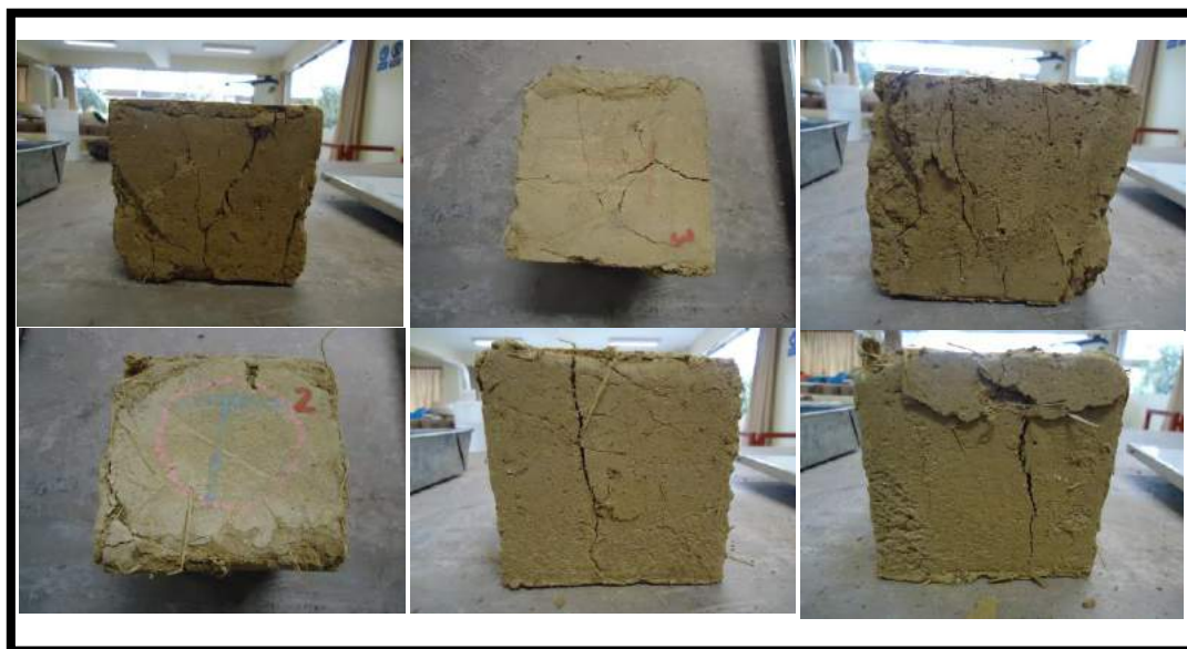
Figura 69: Muestras luego del ensayo de resistencia a la compresión a los 56 días Fuente: Propia
