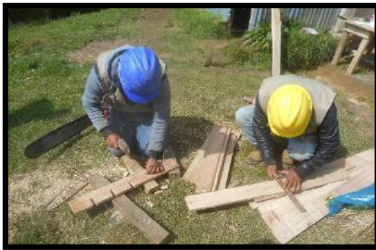
Figura 41: Corte y armado de moldes para los ensayos de resistencia a la compresión, absorción y erosión acelerada
