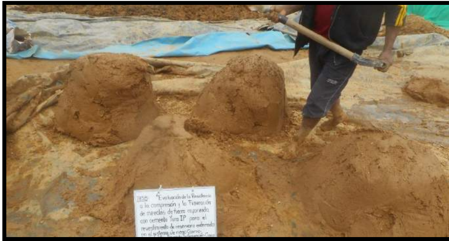
Figura 37: Armado de rumas de mezclas para el proceso de dormido Fuente: Propia
