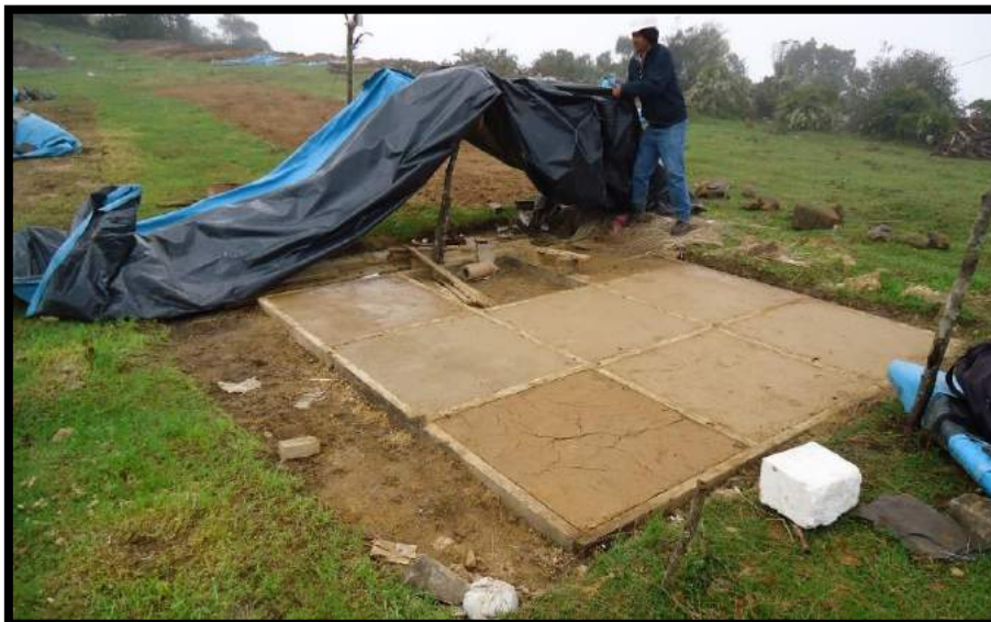
Figura 50: Paneles para evaluación de fisuración a los 14 días de secado Fuente: Propia
