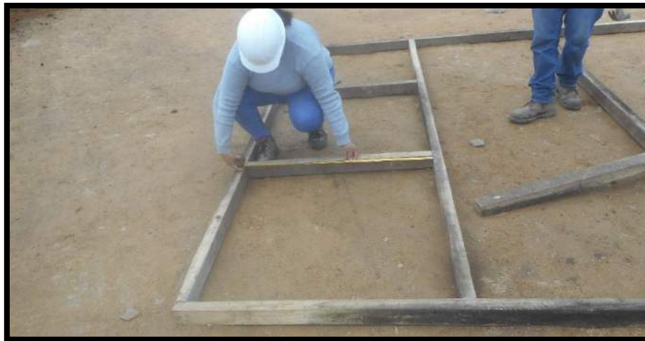
Figura 40: Verificación de medidas de los paneles para el ensayo de fisuración
