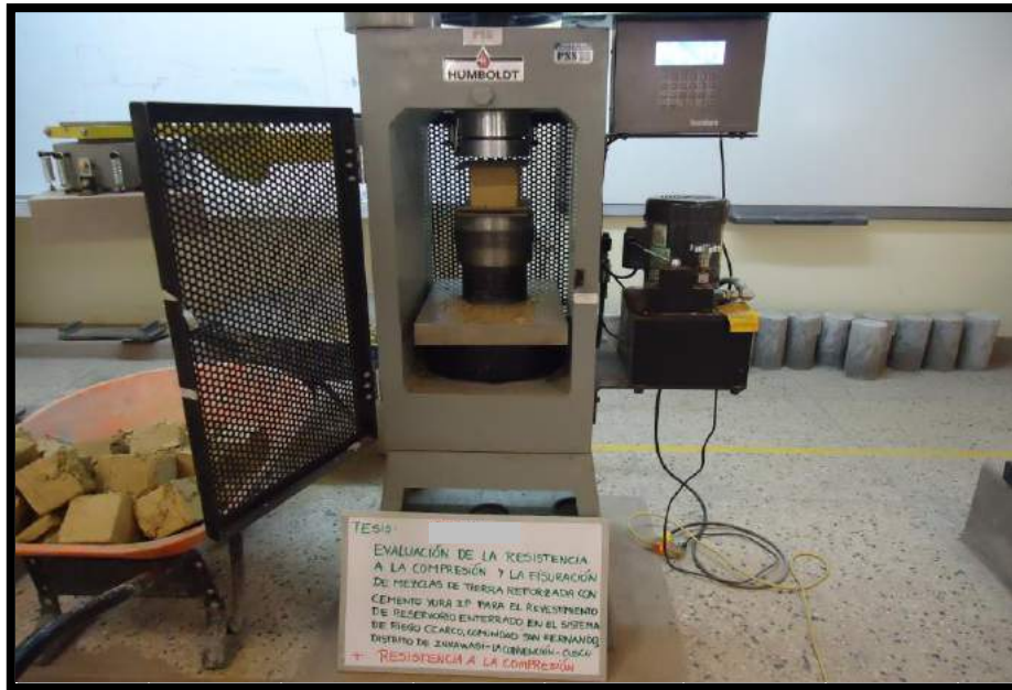
Figura 68: Ensayo de resistencia a compresión en bloques a los 56 días de secado Fuente: Propia
