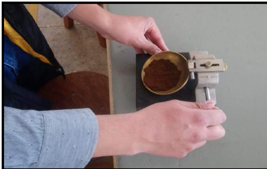
Figura 30: Ensayo de Límite Líquido con la cuchara de Casagrande Fuente: Propia
