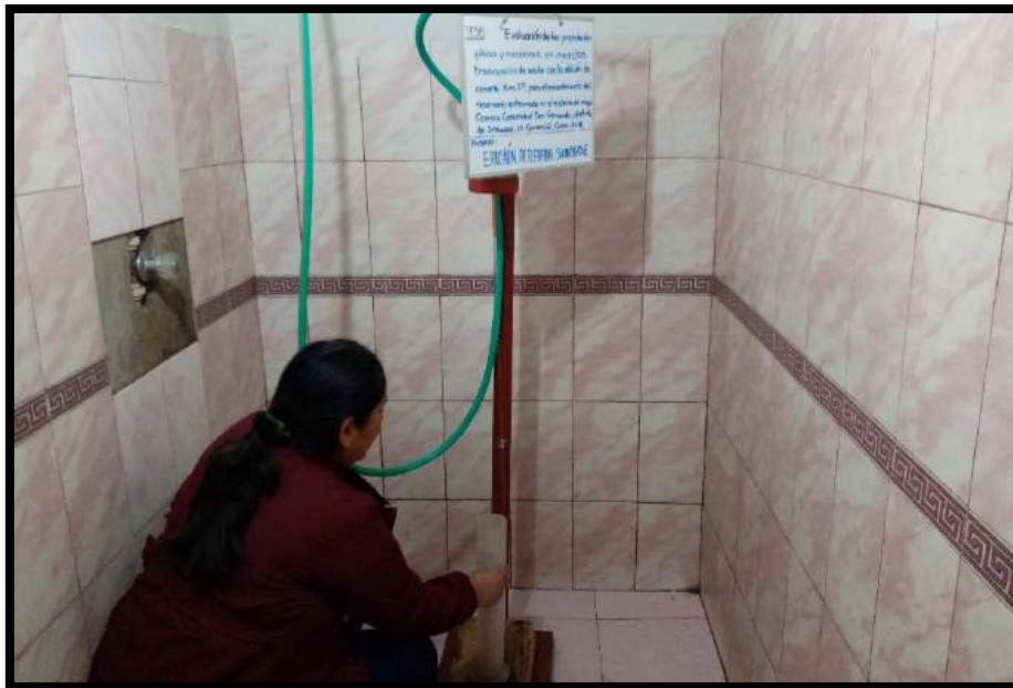
Figura 72: Calibración del equipo para erosión acelerada de Swinburne Fuente: Propia
