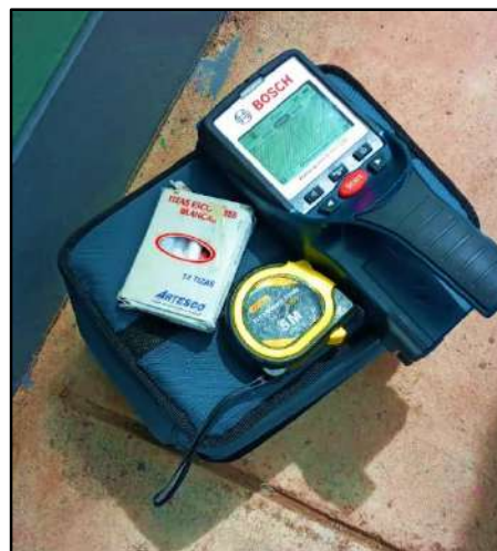
Figura 9 Detector universal de materiales digital BOSCH D-Tect 150
