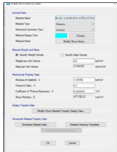
Figura 41 a) Modelo de grillas de la edificación "A-2" y b) Definición de propiedad del material
