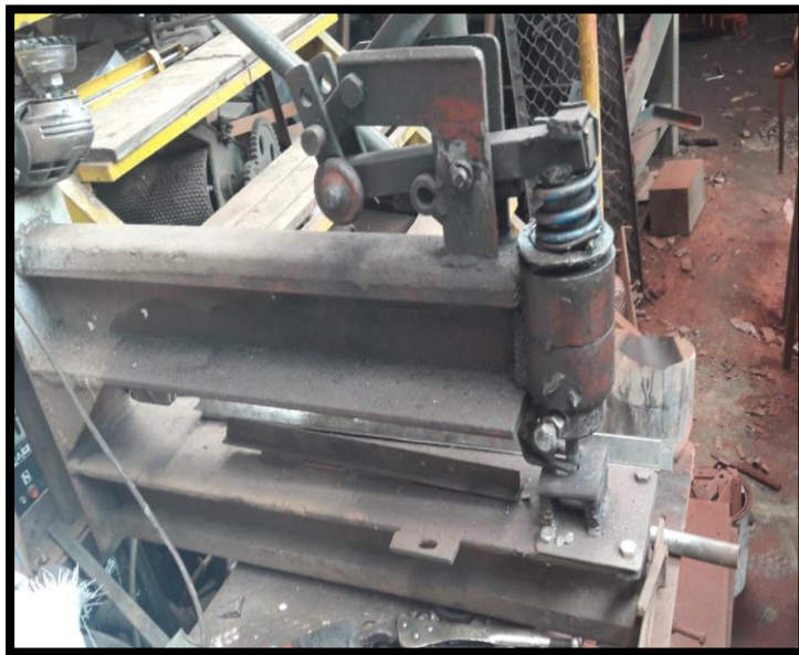
Figura 31: Fabricación de Camisetas sin Innovación de la Matriz y Prensa Excéntrica.
