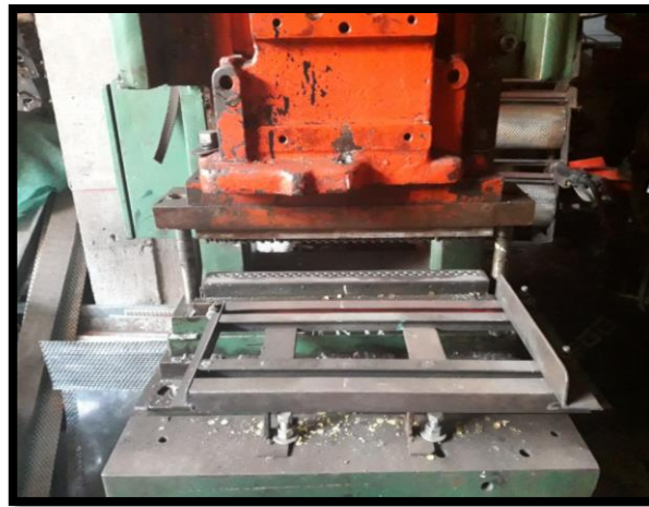
Figura 37: Fabricación de Camisetas con Innovación de la Matriz y Prensa Excéntrica.
