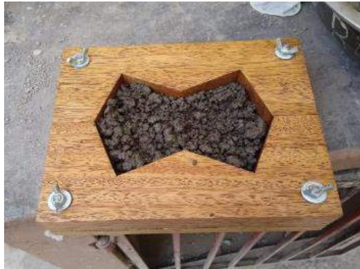
Figura 71. Proceso de verter la mezcla al molde.
