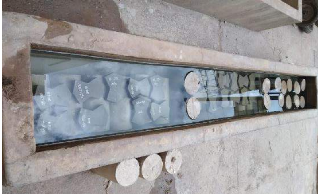
Figura 32. Posa de Curado. Fuente propia
