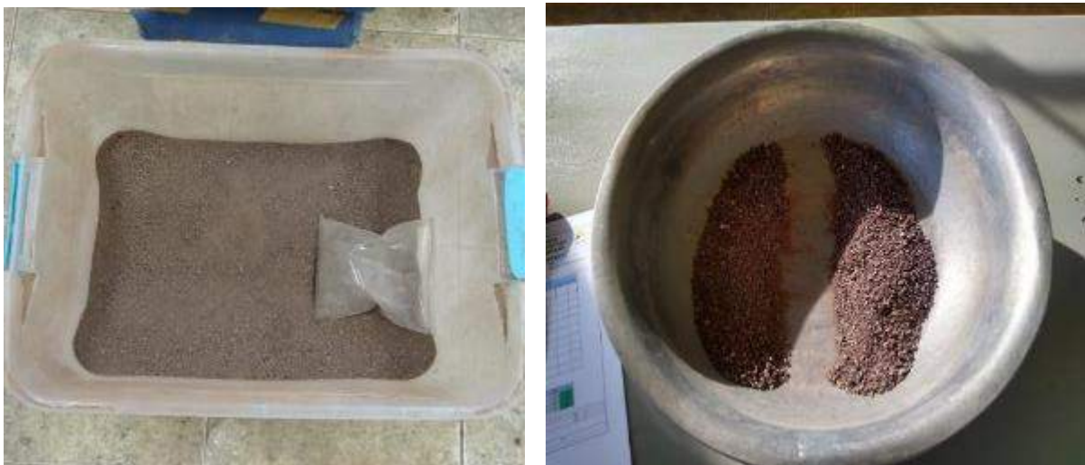
Figura 64. Cuarteo de agregado Fuente propia
