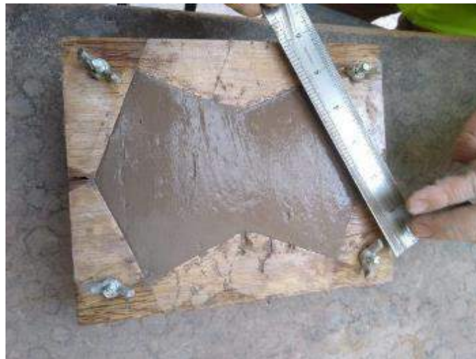
Figura 72. Retiro de la mezcla excedente
