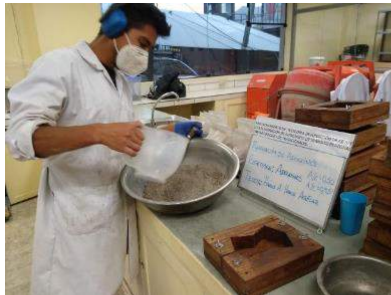
Figura 70. Proceso de agregado de agua
