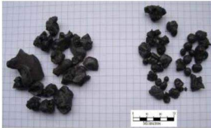
Figura 24. Escoria Granallada Fundición Paipote de ENAMI Fuente: (Kneer, 2013, pág. 22, citado por Fundición Paipote de ENAMI).
