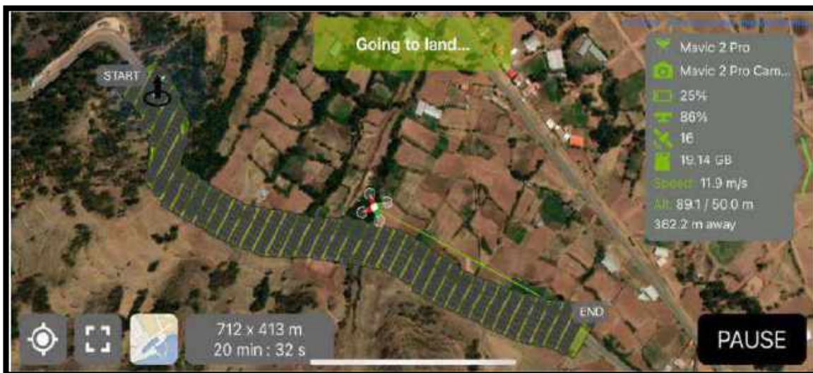
Figura n° 65: Regreso del dron con su comando devuelta a casa o punto de inicio del vuelo una vez tomada las fotografías
