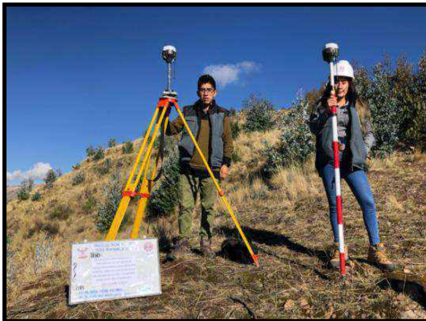
Figura n° 50: Término del levantamiento con GPS Diferencial (retorno a la Base)
