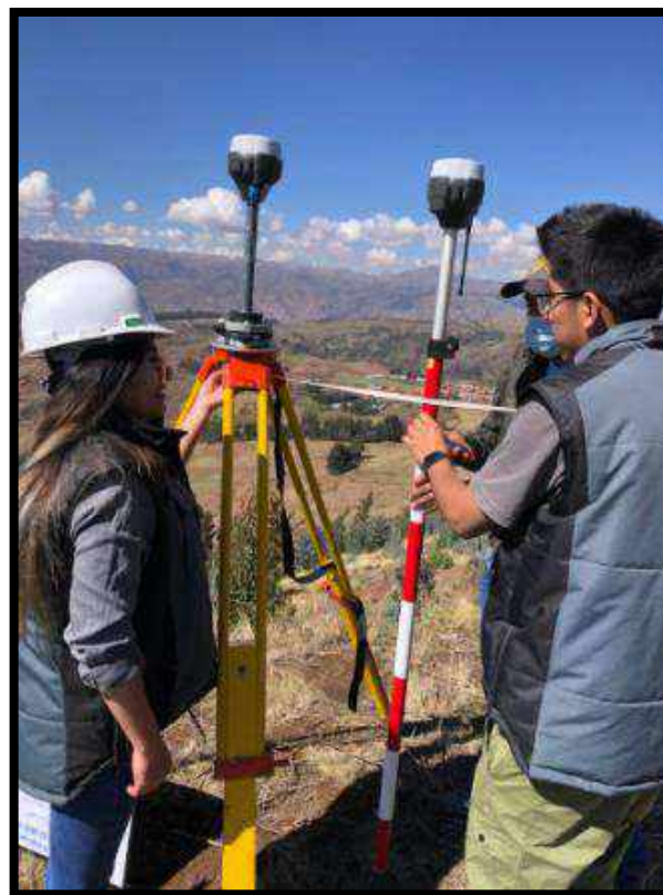
Figura n° 44: Prueba de medición de la distancia y posicionamiento del Rover con respecto a la Base del GPS Diferencial
