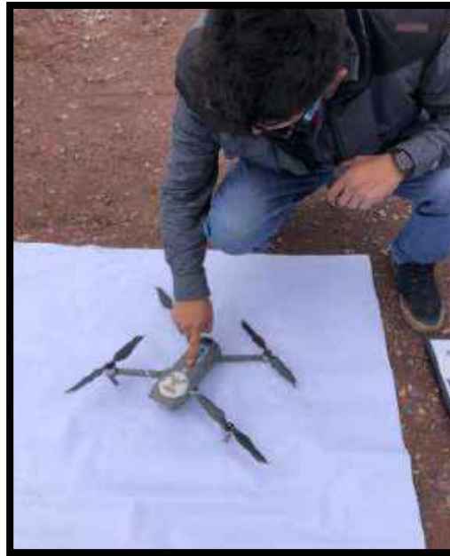
Figura n° 76: Apagado del equipo para evitar el recalentado de los accesorios y batería del Dron
