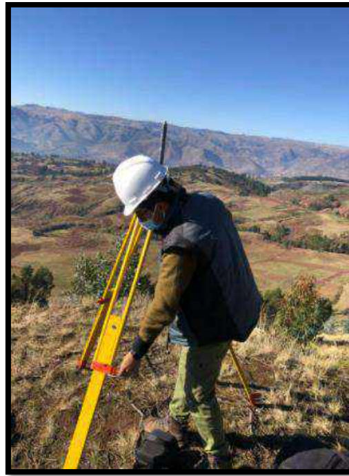
Figura n° 41: Armado del Trípode del GPS Diferencial
