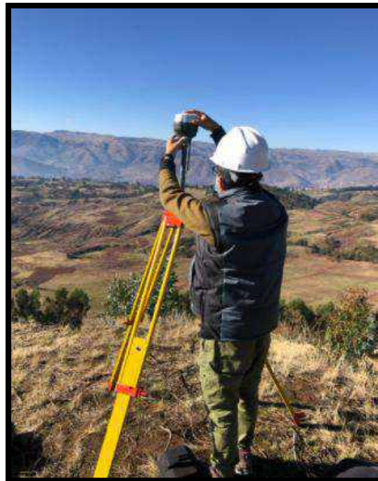
Figura n° 42: Ensamblado de la Base del GPS Diferencial
