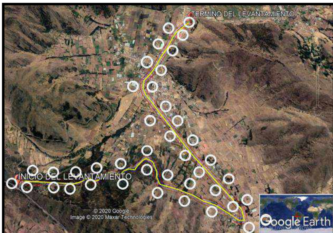
Figura n° 30: Ubicación de los BMs (Puntos de Control)
