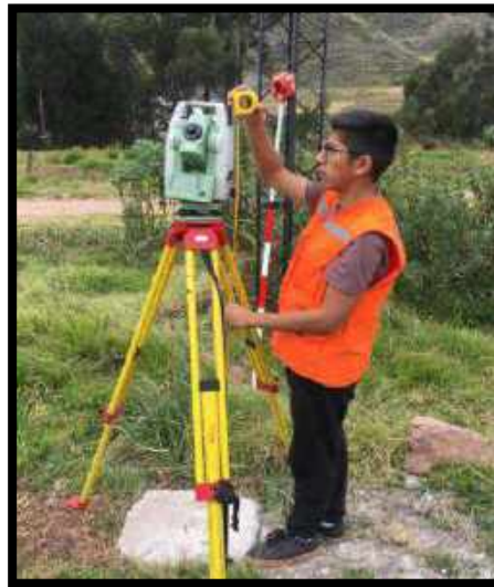
Figura n° 2: Levantamiento Topográficos con Estación Total
