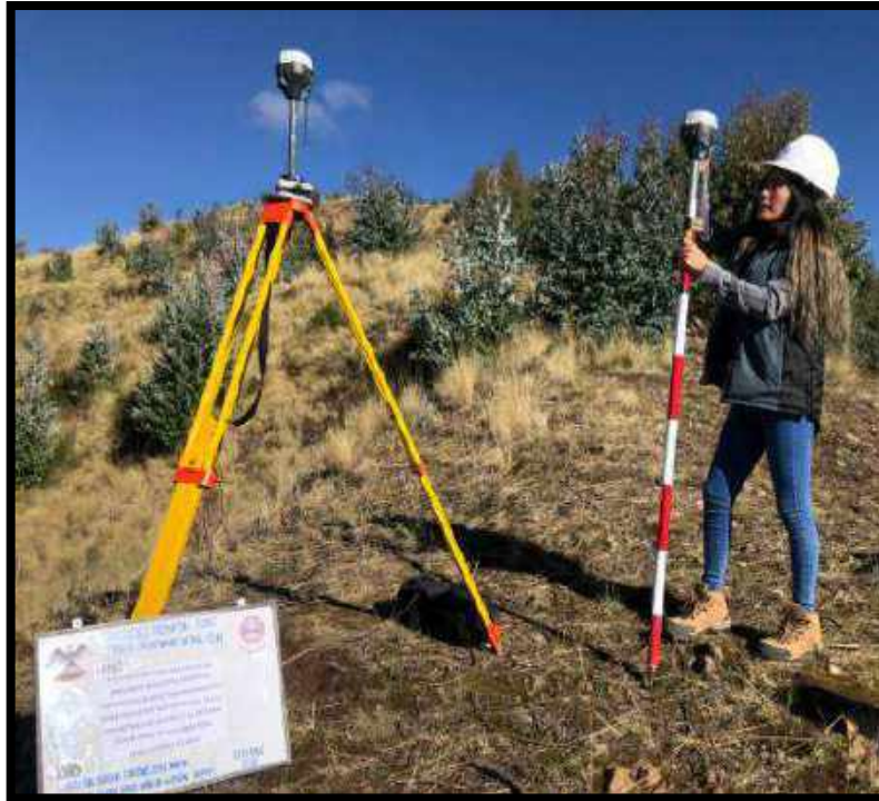
Figura n° 43: Armado del Rover en la porta prisma del GPS Diferencial
